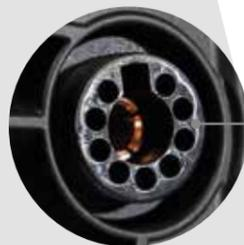
Разъем для подключения резака
