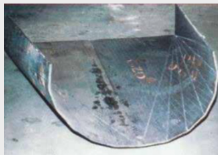
Лоток, изготовленный методом секторной гибки АСП
