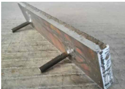
Элемент футеровки АСП со шпильками
