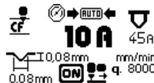
Il generatore visualizza automaticamente la larghezza e la profondità del solco ottenibile con i valori di corrente (Fig. 4 Rif. G) e velocità di lavorazione relativa (Fig. 4 Rif. E) impostate dall'operatore e indica l'ugello da utilizzare (Fig.4 Rif.F).
