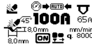
Der Generator zeigt automatisch die Breite und die Tiefe der mit den Stromwerten erzielbaren Rille (Abb. 4 Bez. G) bei entsprechender Betriebsgeschwindigkeit (Abb. 4 Bez. E) an, die vom Bediener eingestellt wurden und gibt auch die zu verwendende Düse (Abb. 4 Bez. F) und die Neigung in Grad an, mit der der Schneidbrenner während des Vorschubs gehalten werden muss.
