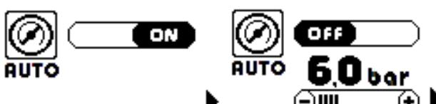
La modalità default di fabbrica è AUTO ON che permette al generatore di mantenere costante e al valore ottimale la pressione di lavoro della torcia, anche in presenza di variazioni della pressione di ingresso. Questo sistema
