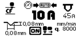
Der Generator zeigt automatisch die Breite und die Tiefe der mit den Stromwerten erzielbaren Rille (Abb. 4 Bez. G) und die entsprechende Betriebsgeschwindigkeit (Abb. 4 Bez. E) an, die vom Bediener eingestellt wurde, und es wird auch die zu verwendende Düse angegeben (Abb. 4 Bez. F).
