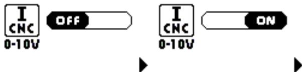
A modalidade padrão de fábrica é OFF [Desligado] o que implica que não haja qualquer possibilidade de regulação da corrente de corte remotamente entre o pino 1 (0V) e o pino 2 (10V).
