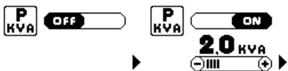
La modalité par défaut d'usine est OFF ce qui comporte qu'il n'y a aucune limitation de la puissance absorbée à l'entrée. Cependant si nécessaire en positionnant sur ON cette fonction, on peut sélectionner la valeur de puissance maximale absorbée pour adapter le générateur à l'équipement auquel il sera connecté. De cette manière il
