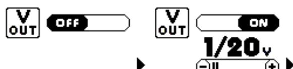
La modalité par défaut d'usine est OFF ce qui comporte qu'il n'y a aucune tension entre les pins de sortie 5(-) et 6(+).
