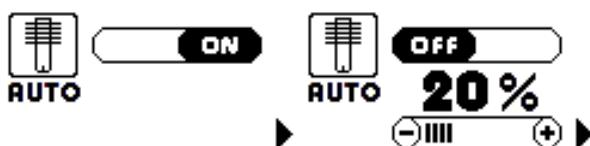
La modalité par défaut d'usine est AUTO ON, elle permet au générateur d'interrompre le fonctionnement automatique de manière autonome quand l'électrode et la buse sont à remplacer. Il est cependant possible de configurer cette modalité sur OFF, ce qui ne correspond pas à la désactivation complète de la fonction, mais il devient possible de pouvoir augmenter ou diminuer la sensibilité d'intervention de cette protection.
