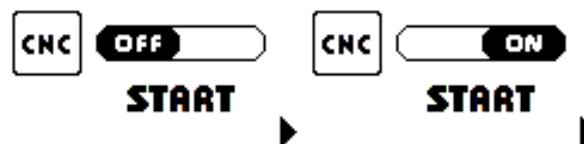
Impostando questa funzione su ON si attiva la modalità di START da CNC corrispondente ai pin 3 e 4 del connettore AMP posto sul retro del generatore e contemporaneamente si disattiva lo start manuale posto sull'adattatore frontale della macchina.
