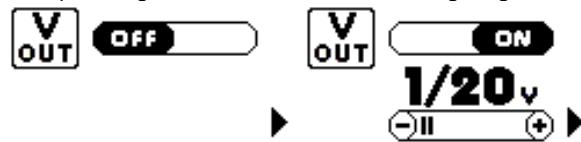
Der werkseitige Standardmodus ist OFF, was bedeutet, dass zwischen den Ausgangspins 5 (-) und 6 (+) keine Spannung anliegt.
