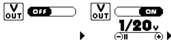
La modalità default di fabbrica è OFF il che comporta che non via sia alcuna tensione tra i pin di uscita 5(-) e 6(+). In caso di utilizzo con CNC dotato di controllo della tensione d'arco è possibile impostare questa funzione in ON, in modo da poter regolare a piacimento i valori del partitore di uscita tra un minimo di 1/20V e un massimo di 1/100V. (es.1/20, 1/21, 1/22, 1/23, 1/24.....fino a 1/100V).
