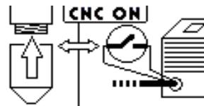
Si cette image s'affiche la machine signale que la fonction START CNC est activée et qu'il faut contrôler si le porte-buse n'a pas été enlevé et/ou si le contact externe de la torche automatique n'est pas resté ouvert (ce dernier doit en effet être court-circuité pour le fonctionnement correct du start du cnc).
