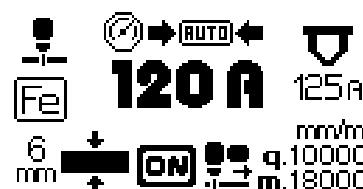
Si la pression à l'entrée est insuffisante pour atteindre la valeur optimale de découpe, mais de toute manière suffisante pour le processus sélectionné la machine affichera le mot LOW avec une flèche tournée vers le bas.
