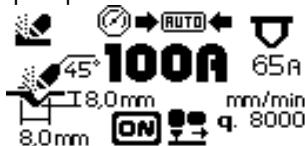
El generador mostrará automáticamente la anchura y la profundidad del surco que se obtiene con los valores de corriente (Fig. 4 Ref. G) a la velocidad de elaboración relativa (Fig. 4 Ref. E) configuradas por el operador e indicará la boquilla que hay que utilizar (Fig.4 Ref.F) y la inclinación en
