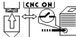
Si aparece esta imagen, la máquina señala que la función START CNC está activa y hay que comprobar que el portaboquilla no se haya retirado y/o que el contacto externo de la antorcha automática no se haya quedado abierto (de hecho, este último debe ser cortocircuitado para el funcionamiento correcto del start por cnc)
