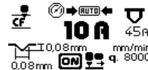
El generador mostrará automáticamente la anchura y la profundidad del surco que se obtiene con los valores de corriente (Fig. 4 Ref. G) y la velocidad de elaboración relativa (Fig. 4 Ref. E) configuradas por el operador e indicará la boquilla que hay que utilizar (Fig.4 Ref.F).
