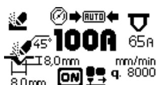
Le générateur affichera automatiquement la largeur et la profondeur du sillon pouvant être obtenu avec les valeurs de courant (Fig. 4 Réf. G) à la vitesse d'usinage correspondante (Fig. 4 Réf. E) configurées par l'opérateur et indique la buse à utiliser (Fig. 4 Réf. F) et l'inclinaison en degrés à laquelle il faut garder la torche pendant l'avancement.
