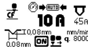
Le générateur affichera automatiquement la largeur et la profondeur du sillon pouvant être obtenu avec les valeurs de courant (Fig. 4 Réf. G) et la vitesse d'usinage correspondante (Fig. 4 Réf. E) configurées par l'opérateur et indique la buse à utiliser (Fig. 4 Réf. F).
