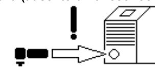
Si aparece esta imagen, la máquina señala que no se ha conectado ninguna antorcha o que se ha conectado una antorcha no válida.
