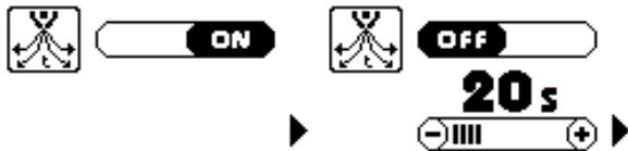
Der werkseitig eingestellte Standardmodus ist AUTO ON, sodass der Generator die Dauer des Nach-Gases je nach dem eingesetzten Schneidbrenner, dem eingestellten Stromwert und dem gewählten Bearbeitungsprozess automatisch und synergetisch regeln kann. Diese Funktion kann jedenfalls auch auf OFF geschaltet werden, um die Dauer des Nach-Gases von Hand zu regulieren.
