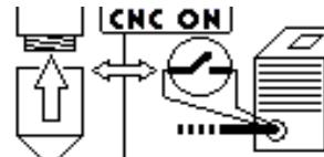
Nel caso in cui compaia questa immagine la macchina segnala che la funzione START CNC è attiva e occorre verificare che il portaugello non sia stato rimosso e/o che il contatto esterno della torcia automatica non sia rimasto aperto (quest'ultimo va infatti cortocircuitato per un corretto funzionamento dello start da cnc)
