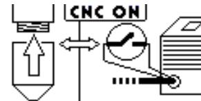
Falls diese Abbildung erscheint, teilt die Maschine mit, dass die Funktion START CNC aktiviert ist und überprüft werden muss, ob die Düsenhalterung entfernt wurde und/oder ob der externe Kontakt des automatischen Schneidebrenners offen geblieben ist (letzterer muss für den korrekten Betrieb des über CNC gesteuerten Kontakts kurzgeschlossen werden).
