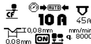
O gerador exibe automaticamente a largura e a profundidade do sulco que pode ser obtido com os valores de corrente (Fig. 4 Ref. G) e velocidade de trabalho relativa (Fig. 4 Ref. E) definidos pelo operador e indica o bico a usar (Fig.4 Ref.F).
