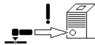
Falls diese Abbildung erscheint, teilt die Maschine mit, dass kein Schneidebrenner oder ein nicht gültiger Schneidebrenner angeschlossen ist.
