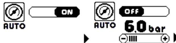
Der werkseitige Standardmodus ist AUTO ON, sodass der Generator den Betriebsdruck des Schneidbrenners konstant und auf optimalem Wert beibehält, auch wenn am Eingang Druckschwankungen vorkommen. Dieses im Automatikmodus eingestellte System ermöglicht es, dass der Druck nicht reguliert werden muss, der Generator selbst stellt den richtigen Wert aufgrund des eingesetzten Schneidbrenners und der gewählten Bearbeitung ein.
