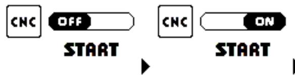
Configurando esta função em ON ativa-se a modalidade de START pelo CNC correspondente aos pinos 3 e 4 do conector AMP situado na parte traseira do gerador e desativa-se simultaneamente o start manual situado no adaptador frontal da máquina.
