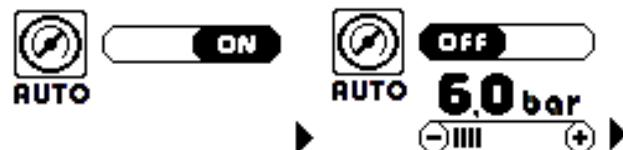
La modalité par défaut d'usine est AUTO ON qui permet au générateur de conserver constante et à la valeur optimale la pression de travail de la torche, même avec des variations de pression d'entrée. Ce système configuré en modalité automatique permet en effet de n'effectuer aucun réglage de la pression, ce sera le générateur qui configurera la valeur correcte par rapport à la torche insérée et à l'usinage sélectionné.
