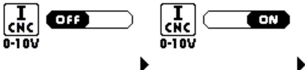
Der werkseitige Standardmodus ist OFF, was bedeutet, dass es keine ferngesteuerte Möglichkeit zum Regulieren des Schnittstroms zwischen dem Pin 1 (0 V) und dem Pin 2 (10 V) gibt. Falls der Schnittstrom ferngesteuert reguliert werden soll (CNC), muss Folgendes erfolgen:
