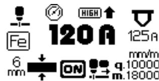
De todas maneras, es posible configurar la función en OFF para poder leer y regular la presión de trabajo de la antorcha en el valor deseado (dentro de ciertos límites preconfigurados), directamente desde el panel principal, que aparecerá de la manera siguiente:
