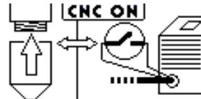
Caso apareça esta imagem a máquina sinaliza que a função START CNC está ativa e é necessário verificar que o suporte do bico não tenha sido removido e/ou que o contacto externo da tocha automática não tenha ficado aberto (a este último deve ser feito um curto-círcuito para um correto funcionamento do start pelo CNC).
