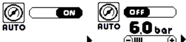
A modalidade padrão de fábrica é AUTO ON [AUTOMATICAMENTE LIGADO] que permite ao gerador de manter constante e ao valor ideal a pressão de trabalho da tocha, mesmo em presença de alterações da pressão de entrada. Este sistema configurado em modalidade automática permite, na verdade, não realizar qualquer regulação da
