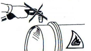
Не используйте плазменную резку для демонтажа пустых контейнеров, в которых содержались ГСМ, из-за опасности взрыва.
