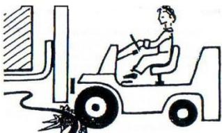
Защитите все кабельные соединения и провода от возможного механического повреждения.
