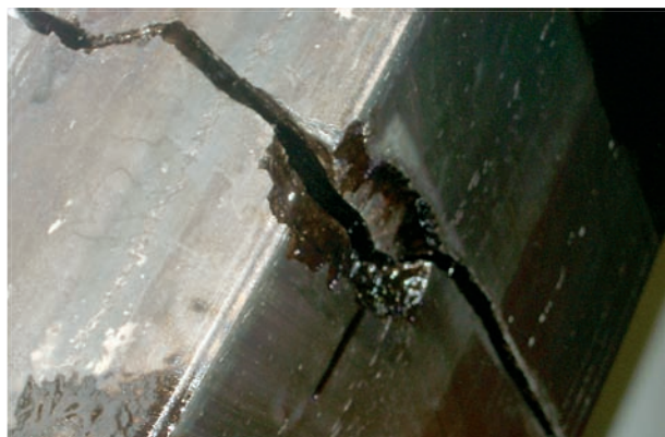
Усталостное растрескивание бандажа клинкерной печи, толщина – 250 мм
