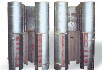
Трубы циклона в вентиляционной системе экскаватора. Тепловая электростанция
