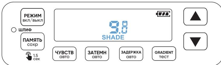
Нажатием кнопки **РЕЖИМ АВТО** на внешнем регуляторе выберите режим фиксированного затемнения, обозначенный на экране замком. Поворотом энкодера **ШЛИФ** выберите необходимое значение затемнения в диапазоне 4...14 DIN.
