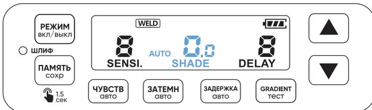
Зажатием на 1,5 секунды кнопки **РЕЖИМ АВТО** активируете автопилот затемнения. Включенный автопилот затемнения отобразится на ЖК-экране надписью «AUTO».
