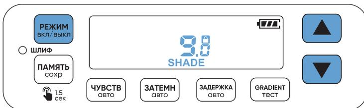
Нажатием кнопки **РЕЖИМ** выберите режим фиксированного затемнения, обозначенный на экране замком. Нажатием
