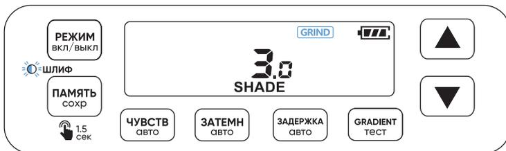
Нажатием кнопки **УДЕРЖ ШЛИФ** активируйте режим шлифовки. Включенный режим отобразится мигающим световым индикатором **ШЛИФ**.
