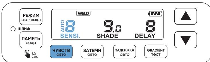
Зажатием на 1,5 секунды кнопки **ЧУВСТВ АВТО** активируете режим автоматической регулировки чувствительности. Включенный ре-
