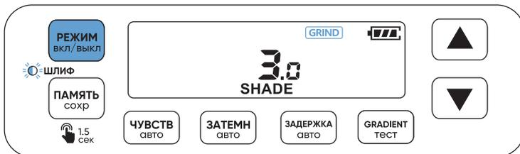
Нажатием кнопки **РЕЖИМ** выберите «GRIND». Включенный режим отобразится мигающим световым индикатором **ШЛИФ**.
