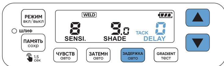
Нажатию кнопки **ЗАДЕРЖКА АВТО** и активируете «DELAY». Нажатию кнопок **▲** **▼** выберите значение времени задержки просветле-
