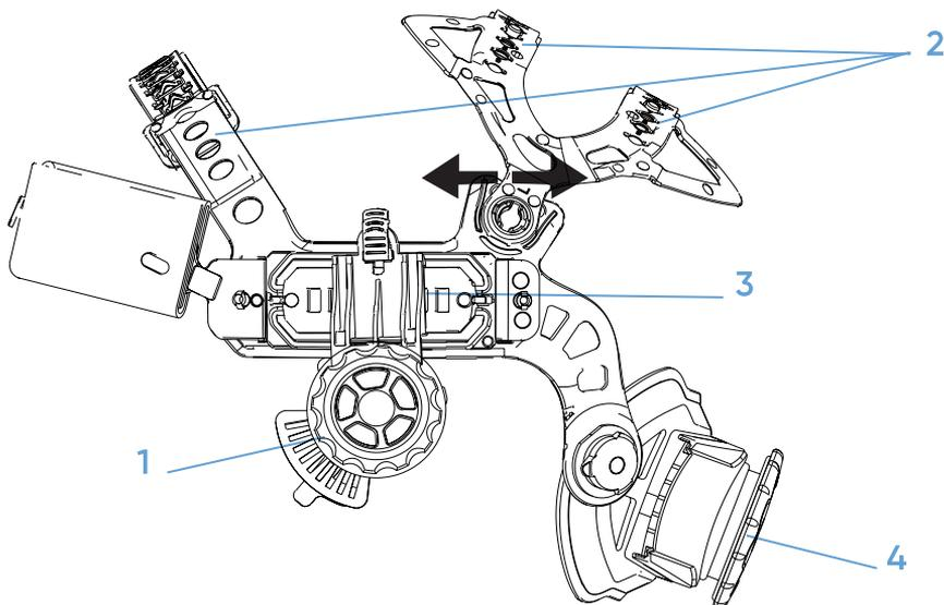
Рисунок 8. Схема регулировки наголовника
