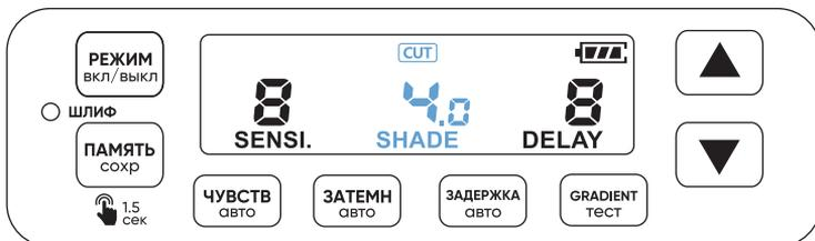
Нажатием кнопки **РЕЖИМ АВТО** на внешнем регуляторе выберите «CUT 4-8». Поворотом энкодера **1** **2** выберите необходимое значение затемнения в диапазоне 4...8 DIN.
