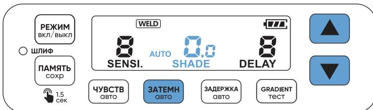
Зажатием на 1,5 секунды кнопки **ЗАТЕМН АВТО** активируете автопилот затемнения. Включенный автопилот затемнения отобразится на
