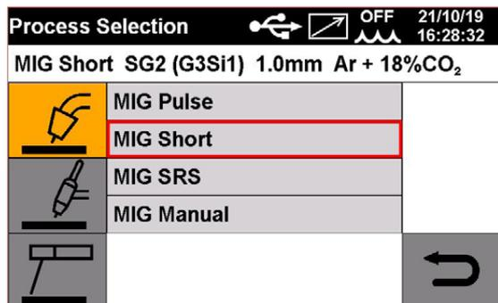
В столбике слева выбирается сварочный процесс: MIG/MAG, TIG, MMA. Выбранный процесс подсвечивается желтым цветом. Выбор осуществляется нажатием на соответствующее изображение. При выборе процесса MIG/MAG, появляются варианты выбора режима сварки: MIG Pulse, MIG Short, MIG SRS, MIG Manual.
