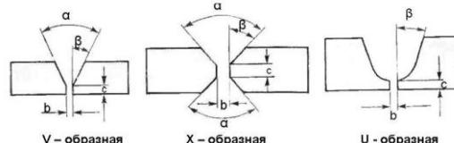
X – образная разделка кромок по сравнению с V – образной позволяет уменьшить объем наплавляемого металла в 1.6 – 1.7 раза.
