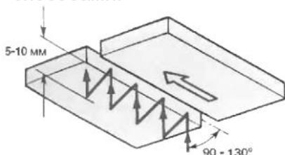
**Лесенкой.** Электрод располагают под углом к плоскости 90-130°, подводят к изделию и зажигают дугу. После образования маленькой порции расплавленного металла электрод отводят на 5-10мм от потолочной плоскости и возвращают, перекрывая закристаллизовавшуюся порцию металла расплавленным примерно на 1/2 – 1/3 ее длины.
