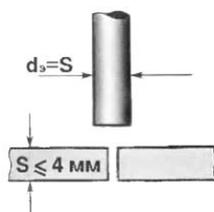
Листы без скоса кромок толщиной 2-8 мм сваривают двусторонним швом, а до 6 мм - односторонним
