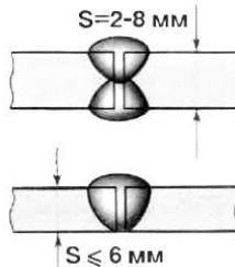
Металл толщиной более 8мм сваривают с разделкой кромок. Во избежание прожогов сварку ведут на съемных медных или стальных пластинах.
