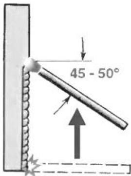
Вертикальные швы выполняют с током на 10% меньшим, чем при сварке в нижнем положении. Чтобы металл не вытек из ванны, нужно поддерживать короткую дугу. Используются электроды, дающие тонкий слой шлака.
