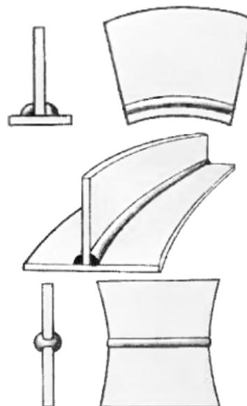
Литейная усадка происходит при остывании металла. Металл становится более плотным, его объем уменьшается, и в сварном соединении возникают внутренние напряжения. Из-за продольных напряжений изделие коробится в продольном направлении, а поперечные приводят, как правило, к угловым деформациям – короблению в сторону большего объема расплавленного металла.
