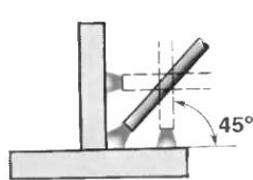
Угловые швы без скоса кромок с катетами более 10 мм выполняют в один слой поперечными движениями электрода треугольником с задержкой в корне шва.
