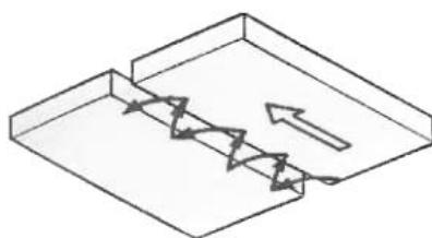
**Полумесяцем.** Электрод располагают под прямым углом 90-130° к потолочной плоскости и, манипулируя по схеме полумесяца, беспрерывно заходят электродом на закристаллизовавшуюся часть металла.
