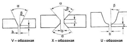
X – образная разделка кромок по сравнению с V – образной позволяет уменьшить объем наплавляемого металла в 1.6 – 1.7 раза.
