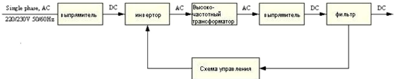
Управление количеством передаваемой энергии осуществляется в узле инвертора с помощью регулирования длительности полуволн напряжения – широтно-импульсной модуляции (ШИМ). Задание для узла инвертора формирует система управления источника. Система управления величины сварочного тока и напряжения, сравнивает их с требуемыми выходными характеристиками источника и меняет количество передаваемой энергии.
