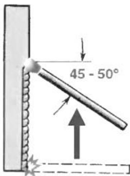
Вертикальные швы выполняют с током на 10% меньшим, чем при сварке в нижнем положении. Чтобы металл не вытекал из ванны, нужно поддерживать короткую дугу. Используются электроды, дающие тонкий слой шлака.
