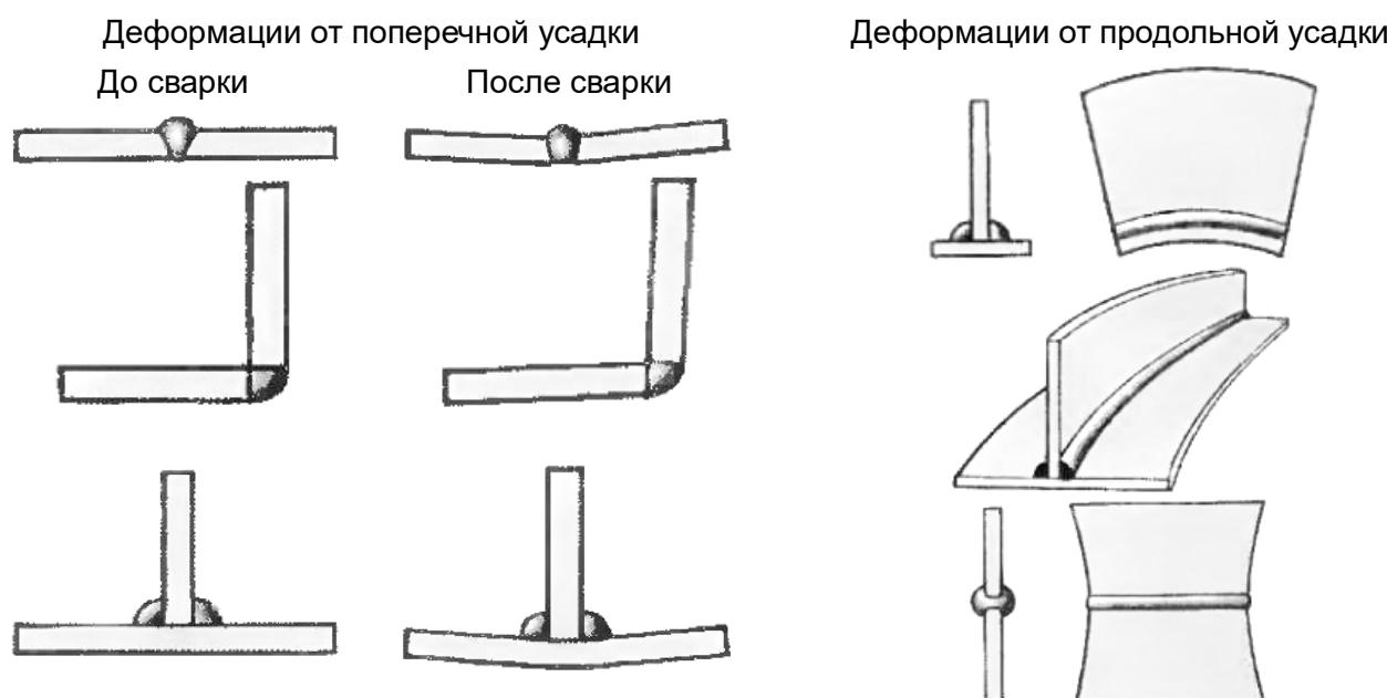
Литейная усадка происходит при остывании металла. Металл становится более плотным, его объем уменьшается, и в сварном соединении возникают внутренние напряжения. Из-за продольных напряжений изделие коробится в продольном направлении, а поперечные приводят, как правило, к угловым деформациям – короблению в сторону большего объема расплавленного металла.
