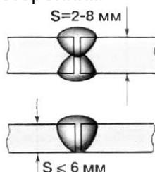
Металл толщиной более 8мм сваривают с разделкой кромок. Во избежание прожогов сварку ведут на съемных медных или стальных пластинах.
