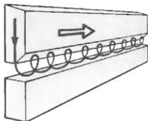
При сварке горизонтальных стыковых швов необходим скос только верхней кромки. Дугу возбуждают на нижней горизонтальной кромке (1), а затем электрод переводят на верхнюю (2). Сварку можно вести вертикально расположенным электродом, а также углом вперед и углом назад.
