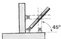
Угловые швы без скоса кромок с катетами более 10 мм выполняют в один слой поперечными движениями электрода треугольником с задержкой в корне шва.
