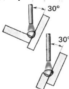
Во избежание непровара и подрезов кромок сварку «в лодочку» лучше вести электродом, допускающим опирание покрытия на кромки
