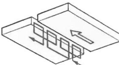
**Обратнопоступательно.** Концом электрода сварщик беспрерывно возвращается назад, на кристаллизирующуюся часть металла, постоянно удлиняя валик.
