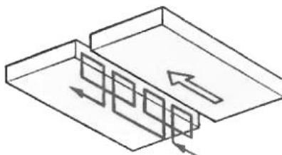
**Обратнопоступательно.** Концом электрода сварщик беспрерывно возвращается назад, на кристаллизующуюся часть металла, постоянно удлиняя валик.
