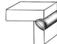
с двумя скосами одной из кромок
