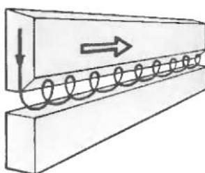
При сварке горизонтальных стыковых швов необходим скос только верхней кромки. Дугу возбуждают на нижней горизонтальной кромке (1), а затем электрод переводят на верхнюю (2). Сварку можно вести вертикально расположенным электродом, а также углом вперед и углом назад.
