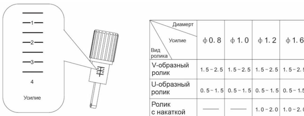
(Рис. 30) Усилия зажатия подающих роликов
