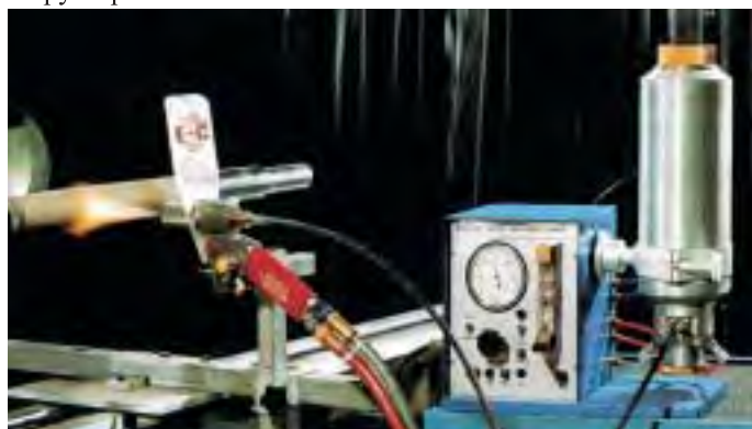
Горелка CDS 8000 с наружным дозатором порошка, предназначенная для выполнения больших или повторяемых работ.
