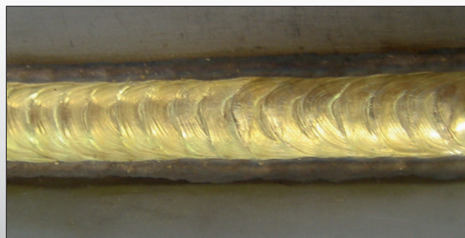
ПАЙКА-СВАРКА ПРИ ПОМОЩИ ПРОВОЛОКИ CuAl 8 BRAZING WITH CuAl 8 WIRE
