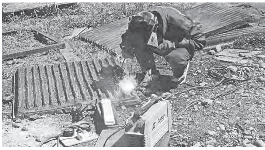
Наплавка плит дробилок из стали Гадфильда с помощью электродов **ОК 86.28**.
