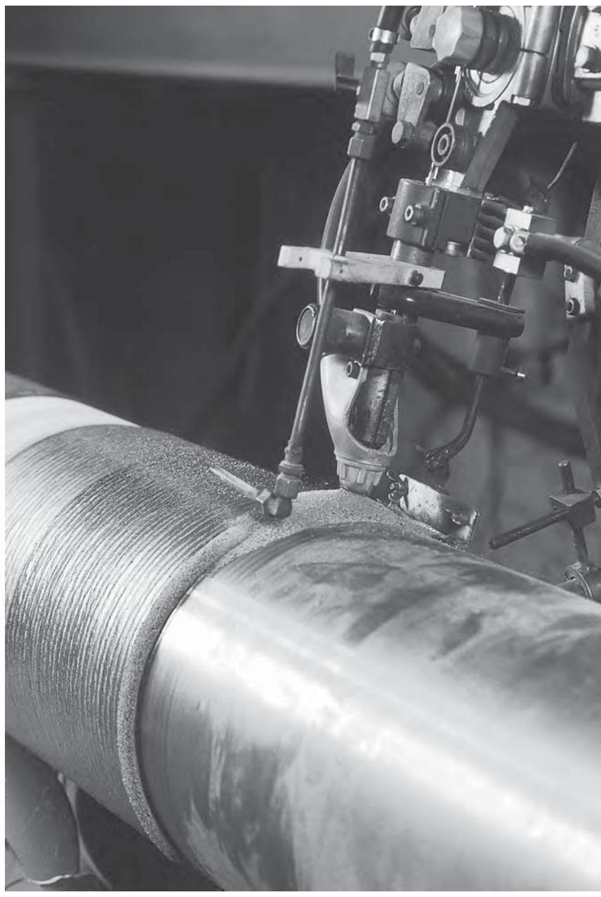
Наплавка ролика проволокой **OK Tubrodur 15.72S** под флюсом **OK Flux 10.33** на автомате марки А6 HD SAW фирмы ESAB для сварки под флюсом.
