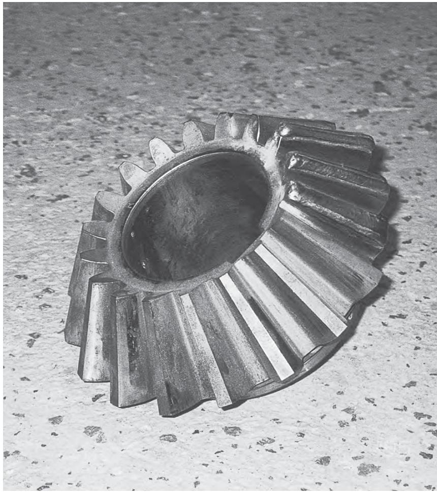
Коническая шестерня, наплавленная электродами **OK 68.82**.
