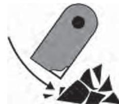
Металлические детали деформируются, частично ломаются и даже полностью разрушаются, если их поверхности не защищены от воздействия ударного износа.
