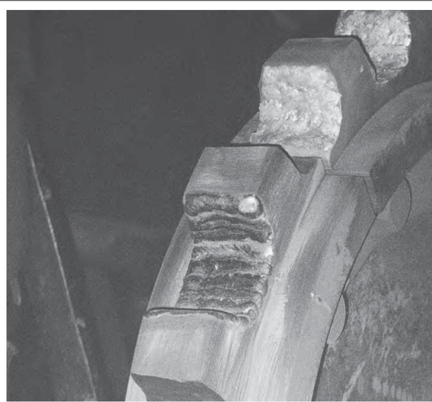
Зубчатое колесо, наплавленное электродами **ОК 83.28**.
