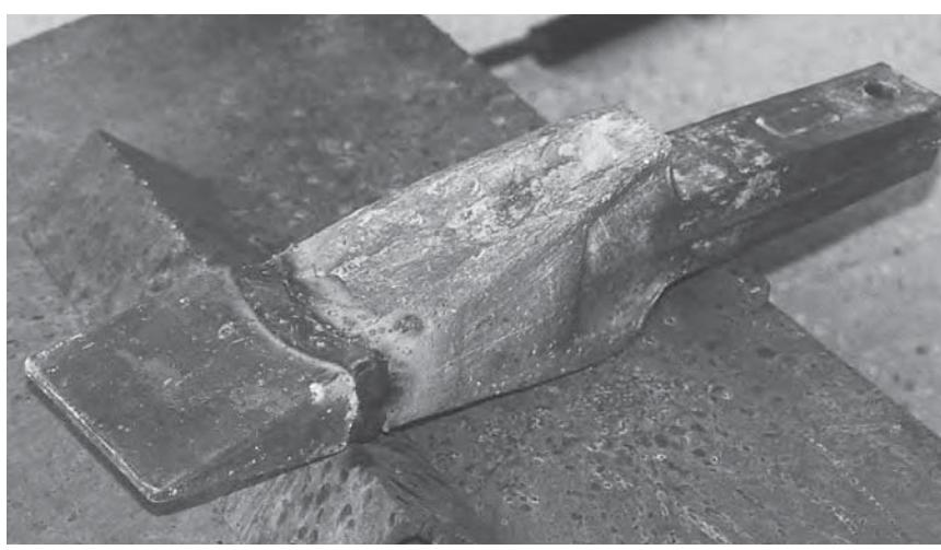
Новая рабочая часть подбойки, приваренная с помощью электродов **ОК 67.45** и проволоки **OK Tubrodur 14.71**.
