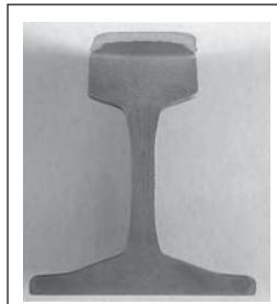
Головка рельса, наплавленная
