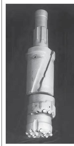
Бур до наплавки.
