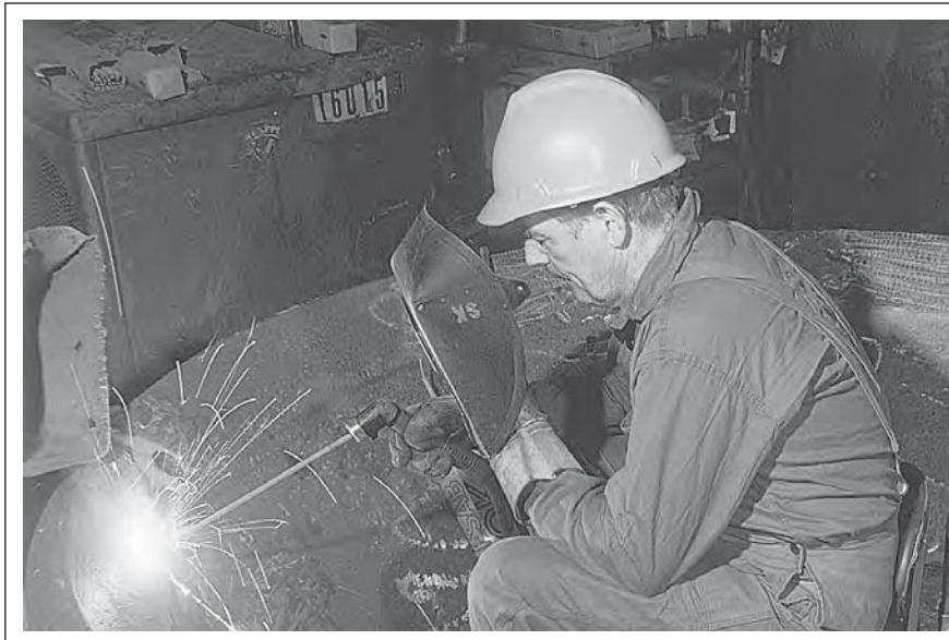
Ремонт дробилки из стали Гадфильда с помощью электродов **ОК 86.08**.
