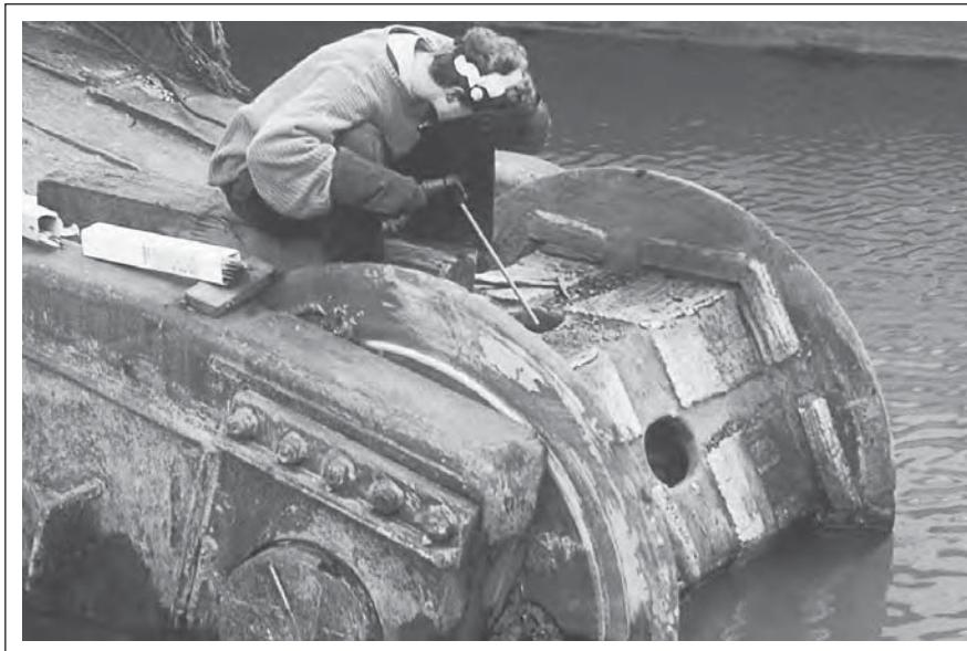
Восстановление барабана электродами **ОК 83.28** с последующей упрочняющей наплавкой электродами **ОК 84.84**.
