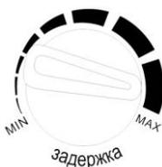
Позволяет увеличить время просветления после окончания сварки. Это особенно удобно для защиты глаз от «послесвечения» горячего металла/шлака после сварки на больших токах. Можно выставить короткую задержку MIN (0.1 сек) или длинную MAX (1.0 сек).
