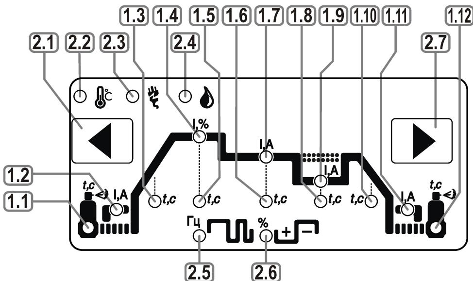
Индикаторы **2.2**, **2.3** и **2.4**, расположенные сверху на диаграмме сварки, предназначены для информирования персонала, работающего с данным выпрямителем, о возможных неисправностях, возникающих в процессе работы аппарата. Мигающий индикатор **2.2** означает, что температура
