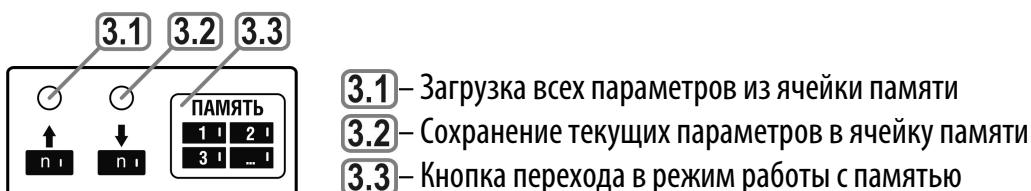
При необходимости, можно сохранить все настроенные режимы и параметры в одну из десяти ячеек памяти для дальнейшего использования. Если вы зашли в секцию «Память», а необходимость в записи/сохранении состояния панели управления отпала, то необходимо нажать кнопку «Память» один или два раза для перехода на диаграмму сварки – должен загореться индикатор одного из параметров диаграммы сварки.
