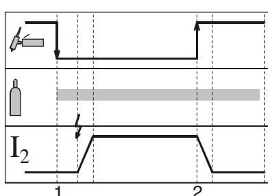
1. Поднести вольфрамовый электрод на расстояние 2–3 мм от детали. Нажать кнопку горелки. Подается защитный газ. После обдува газом дуга возбуждается высоковольтным импульсом, далее процедура сварки продолжается в соответствии с выбранным режимом работы.
