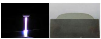
Сфокусированная плазменная дуга , снижает растворение наплавляемого металла, улучшает качество покрытия, не дает брызг при сварке , тем самым повышая качество и снижая стоимость работ по сварке и наплавке
