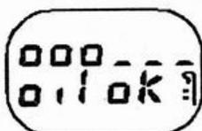
Если уровень масла достиг минимальной величины, то после включения зажигания в течение 30 секунд будет мигать сообщение **oil** и прочерки. Одновременно загорается индикатор, предупреждающий о необходимости обслуживания в сервисе (SERV), который продолжает гореть и после запуска двигателя.
