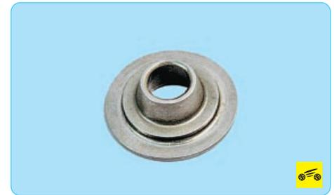
31. Проверьте состояние тарелок пружин. Замените тарелки со значительным износом опорных канавок под пружины.
