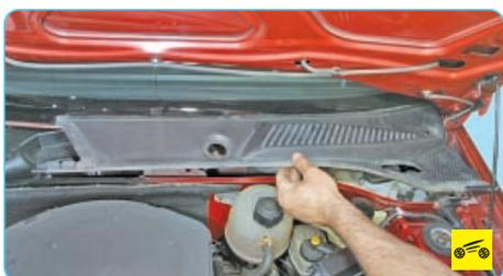
4. Снимите левую часть решетки корпуса воздухопритока (см. «Снятие и установка решетки корпуса воздухопритока», с. 249).
