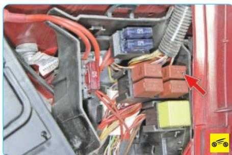
4. Отключите топливный насос, вынув его реле в монтажном блоке, установленном в подкапотном пространстве автомобиля.
