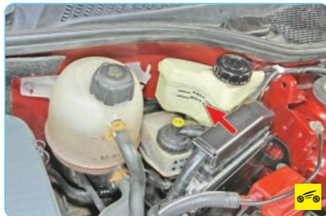
7. Проверьте уровень рабочей жидкости в бачке гидроусилителя рулевого управления. При необходимости доведите его до нормы.
