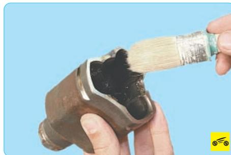
12. Если шарнир разбирали только для замены чехла, удалите из него старую смазку, промыв керосином или бензином внутреннюю полость корпуса шарнира...
