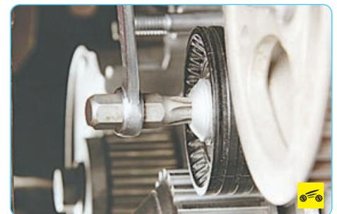
11. Выверните болт крепления промежуточного ролика ремня привода газораспределительного механизма...
