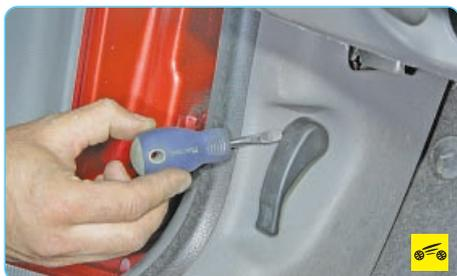
2. Поддев отверткой рукоятку привода замка капота...
