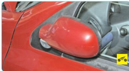
Для уменьшения габарита автомобиля при парковке в местах с интенсивным движением наружное зеркало можно сложить, повернув на шарнире рукой назад...
