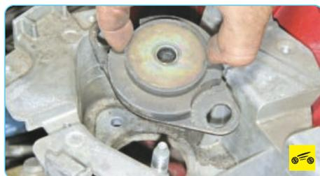
18. Снимите подушку левой опоры подвески силового агрегата.
