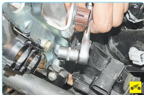
33. Выверните болт крепления «массового» провода...
