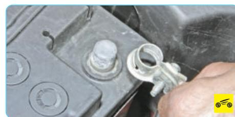
3. ...и отсоедините провод от клеммы «минус» аккумуляторной батареи.
