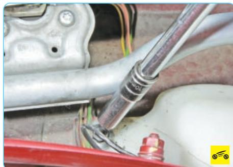
5. Выверните болт крепления бачка стеклоомывателя.
