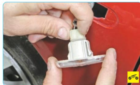
4. Поверните патрон против часовой стрелки...
