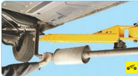
5. Снизу автомобиля отсоедините крепления системы выпуска отработавших газов (см. «Замена элементов системы выпуска отработавших газов», с. 126) и отведите ее в сторону.
