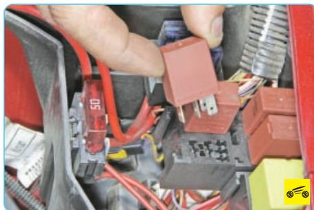
10. При необходимости замены извлеките реле из монтажного блока, покачивая его из стороны в сторону, и установите новое реле.
