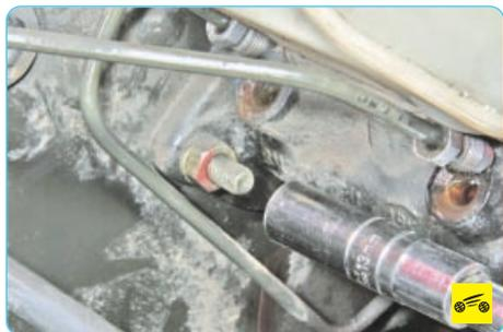
7. Отверните две гайки крепления главного тормозного цилиндра к вакуумному усилителю...
