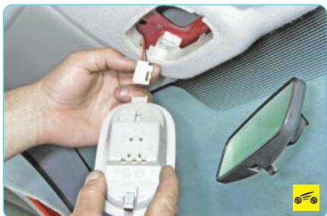
5. ...отсоедините колодку от плафона и снимите плафон.
