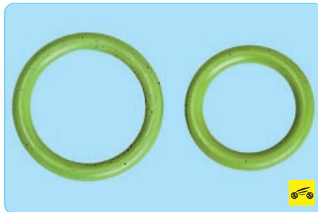
В местах соединений отдельных элементов системы установлены уплотнительные кольца круглого сечения из неопрена. Во время ремонта системы при разъединении участков трубопроводов уплотнительные кольца подлежат обязательной замене. Резьбовые соединения трубопроводов затягивайте рекомендуемым моментом. Слабая или излишне сильная затяжка приводит к деформации уплотняемых поверхностей и утечке хладагента.
