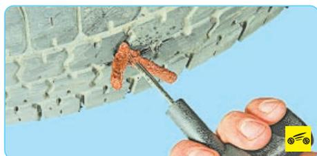
10. Нажатием на рукоятку иглы протолкните жгут в отверстие так, чтобы снаружи остались оба конца жгута длиной около 10 мм.
