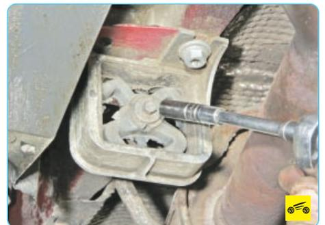
2. Выверните болт крепления кронштейна основного глушителя к подушке.
