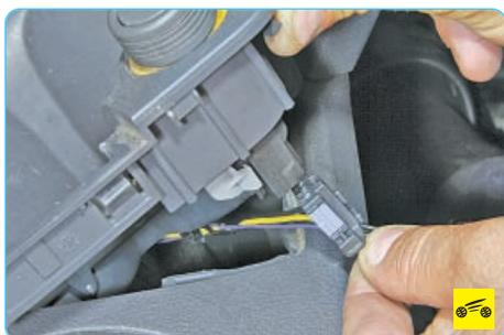
4. Нажмите на фиксатор колодки жгута проводов прикуривателя, отсоедините колодку...
