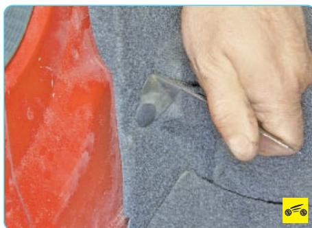
9. Поддев отверткой по одному пистону крепления боковых облицовок багажника с обеих сторон автомобиля, извлеките пистоны...
