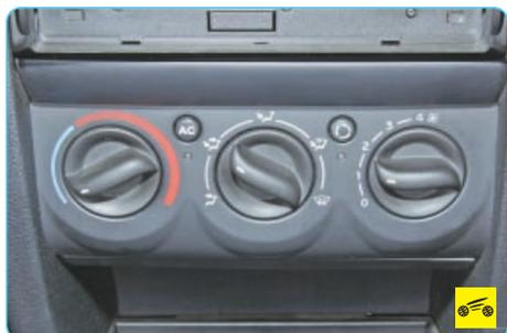
**Блок управления** системой отопления, кондиционирования и вентиляции салона автомобиля установлен на консоли панели приборов.
