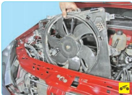
5. Снимите вентилятор системы охлаждения двигателя (см. «Снятие и установка электровентилятора радиатора системы охлаждения двигателя в сборе с кожухом», с. 109).
