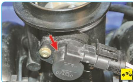
Специфической причиной рывков при установленном движении автомобиля с инжекторным двигателем может быть выход из строя датчика положения дроссельной заслонки. Дополнительными симптомами, подтверждающими неисправность этого датчика, являются:
