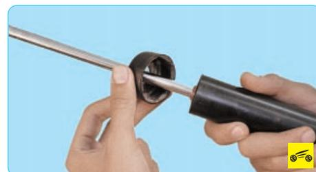
13. Снимите защитный колпачок.
