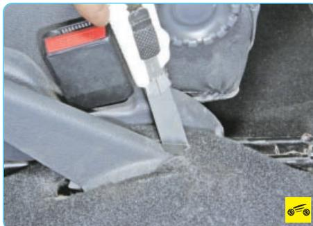
7. Аккуратно разрежьте коврик пола в задней части рычага привода стояночного тормоза...
