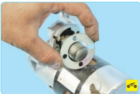
6. Снимите промежуточную шайбу.
