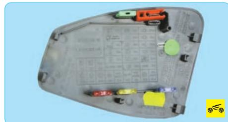
На внутреннюю поверхность крышки нанесена схема расположения предохранителей.
