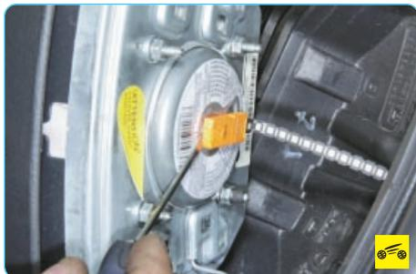
7. Подденьте отверткой колодку жгута проводов модуля подушки безопасности водителя...
