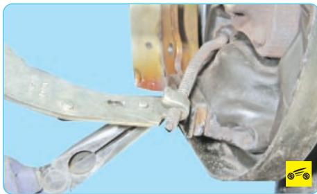
23. Отведите заднюю колодку от щита тормоза, отожмите пассатижами пружину вдоль троса привода стояночного тормоза...
