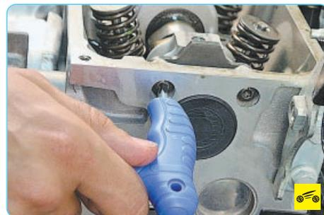
9. На заднем торце головки блока выверните два винта крепления упорного фланца распределительного вала...
