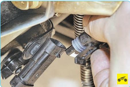
13. Разъедините колодку жгута проводов датчика концентрации кислорода...
