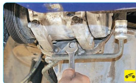
12. ...болт крепления кронштейна компрессора кондиционера к масляному картеру, которым одновременно закреплен второй держатель трубопровода...
