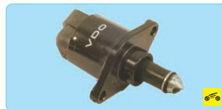
**Регулятор холостого хода** поддерживает заданную частоту вращения холостого хода двигателя при полностью закрытой дроссельной заслонке во время его пуска, прогрева и при изменении нагрузки во время включения вспомогательного оборудования.
