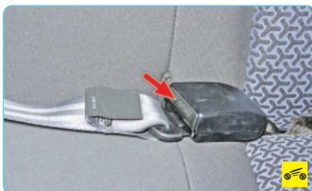
1. Нажмите на фиксатор замка крепления ремня безопасности центрального заднего пассажира и отсоедините пряжку ремня от замка.
