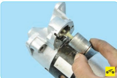
7. Снимите с рычага привода сердечник тягового реле.
