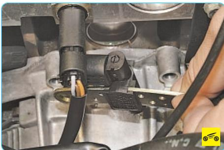
4. ...и снимите датчик.
