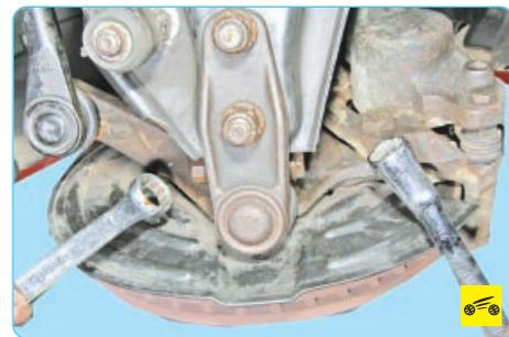
3. Удерживая головку стяжного болта крепления от проворачивания, ослабьте затяжку и снимите гайку...
