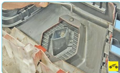
20. При необходимости выверните винт крепления заводского знака...
