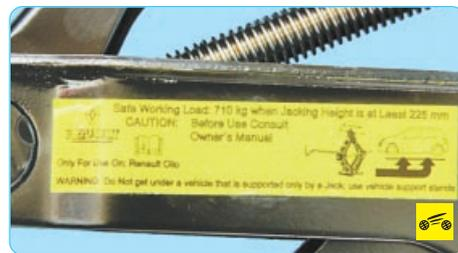
На домкрат наклеена табличка с указанием приемов установки его под автомобиль.
