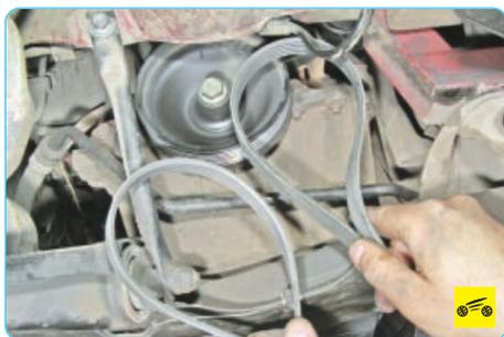
4. Снимите ремень привода вспомогательных агрегатов (см. «Замена ремня привода вспомогательных агрегатов», с. 75).
