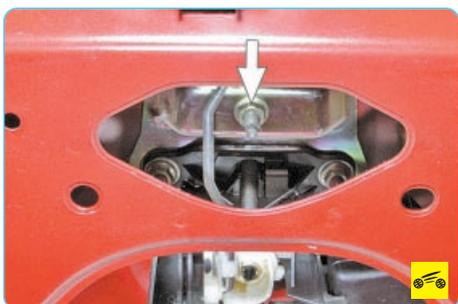
9. Отверните гайку шпильки крепления кронштейна привода замка крышки багажника...
