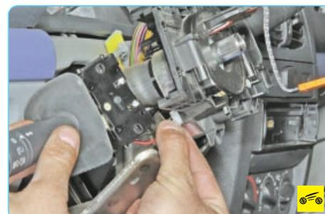
10. ...отведите переключатель в сторону, отожмите фиксатор колодки проводов, расположенный в нижней части контактного кольца...
