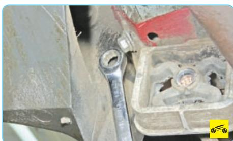
2. Ослабьте два болта крепления подушки к кузову...
