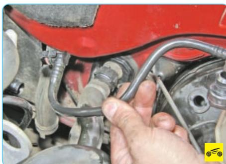
7. ...и снимите шланг в сборе с обратным клапаном.
