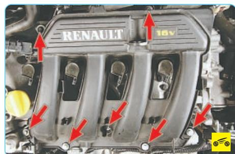
14. Выверните семь болтов крепления ресивера к крышке головки блока цилиндров...
