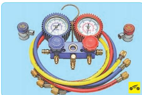
– прецизионные манометрические блоки со специальными соединительными накопниками;
