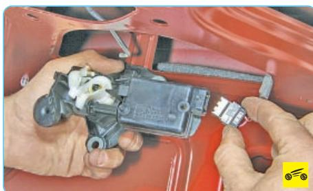
3. Отсоедините колодку жгута проводов от привода замка крышки багажника (для наглядности показано на снятом приводе замка крышки багажника).
