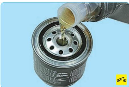
7. Заполните новый фильтр примерно на 1/3 объема чистым моторным маслом.
