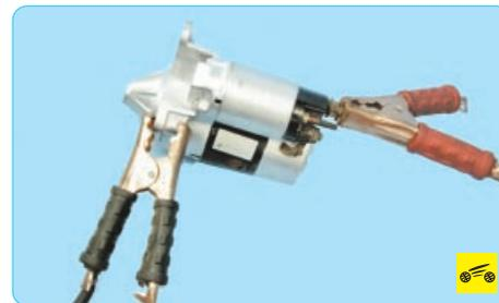
4. Отсоедините провод от управляющего вывода тягового реле и подсоедините к контактному болту тягового реле. Якорь стартера должен начать вращаться с частотой более 2000 мин<sup>-1</sup>. В противном случае отремонтируйте стартер.
