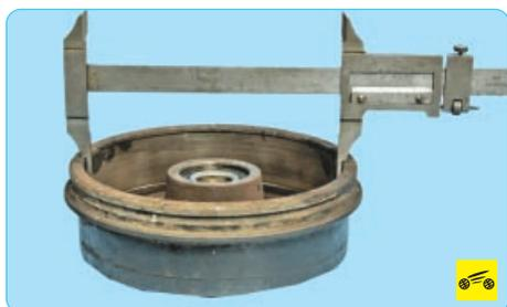
7. Измерьте диаметр рабочей поверхности тормозного барабана. Если он больше предельно допустимого (см. табл. 9.1), замените барабан (см. «Снятие и установка тормозного барабана», с. 193).
