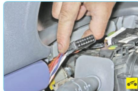
7. Аналогично отсоедините колодки жгутов проводов от подрулевого переключателя наружного освещения и указателей поворота...
