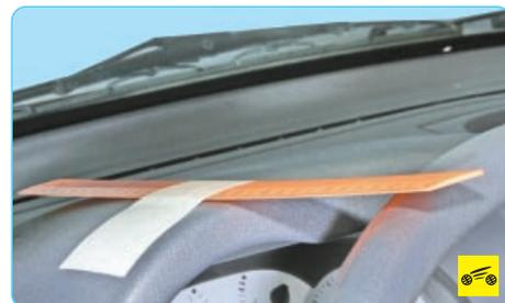
2. Установите линейку так, чтобы ее торец упирался в панель приборов, а плоскость линейки касалась наружной поверхности обода рулевого колеса.
