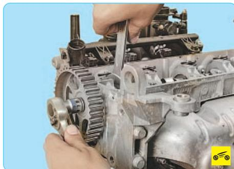
5. ...выверните болт крепления зубчатого шкива распределительного вала...
