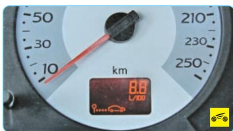
– в режиме **среднего расхода топлива** отображается среднее потребление топлива, рассчитанное по количеству потребляемого топлива и пройденного расстояния с момента подключения аккумуляторной батареи или обнуления данных. После обнуления счетчика примерно в течение 1 мин на дисплее будет отображаться надпись «---L/100», затем начнется пересчет и отображение среднего расхода топлива. Рабочий диапазон счетчика от 0,0 до 99,9 L/100;
