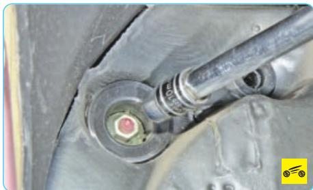
4. Отверните гайку крепления верхнего держателя левой части шумоизоляционной накладки...
