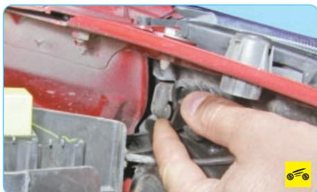
2. Поверните патрон лампы против часовой стрелки...
