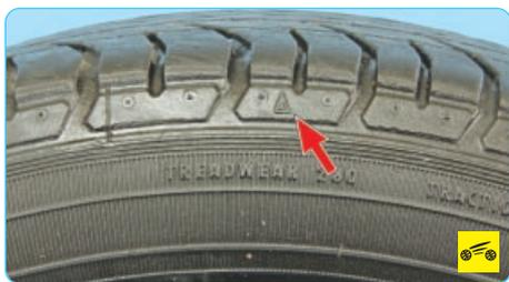
**TWI** (Tread Wear Index) или символ треугольной формы указывает место расположения индикаторов износа...
