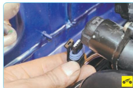
6. ...и отсоедините колодку жгута проводов от регулятора холостого хода.
