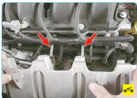
– аккуратно снимите защиту топливной рампы со шпилек (указаны стрелками).
