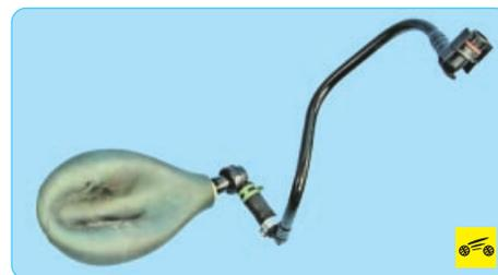
8. Наденьте на штуцер обратного клапана (которым клапан вставляется в усилитель) резиновую грушу и сожмите ее. Воздух из груши должен выйти через клапан.
