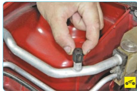
Клапаны закрыты резьбовыми колпачками для предохранения их от попадания грязи.
