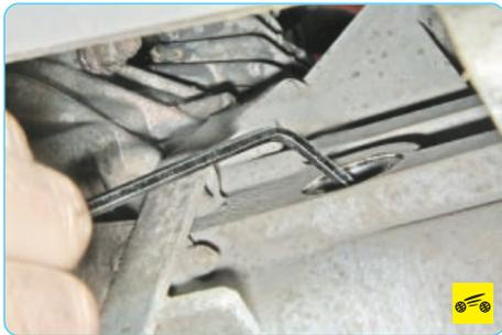
2. Проверьте уровень масла: он должен быть у нижней кромки наливного отверстия...
