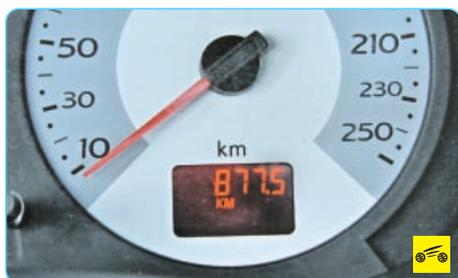
– в режиме **счетчика суточного пробега** отображается суммарный пробег автомобиля с момента последнего обнуления счетчика. Рабочий диапазон счетчика от 0,0 до 999,9 км;
