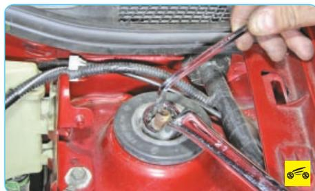
7. Проверьте затяжку гайки верхнего крепления амортизаторной стойки.
