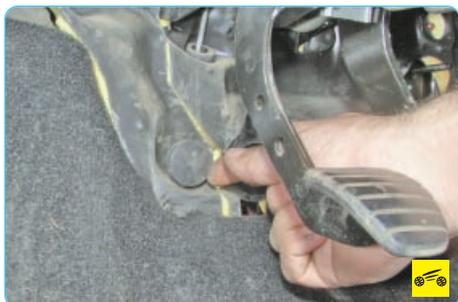
6. Поддев край защитного колпачка нижнего держателя левой стороны шумоизоляционной накладки...
