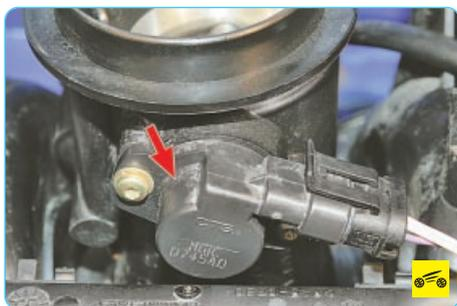
– **датчик положения дроссельной заслонки** (установлен на дроссельном узле) – потеря мощности, рывки и провалы при разгоне, неустойчивая работа в режиме холостого хода;
