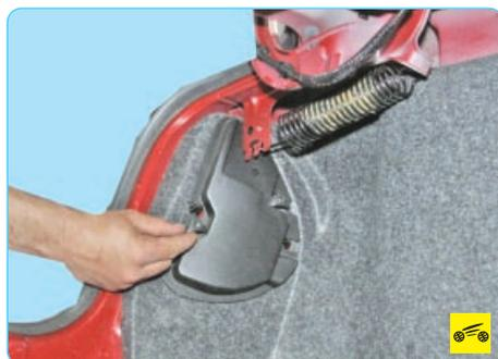
1. Отверните две гайки-барашка крепления крышки технологического окна в обивке багажника и в кузове.
