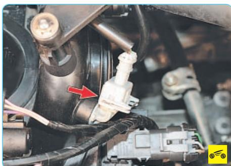
– **датчик температуры всасываемого воздуха** – при отказе датчика увеличивается расход топлива, повышается уровень токсичности отработавших газов;
