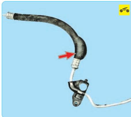
Периодически проверяйте состояние гибких вставок трубопроводов, при наличии трещин, выпуклостей, потертостей замените трубопровод.
