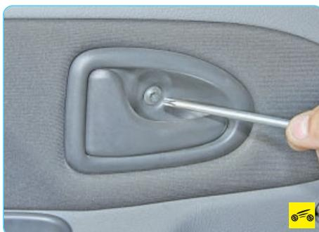
1. Выверните болт крепления внутренней ручки задней двери.
