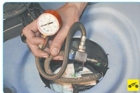
3. Для проверки давления топлива подключите манометр (с пределом измерения не менее 5 кгс/см<sup>2</sup>) между топливным насосом и напорным трубопроводом. При работающем на холостом ходу двигателе давление в топливопроводе должно быть около 3 кгс/см<sup>2</sup>.
