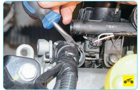
13. Отстегнув отверткой верхние держатели моторного жгута спереди...
