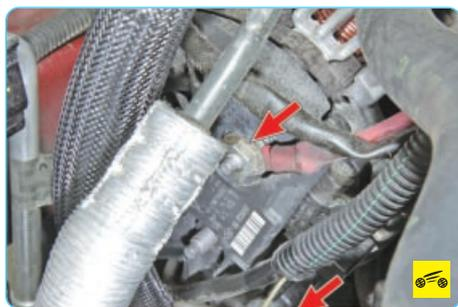
6. ...и генератору. Провода могут быть оборваны, обломаны внутри изоляции или с окисленными или ненадежными контактами. Устраните неисправность и пустите
