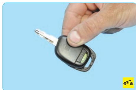
1. Сдвиньте крышку пульта с блоком управления относительно головки ключа, преодолевая сопротивление ее фиксаторов...
