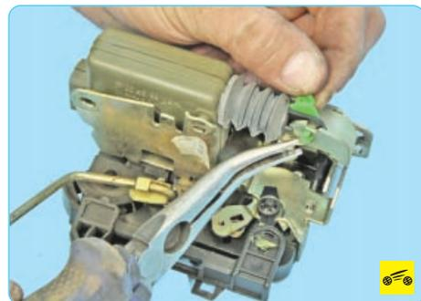
5. Сожмите усики фиксатора крепления штока привода к рычагу замка...
