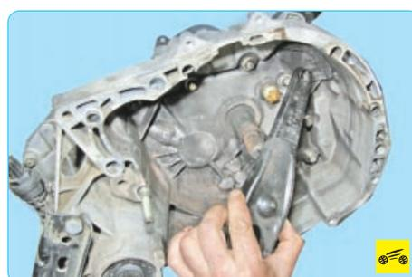
3. При необходимости замены вилки выключения сцепления снимите вилку выключения сцепления с шаровой опоры и извлеките ее из грязезащитного чехла.
