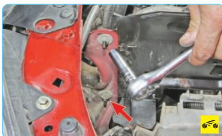
7. Отверните две гайки шпилек переднего крепления щитка аккумуляторной батареи к рамке радиатора.
