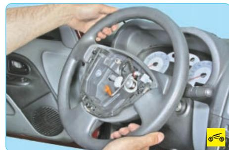
7. Резкими ударами рук сбейте рулевое колесо со шлицев рулевого вала.
