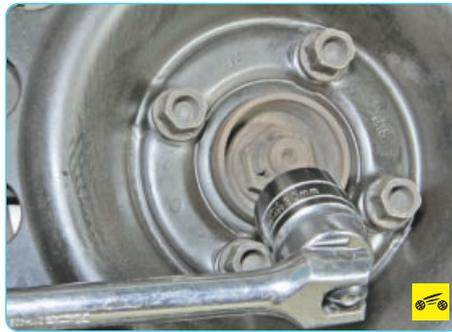
2. Ослабьте затяжку гайки ступицы и болтов крепления колеса. Приподнимите домкратом переднюю часть автомобиля и установите ее на опоры. Снимите колесо.
