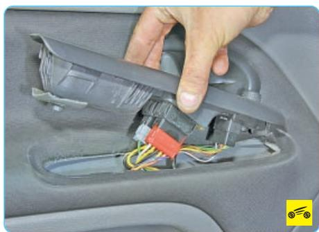
4. Извлеките блок переключателей управления электростеклоподъемниками дверей из проема обивки передней двери, сдвигая назад, и отведите его на длину присоединенных проводов.
