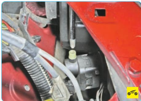
7. Откройте капот и, вращая регулировочные винты, отрегулируйте (если расположение световых пятен не соответствует рисунку) положение на экране светового пятна для каждой фары по вертикали...
