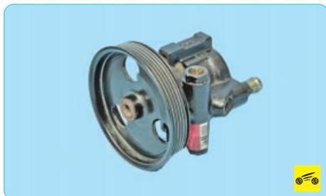
8. Установите насос в порядке, обратном снятию. Болты крепления насоса и гайку крепления напорного трубопровода затяните моментом 21 Н·м.
