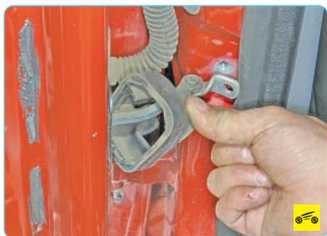
3. Подденьте резиновый уплотнитель ограничителя открывания задней двери и его сдвиньте по рычагу ограничителя.
