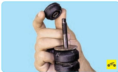
9. Снимите со штока амортизатора нижнюю резиновую подушку...
