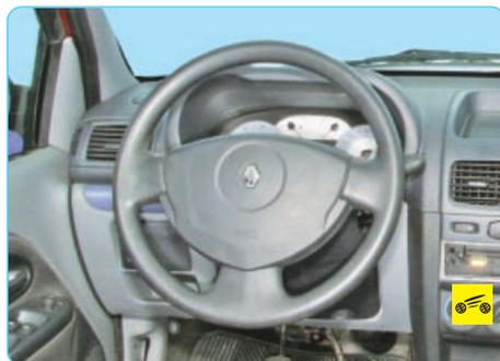
Рулевое колесо оснащено подушкой безопасности и выключателем звукового сигнала.
