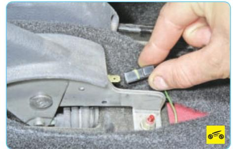
9. Отсоедините колодку провода от выключателя сигнальной лампы включения стояночного тормоза.
