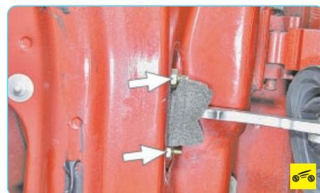
3. Отверните две гайки шпилек крепления ограничителя открывания передней двери к панели двери.
