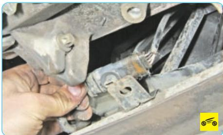
7. ...и извлеките держатель из отверстия в кронштейне подрамника.
