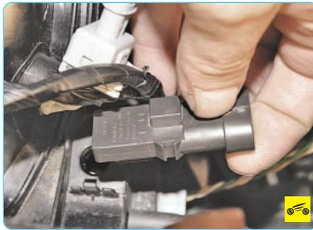
4. Аккуратно снимите датчик абсолютного давления, преодолевая сопротивление уплотнительных резиновых колец (штуцер датчика установлен с натягом в отверстии впускной трубы).
