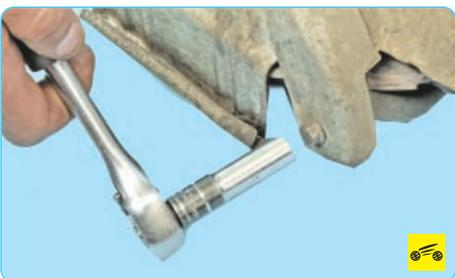
8. Выверните два болта крепления кронштейна к нейтрализатору.
