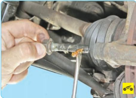
...смажьте его консистентной смазкой, а затем смажьте смазкой защитный чехол пальца. Аналогично смажьте второй направляющий палец и его чехол.
