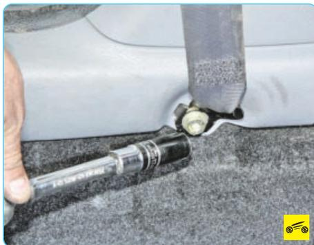
2. Выверните болт нижнего крепления ремня безопасности к кузову...
