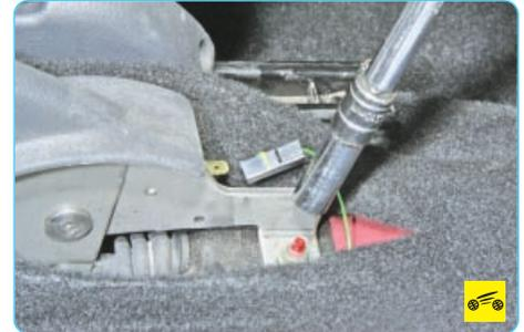
10. Отверните гайку заднего крепления кронштейна рычага привода стояночного тормоза к основанию кузова...
