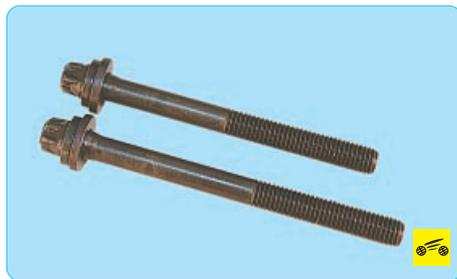
Болты крепления головки блока обязательно замените новыми. Повторное использование не допускается. Обратите внимание на то, что болты разной длины. При их снятии запомните расположение болтов и затем установите их на прежние места.
