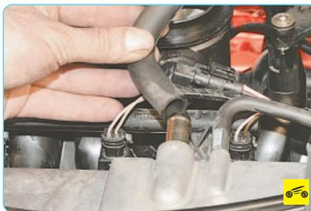
2. Отсоедините от патрубка крышки головки блока цилиндров отводящий шланг
