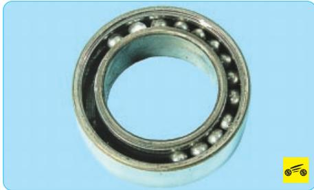
При необходимости замените подшипник, не дожидаясь его полного разрушения. Замена подшипника требует специального оборудования, поэтому при необходимости обратитесь в сервисный центр по обслуживанию автомобильных кондиционеров.
