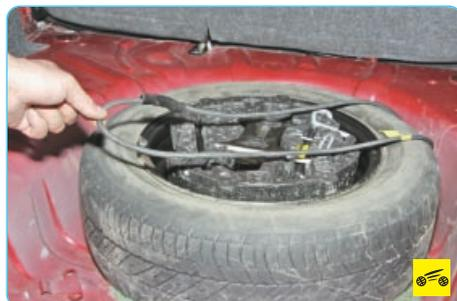
7. ...выведите фиксатор из держателя на кузове и снимите фиксатор с кассеты и запасного колеса.
