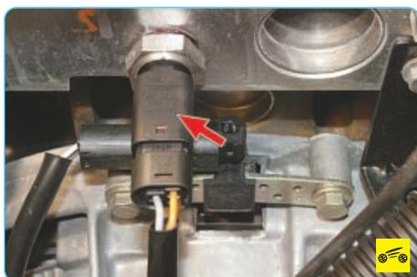
– **датчик температуры охлаждающей жидкости** – трудности с пуском в мороз, приходится прогревать двигатель, поддерживая обороты педалью акселератора, при перегреве существенно снижается мощность, возникает детонация;
