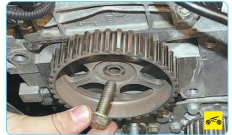
4. ...выверните болт из отверстия распределительного вала...
