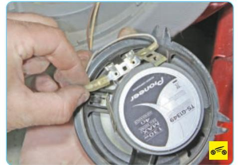
5. Отсоедините колодки жгута проводов от выводов динамика и снимите динамик аудиосистемы.
