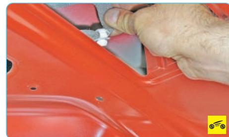
5. ...и протолкните держатель во внутреннюю полость крышки багажника. Аналогично извлеките из отверстия в крышке багажника второй держатель жгута проводов.
