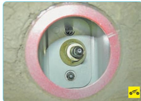
Под заглушками установлены гайки крепления левых салазок сиденья.
