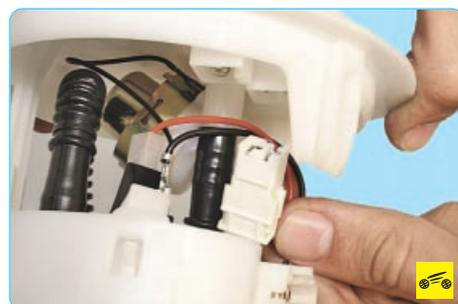
5. ...и колодку жгута проводов топливного насоса.
