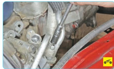
11. Выверните болт крепления фланца трубопровода линии высокого давления...
