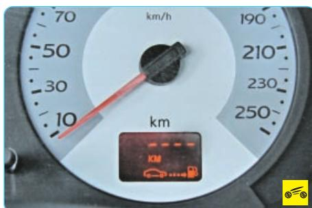
– в режиме отображения **расстояния, которое можно проехать на остатке топлива в баке**, выводится примерное расстояние, которое можно проехать на оставшемся в баке топливе с учетом средней скорости движения и текущего расхода топлива. Это расстояние повторно рассчитывается и обновляется каждую секунду;
