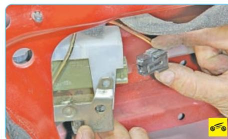
8. Нажмите на фиксатор колодки жгута проводов замка передней двери и отсоедините колодку от замка.
