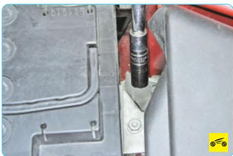
8. Выверните болт крепления прижимной пластины...
