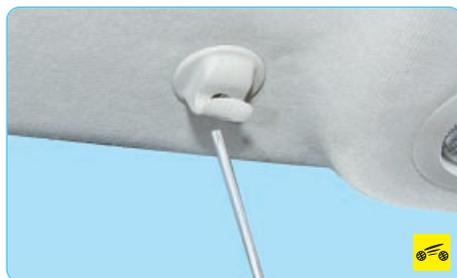
4. Выверните наполовину винт крепления держателя козырька...
