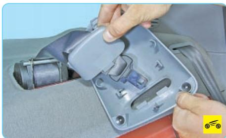
26. ...и снимите облицовку, пропустив в ее отверстие ремень безопасности.
