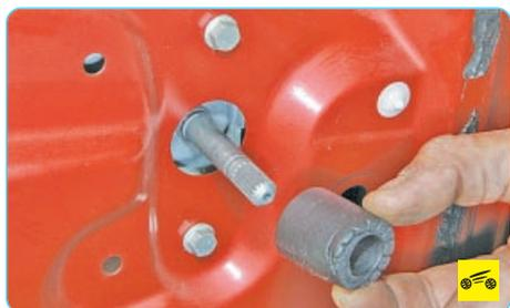
3. Снимите резиновую втулку с механизма стеклоподъемника задней двери.
