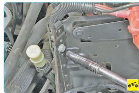
3. Выверните болт заднего крепления защитного щитка аккумуляторной батареи.
