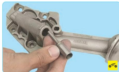
8. ...и плунжер редукционного клапана.
