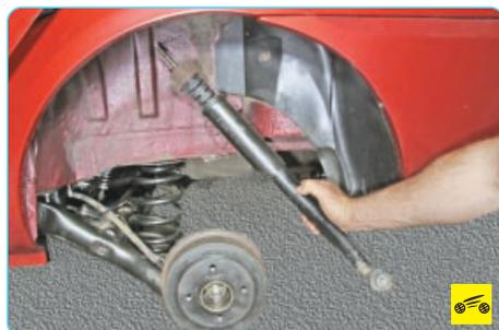
8. ...и снимите амортизатор с автомобиля.
