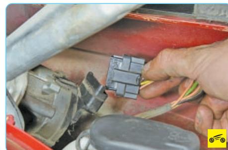
7. Извлеките трапецию из корпуса воздухопритока и разверните так, чтобы получить доступ к колодке жгута проводов. Отсоедините колодку жгута проводов от моторедуктора стеклоочистителя, нажав на ее фиксатор...
