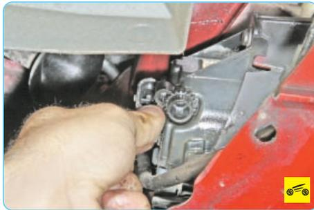
5. Поверните лампу против часовой стрелки...
