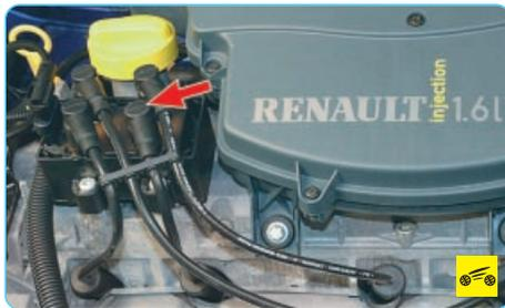
2. Проверьте исправность модуля зажигания (см. «Снятие и установка катушек зажигания», с. 211).
