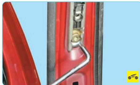
20. Выверните два болта крепления механизма регулирования ремня по высоте...
