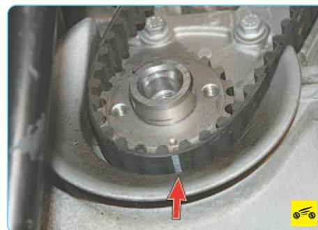
12. ...и шкив коленчатого вала, также совместив риску на ремне с установочной меткой на шкиве. После этого установите ремень на натяжной ролик.
