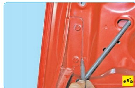
6. Если снимаете крышку багажника не для замены, пометьте ее положение относительно петель, например, обведя петли по контуру фломастером.
