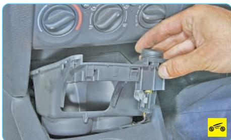
3. ...и извлеките их корпус из гнезда в облицовке тоннеля пола, преодолевая упругое сопротивление фиксаторов, на длину присоединенных проводов.
