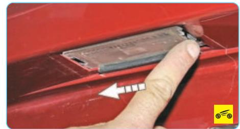
1. Сдвиньте в направлении, показанном стрелкой, фонарь освещения номерного знака...
