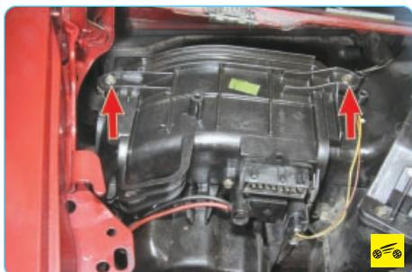
Так расположены винты крепления вентилятора отопителя к климатическому блоку.
