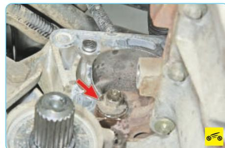
36. Отверните правую гайку крепления коробки передач к двигателю.
