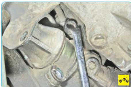
16. Выверните болт верхнего крепления рулевого механизма к подрамнику...
