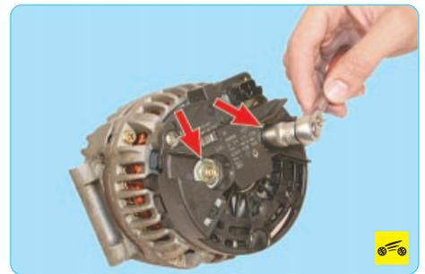
3. Отверните две гайки...
