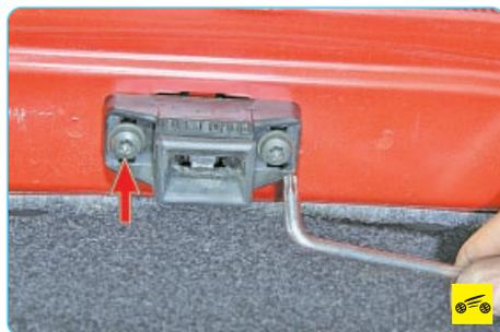
2. Выверните два болта крепления замка к внутренней панели крышки багажника.
