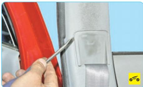
10. Подденьте отверткой заглушку проема ремня безопасности в центральной части облицовки центральной стойки кузова...
