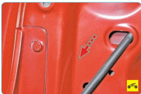
7. Извлеките жгут проводов из отверстия во внутренней панели крышки багажника.
