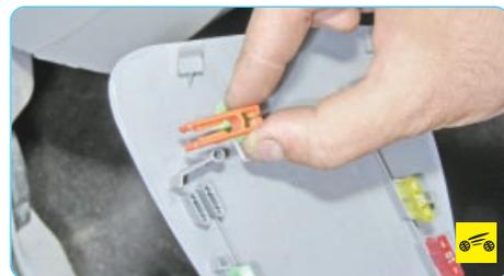
В специальных гнездах крышки монтажного блока закреплены запасные предохранители и пинцет для их замены.
