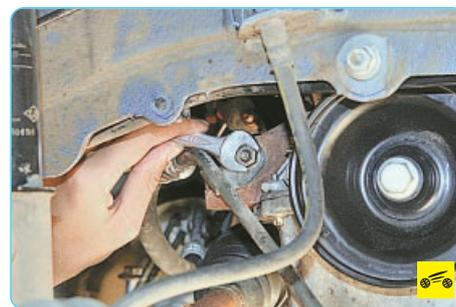
11. Выверните болт крепления держателя трубопровода к двигателю...
