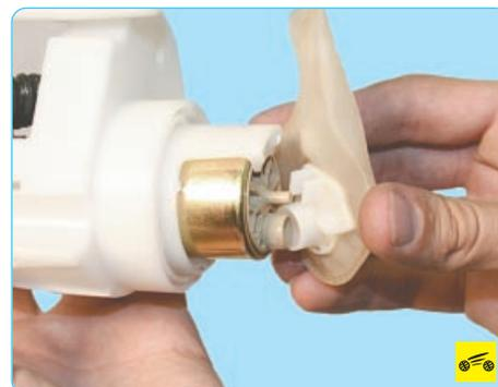
16. Преодолевав усилие фиксаторов, снимите сетчатый фильтр с топливоприемника.
