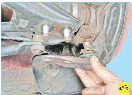
9. ...и снимите шаровую опору с рычага.
