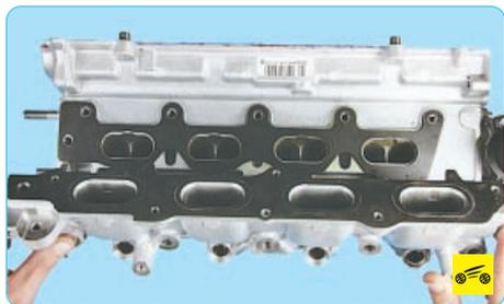
7. Снимите впускную трубу.
