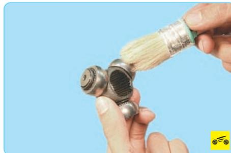
13. ...и ступицу. Просушите детали сжатым воздухом.
