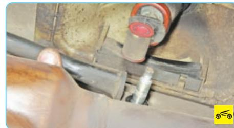
6. ...отсоедините тягу от рычага управления коробкой передач и снимите ее.
