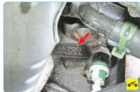
Модель и номер двигателя выбиты на приливе блока цилиндров в его левой задней части (рядом с датчиком сигнальной лампы аварийного падения давления масла):
