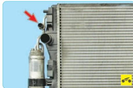
Датчик давления установлен в моторном отсеке с левой стороны над ресивером.
