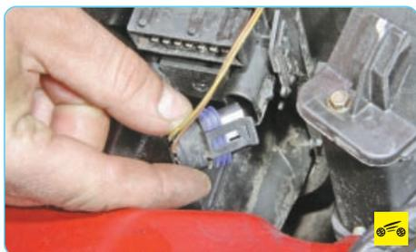
12. ...и отсоедините вторую колодку от разъема вентилятора отопителя.
