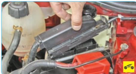
3. ...и отсоедините колодку жгута проводов от блока управления двигателем.
