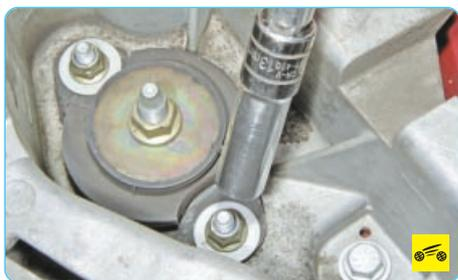
13. Отверните гайку шпильки крепления подушки левой опоры подвески силового агрегата к кронштейну кузова...
