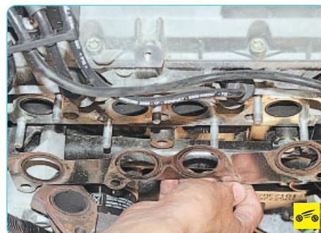
6. ...а затем и установленную под ним прокладку.
