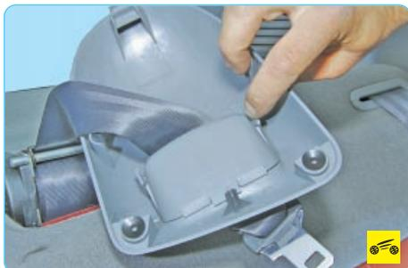
24. Разожмите фиксаторы окантовки отверстия в облицовке для прохода ремня безопасности...
