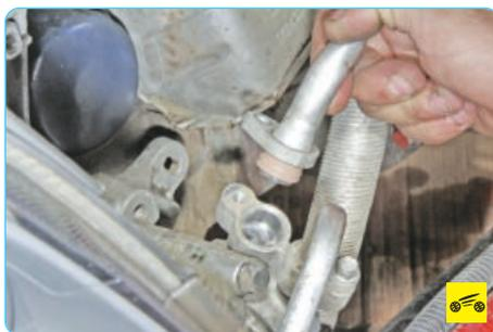
5. ...извлеките болт из отверстия и, отсоединив трубопровод от компрессора...
