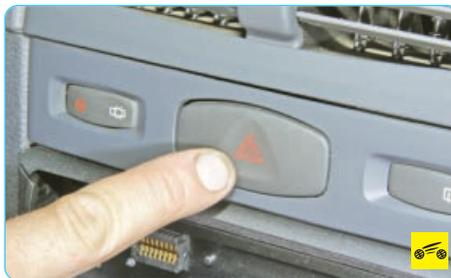
**18** – выключатель аварийной сигнализации. При нажатии на клавишу выключателя загораются мигающим светом все указатели поворота и их контрольные лампы, установленные в комбинации приборов. При повторном нажатии на клавишу сигнализация отключается.
