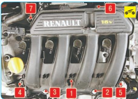
Рис. 5.10. Порядок затяжки болтов крепления ресивера
