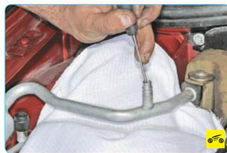
3. Проложите ветошь моторный отсек под сервисным клапаном, затем аккуратно нажмите тонкой отверткой с плоским лезвием на окончание золотника клапана и стравите хладагент из системы.
