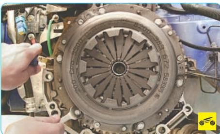
2. Удерживая маховик отверткой (или монтажной лопаткой) от проворачивания, выверните шесть болтов крепления кожуха нажимного диска сцепления к маховику. Затяжку болтов ослабляйте равномерно: каждый болт по одному обороту ключа, переходя от болта к болту по диаметру.
