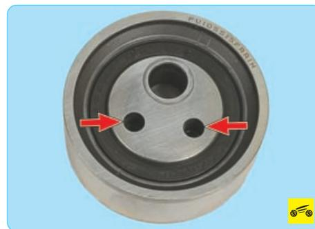
10. Установите новый натяжной ролик в порядке, обратном снятию. При этом отверстия под специальный ключ должны быть направлены наружу.
