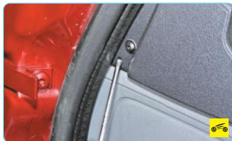
7. Выверните по одному винту бокового крепления верхней накладки панели приборов с обеих сторон.
