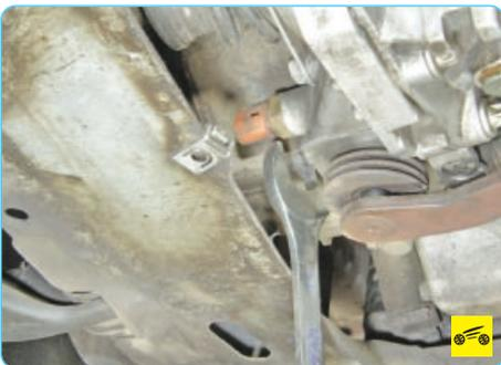
5. Ослабьте ключом затяжку и выверните выключатель света заднего хода из картера коробки передач.
