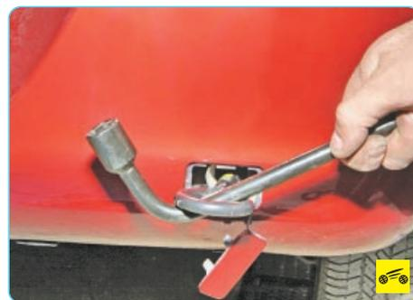
5. ...и затяните ее, используя ключ для болтов колес в качестве воротка.
