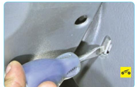
4. Вставьте отвертку в отверстие кожуха рулевого колеса...
