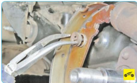
25. Снимите прижимную пружину и опорную стойку передней колодки так же, как это делали для задней колодки (пп. 20–22)...
