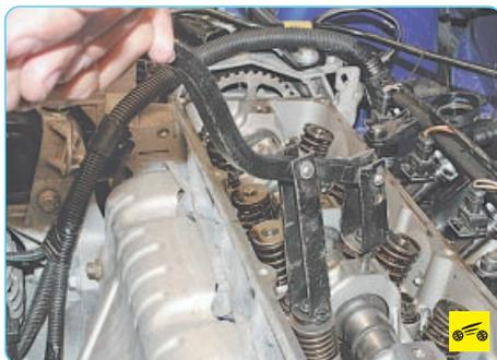
8. Установите приспособление для сжатия пружин клапанов, ввернув в одно из отверстий головки блока болт крепления оси коромысел клапанов и зацепив приспособление за этот болт.
