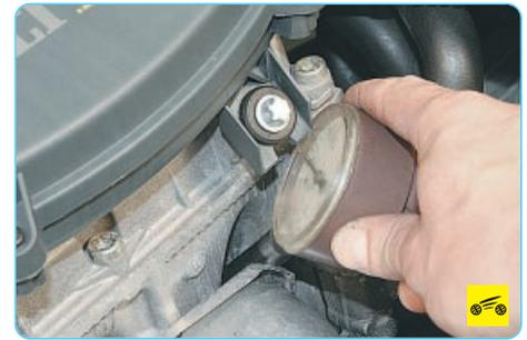
5. Вверните в свечное отверстие проверяемого цилиндра компрессометр.
