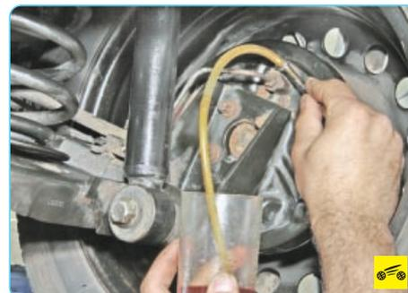
7. Отверните на 1/2–3/4 оборота клапан выпуска воздуха. Из шланга начнет вытекать старая (грязная) тормозная жидкость. Педаль тормоза в это время должна плавно дойти до упора. Как только жидкость перестанет вытекать, заверните клапан выпуска воздуха.
