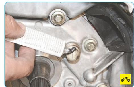
6. ...шаровую опору вилки выключения сцепления...
