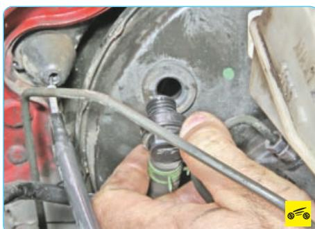
6. ...извлеките штуцер обратного клапана из корпуса вакуумного усилителя...
