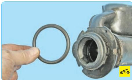
Уплотнительное кольцо наливной трубы заменяйте новым при каждой разборке соединения.
