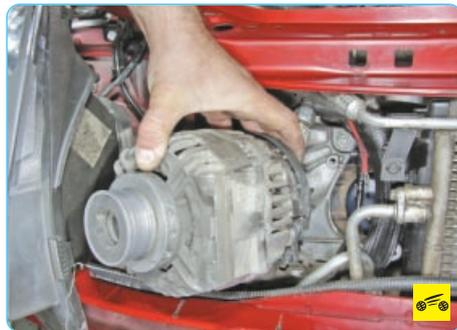
9. ...и снимите генератор
