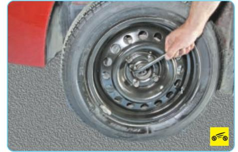
14. Опустите автомобиль и окончательно затяните болты штатным баллонным ключом. Затягивайте колесные болты крест-накрест. Во избежание повреждения диска колеса не пытайтесь «дотянуть» болты крепления колеса, нажимая ногой на рукоятку ключа.
