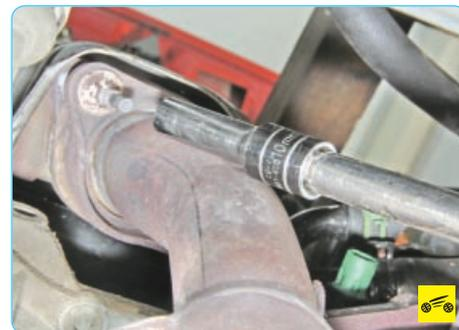
2. Отверните две гайки крепления каталитического нейтрализатора к выпускному коллектору.
