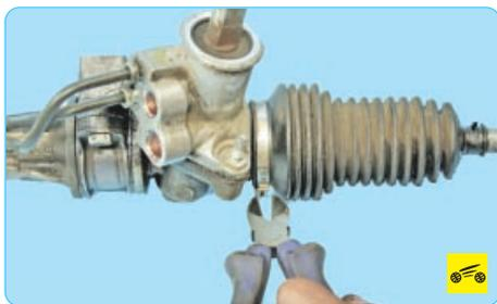
2. Бокорезами перекусите большой хомут крепления защитного чехла и снимите хомут (при установке замените хомут новым).
