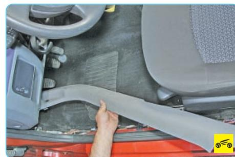
5. ...и снимите облицовку, преодолевая упругое сопротивление ее фиксаторов.
