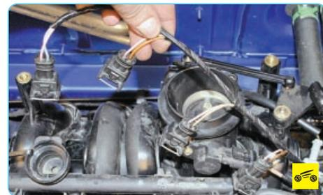
7. Отжав фиксаторы, отсоедините колодки жгута проводов от форсунок...
