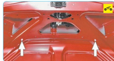
Так расположены держатели жгута проводов на внутренней панели крышки багажника.
