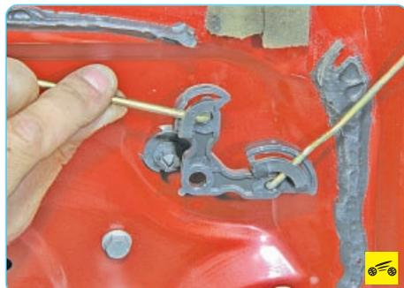
4. ...и снимите привод с направляющей.
