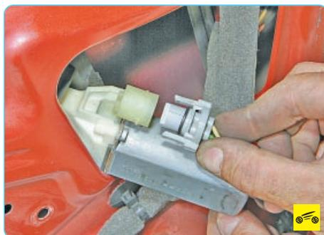
8. Отожмите фиксаторы колодки жгута проводов моторедуктора стеклоподъемника передней двери и отсоедините колодку от разъема моторедуктора.
