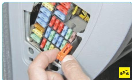
6. Захватите пинцетом предохранитель...
