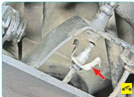
Осмотрите фиксатор наконечника шланга. Сильно деформированный или корродированный фиксатор замените.
