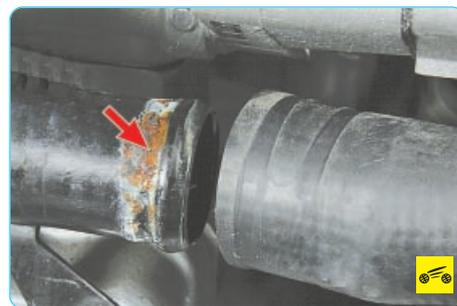
Снимите шланг с патрубка. Как правило, причиной течи является коррозия уплотняющей поверхности патрубков. Зачистите поврежденную поверхность и установите шланг на герметик. После высыхания герметика залейте охлаждающую жидкость.
