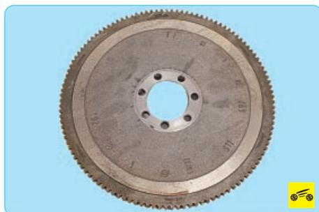
5. Проверьте состояние зубьев обода маховика и в случае их повреждения замените маховик.
