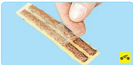
4. Снимите с отрезков жгута из набора защитную пленку...
