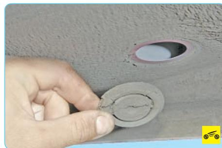
2. Поддев отверткой края двух заглушек отверстий в пороге, извлеките заглушки.
