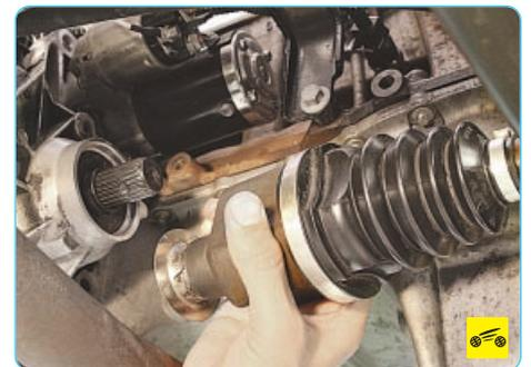
2. Для замены сальника хвостовика правой полуосевой шестерни дифференциала снимите правый привод (см. «Снятие и установка приводов передних колес», с. 148).
