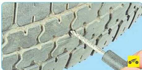
3. Обработайте с помощью рашпиля внутреннюю поверхность отверстия. После обработки поверхность будет очищена от грязи, ржавчины и иметь ровные края.
