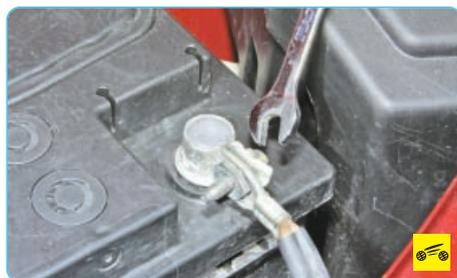
2. Ослабьте стяжной болт наконечника провода...
