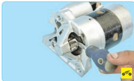
1. С помощью отвертки проверьте легкость перемещения муфты привода вдоль вала.
