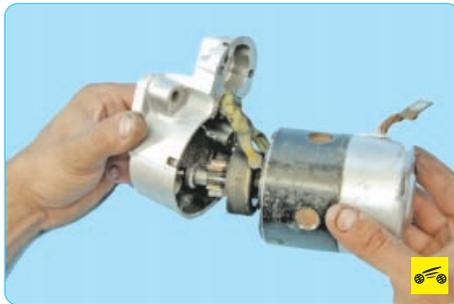
10. ...и окончательно разъедините статор и крышку.
