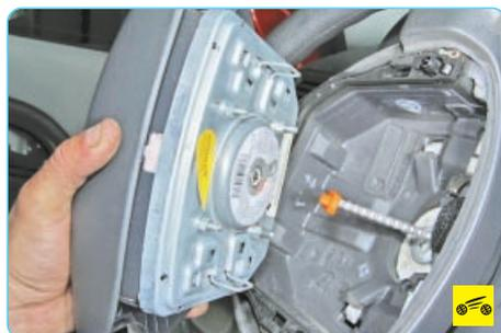
3. Снимите модуль подушки безопасности (см. «Снятие и установка подушки безопасности водителя», с. 291).
