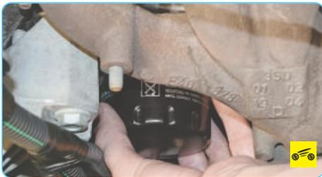
Отверните фильтр и снимите его. Данный способ показан на примере двигателя K7J. Масляный фильтр двигателя K4J снимают аналогично.
