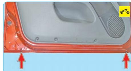
1. Для удаления воды в нижних кромках передних и задних дверей, а также в порогах выполнены дренажные отверстия.
