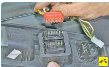
7. Сожмите фиксаторы колодки жгута проводов переключателя управления электростеклоподъемником двери переднего пассажира, отсоедините колодку от переключателя и снимите блок.
