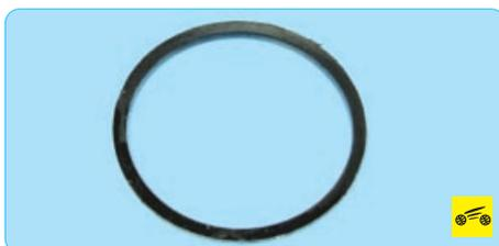
Уплотнительное кольцо главного тормозного цилиндра при каждой разборке соединения заменяйте новым.
