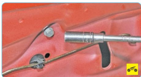
3. Выверните болты 1 (рис. 11.1) крепления направляющей стеклоподъемника к внутренней панели передней двери.
