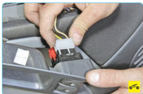
4. Сожмите фиксатор колодки жгута проводов...
