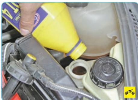
3. ...и долейте тормозную жидкость до метки «MAX».
