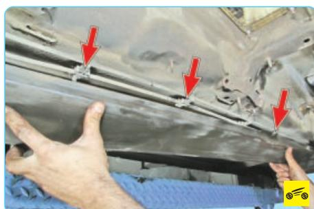
7. Проверьте крепление трубопроводов в держателях (трубопроводы проложены с левой стороны днища и закрыты защитным кожухом, который при проверке необходимо снять). Замените поврежденные держатели, так как их ослабление или поломка приводят к вибрации и, как следствие, к поломке трубопроводов.
