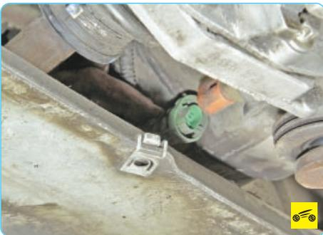
4. ...и отсоедините от выключателя колодку жгута проводов.
