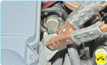
8. ...а второй зажим кабеля с черными рукоятками – к «массе» автомобиля с разряженной батареей в месте, расположенном на максимально возможном расстоянии от аккумуляторной батареи.
