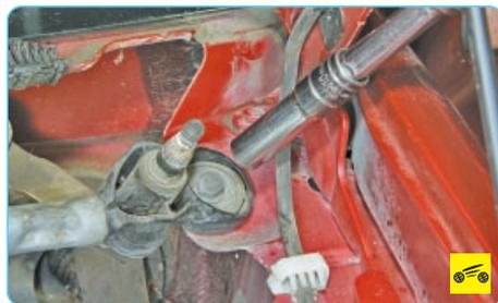
4. Выверните два болта крепления трапеции стеклоочистителя...
