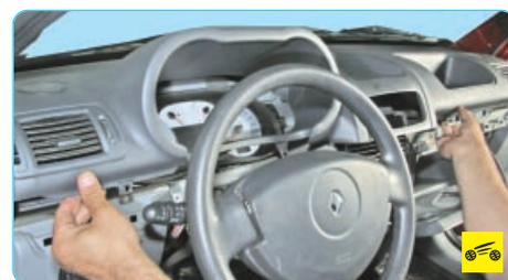
11. Снимите верхнюю накладку панели приборов.
