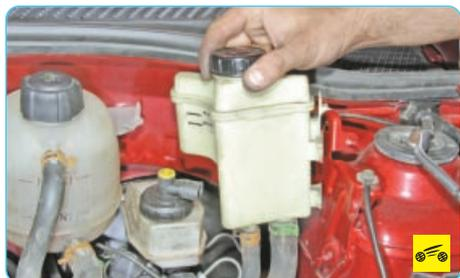
4. Поднимая бачок вверх, снимите его с кронштейнов на кузове (на этой и последующих фотографиях для наглядности снят блок управления двигателем).
