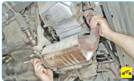
30. Снимите каталитический нейтрализатор отработавших газов (см. «Замена элементов системы выпуска отработавших газов», с. 126).
