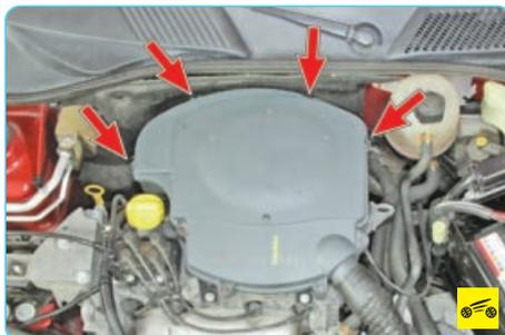
**Крышка воздушного фильтра удерживается четырьмя фиксаторами.**
