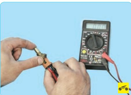
6. Проверьте проводимость выключателя света заднего хода (отжатый шток датчика) – проводимость должна быть.
