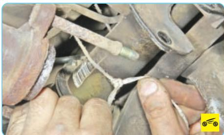
12. Привяжите, например, проволокой или веревкой рулевой механизм к силовому агрегату.
