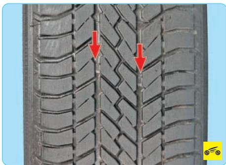
...выполненных в виде выступов внутри канавок протектора. После стирания протектора до уровня этих индикаторов шина считается не пригодной для дальнейшей эксплуатации.
