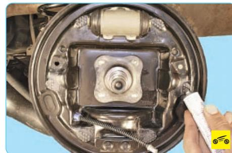
28. Нанесите на места трения передней и задней тормозных колодок о тормозной щит тугоплавкую смазку для тормозных механизмов.
