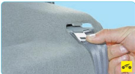
34. Следом за окантовками пропустите в отверстия облицовки задней полки ремни безопасности и снимите облицовку.
