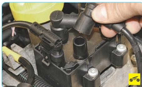
1. Отсоедините от модуля зажигания наконечники высоковольтных проводов.
