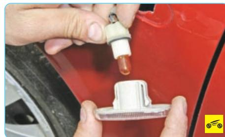
5. ...извлеките его из фонаря и снимите фонарь.
