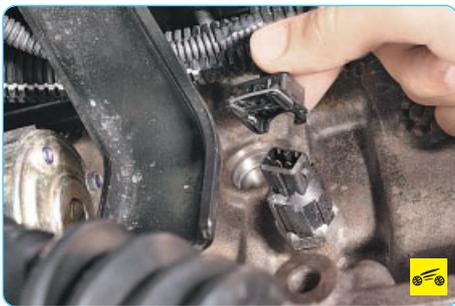
2. Сожмите фиксатор и отсоедините от датчика колодку жгута проводов.
