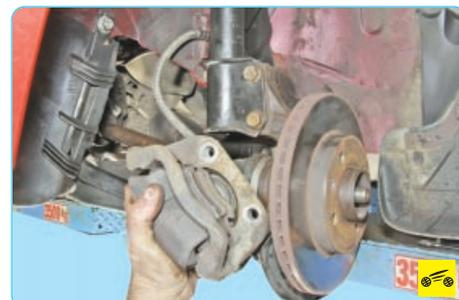
7. Снимите суппорт тормозного механизма переднего колеса в сборе с направ-
