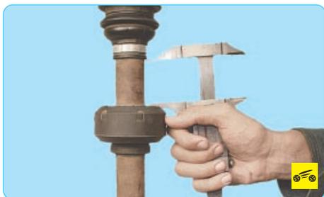
Перед снятием динамического демпфера измерьте и запомните расстояние между торцами демпфера и чехла шарнира, чтобы
