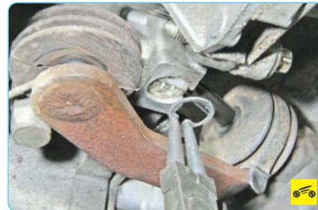
9. ...и извлеките кольцо из проточки в приливе на механизме переключения передач.
