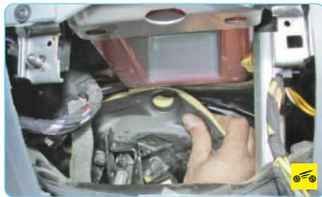
4. Снимите шумоизоляционную накладку щита передка (см. «Замена вакуумного усилителя», с. 185).
