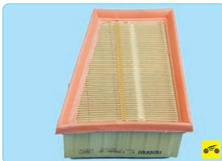
...а двигателя K4J прямоугольный. Оба элемента выполнены с большой площадью фильтрующей поверхности.
