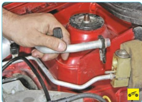
2. Отсоедините трубопровод линии низкого давления от терморегулирующего клапана (см. пп. 2 и 3 подраздела «Замена терморегулирующего клапана», с. 288).
