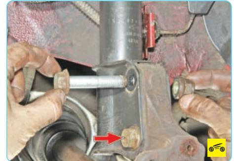
10. Отверните гайки болтов крепления поворотного кулака к амортизаторной стойке и извлеките болты.
