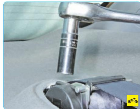
7. Выверните болт крепления катушки ремня безопасности к задней полке.
