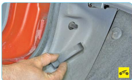
5. ...и снимите ручку с оси привода, преодолевая упругое сопротивление ее фиксатора.
