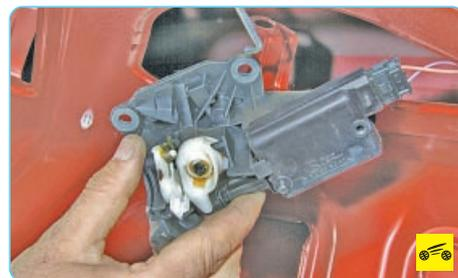
7. Выведите привод замка из проема крышки багажника на длину присоединенного провода.
