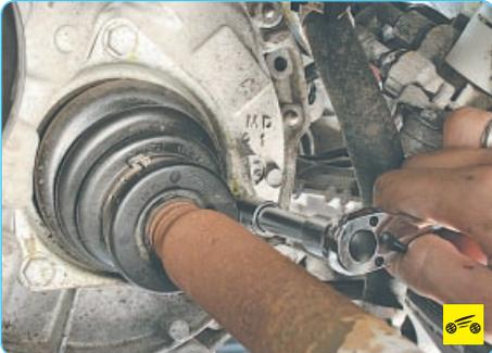
11. Выверните три болта крепления держателя чехла внутреннего шарнира привода к картеру коробки передач...
