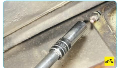
8. Отверните четыре гайки крепления кулисы рычага управления коробкой передач...
