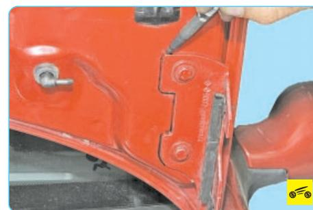
4. Если снимаете капот не для замены, пометьте его положение относительно петель, например, обведя петли по контуру фломастером.
