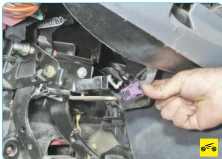
3. Отсоедините от выключателя стоп-сигнала колодку жгута проводов, нажав на ее фиксатор.
