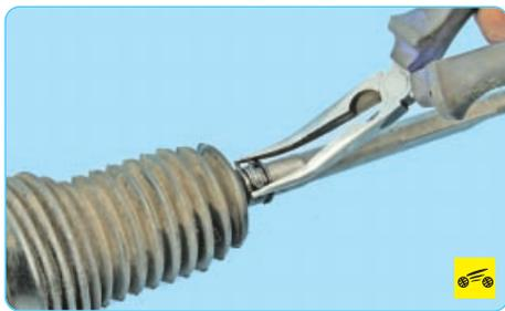
3. Снимите малый хомут и снимите защитный чехол.
