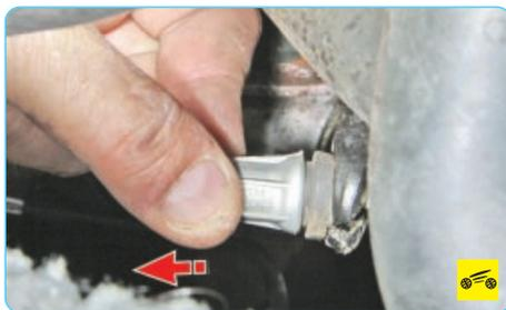
10. В подкапотном пространстве, потянув наконечник троса привода выключения сцепления в направлении, показанном на фото стрелкой...
