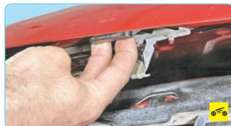
Так расположена лапка предохранительного крючка (для наглядности показано при открытом капоте).
