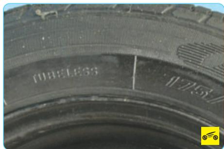
На боковины шин наносят маркировку, в которой указаны основные их параметры. Например, маркировка **175/ 65 R14 82T** расшифровывается следующим образом:
