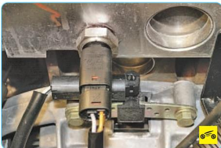
**Датчик температуры охлаждающей жидкости** установлен в торце головки блока цилиндров со стороны 1-го цилиндра.
