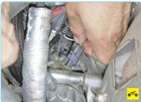
5. ...и отсоедините колодку жгута проводов от генератора.
