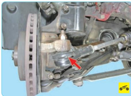
1. Проверьте состояние защитных чехлов наконечников рулевых тяг. Замените порванные, потрескавшиеся или потерявшие эластичность чехлы.
