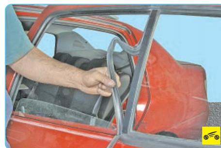
7. Извлеките уплотнитель проема опускаемого стекла задней двери.
