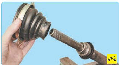
5. ...и снимите с вала привода чехол вместе с его держателем.
