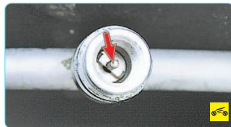
Проверять наличие хладагента в системе путем нажатия на золотники сервисных клапанов запрещено, так как после такой проверки золотник клапана может полностью не закрыться и произойдет утечка хладагента из системы!
