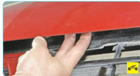
Приподнимите капот и через образовавшуюся щель отожмите вверх лапку предохранительного крючка.
