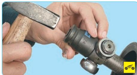
8. Установите на вал чехол, закрепите его хомутом, напрессуйте на шлицы вала ступицу шарнира в сборе с роликами (в качестве оправки можно использовать подходящую головку из набора инструмента), совместив нанесенные при разборке метки.
