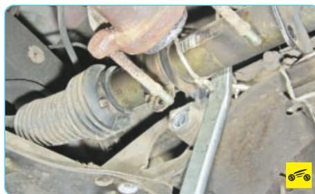
29. Монтажной лопаткой отделите рулевой механизм от подрамника...
