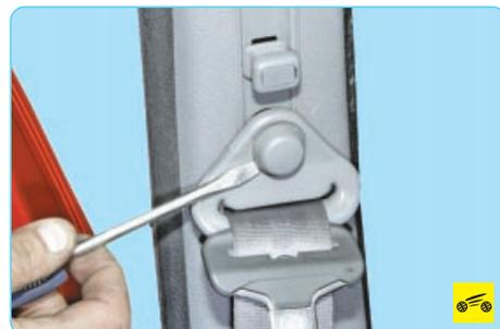
6. Подденьте отверткой декоративный колпачок болта верхнего крепления ремня безопасности...
