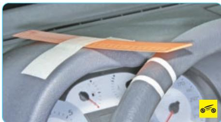
5. В этом положении нанесите на обод рулевого колеса вторую метку (закрепите проволоку).
