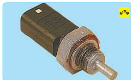
Датчик температуры охлаждающей жидкости установлен в системе охлаждения двигателя. Чувствительным элементом датчика является термистор, его электрическое сопротивление изменяется обратно пропорционально температуре.
