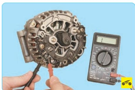
9. Проверьте диоды выпрямительного блока. Подсоедините один провод к «массе» выпрямительного блока, второй – к выводу диода...
