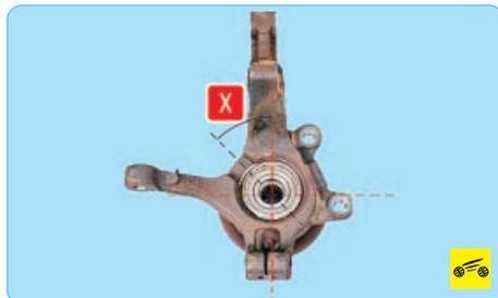
На автомобилях, оборудованных ABS, установите кронштейн датчика частоты вращения колеса таким образом, чтобы угол X составлял  $35^\circ \pm 5^\circ$ .
