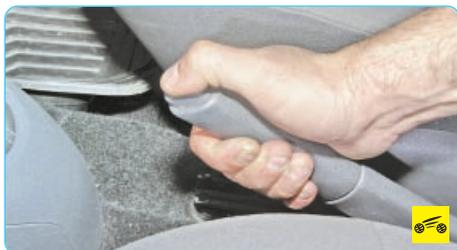
Для того чтобы растормозить автомобиль, потяните рычаг немного вверх, нажмите на кнопку в торце рукоятки рычага и опустите рычаг до упора вниз – контрольная лампа должна погаснуть.
