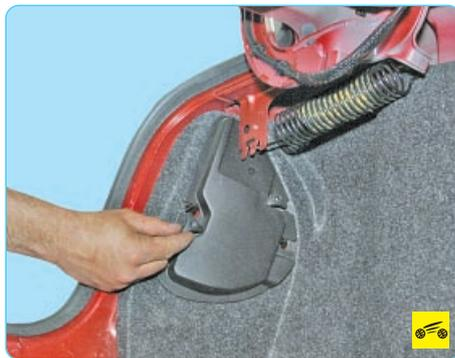
8. Снимите крышки задних фонарей, отвернув по две гайки-барашка их крепления.
