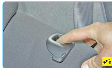
7. С обеих сторон спинки нажмите на фиксаторы ее замков и отведите спинку вперед до момента отсоединения замков от защелок на кузове.
