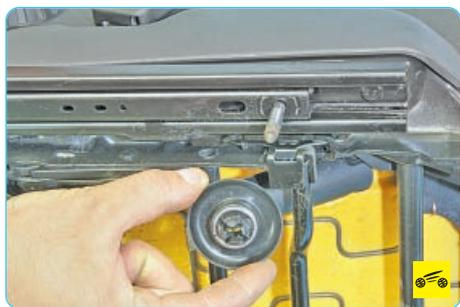
6. Снимите со шпилек крепления правых салазок уплотнительные втулки. Сильно обжатые или затвердевшие втулки замените.
