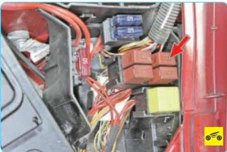
Электробензонасос может не работать из-за перегорания реле в монтажном блоке моторного отсека.
