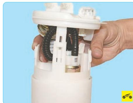
15. Сожмите пластмассовые фиксаторы и извлеките узел топливного насоса из стакана-накопителя.
