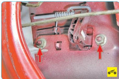
3. Отверните гайки крепления наружной ручки задней двери.
