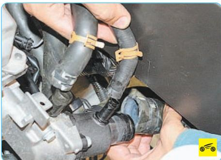
18. ...и отсоедините шланги от патрубков термостата и головки блока цилиндров.
