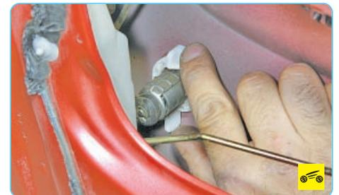
2. Через проем во внутренней панели передней двери поверните фиксирующее кольцо выключателя замка против часовой стрелки на 45°.
