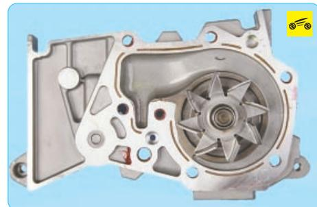
**Водяной насос двигателя K4J аналогичен по конструкции водяному насосу двигателя K7J, но отличается от последнего формой корпуса.**
