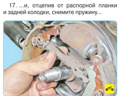
17. ...и, отцепив от распорной планки и задней колодки, снимите пружину...
