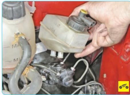
4. Снимите бачок, извлекая его патрубки из соединительных втулок.
