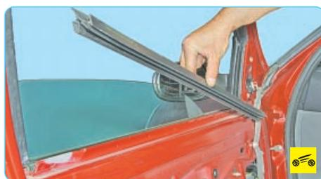
4. ...и снимите его с отштамповки проема стекла.
