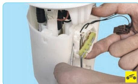
6. Нажмите отверткой на фиксатор, сдвиньте вверх датчик указателя уровня топлива...
