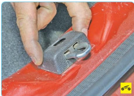
Если замок крышки багажника нечетко запирается или отпирается, если закрывание сопровождается ударом, отрегулируйте положение крышки багажника относительно петель, для чего при ослабленных болтах крепления крышки багажника к петлям перемещайте крышку багажника вправо-влево.
