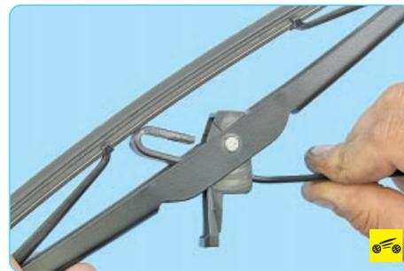
2. ...переместите щетку по рычагу до выхода его отогнутого конца из отверстия адаптера...
