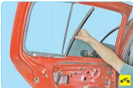
12. Отведите направляющую от уплотнителя неподвижного стекла и снимите направляющую, вынимая ее из проема опускного стекла задней двери.
