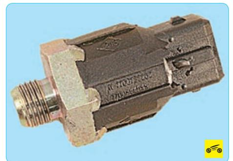
**Датчик детонации**, прикрепленный к блоку цилиндров между 2-м и 3-м цилиндрами, улавливает аномальные вибрации (детонационные удары) в двигателе.
