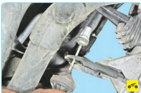
33. ...извлеките наконечник оболочки троса привода выключения сцепления из паза кронштейна (см. «Замена троса привода выключения сцепления», с. 132).
