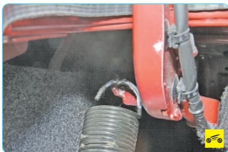
4. Отсоедините отогнутый конец пружины от кронштейна на петле крышки багажника и снимите пружину.
