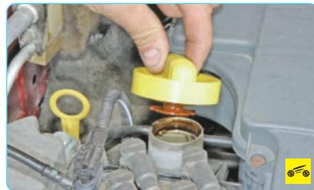
4. Для доливки масла поверните пробку маслосливной горловины против часовой стрелки и и извлеките ее из маслосливной горловины.
