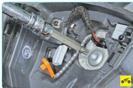
6. Ослабьте затяжку болта крепления рулевого колеса, удерживая колесо от проворачивания.
