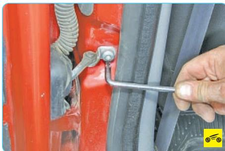
6. Выверните болт крепления петли ограничителя открывания задней двери и отведите петлю от центральной стойки кузова.
