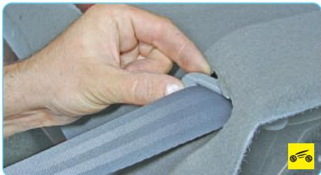
33. ...разверните их боком и пропустите в отверстия облицовки задней полки.
