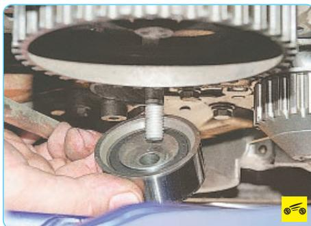
9. ...и снимите ролик.
