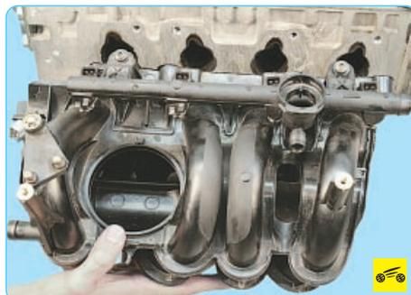
26. ...и отсоедините впускную трубу от головки блока цилиндров.
