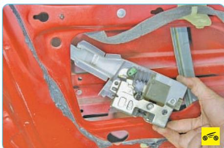
12. Снимите замок передней двери через нижний проем во внутренней панели двери.
