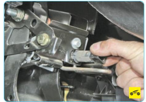
4. Поверните выключатель стоп-сигнала против часовой стрелки на 90°...
