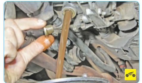
22. Слейте масло из коробки передач (см. «Проверка уровня, доливка и замена масла в механической коробке передач», с. 134).
