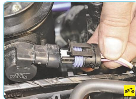
3. Отожмите фиксатор и отсоедините от датчика колодку жгута проводов.
