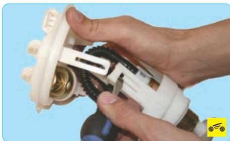
17. Отожмите отверткой фиксаторы и снимите верхнюю часть узла топливного насоса...
