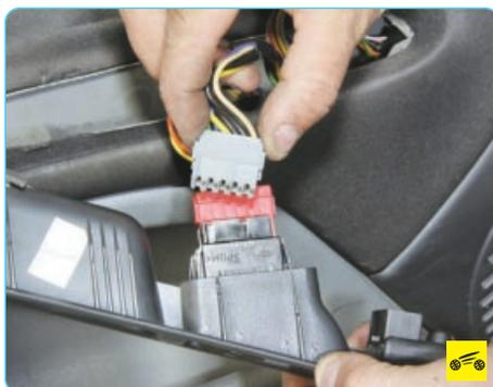
5. ...и отсоедините колодку от выключателя стеклоподъемника.
