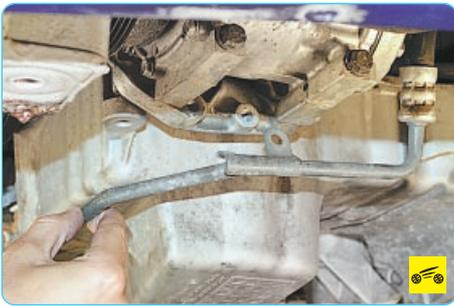
13. ...отведите трубопровод в сторону и снимите масляный картер.
