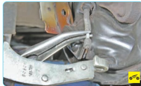
7. Отсоедините наконечник троса стояночного тормоза от разжимного рычага стояночной тормозной системы (см. «Замена тросов привода стояночного тормоза», с. 198).
