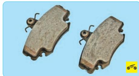
Так выглядят тормозные колодки тормозного механизма переднего колеса. Все тормозные колодки передних тормозных механизмов одинаковы.
