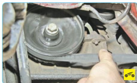
Есть еще один способ проверки натяжения ремня: попробуйте перекрутить его нижнюю ветвь пальцами вдоль ее оси. Если ремень натянут правильно, перекрутить ветвь удастся не более чем на 45°.
