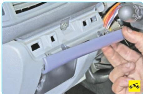
3. Преодолевая сопротивление пластмассовых фиксаторов, снимите левую декоративную накладку...
