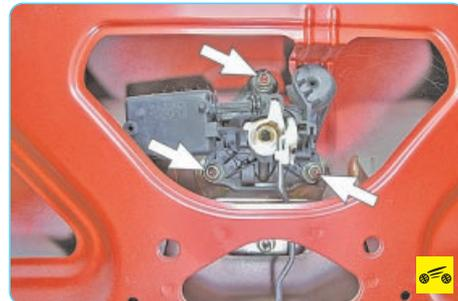
6. Отверните три гайки крепления привода замка к панели крышки багажника.
