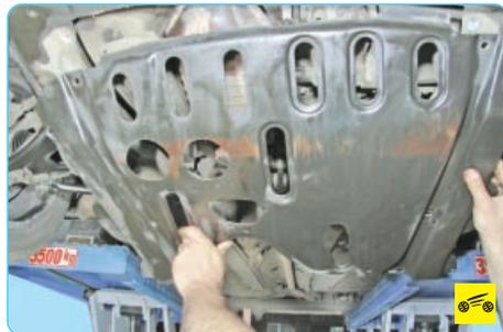
1. Снимите защиту картера двигателя (см. «Снятие и установка защиты картера двигателя», с. 68).
