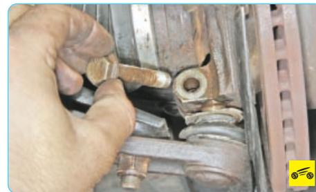
7. Отверните гайку стяжного болта клеммового соединения поворотного кулака с шаровой опорой и извлеките стяжной болт из отверстия.
