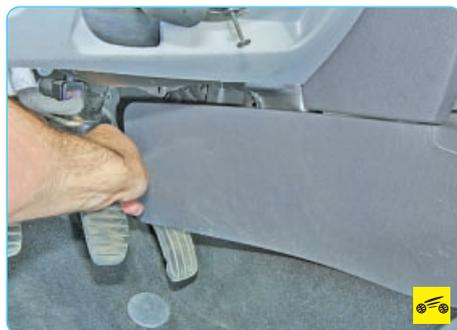
6. С обеих сторон облицовки тоннеля пола отсоедините ее держатели от кронштейнов консоли панели приборов, потянув края облицовки на себя.
