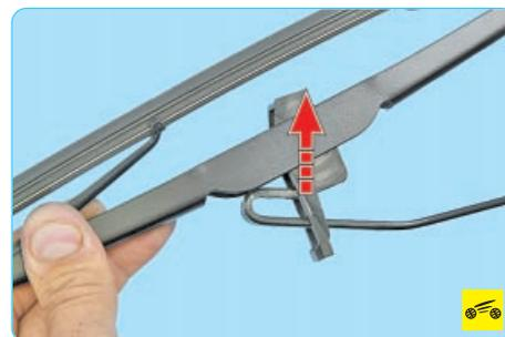
3. ...сдвиньте адаптер щетки с рычага в направлении стрелки...
