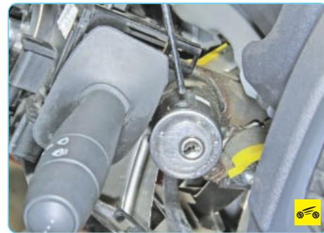
3. Выверните винт крепления замка зажигания к кронштейну на рулевой колонке.
