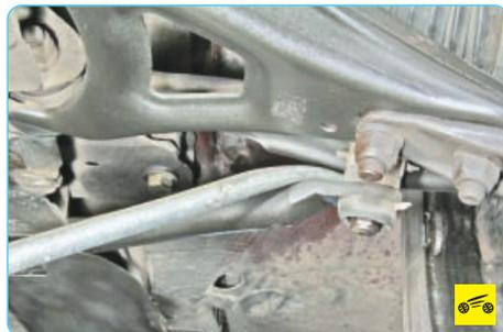
4. Проверьте состояние резиновых втулок в местах крепления стабилизатора поперечной устойчивости к рычагам передней подвески. Упираясь монтажной лопаткой в подрамник передней подвески, попытайтесь покачать рычаг стабилизатора: если есть ощутимый люфт, замените втулки, болт и гайку крепления.
