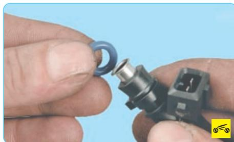
12. ...и с корпуса форсунки. Установив новые кольца, смажьте их моторным маслом.
