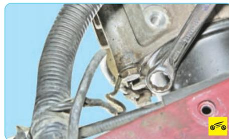
10. Выверните болт крепления «массового» провода...
