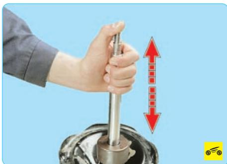
10. Установите стойку вертикально и несколько раз до упора опустите и поднимите шток амортизатора. Убедитесь в том, что шток перемещается без провалов, заеданий и стуков. В противном случае замените стойку. Кроме того, замените ее при повреждении резьбы в верхней части штока.
