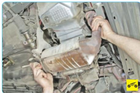
5. Снимите каталитический нейтрализатор (см. «Замена элементов системы выпуска отработавших газов», с. 126).
