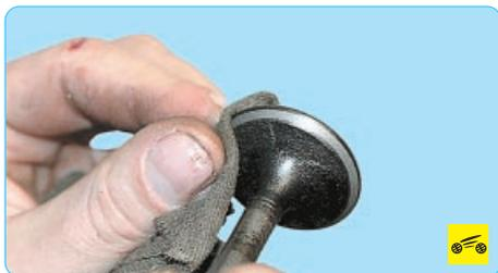
8. После притирки тщательно протрите клапан и седло чистой тряпкой и промойте для удаления остатков притирочной пасты. Проверьте герметичность клапана, для чего установите его в головку с пружинами и сухарями. Затем положите головку набок и залейте керосин в тот канал, который закрыт клапаном. Если в течение 3 мин керосин не просочится в камеру сгорания, клапан герметичен.
