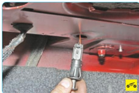
3. ...и извлеките его из усилителя задней полки.
