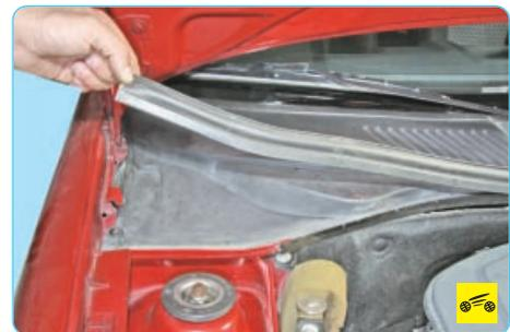
2. Снимите резиновый уплотнитель с отштамповки на щите передка.
