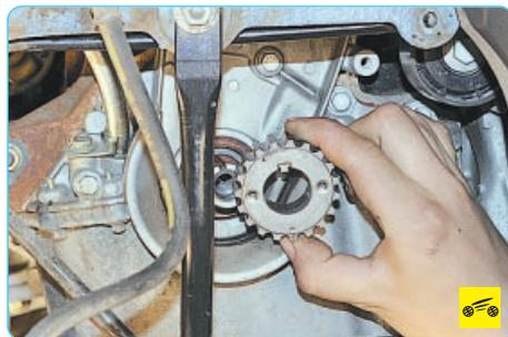
3. Снимите зубчатый шкив коленчатого вала.
