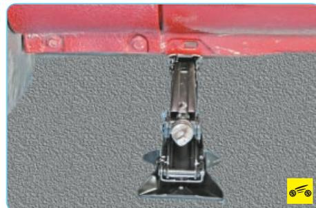
Место установки домкрата на пороге помечено отштамповкой с отверстием, на которое должна попасть прорезь головки домкрата.
