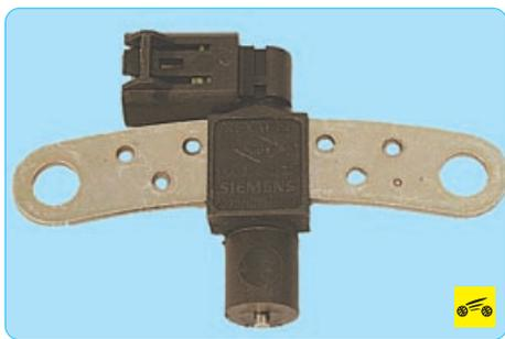
**Датчик верхней мертвой точки и частоты вращения коленчатого вала** индуктивного типа предназначен для синхронизации работы электронного блока управления с ВМТ поршня 1-го цилиндра и угловым положением коленчатого вала.
