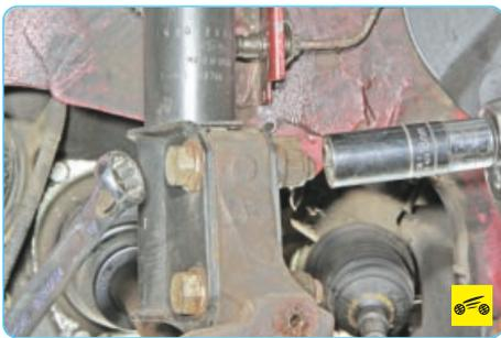
9. Удерживая головку болта от проворачивания, ослабьте затяжку гайки болта верхнего крепления поворотного кулака к амортизаторной стойке...
