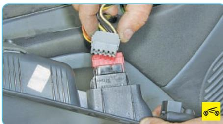
6. Сожмите фиксаторы колодки жгута проводов переключателя управления электростеклоподъемником двери водителя и отсоедините колодку от переключателя.
