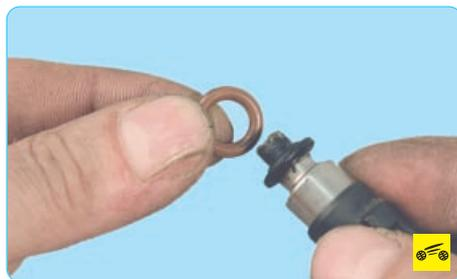
11. Для замены уплотнительных колец форсунок снимите их с распылителя...
