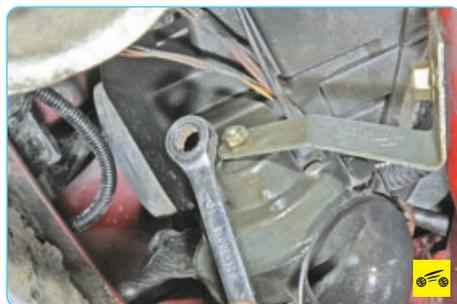
6. Отверните гайку крепления звукового сигнала...
