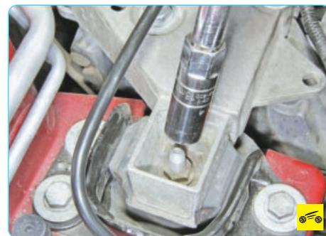
3. Отверните гайку шпильки крепления кронштейна правой опоры подвески силового агрегата к опоре.
