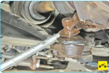
9. Отсоедините от поворотного кулака шаровую опору, отжав нижний рычаг вниз и преодолевая упругое сопротивление стабилизатора поперечной устойчивости (см. «Снятие и установка рычага передней подвески», с. 158).
