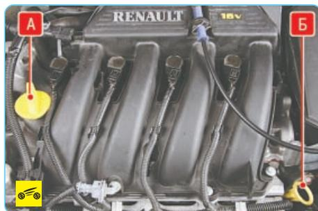
На двигателе K4J указатель (щуп) Б уровня масла расположен в левой части моторного отсека, а пробка А маслосливной горловины – в правой части.
