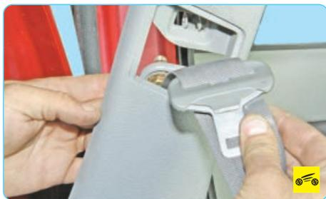
16. Проденьте в проем облицовки центральной стойки кузова пряжку болтов нижнего и верхнего креплений, а также пряжку замка ремня безопасности...
