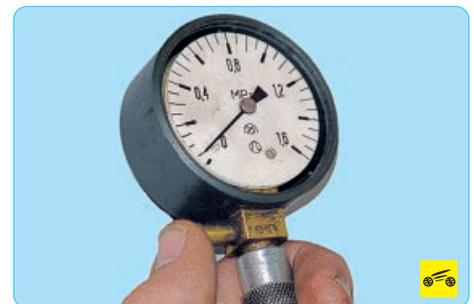
8. Записав показания компрессометра, установите его стрелку на ноль, нажав на клапан выпуска воздуха.
