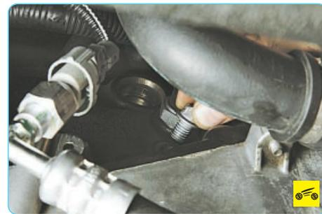
8. Выверните головкой TORX E14 пробку отверстия для установки фиксатора положения ВМТ.
