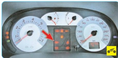
В комбинации приборов вашего автомобиля есть сигнальная лампа аварийного падения давления масла в двигателе. Для надежной работы двигателя необходимо, чтобы в системе смазки двигателя постоянно обеспечивалось достаточно высокое давление.
