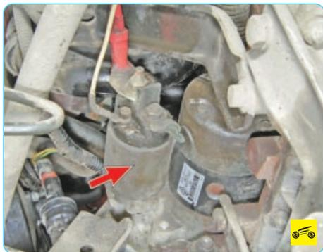
5. Стартер не выключается после пуска двигателя. Причины – неисправность муфты свободного хода стартера, спекание контактов тягового реле. В случае такой неисправности немедленно остановите двигатель!
