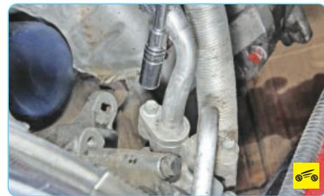
9. Выверните болт крепления фланца трубопровода линии низкого давления...
