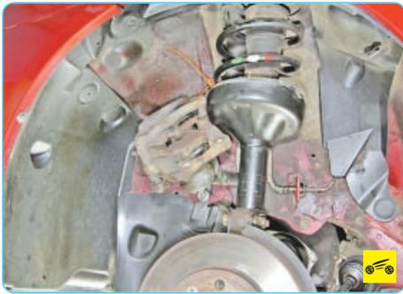
8. ...и закрепите на кузове проволокой или веревкой (см. «Замена суппорта тормозного механизма переднего колеса», с. 192).
