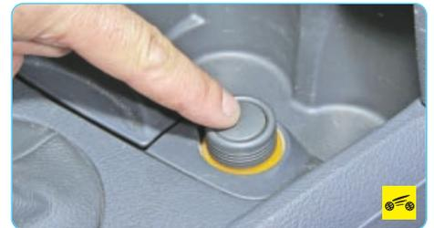
**22** – прикуриватель. Для пользования прикуривателем нажмите на кнопку его подвижной части (ключ в замке зажигания в положении «А»).
