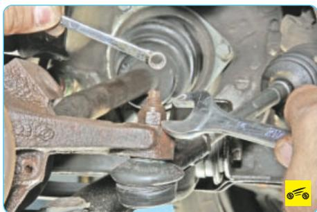
2. Отверните гайку крепления пальца шарнира к рычагу поворотного кулака, удерживая палец от проворачивания вторым ключом.
