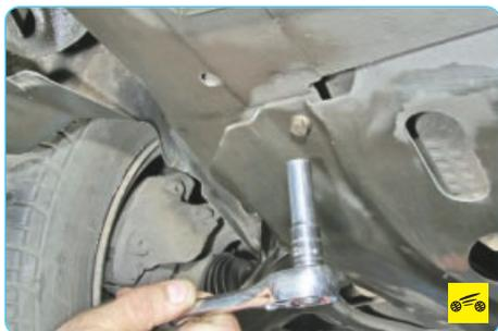
1. Выверните болт крепления защиты картера двигателя к подрамнику передней подвески...
