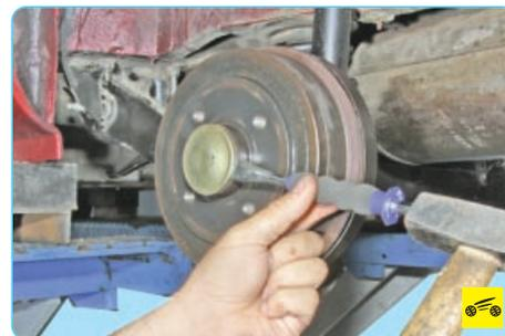
3. С помощью тонкого зубила и молотка выпрессуйте защитный колпачок из ступицы...
