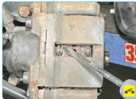
2. Вставив большую отвертку между внутренней тормозной колодкой и тормозным диском, сдвиньте колодку внутрь, утопив тем самым поршень рабочего цилиндра в цилиндр.
