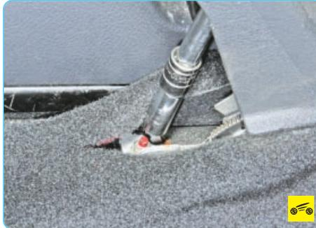
6. Отверните гайку переднего крепления кронштейна рычага привода стояночного тормоза к основанию кузова.
