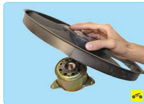
7. Снимите крыльчатку электровентилятора.
