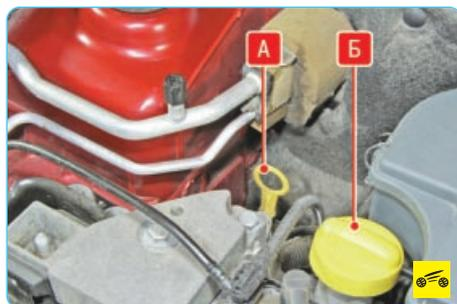
Указатель (щуп) А уровня масла и пробка Б маслосливной горловины расположены в правой части моторного отсека рядом с воздушным фильтром.
