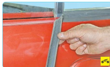
6. ...снимите уплотнитель с отштамповки проема стекла задней двери и отведите его в сторону.
