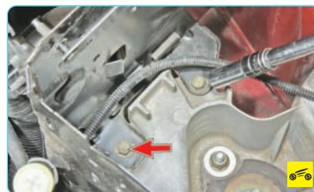
9. Выверните два болта крепления щитка аккумуляторной батареи к кронштейну левой опоры подвески силового агрегата.
