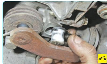
10. Извлеките шаровой палец шарнира из гнезда в приливе коробки передач...
