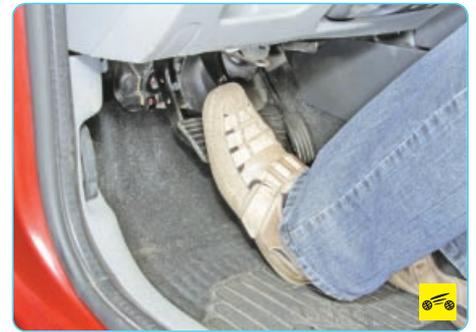
4. Проверьте момент включения сцепления при отпуске педали. При работающем на холостом ходу двигателе нажмите на педаль до упора, включите первую передачу и начинайте медленно отпускать педаль, стараясь определить, при каком расстоянии площадки педали от пола автомобиля начинает двигаться. Если сцепление и привод его выключения в нормальном состоянии, это расстояние должно быть примерно 90 мм. Если ход педали до включения сцепления меньше или больше указанного значения, проверьте следующее:
