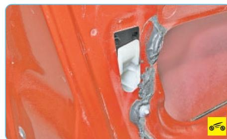
6. ...и, опуская его вниз, выведите фиксатор верхнего крепления замка из паза в панели двери...
