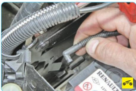
7. Снимите со штуцера аккумуляторной батареи трубку отвода газов.
