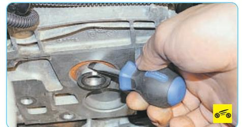
6. Поддев отверткой, извлеките сальник из гнезда головки блока цилиндров.
