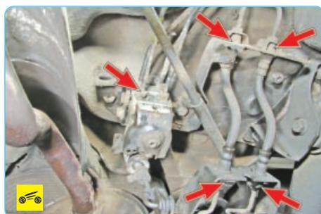
8. Проверьте состояние трубопроводов и шлангов, а также их соединения на балке задней подвески, крепление трубопроводов к кузову автомобиля и к балке задней подвески, соединение трубопроводов с регулятором тормозных сил в гидроприводе задних тормозов.
