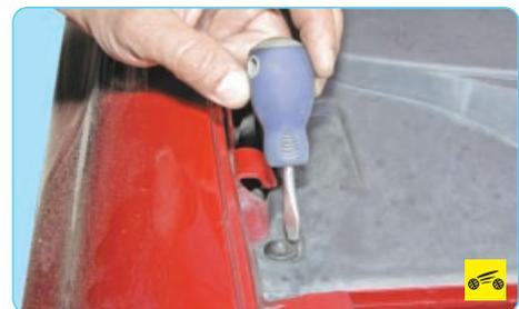
3. Выверните фиксатор пистона крепления правой половины решетки корпуса воздухопритока...
