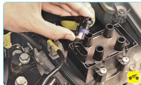
2. ...и, отжав фиксатор, колодку жгута проводов.
