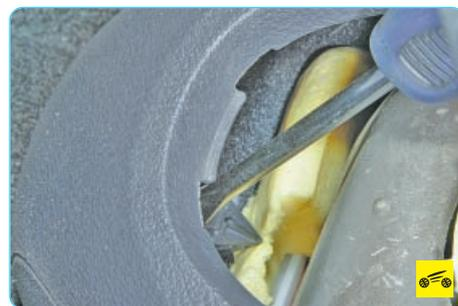
9. Через окно в облицовке тоннеля пола нажмите отверткой на фиксатор, расположенный в ее задней части...
