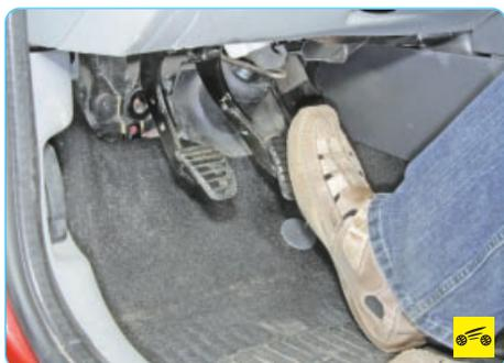
1. Причиной потери эффективности торможения может быть неудовлетворительная работа вакуумного усилителя. Для его экспресс-проверки нажмите несколько раз на педаль тормоза при неработающем двигателе, чтобы снять разрежение в усилителе, а затем, удерживая педаль, пустите двигатель. Если после пуска двигателя педаль немного опустилась, вакуумный усилитель исправен.
