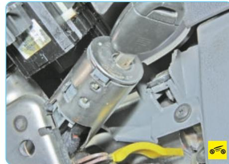
4. Вставьте ключ в замок зажигания...
