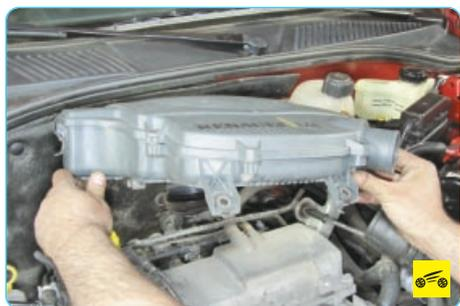
4. Снимите воздушный фильтр (см. «Снятие и установка воздушного фильтра», с. 116).
