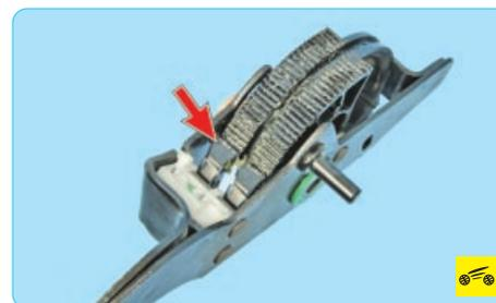
Ход педали в эксплуатации регулируется по мере износа накладок ведомого диска
