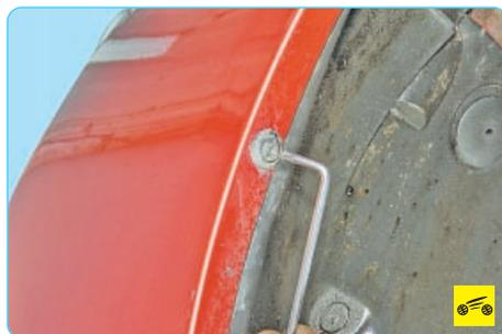
8. ...и передний винты крепления подкрылка к переднему бамперу.
