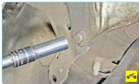
6. Выверните четыре болта крепления термоэкрана промежуточной трубы...
