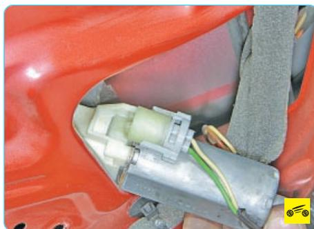
7. Выведите моторедуктор из проема внутренней панели передней двери.
