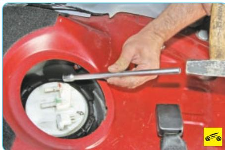
10. Легкими ударами ослабьте затяжку прижимного кольца модуля топливного насоса, как показано на фото...
