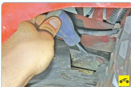
7. Отожмите отверткой фиксатор держателя крепления брызговика к переднему бамперу...
