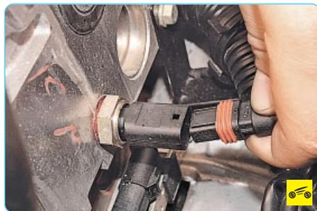
4. ...и отсоедините колодку жгута проводов от датчика температуры охлаждающей жидкости.
