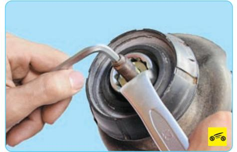
3. Отверните гайку штока, удерживая шток от проворачивания вторым ключом...
