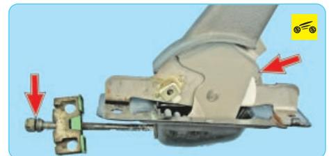
12. Перед установкой на автомобиль смажьте зубчатый сектор рычага и резьбу тяги консистентной смазкой.
