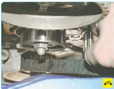
6. ...коленчатого вала и натяжного ролика...
