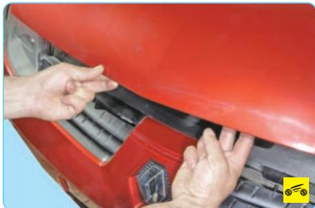
Во избежание появления вмятин на лицевой поверхности капота закрывайте капот захлопыванием, отпуская его с высоты 15–20 см от верхней кромки рамки радиатора.
