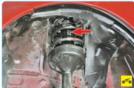
6. Проверьте состояние защитного чехла амортизаторной стойки.
