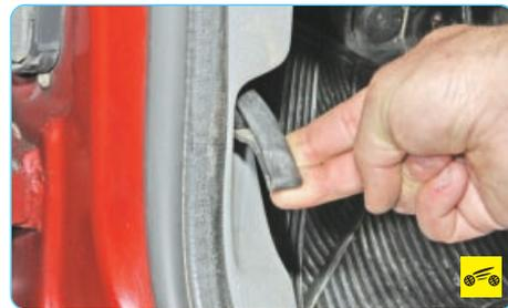
Для доступа в моторный отсек потяните на себя рукоятку привода замка капота.
