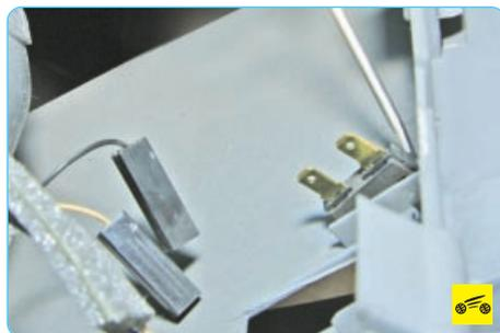
4. Сожмите фиксаторы выключателя...
