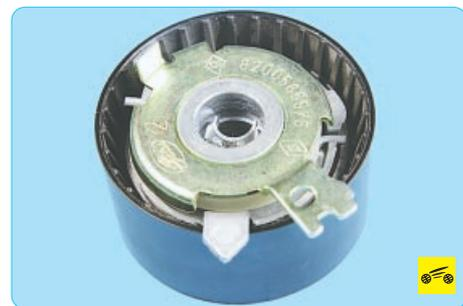
На двигателе K4J установлен автоматический натяжитель ремня привода ГРМ.
