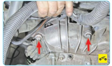
20. Выверните два верхних болта крепления коробки передач к блоку цилиндров двигателя.
