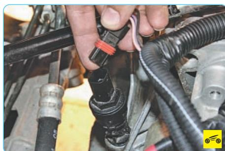
– **датчик скорости** (установлен на картере коробки передач) – возможны ухудшенные динамические качества автомобиля и повышение расхода топлива. Проверьте надежность присоединения к датчику колодки жгута проводов и очистите от окислов ее контакты.
