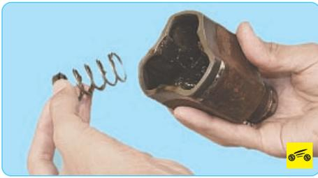
6. Извлеките из корпуса распорную пружину...
