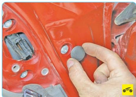
5. Подденьте отверткой край резиновой заглушки отверстия, в котором расположен один из винтов крепления зеркала, и снимите заглушку.
