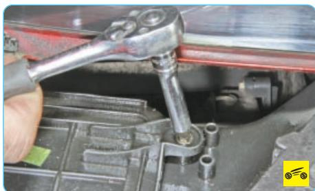
13. Выверните винты крепления вентилятора отопителя к корпусу климатического блока...
