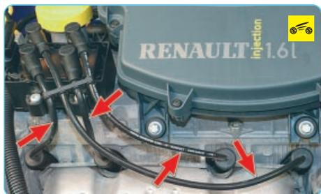
2. Если хлопки нерегулярны, остановите двигатель и откройте капот. Проверьте состояние проводов системы зажигания. Высоковольтные провода не должны быть повреждены изоляции, а их наконечники – окислены. Если есть повреждения проводов, замените неисправный провод.
