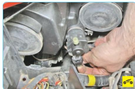
5. Сожмите фиксатор колодки жгута проводов...
