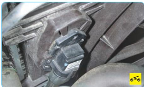
6. Пустите двигатель, следите за температурой и обратите внимание, включает ли при перегреве двигателя вентилятор системы охлаждения. Если он не включается, то причинами могут быть неисправность дополнительного сопротивления, перегорание предохранителя, неисправность реле включения, окисление контактов в колодке жгута проводов или перегорание электродвигателя.
