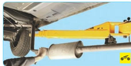
3. Снизу автомобиля отсоедините крепления системы выпуска отработавших газов (см. «Замена элементов системы выпуска отработавших газов», с. 126) и отведите ее в сторону.
