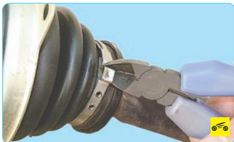
Хомут крепления чехла можно (и значительно легче) снять, перекусив его бокорезами, так как в ремкомплект шарнира обязательно входит и новый хомут.
