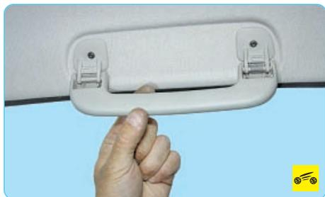
1. Откиньте поручень вниз, преодолевая усилие его возвратных пружин.
