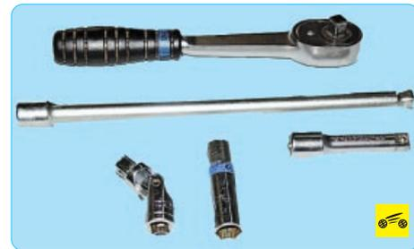
Для отворачивания труднодоступных гаек крепления вакуумного усилителя вам потребуется набор торцовых головок, удлинителей и воротков, подобный изображенному на фото.
