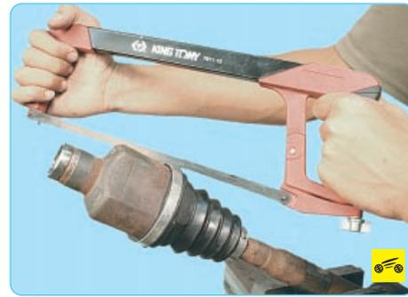
Для облегчения снятия хомута можно распилить его ножовкой по металлу, так как в ремкомплект шарнира обязательно входит новый хомут. При распиливании хомута будьте осторожны – не повредите края паза под чехол на корпусе шарнира.
