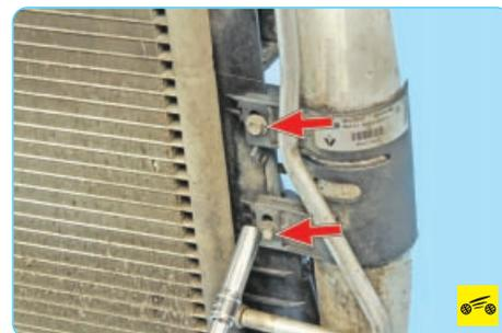
20. Выверните два винта крепления кронштейна ресивера-осушителя к блоку радиатора системы охлаждения двигателя и конденсора...
