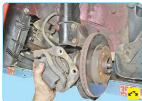
2. Снимите суппорт переднего тормозного механизма, не отсоединяя от него тормозной шланг (см. «Замена суппорта тормозного механизма переднего колеса», с. 192)...
