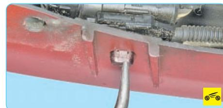
13. С обеих сторон автомобиля сожмите пассатижами фиксаторы соединительных колодок жгутов проводов блок-фар...
