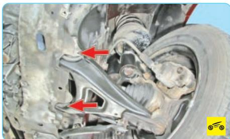
3. Проверьте с помощью монтажной лопатки состояние переднего и заднего шарниров рычага передней подвески. Упираясь монтажной лопаткой в подрамник передней подвески, попытайтесь покачать рычаг подвески. Если есть люфт, замените резинометаллические шарниры (сайлент-блоки).
