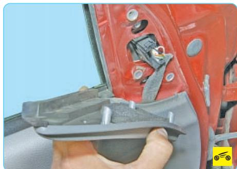
3. ...и снимите накладку, преодолевая упругое сопротивление ее фиксаторов.
