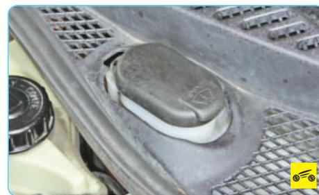
Бачок омывателя расположен в моторном отсеке слева под решеткой короба воздухопритока.
