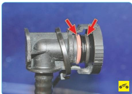
Заменяйте резиновые уплотнительные кольца трубопровода новыми при каждой разборке соединения.
