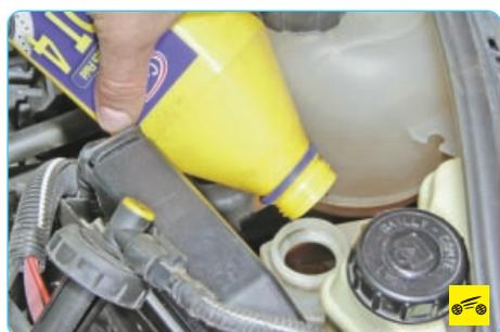
2. Долейте в бачок чистую тормозную жидкость до нижней кромки наливной горловины.
