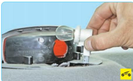
2. Поверните патрон против часовой стрелки и извлеките его из фонаря.
