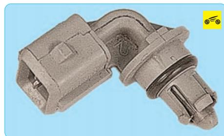
Датчик температуры воздуха во впускной трубе аналогичен по конструкции датчику температуры охлаждающей жидкости, в нем также использован термистор, сопротивление которого изменяется в зависимости от температуры.
