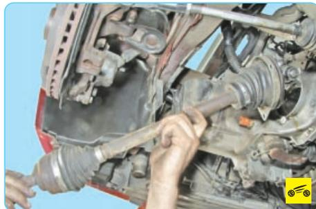
31. Снимите приводы передних колес (см. «Снятие и установка приводов передних колес», с. 148).
