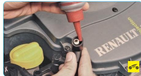
Перед установкой смажьте наконечники высоковольтных проводов консистентной смазкой. Завод-изготовитель рекомендует смазку FLUORINE GREASE (№82 00 168 855 по каталогу), но можно использовать и технический вазелин.
