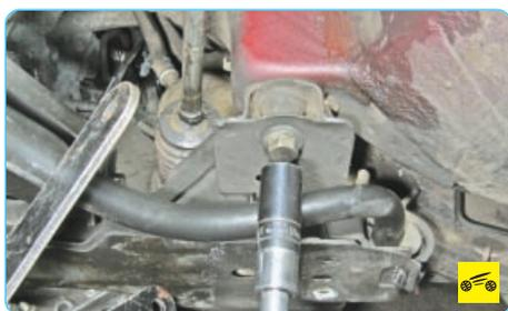
28. Выверните два болта (по одному с каждой стороны) заднего крепления подрамника к кузову.
