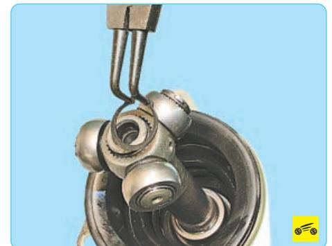
1. Снимите стопорное кольцо ступицы шарнира, разжав его съемником стопорных колец или круглогубцами и выведя кольцо из проточки вала.
