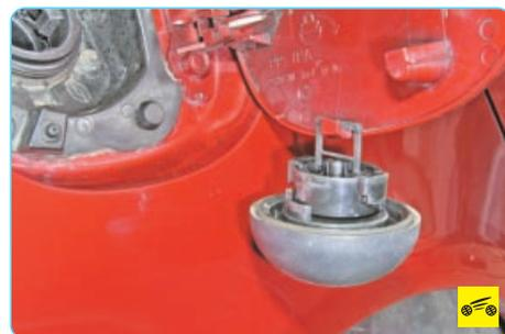
8. Закрепите пробку на держателе с внутренней стороны крышки.
