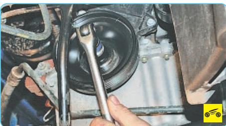
7. Проверните коленчатый вал по часовой стрелке за болт крепления шкива привода вспомогательных агрегатов до мо-
