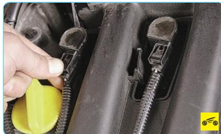
1. Нажав на фиксатор, отсоедините колодку жгута проводов от катушки зажигания.
