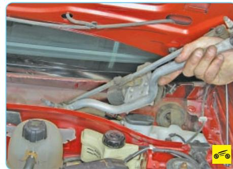
8. ...и снимите трапецию стеклоочистителя в сборе с моторедуктором.
