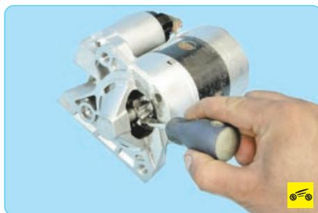
2. Проверните шестерню муфты привода. Шестерня должна легко проворачиваться относительно ступицы муфты в направлении вращения якоря и не должна проворачиваться в противоположном направлении.
