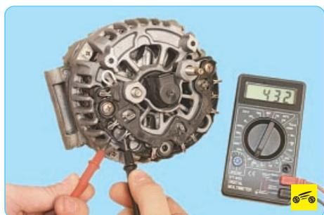
10. ...а затем поменяйте провода местами. Диод должен пропускать ток только в одну сторону. Если диод пропускает ток в обе стороны, значит, он неисправен.
