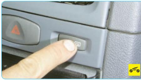
**17** – выключатель электрообогрева заднего стекла. При нажатии на клавишу выключателя (двигатель должен работать) включается электрообогрев заднего стекла, одновременно загорается контрольная лампа в клавише. При повторном нажатии на клавишу обогрев выключается и контрольная лампа гаснет. Если не отключить электрообогрев заднего стекла клавишей выключателя, он автоматически выключится примерно через 15 мин.
