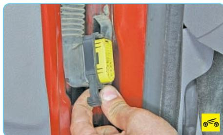
5. ...и отсоедините колодку от разъема на передней стойке кузова.
