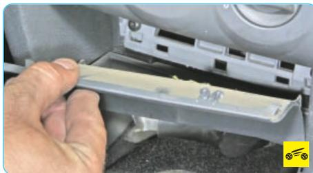
6. ...и, преодолевая сопротивление фиксаторов, снимите облицовку. Аналогично снимите верхнюю облицовку блока управления климатической системой.
