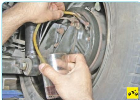
5. После этого наденьте резиновый шланг или прозрачную трубку на клапан выпуска воздуха рабочего цилиндра тормозного механизма правого заднего колеса и погрузите конец шланга в чистый прозрачный сосуд.
