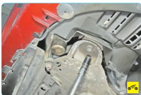
27. Выверните два болта (по одному с каждой стороны) переднего крепления подрамника к кузову.
