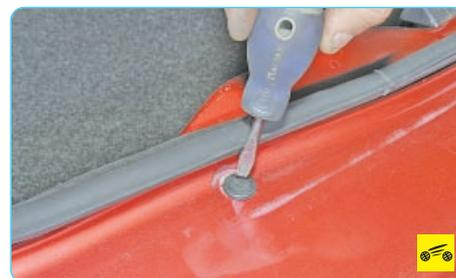
12. Выверните фиксаторы двух пистонов верхнего крепления бампера к кузову, извлеките пистоны...
