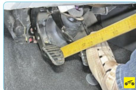
2. Отпустите педаль и повторно измерьте расстояние от накладке площадки педали до пола в свободном состоянии. Это расстояние должно быть 100–105 мм. Разность размеров при двух измерениях и является полным рабочим ходом педали, который должен быть 60–65 мм.
