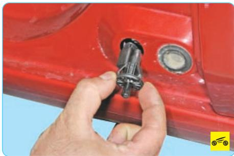
3. Отожмите отверткой фиксаторы и извлеките выключатель из отверстия в кузове.
