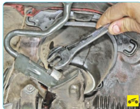
6. Выверните наконечник напорного трубопровода из картера рулевого механизма.
