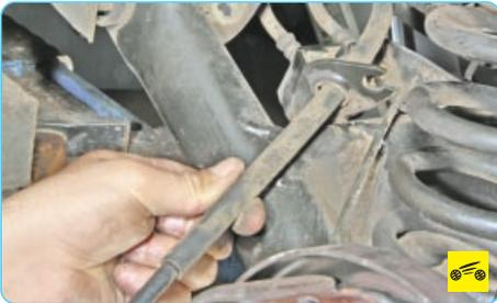
10. Извлеките трос привода стояночного тормоза из отверстия кронштейна балки задней подвески. Аналогично отсоедините второй трос привода стояночного тормоза.
