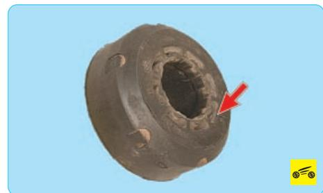
Динамический демпфер устанавливайте на вал, ориентируя его торцом без буртика в сторону наружного шарнира.
