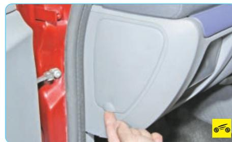
1. Для получения доступа к монтажному блоку предохранителей, расположенному в салоне, подденьте край боковой крышки
