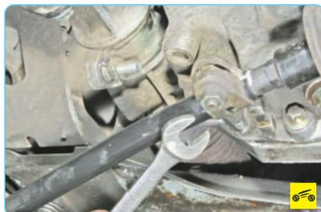
3. ...ослабьте гайку стяжного болта хомута их клеммового соединения...
