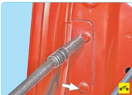
8. Придерживая крышку багажника, выверните по два болта крепления крышки багажника к правой и левой петлям и снимите крышку багажника.
