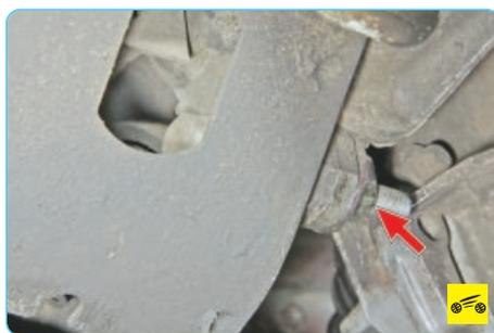
2. Резко поворачивая рулевое колесо в обоих направлениях (это должен делать помощник), проверьте визуально и на слух крепление рулевого механизма. Перемещение механизма на болтах крепления (левый болт показан стрелкой, правый расположен
