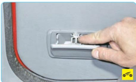
Для очистки пепельницы нажмите на ее фиксатор...
