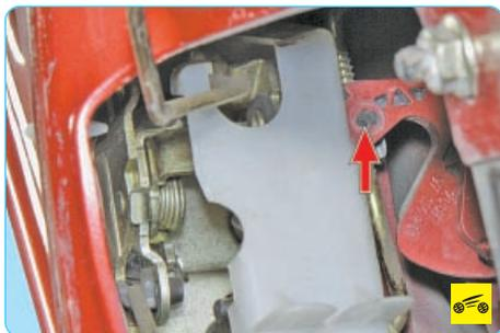
4. Сожмите пассатижами фиксатор тяги наружной ручки и отсоедините тягу от рычага ручки.
