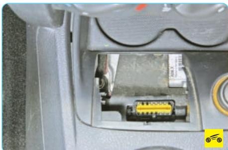
**Диагностический разъем** расположен под крышкой на облицовке тоннеля пола.
