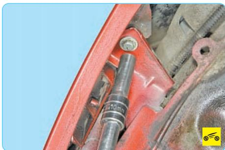
16. Изнутри арок передних колес выверните по одному болту крепления переднего бампера к кронштейнам на брызговиках моторного отсека.
