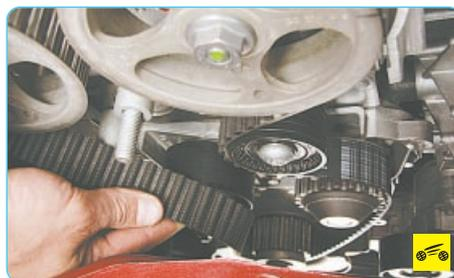
9. Снимите ремень привода газораспределительного механизма.
