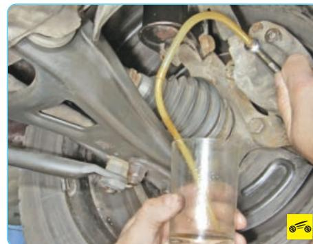
8. Таким же способом замените тормозную жидкость в рабочем цилиндре тормозного механизма левого переднего колеса.
