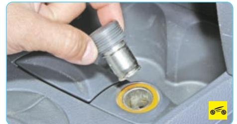
После нагрева спирали в течение 10–20 с кнопка в подвижной части автоматически со щелчком вернется в исходное положение и прикуриватель можно извлечь для использования.
