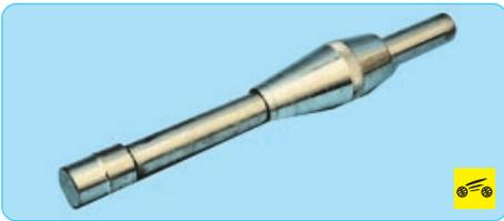
...оправка для центрирования ведомого диска (можно изготовить из первичного вала коробки передач, удалив шестерни).
