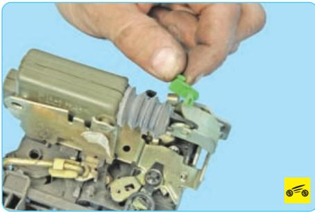
6. ...и снимите фиксатор.
