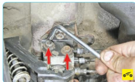
2. Выверните два болта крепления регулятора к кузову.
