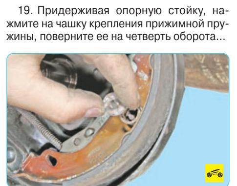
19. Придерживая опорную стойку, нажмите на чашку крепления прижимной пружины, поверните ее на четверть оборота...
