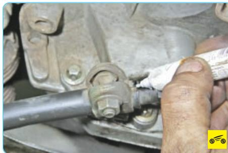
Для предупреждения нарушения регулировки привода, выполняя работы, связанные с разъединением его элементов, предварительно помечайте любым доступным способом взаимное расположение деталей. При обратной сборке устанавливайте элементы привода в соответствии с нанесенными метками.
