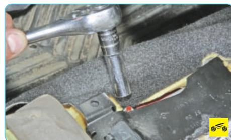
7. Отверните гайки крепления электронного блока управления системой пассивной безопасности впереди слева...
