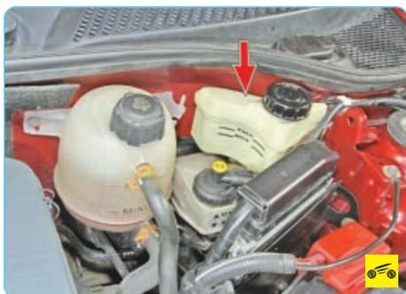
Бачок установлен на кронштейне в левой задней части моторного отсека. На корпус бачка нанесены метки «MAX» и «MIN». При прогревом до нормальной температуры двигателя уровень рабочей жидкости должен находиться около метки «MAX». При холодном двигателе уровень рабочей жидкости не должен быть ниже метки «MIN».
