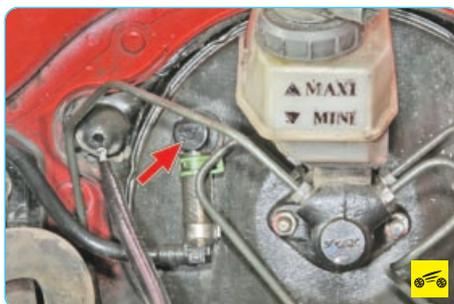
3. ...и плотность посадки штуцера обратного клапана в корпусе вакуумного усилителя.
