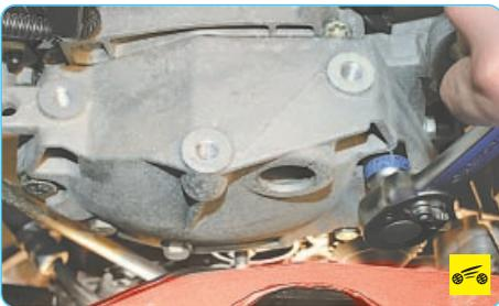
5. Выверните пять болтов крепления верхней крышки ремня привода газораспределительного механизма...
