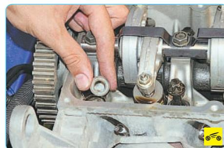
39. ...и снимите установленные под болтами шайбы.
