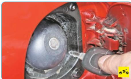
4. Вставьте ключ зажигания в замок пробки топливного бака...
