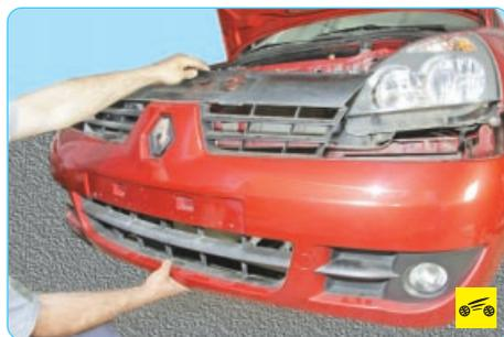
6. Снимите передний бампер (см. «Снятие и установка переднего бампера», с. 243).
