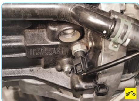
Датчик сигнальной лампы аварийного падения давления масла установлен в задней части блока цилиндра с правой стороны (рядом с номером двигателя).
