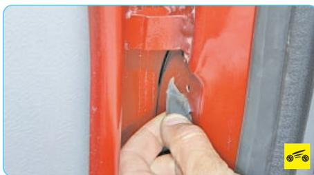
3. Подденьте уплотнитель жгута проводов в проеме центральной стойки...
