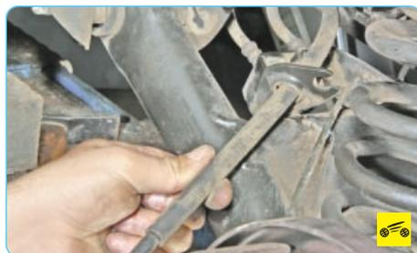
5. Выньте трос из держателя на рычаге балки задней подвески.
