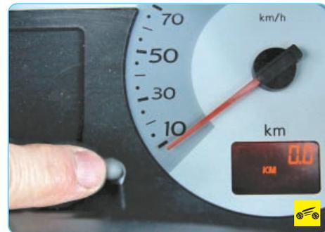
Показания маршрутного компьютера (кроме показаний одометра) обнуляют нажатием на кнопку 15 (см. рис. 1.8) в комбинации приборов.
