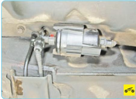
– загрязнение полнопоточного топливного фильтра.
