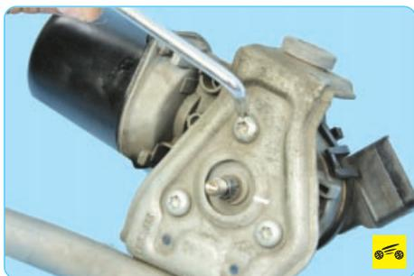
8. Выверните три винта крепления моторедуктора к кронштейну...
