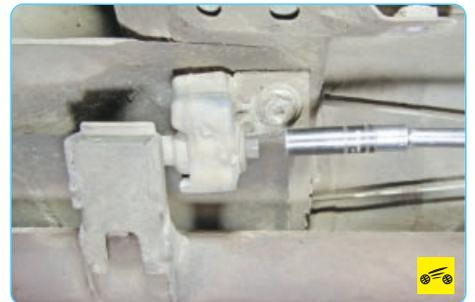
5. Выверните болт крепления кронштейна дополнительного глушителя к подушке.
