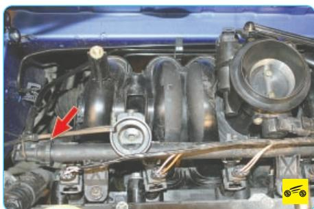
1. Осмотрите соединения топливопроводов с топливной рампой, а также соединения форсунок с топливной рампой (для этого необходимо снять воздушный фильтр). При обнаружении подтекания топлива замените уплотнительные кольца форсунок или наконечников шлангов.
