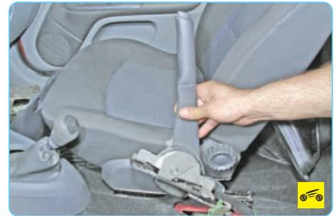
11. ...и снимите рычаг.
