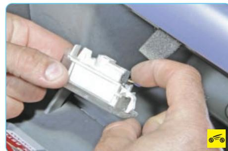
5. Сожмите фиксатор колодки жгута проводов...
