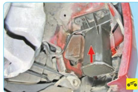
Угольный адсорбер установлен в арке правого переднего колеса за подкрылком (в нише переднего бампера).
