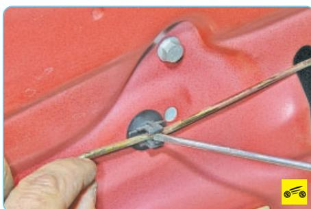
2. Отверткой разожмите держатель тяги привода замка передней двери...
