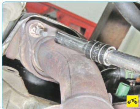
2. Отверните две гайки крепления каталитического нейтрализатора к выпускному коллектору...
