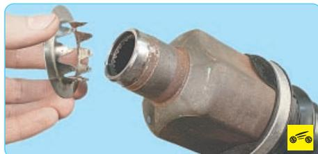
1. Снимите с хвостовика корпуса шарнира грязеотражательную шайбу.
