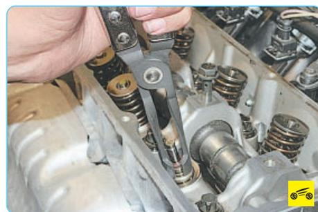
13. При отсутствии инерционного съемника колпачков снимите колпачок специальным съемником клещевого типа или пассатижами, прикладывая усилие строго вверх и не проворачивая колпачок, чтобы не повредить направляющую втулку клапана.
