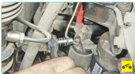
2. Отверните гайку крепления управляющего провода и отсоедините провод от тягового реле.
