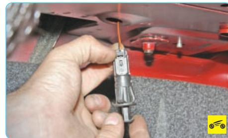
4. Сожмите фиксатор колодки жгута проводов...
