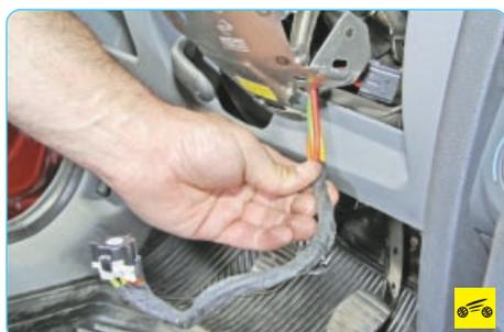
10. При необходимости отсоедините колодку жгута проводов от контактной группы и снимите контактную группу замка зажигания.
