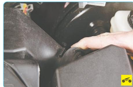
2. Отсоедините воздухоподводящий рукав от корпуса воздушного фильтра и снимите рукав.
