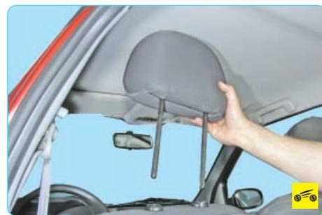
При необходимости (например, для складывания сиденья в спальное положение) подголовник можно снять, нажав на фиксаторы.
