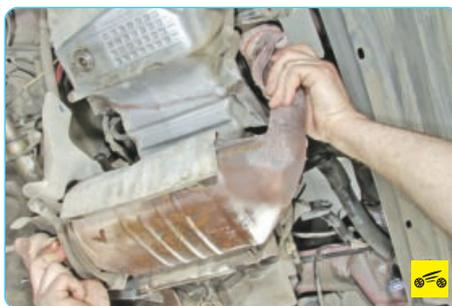
1. Отсоедините от фланца выпускного коллектора каталитический нейтрализатор (см. «Замена элементов системы выпуска отработавших газов», с. 126).
