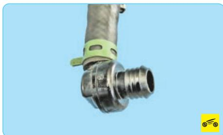
Шланг, соединяющий вакуумный усилитель с впускной трубой, надет на штуцер обратного клапана, вставленного через резиновую втулку в корпус усилителя. Клапан удерживает разрежение в усилителе при
