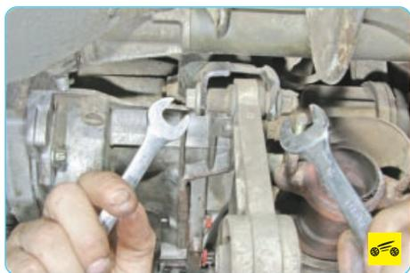
4. Удерживая от проворачивания головку болта крепления задней опоры подвески силового агрегата к кронштейну силового агрегата, отверните гайку крепления...
