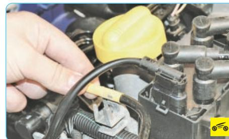
2. Извлеките из держателя на крышке головки блока цилиндров шланг продувки адсорбера.
