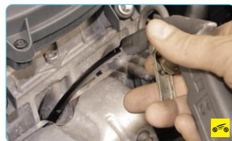
2. Продуйте свечные колодцы сжатым воздухом, чтобы избежать попадания грязи в цилиндр двигателя при выворачивании свечи.
