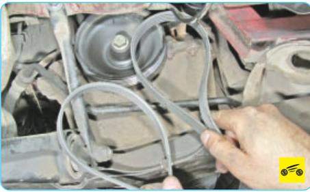
3. Снимите ремень привода вспомогательных агрегатов (см. «Замена ремня привода вспомогательных агрегатов», с. 75).
