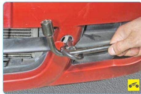
9. ...и затяните ее, используя ключ для болтов колес в качестве воротка.
