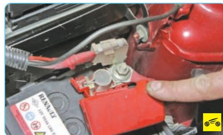
4. Откиньте защитную крышку клеммы «плюс».
