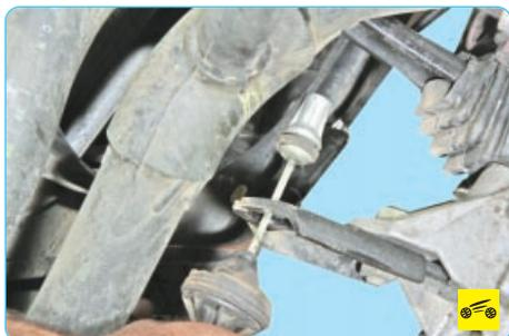
3. Извлеките демпфер оболочки троса из кронштейна на картере коробки передач.
