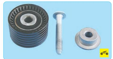
12. ...и снимите ролик вместе с болтом и шайбой.
