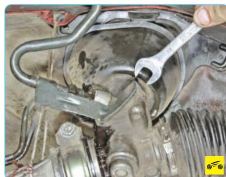
7. Выверните болт крепления кронштейна напорного трубопровода...
