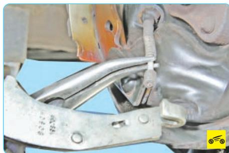
2. Снимите заднюю тормозную колодку (см. «Замена тормозных колодок тормозного механизма заднего колеса», с. 194) и отсоедините наконечник троса от разжимного рычага, отжав пассатижами вперед пружину троса.
