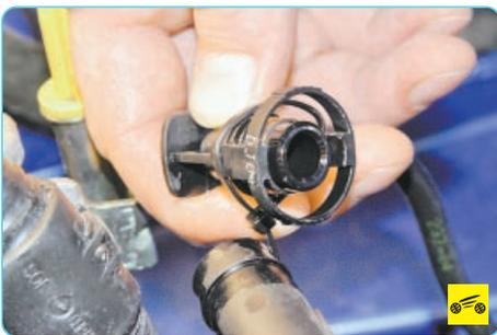
21. Отсоедините от топливной рампы топливопровод (см. «Снятие и установка топливной рампы», с. 120).
