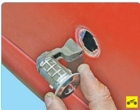
6. ...и, развернув выключатель, выведите его рычаг из отверстия панели двери.
