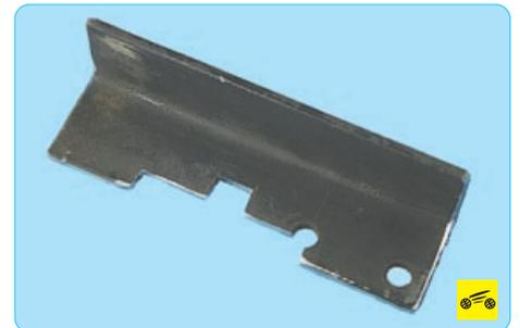
...и фиксатор распределительных валов.
