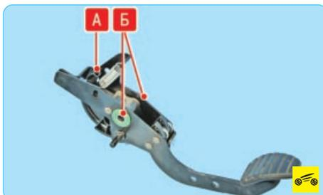
6. При необходимости замените оттяжную пружину **А** и пластиковые втулки **Б**, вынув их из проушины педали.
