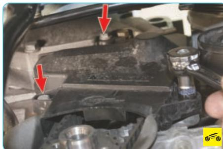
10. Выверните три болта крепления нижней крышки ремня привода газораспределительного механизма...
