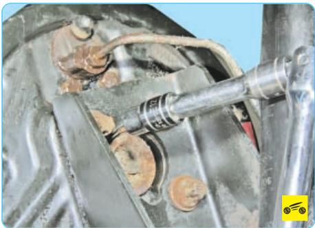
5. Выверните четыре болта крепления цапфы к кронштейну продольного рычага...
