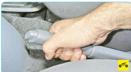
Для того чтобы затормозить автомобиль стояночным тормозом, поднимите рычаг до упора вверх – в блоке контрольных и сигнальных ламп загорится красным светом контрольная лампа 12 (см. рис. 1.9) в блоке контрольных и сигнальных ламп.
