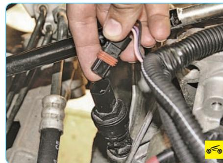
3. ...и отсоедините колодку жгута проводов от датчика скорости.
