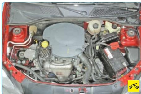
1. Откройте капот и осмотрите подкапотное пространство. При осмотре двигателя обратите внимание на наличие охлаждающей жидкости в расширительном бачке, на целостность резиновых шлангов, радиатора...
