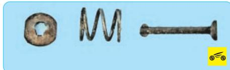
При каждой разборке тормозного механизма заменяйте новыми прижимные пружины, чашки пружин и опорные стойки.
