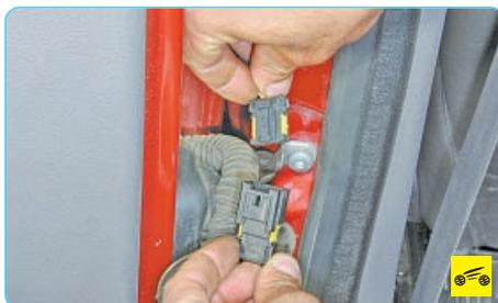
5. Нажмите на фиксатор колодки жгута проводов и разъедините колодки.
