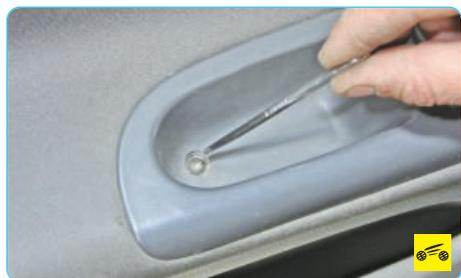
2. Выверните винт крепления блока переключателей электростеклоподъемников передних дверей и наружных зеркал.
