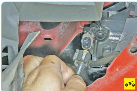
5. Отожмите фиксаторы колодок жгутов проводов противотуманных фар и отсоедините колодки от фар.
