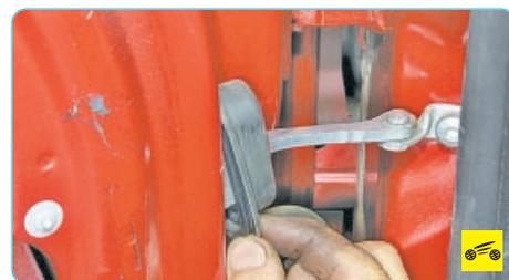
2. Подденьте резиновый уплотнитель ограничителя открывания передней двери, извлеките его из проема двери и сдвиньте по рычагу ограничителя.
