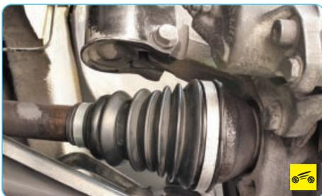
4. ...и наружных шарниров равных угловых скоростей: на чехлах не должно быть трещин и разрывов. Поврежденные чехлы замените.
