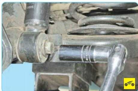
3. Выверните болт крепления амортизатора к рычагу задней подвески.
