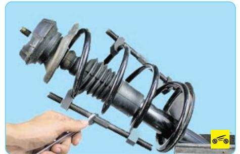
2. Установите приспособление для сжатия пружины и сожмите пружину.
