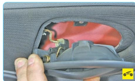
4. ...выведите наконечник тяги привода замка из втулки рычага ручки и снимите внутреннюю ручку задней двери.
