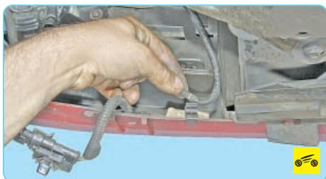
15. Извлеките из держателей на бампере жгуты неиспользуемых проводов (если они установлены).
