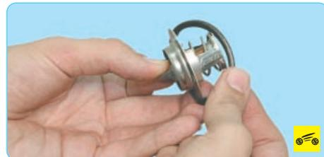
5. Снимите уплотнительное кольцо с термостата и осмотрите его. Сильно обжатое, затвердевшее или надорванное кольцо замените.
