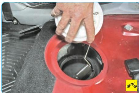
12. Аккуратно извлеките модуль топливного насоса и слейте из него топливо в заранее подготовленную емкость.
