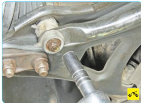
6. Отверните гайку болта крепления штанги стабилизатора поперечной устойчивости к рычагу, удерживая болт от проворачивания, и извлеките болт (см. «Замена деталей стабилизатора поперечной устойчивости», с. 157).
