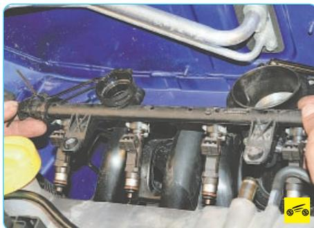
5. Снимите рампу, вынув форсунки из отверстий во впускной трубе.
