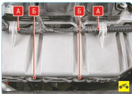
– извлеките жгут проводов из держателей **А** и торцевой головкой «на 13» отверните две гайки, расположенные в каналах **Б** защиты топливной рампы;
