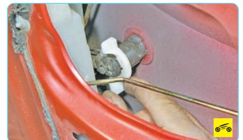
3. Сдвиньте фиксирующее кольцо с выключателя замка...
