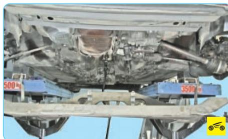
30. ...и снимите подрамник, опуская его вниз, в сборе со стабилизатором поперечной устойчивости, рычагами передней подвески и соединительными тягами.
