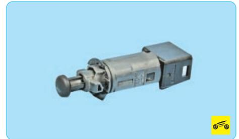
6. Установите выключатель стоп-сигнала в порядке, обратном снятию.
