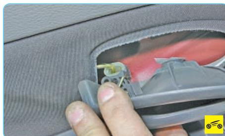
3. Разворачивая вверх переднюю часть внутренней ручки передней двери...
