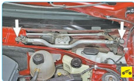
Так расположены болты крепления трапеции стеклоочистителя.
