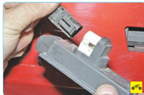
5. Отожмите фиксатор колодки жгута проводов и, отсоединив колодку от фонаря освещения номерного знака, снимите фонарь.
