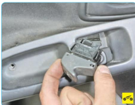
7. ...и снимите выключатель.
