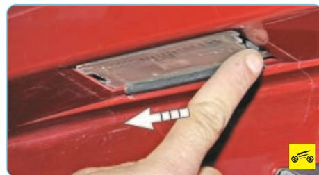
3. Сдвиньте в направлении, показанном стрелкой, фонарь освещения номерного знака...
