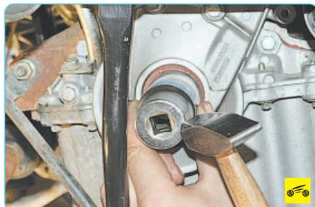
5. Смажьте рабочую кромку нового сальника моторным маслом, установите его в держатель, сориентировав рабочей кромкой внутрь двигателя, и запрессуйте сальник в держатель до упора с помощью оправки. В качестве оправки можно исполь-
