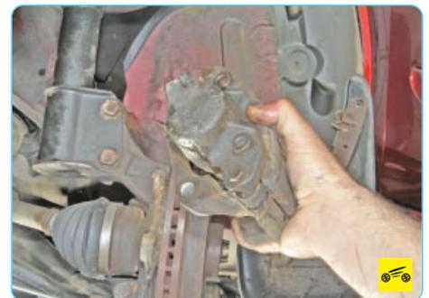
6. ...отсоедините суппорт от поворотного кулака и снимите его, свинчивая с наконечника тормозного шланга.
