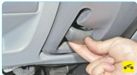
...затем заблокируйте рулевую колонку, опустив рычаг до упора вниз.
