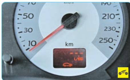
– в режиме **текущего расхода топлива (мгновенный расход)** отображается текущее потребление топлива, рассчитанное по количеству потребляемого топлива и пройденному расстоянию в конкретный момент времени. Текущий расход топлива заново рассчитывается и отображается каждые две секунды. При работе двигателя во время стоянки текущий расход отображается в л/ч. Если скорость автомобиля снижена примерно до 10 км/ч текущий расход не рассчитывается и на дисплее появится надпись «---L/100»;
