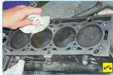
26. Очистите привалочные поверхности головки и блока.
