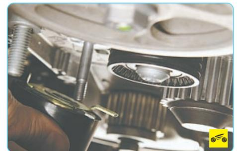
10. Окончательно отверните гайку крепления натяжителя и снимите его.
