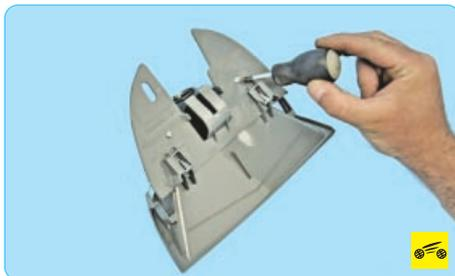
6. Выверните два винта крепления фонаря к нижней облицовке.
