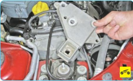
4. Снимите кронштейн правой опоры подвески силового агрегата (см. «Замена правой опоры подвески силового агрегата», с. 68).
