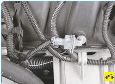
На двигателе K4J датчик температуры воздуха во впускной трубе установлен на ресивере рядом с термозаном, снимают его аналогично.
