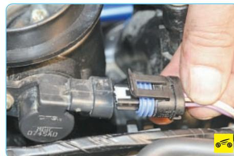
4. ...и отсоедините колодку жгута проводов от датчика положения дроссельной заслонки.
