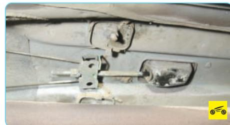
Под термозэканом расположен регулировочный узел привода стояночного тормоза.
