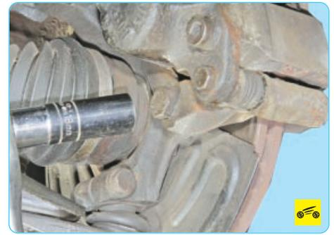
4. Ослабьте затяжку двух болтов нижнего и верхнего креплений суппорта в сборе с направляющей колодок к поворотному кулаку...
