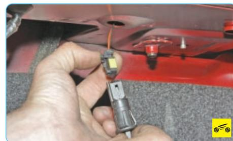
5. ...и, отсоединив колодку от выключателя, снимите выключатель.
