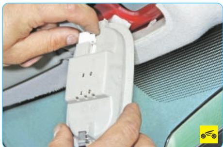
4. Сожмите фиксатор колодки жгута проводов...
