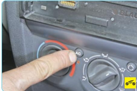
Для охлаждения воздуха, поступающего в салон автомобиля, нажмите на кнопку выключателя 2 кондиционера – в ней загорится контрольная лампа. Для выключения кондиционера повторно нажмите на кнопку.
