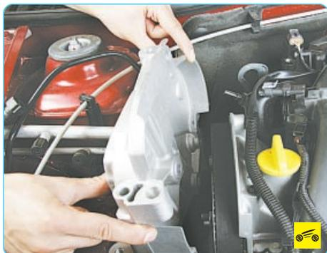
5. Снимите верхнюю крышку ремня привода газораспределительного механизма (см. «Замена и регулировка натяжения ремня, замена натяжного ролика
