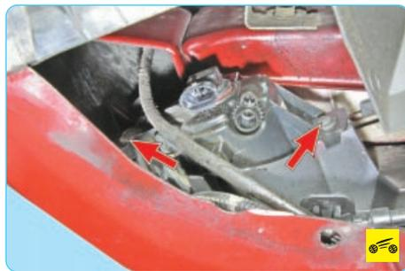
6. Выверните два винта крепления противотуманной фары...
