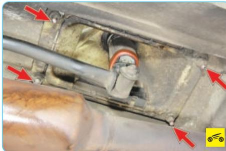
Кулиса рычага управления коробкой передач прикреплена к основанию кузова четырьмя гайками.
