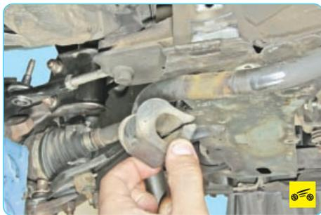
8. ...и снимите ее со штанги стабилизатора.
