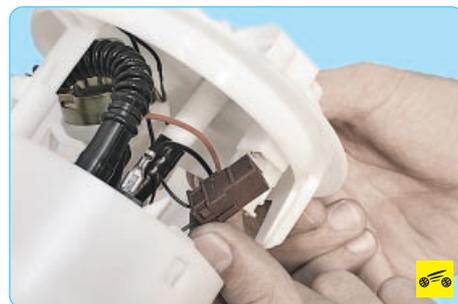
4. Отсоедините от крышки модуля колодку жгута проводов датчика указателя уровня топлива...
