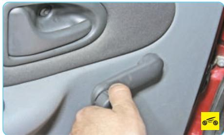
Для опускания или подъема стекла двери с механическим приводом стеклоподъемника вращайте ручку в соответствующую сторону.
