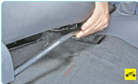
Для регулировки положения сиденья переднего пассажира в продольном направлении нужно поднять вверх блокирующую скобу. Как вариант аналогичное устройство может иметь и сиденье водителя.
