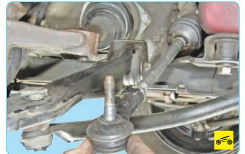
7. Отсоедините от поворотного рычага левую рулевую тягу (см. «Замена наружного наконечника рулевой тяги», с. 171).
