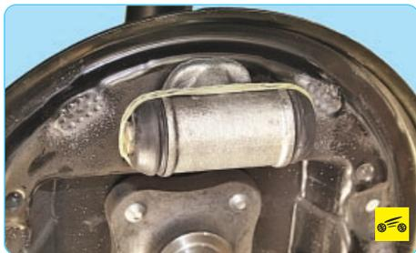
Сразу же после снятия колодок закрепите поршни рабочего цилиндра любым доступ-
