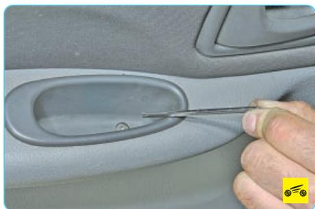
4. Выверните болт крепления обивки задней двери к кронштейну панели задней двери, расположенный в нише подлокотника...
