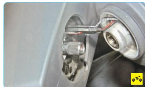
10. Выньте через отверстие в ступице жгуты проводов и снимите рулевое колесо.
