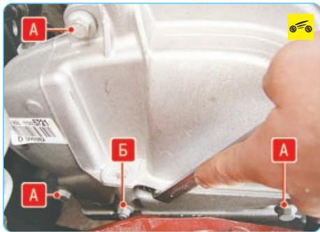
2. Выверните три болта **A** и отверните две гайки **B**.
