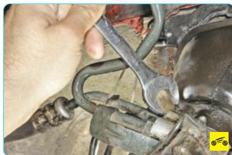
4. Выверните наконечник отводящего шланга из картера рулевого механизма...
