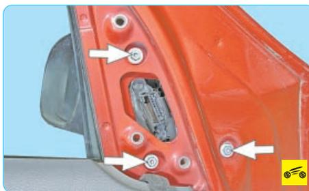
6. Выверните три винта крепления зеркала, придерживая его с наружной стороны...
