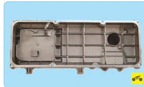
7. Промойте бензином или керосином шланги системы и внутреннюю полость крышки головки блока цилиндров от отложений. Поскольку крышка головки блока неразборная (маслоотражатель приклепан к крышке), залейте в полость между маслоотражателем и крышкой промывочную жидкость, взболтайте ее в полости и слейте.
