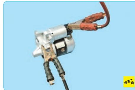
3. Соедините проводами для «прикуривания» клемму «минус» снятой с автомобиля аккумуляторной батареи с корпусом стартера. Второй провод подсоедините одним концом к клемме «плюс» аккумуляторной батареи, а другим – к выводу управляющего провода тягового реле. Если тяговое реле исправно, то раздается щелчок и выдвинется муфта привода. В противном случае тяговое реле подлежит замене.
