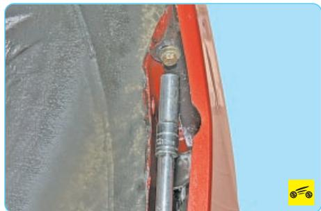
3. Изнутри обеих арок задних колес выверните по одному болту крепления заднего бампера к кузову.
