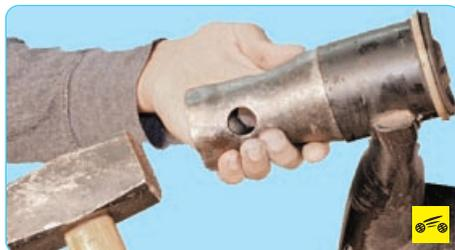
2. Установите балку в тиски и выпрессуйте сайлентблок оправкой подходящего диаметра или съемником.
