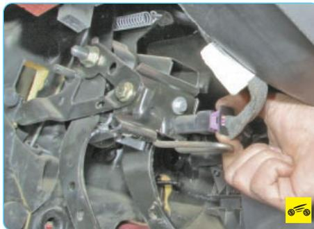
2. Нажмите на фиксатор колодки проводов выключателя стоп-сигнала...
