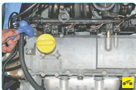
7. Выверните восемь болтов крепления крышки головки блока цилиндров.
