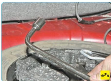
5. Извлеките из кассеты для инструментов ключ для болтов колес, расположенный в нише кассеты под домкратом.
