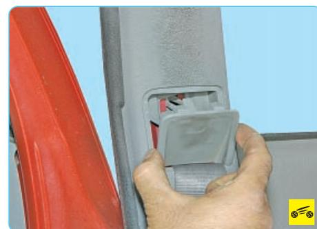
13. ...поворачивая заглушку на нижних держателях, выведите два ее верхних фиксатора из зацепления с краем окна в облицовке и снимите заглушку.
