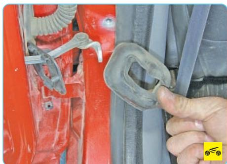
6. Снимите резиновый уплотнитель ограничителя открывания задней двери.
