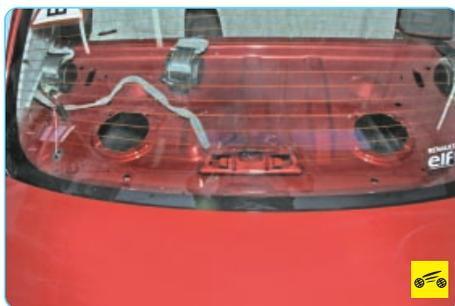
Нагревательный элемент заднего стекла состоит из горизонтальных токопроводящих полос, соединенных по обеим сторонам вертикальными шинами. Одна шина соединена с «+» бортовой электросети, другая – с «массой» кузова. Напряжение питания электрообогревателя 12 В.
