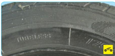
**Tubeless** – бескамерная конструкция шины.
