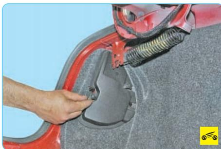
3. Отверните две гайки-барашка крепления крышки левого заднего фонаря...
