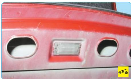
В багажнике установлен плафон освещения, который включается автоматически при открывании крышки багажника.
