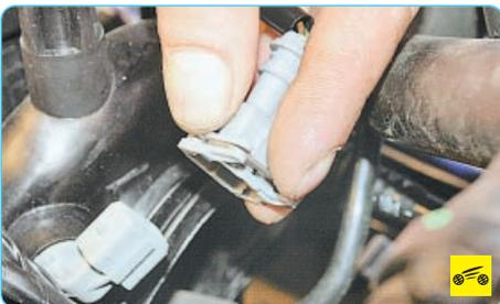
7. ...датчика температуры всасываемого воздуха...
