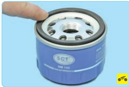
8. Уплотнительное кольцо нового фильтра смажьте чистым моторным маслом и заверните фильтр на место (руками без применения инструмента) на 3/4 оборота с момента соприкосновения кольца и фланца блока цилиндров.
