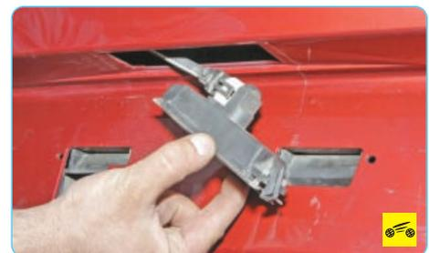
2. ...и извлеките его из проема крышки багажника.
