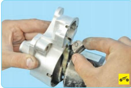
9. Раздвиньте статор и крышку со стороны привода, снимите демпфер...
