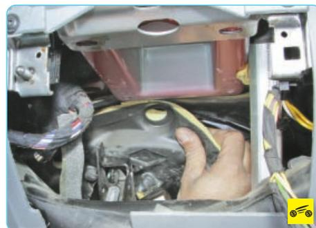
14. Снимите шумоизоляционную накладку, пропуская в ее отверстие трос привода выключения сцепления.
