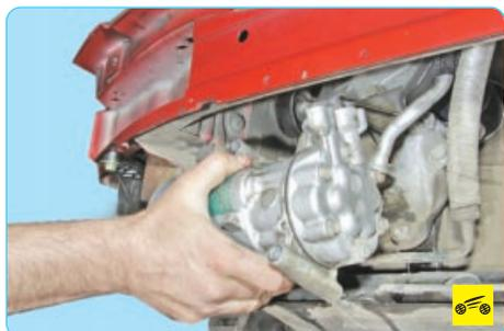
14. ...и снимите компрессор кондиционера, опустив его вниз.
