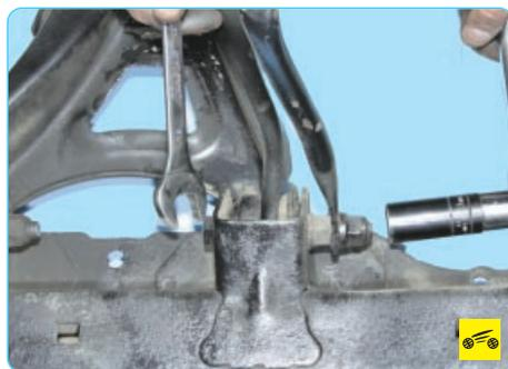
4. Отверните гайку нижнего крепления...
