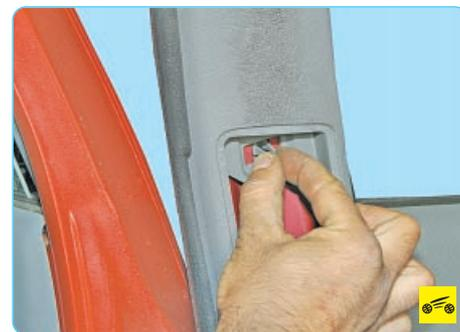
14. Сожмите усики центрального держателя облицовки центральной стойки и вытяните держатель из отверстия стойки.
