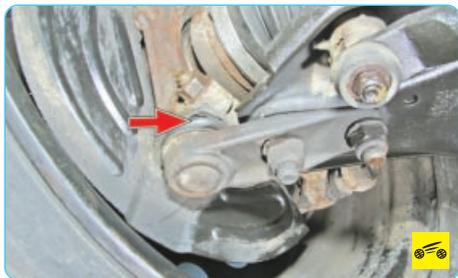
1. Проверьте состояние защитных чехлов шаровых опор. Если чехлы повреждены, замените шаровую опору.
