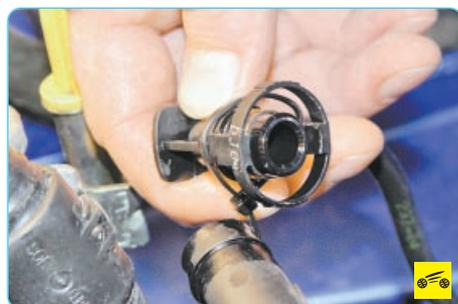
3. Сожмите фиксирующее кольцо и отсоедините трубопровод от топливной рампы.
