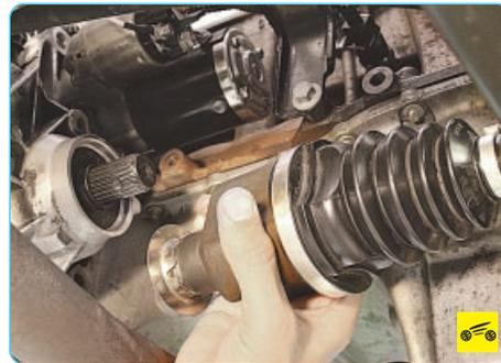
2. Сдвиньте корпус внутреннего шарнира со шлицевого хвостовика полуосевой шестерни и снимите привод правого переднего колеса с автомобиля.
