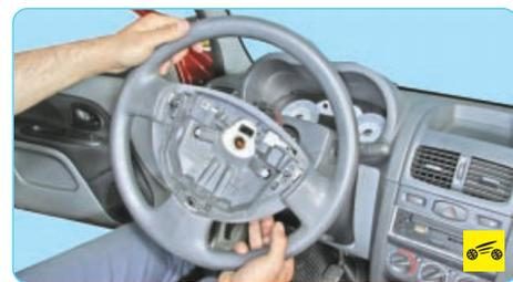
9. Снимите рулевое колесо с рулевого вала.
