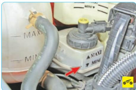
4. Проверьте уровень тормозной жидкости в бачке гидропривода тормозной системы. При необходимости долейте жидкость до нормы.
