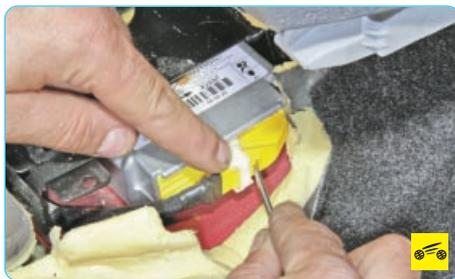
4. Отверткой отожмите держатель фиксирующей скобы колодки жгута проводов электронного блока управления системой пассивной безопасности...
