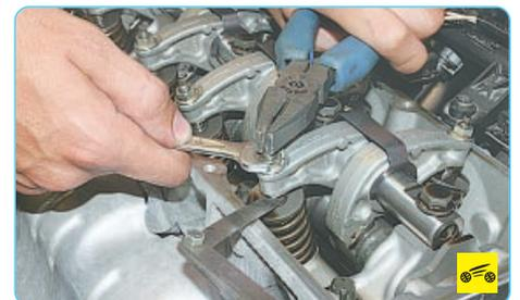
3. Ослабьте затяжку контргайки регулировочного болта одного из коромысел, удерживая болт от проворачивания пассатижами. Вставьте щуп в зазор между торцами клапана и регулировочного болта.
