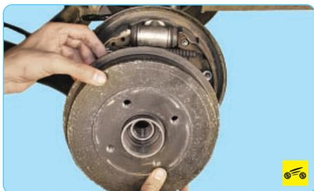
8. ...и снимите тормозной барабан вместе с подшипником с цапфы ступицы.
