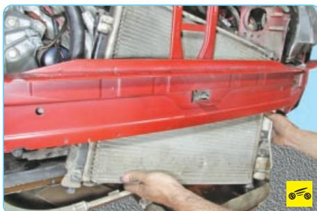
16. Приподнимите блок радиатора системы охлаждения двигателя и конденсора, выведите опоры нижнего крепления из отверстий в нижней рамке радиатора и снимите блок, опуская его вниз.
