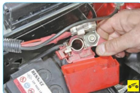
6. ...и отсоедините провод от клеммы «плюс» аккумуляторной батареи.
