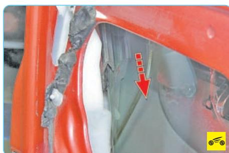
7. Снимите обойму стекла передней двери с оси ползуна и, опуская стекло вниз,
