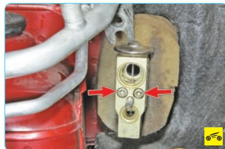
5. Выверните два болта крепления терморегулирующего клапана и снимите клапан с фланца испарителя.
