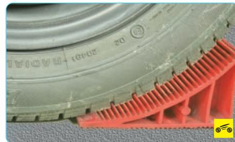
1. Затормозите автомобиль стояночным тормозом и установите противооткатные упоры («башмаки») под задние колеса.
