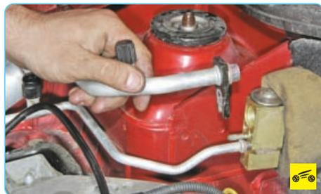
9. Отсоедините от терморегулирующего клапана трубопроводы линий низкого...
