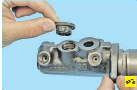
5. Если в процессе эксплуатации наблюдалась течь тормозной жидкости через соединительные втулки, извлеките втулки из отверстий корпуса цилиндра. Для этого, поддев отверткой край втулки, извлеките ее из отверстия главного тормозного цилиндра. Аналогично извлеките другую втулку.
