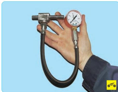
Проверка давления топлива в топливной рампе двигателя возможна только при наличии манометра с набором переходников для подключения к топливному трубопроводу.
