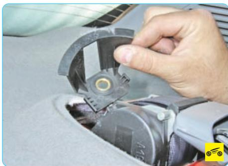
8. Снимите кронштейн облицовки задней полки...
