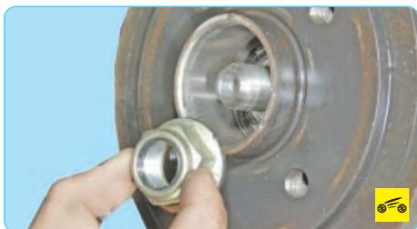
7. Отверните гайку ступицы заднего колеса...
