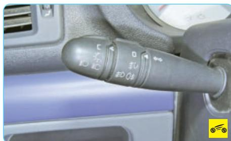
10. Проверьте работу фар, задних фонарей, дополнительного стоп-сигнала и указателей поворота. Неисправные лампы замените (см. «Замена ламп», с. 220).
