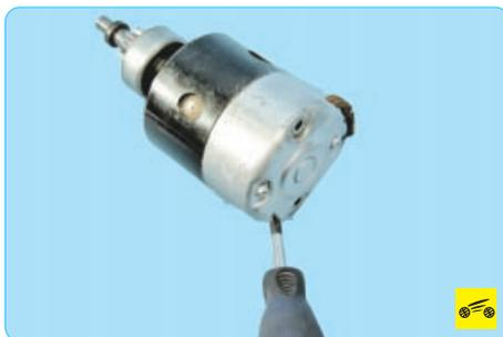
12. Выверните два винта крепления к статору крышки со стороны коллектора...
