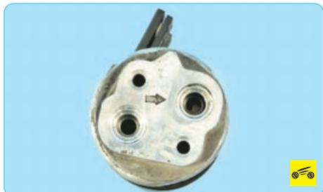
Сориентируйте ресивер-осушитель так, чтобы фланец трубопровода, соединяющий ресивер и конденсор, был установлен в отверстие, помеченное стрелкой.
