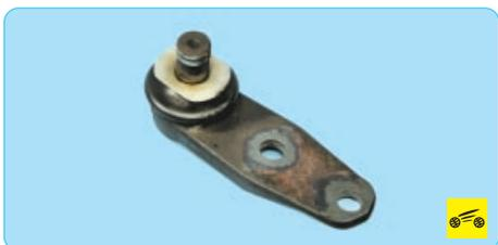
11. Установите шаровую опору и все детали в порядке, обратном снятию. Гайку стяжного болта крепления шаровой опоры к поворотному кулаку передней подвески затяните моментом 55 Н·м, гайки болтов крепления шаровой опоры к рычагу передней подвески – моментом 75 Н·м.
