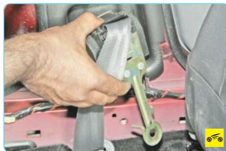
19. ...извлеките катушку из полости в стойке кузова и снимите ремень безопасности.
