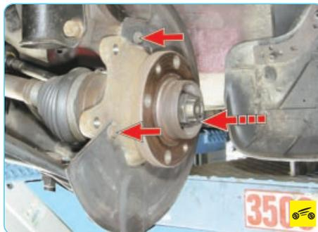
5. Выверните три болта (один из не виден) крепления щита тормозного механизма...
