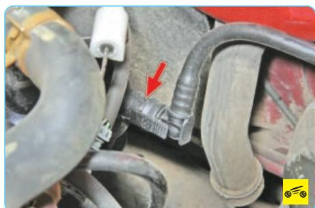
2. ...плотность посадки наконечника вакуумного шланга на штуцере впускной трубы...
