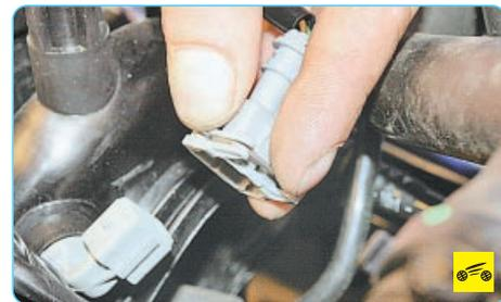
11. ...датчика температуры всасываемого воздуха...
