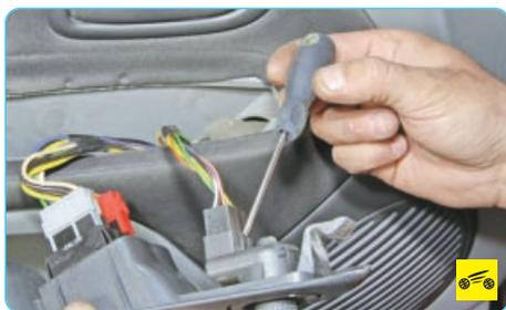
4. Сожмите фиксатор колодки жгута проводов...
