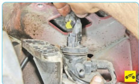
5. Отсоедините от клапана продувки адсорбера колодку жгута проводов...
