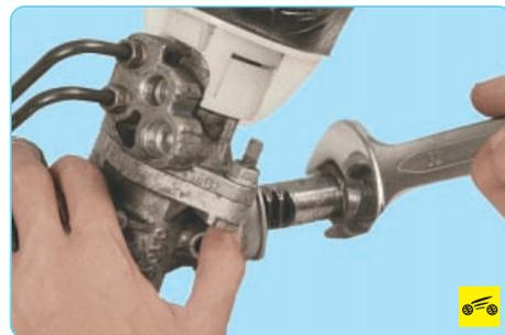
2. Выверните рулевую тягу из рейки рулевого механизма.
