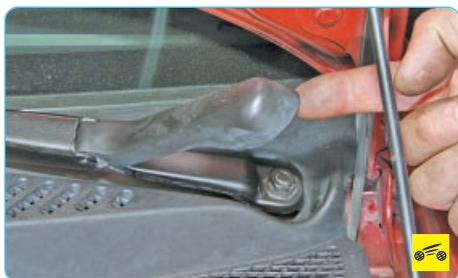
2. Подденьте край декоративной облицовки гайки крепления рычага и откиньте облицовку вверх.
