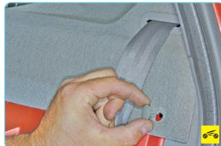
29. Поддев отверткой, извлеките три пистона крепления облицовки задней полки.
