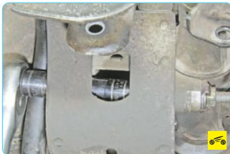
13. Удерживая болт нижнего крепления рулевого механизма к подрамнику, отверните...
