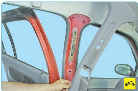
19. ...и отсоедините облицовку от стойки, преодолевая упругое сопротивление ее фиксаторов...
