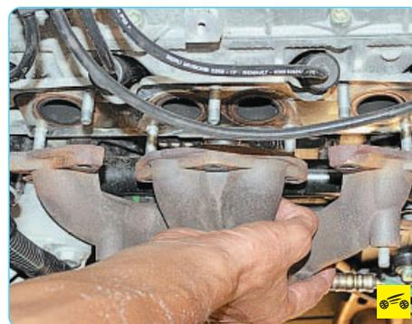
5. ...и снимите его со шпилек головки блока цилиндров...
