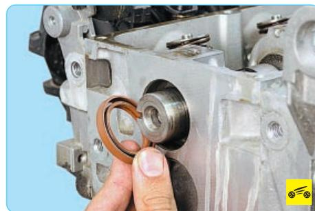
8. ...извлеките из гнезда в головке блока сальник распределительного вала.
