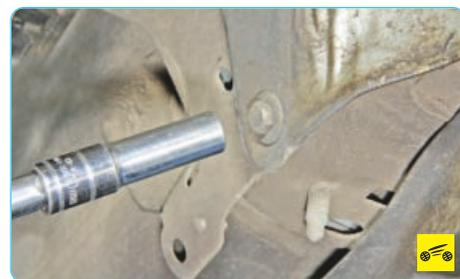
1. Выверните четыре болта крепления термозэрана промежуточной трубы...
