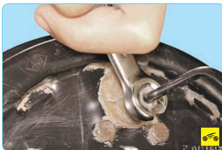
6. Отверните гайку крепления тормозной трубки к рабочему цилиндру...
