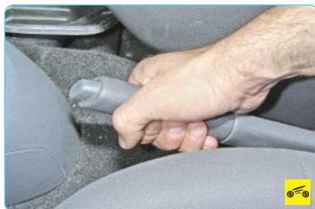
8. Проверьте работу стояночного тормоза. Для этого, поднимая рычаг до упора, подсчитайте количество щелчков. Если щелчков больше шести, стояночный тормоз надо отрегулировать.
