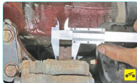
4. Установив автомобиль на домкрат, поочередно снимите передние колеса и осмотрите тормозные диски. Толщина тормозного диска должна быть не менее 17,7 мм, поверхность диска – ровной и гладкой с обеих сторон. Если поверхность диска местами покрыта ржавчиной, что обычно бывает после продолжительной стоянки автомобиля с непросушенными тормозами, попробуйте зачистить рабочую поверхность мелким наждачным полотном. Если эта процедура не помогла, придется отдать диски в шлифовку или заменить новыми.
