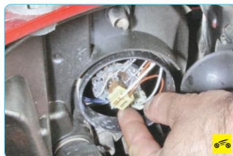
4. Поверните патрон лампы против часовой стрелки...
