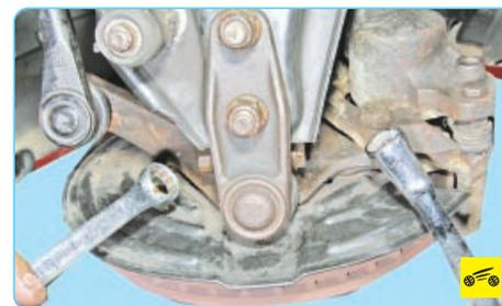
18. Отверните гайку стяжного болта клеммового соединения поворотного кулака с шаровой опорой...
