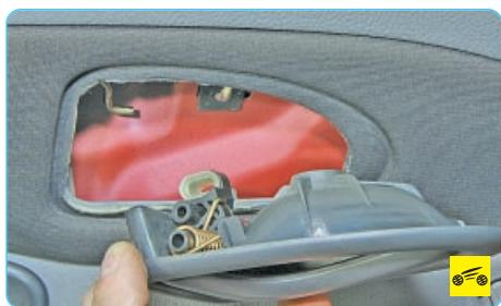
6. Снимите внутреннюю ручку двери (см. «Замена внутренней ручки привода замка задней двери», с. 257).
