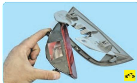
7. Снимите дополнительный стоп-сигнал.
