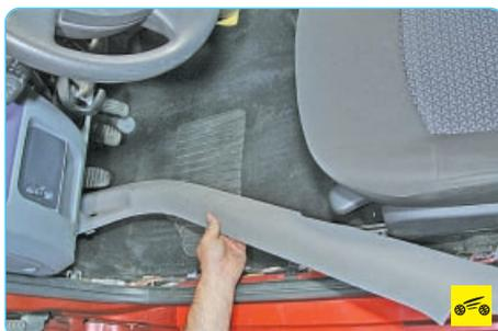
7. ...и снимите облицовку, преодолевая упругое сопротивление ее фиксаторов.
