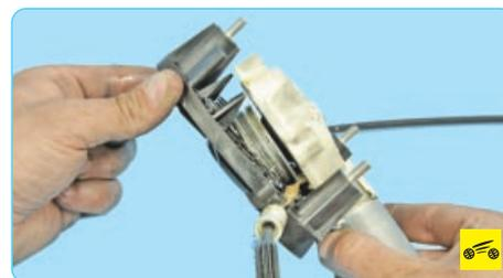
5. ...и снимите моторедуктор.
