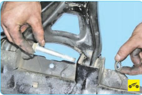
12. ...шайбу и извлеките болт из отверстия.
