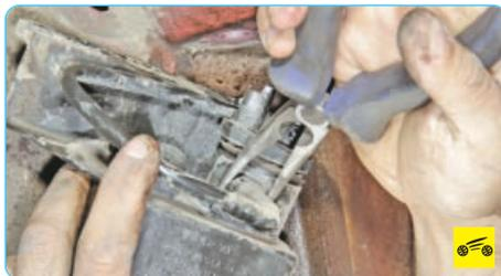
7. Сожмите фиксатор подводящей трубки...
