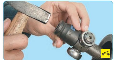
15. Напрессуйте на шлицы вала ступицу шарнира в сборе с роликами (в качестве оправки можно использовать подходящую головку из набора инструмента), совместив нанесенные при разборке метки и установите стопорное кольцо (см. п. 8). Проследите за тем, чтобы кольцо полностью вошло в проточку вала.
