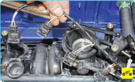
4. Отжав фиксаторы, отсоедините колодки жгута проводов от форсунок...
