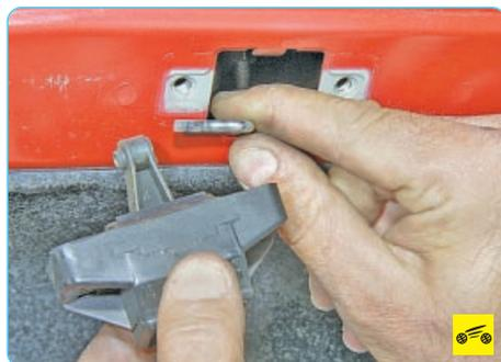
4. ...и, отсоединив от рычага замка тягу привода, снимите замок.
