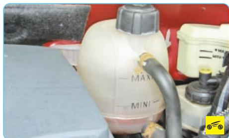
1. Расширительный бачок установлен в левой задней части подкапотного прост-
