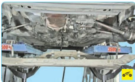
29. Снимите подрамник передней подвески (см. «Снятие и установка подрамника», с. 160).
