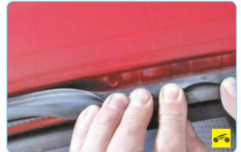
Для установки лап поперечных перекладин багажника отогните верхний край уплотнителя проемов дверей. Под уплотнителем во фланцах крыши расположены фасонные выштамповки для лап.
