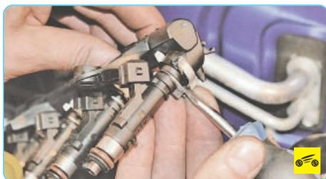
8. Подденьте отверткой фиксатор...
