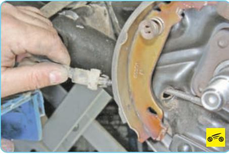
9. ...и извлеките трос из отверстия щита тормозного механизма.
