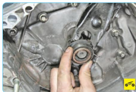
2. Перемещая подшипник выключения сцепления по направляющей втулке вперед, выведите вилку из пазов его муфты и снимите подшипник.
