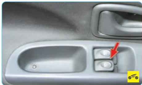
Центральный блок управления электростеклоподъемниками расположен в подлокотнике двери водителя. Блок объединяет выключатели электростеклоподъемников передних (у комплектации Expression) дверей. На двери переднего пассажира установлен один выключатель.
