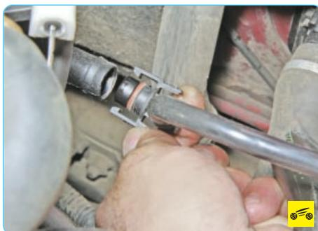
5. ...сожмите фиксатор и отсоедините вакуумный шланг от штуцера впускной трубы...
