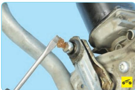
10. Установите моторедуктор стеклоочистителя в порядке, обратном снятию, смазав перед сборкой шарниры тяг консистентной смазкой.
