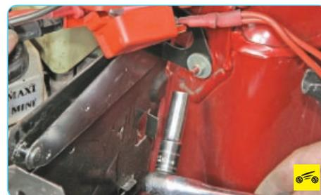
8. Отверните гайку шпильки крепления щитка аккумуляторной батареи к кузову.
