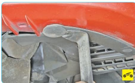
3. С обеих сторон автомобиля извлеките по одному пистону крепления передних частей подкрылков передних колес к переднему бамперу.
