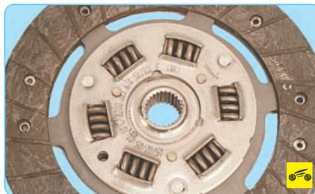
5. Проверьте надежность фиксации демферных пружин в гнездах ступицы ведомого диска, пытаясь переместить их рукой в гнездах ступицы. Если пружины легко перемещаются в гнездах или сломаны, замените диск.
