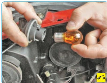
4. Поверните лампу против часовой стрелки и извлеките из патрона.
