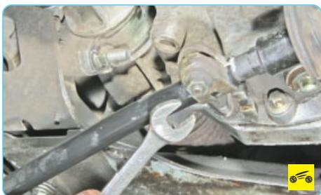
10. Отверните гайку стяжного болта хомута крепления тяги привода управления коробкой передач...
