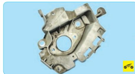
24. ...снимите кронштейн левой опоры подвески силового агрегата.
