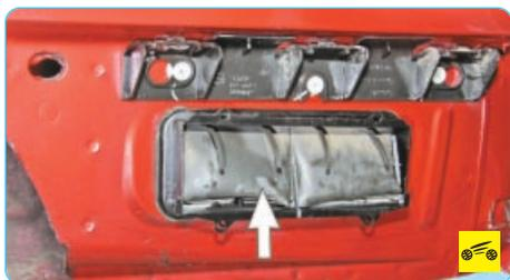
Со стороны улицы отверстия вытяжной вентиляции закрыты дефлекторами с лепестковыми клапанами, которые установлены в задней части кузова, в полости заднего бампера (вид со снятым задним бампером).
