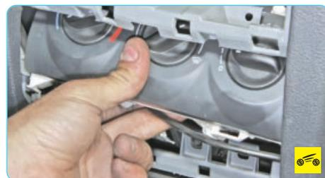
9. ...вдвиньте верхнюю часть блока в нишу панели приборов и разверните блок.
