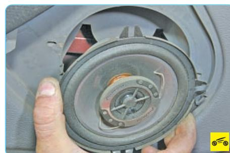
12. Снимите динамик передней двери (см. «Снятие и установка динамиков аудиосистемы», с. 237).
