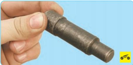
Подойдет и имеющаяся в продаже оправка для переднеприводных автомобилей ВАЗ.
