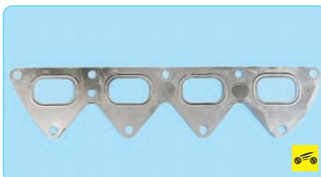
Различие только в форме прокладки. При определенных навыках исполнителя при замене прокладки выпускного коллектора можно не отсоединять полностью приемную трубу от коллектора. Достаточно отвернуть гайки крепления фланца трубы до конца шпилек, не снимая гайки полностью. При этом выпускной коллектор можно будет снять со шпилек головки блока цилиндров и отвести от нее на расстояние, необходимое для снятия прокладки.
