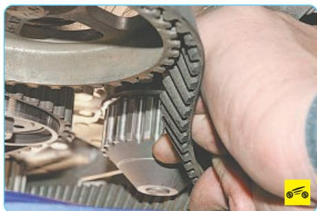
4. Сняв ремень с зубчатых шкивов водяного насоса...
