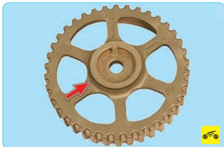
**Зубчатый шкив распределительного вала устанавливайте выступающей частью ступицы к двигателю.**
