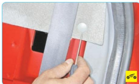
3. Подденьте отверткой пистон крепления обивки задней полки...
