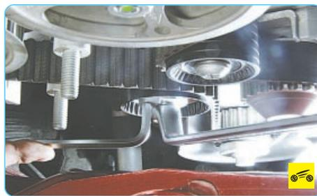
8. Зафиксируйте ключом-шестигранником «на 6» натяжной ролик и ослабьте гайку крепления натяжителя.
