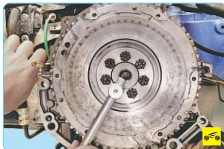
3. Выверните семь болтов крепления маховика, удерживая с помощью отвертки маховик от проворачивания.
