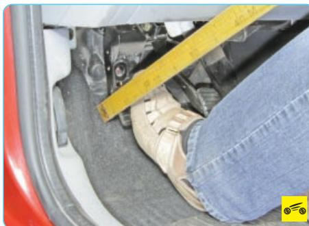
2. Не изменяя положения линейки, нажмите на педаль до упора и вновь измерьте расстояние между накладкой педали и ковриком. Разность двух измерений должна быть 70–80 мм. Если ход педали больше, возможно нечеткое выключение сцепления (сцепление «ведет»). При чрезмерно малом ходе сцепление не полностью включается (сцепление «буксует»).
