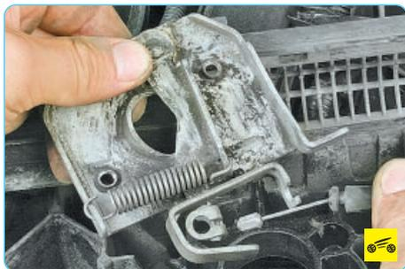
6. Выведите наконечник троса из паза рычага замка и снимите замок капота.
