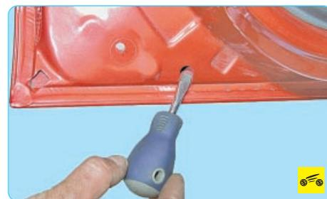
2. Дренажные отверстия со временем забиваются дорожной грязью, поэтому периодически (желательно при каждой мойке автомобиля) прочищайте эти отверстия тонкой деревянной палочкой или отверткой.
