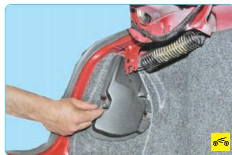
3. Отверните две гайки-барашка крепления крышки технологического окна в обивке багажника и в кузове.
