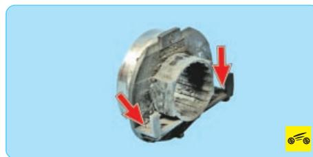
Вилка своими цапфами вставлена до упора в глухие пазы муфты подшипника и опирается на шаровую опору, ввернутую в картер сцепления. Фиксацию вилки в определенном положении обеспечивает ее гофрированный резиновый чехол, вставленный в окно картера сцепления.
