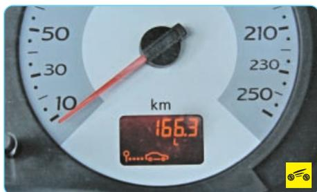
– в режиме **общего расхода топлива** отображается суммарный расход в литрах с момента последнего обнуления счетчика;
