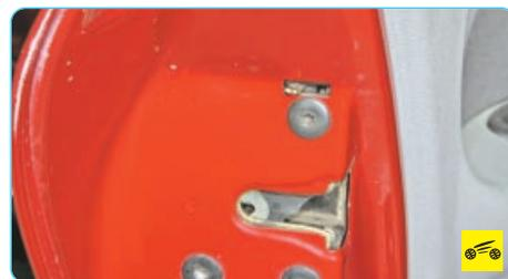
Замки задних дверей оборудованы механизмом, исключающим возможность открывания дверей изнутри («детский» замок).
