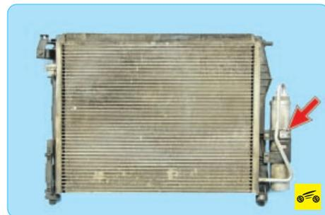
Ресивер-осушитель установлен на конденсоре с левой стороны (по направлению движения) и представляет собой неразборный блок. Внутри корпуса находится фильтрующий элемент, заполненный гранулами осушителя (силикагеля). Проходящий через ресивер сжиженный хладагент очищается от возможных примесей, грязи и влаги.
