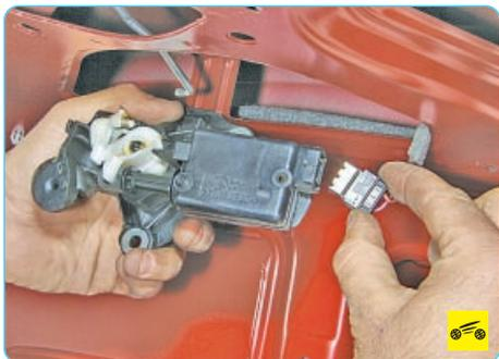
8. Сожмите фиксаторы колодки жгута проводов, отсоедините колодку от разъема привода замка крышки багажника и снимите привод.
