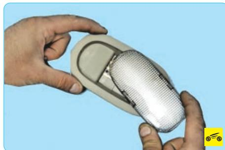
3. ...и снимите рассеиватель с корпуса плафона.
