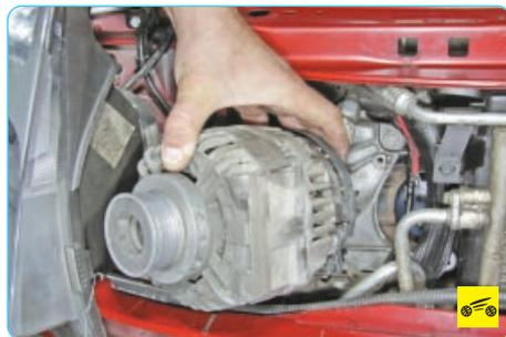
7. Снимите генератор (см. «Снятие и установка генератора», с. 205).
