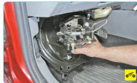
12. Снимите педальный узел, пропуская трос привода выключения сцепления в отверстие монтажной плиты.
