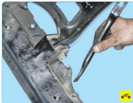
5. ...и снимите тягу (для наглядности показано на снятом подрамнике передней подвески).
