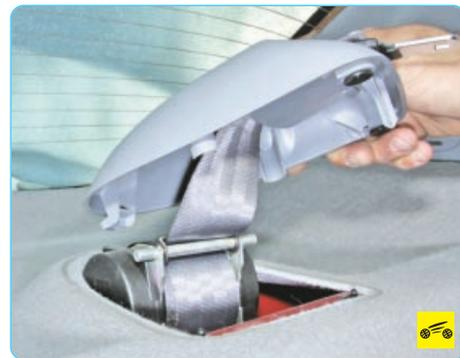
4. ...и, преодолевая сопротивление фиксаторов, отделите облицовку от обивки задней полки.
