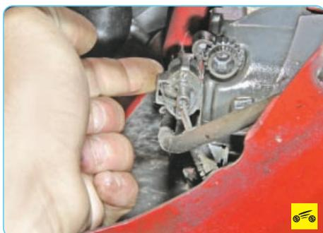
4. Сожмите фиксатор колодки жгута проводов...
