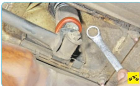
6. Отверните гайку пальца тяги управления коробкой передач...
