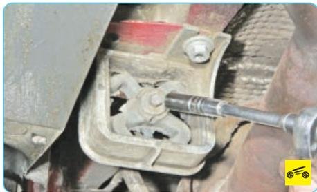
1. Выверните болт крепления кронштейна основного глушителя к подушке.
