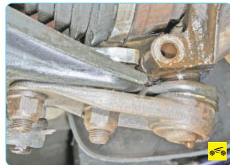
5. Разожмите клеммовое соединение отверткой...
