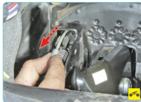
12. В салоне автомобиля, потянув наконечник троса привода выключения сцепления в направлении, показанном на фото стрелкой...
