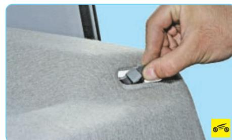
11. ...проденьте в проем обивки задней полки также пряжки ремня и нижнего крепления ремня безопасности.
