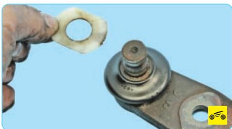
10. Снимите пластмассовую шайбу с пальца шаровой опоры.
