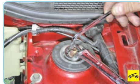
4. Удерживая одним ключом шток амортизатора от проворачивания, вторым ключом ослабьте затяжку гайки упорной шайбы верхнего крепления амортизаторной стойки.
