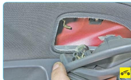
10. ...затем отсоедините от рычага внутренней ручки тягу замка передней двери (см. «Замена внутренней ручки привода замка передней двери», с. 252).
