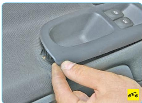
3. ...извлеките винт из отверстия и подденьте заднюю часть блока.
