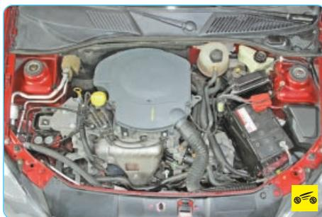
5. Осмотрите двигатель и подкапотное пространство. Обратите внимание на потеки бензина, масла и охлаждающей жидкости. Убедитесь в целостности электропроводки. Проверьте посадку высоковольтных проводов в гнезда модуля зажигания, на свечах (целость и посадку катушек зажигания).
