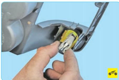
7. Отожмите фиксатор световода патрона прикуривателя...
