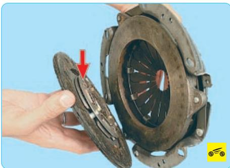
Устанавливайте ведомый диск таким образом, чтобы выступающая часть ступицы диска (показана стрелкой) была направлена в сторону диафрагменной пружины кожуха сцепления.
