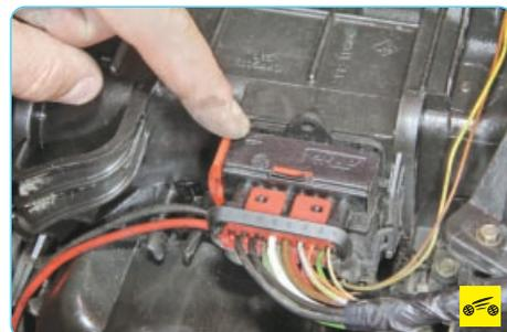
8. Подденьте фиксатор колодки жгута проводов вентилятора отопителя...
