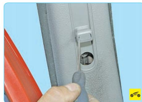
15. Поддев отверткой край фиксатора рукоятки механизма регулирования переднего ремня безопасности по высоте...
