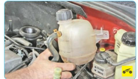
2. Для удобства работы отсоедините от щита передка расширительный бачок системы охлаждения (см. «Снятие и установка расширительного бачка», с. 108) и отведите бачок в сторону, не отсоединяя от него шланги.
