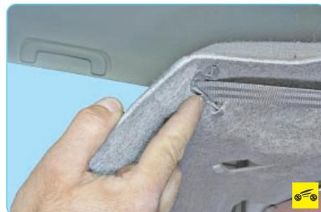
31. ...приподнимите ее, сожмите фиксаторы двух окантовок отверстий для прохода ремней безопасности...
