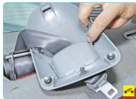
5. Разверните облицовку, отожмите фиксаторы направляющей ремня безопасности...
