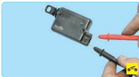
5. При подаче тока шток электропривода должен втянуться. Если этого не произошло, замените электропривод новым.
