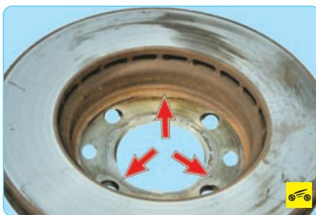
Перед установкой диска тщательно очистите привалочные поверхности диска и ступицы от ржавчины и окалины, так как даже мельчайшая частица, зажатая между привалочными поверхностями, вызовет биение диска и вибрации при торможении.
