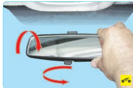
Положение внутреннего зеркала заднего вида регулируют поворотом в нужную сторону на шарнире кронштейна.
