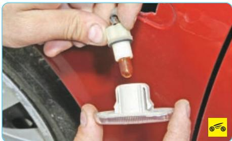
1. Снимите боковой фонарь указателя поворота (см. «Замена бокового фонаря указателя поворота», с. 226).
