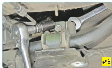
5. Удерживая головку болта от проворачивания, отверните гайку крепления штанги стабилизатора поперечной устойчивости к подрамнику передней подвески, извлеките болт из отверстия...
