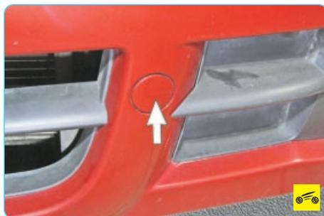
Место крепления буксирной проушины расположено в левой части переднего бампера автомобиля.
