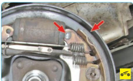
7. Проверьте подвижность поршней рабочего цилиндра заднего тормозного механизма. Для этого попробуйте сдвинуть с места поршни, сдавив тормозные колодки. Если сдвинуть поршни не удастся, значит, их заклинило в тормозном цилиндре.
