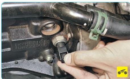
2. Нажмите на фиксатор и отсоедините от датчика колодку жгута проводов.
