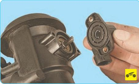
8. ...и снимите датчик положения дроссельной заслонки.
