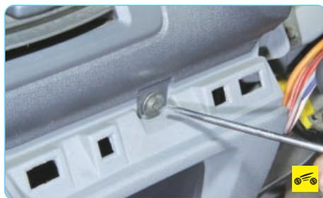
4. ...и выверните расположенный под ней винт крепления верхней накладки панели приборов.
