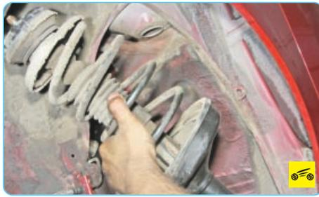
12. Снимите амортизаторную стойку в сборе.
