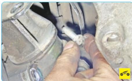
17. ...и извлеките болт из отверстия. Аналогично выверните и извлеките из отверстий болты нижнего и верхнего креплений рулевого механизма к подрамнику с другой стороны.
