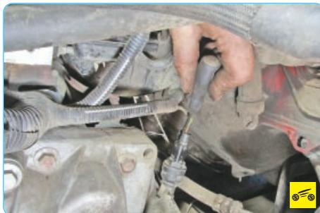
17. Отжав тонкой отверткой фиксатор колодки жгута проводов датчика скорости...
