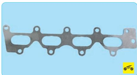
8. Снимите прокладку впускной трубы.
