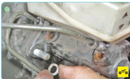
8. ...снимите установленные под ними пружинные шайбы...
