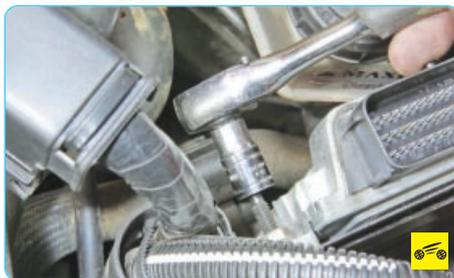
4. Отверните четыре гайки крепления блока...
