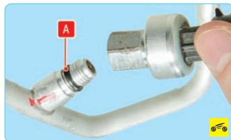
6. Установите датчик давления в порядке, обратном снятию. Уплотнительное кольцо датчика обязательно замените новым.
