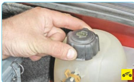
4. Заверните пробку расширительного бачка, пролитую жидкость удалите чистой тряпкой.
