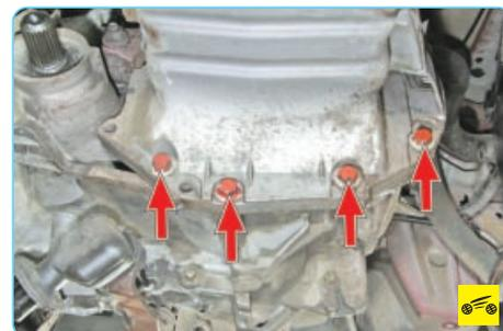
35. Выверните четыре болта крепления масляного картера к картеру сцепления.
