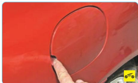
1. Для того чтобы открыть крышку люка топливного бака, подденьте край крышки люка...
