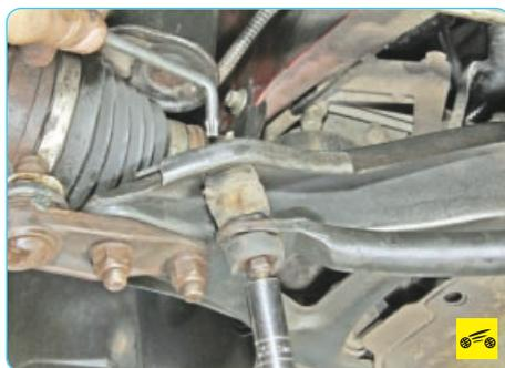
2. Отверните гайку болта крепления штанги стабилизатора поперечной устойчивости к рычагу передней подвески, удерживая болт от проворачивания.
