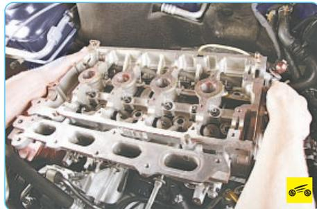
24. Снимите головку блока цилиндров в сборе с выпускным коллектором.
