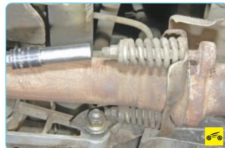
3. Отверните две гайки крепления нейтрализатора к блоку основного и дополнительного глушителей.
