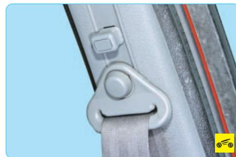
На автомобиле также предусмотрена регулировка передних ремней безопасности по высоте. Для регулировки положения ремня опустите или поднимите крепление ремня таким образом, чтобы ремень не касался шеи и не давил на плечо.
