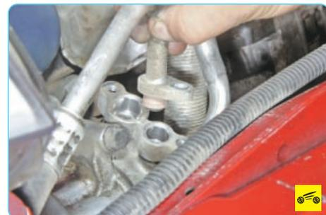
12. ...извлеките болт из отверстия и отсоедините трубопровод от компрессора.
