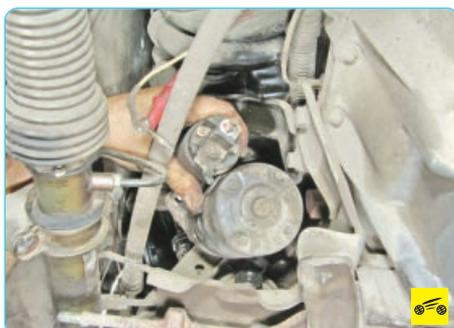
19. Снимите стартер (см. «Снятие и установка стартера», с. 208).
