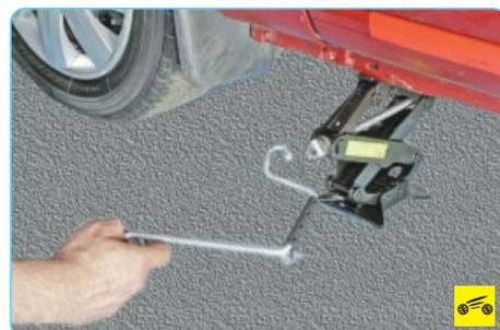
11. Вденьте крючок воротка в отверстие силового винта домкрата и поднимите автомобиль, вращая вороток по часовой стрелке.
