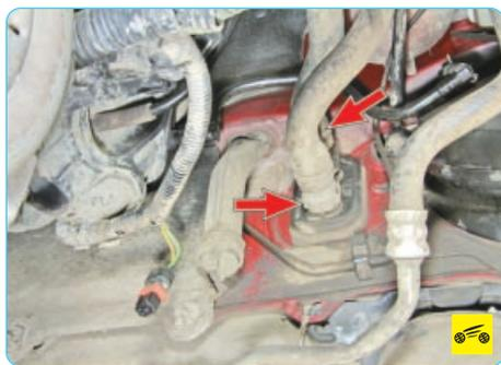
5. ...а также с патрубками радиатора отопителя. В случае подтекания охлаждающей жидкости замените хомуты крепления шлангов.
