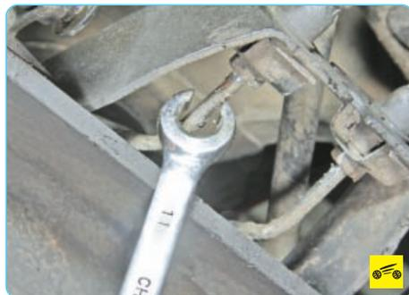
1. Для замены шланга тормозного механизма заднего колеса отверните гайку крепления тормозной трубки к нижнему наконечнику шланга...
