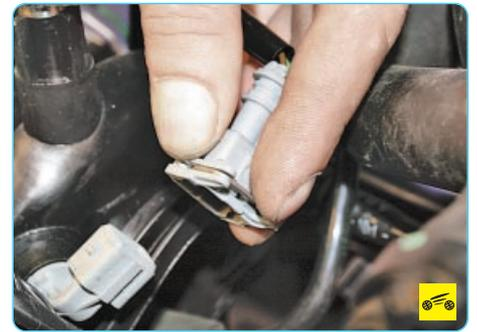
3. Отсоедините колодку жгута проводов от датчика, сжав пружинный фиксатор.
