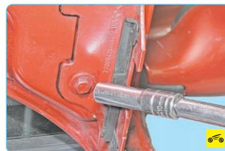
5. Выверните по два болта крепления капота к обеим петлям и снимите капот.
