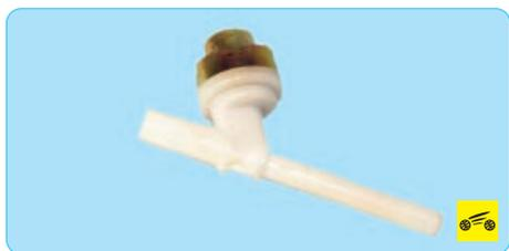
**Регулятор давления топлива**, установленный в топливном модуле, поддерживает постоянное давление топлива в системе питания двигателя на всех режимах работы двигателя. Подача электрического топливного насоса больше, чем это необходимо для обеспечения работоспособности системы. Поэтому при работе двигателя часть топлива благодаря регулятору давления постоянно сливается в топливный бак.
