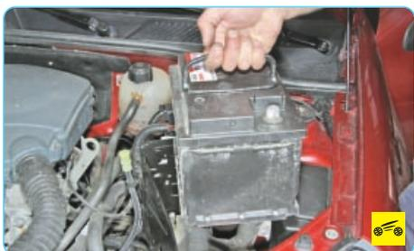
1. Снимите аккумуляторную батарею.
