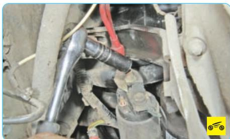
3. Отверните гайку крепления силового провода...
