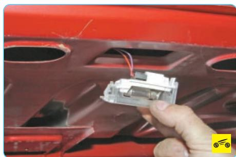
4. ...и извлеките его из проема задней полки.
