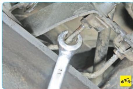
2. Отверните гайку крепления трубопровода...
