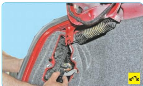
5. Сожмите фиксатор колодки жгута проводов...
