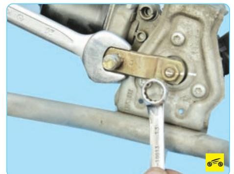
6. Ослабив ключом и отвернув гайку крепления кривошипа...
