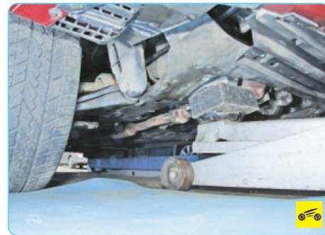
2. Установите опору через деревянную или резиновую проставку под картер двигателя.
