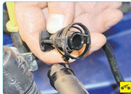
25. Отсоедините топливный шланг от топливной рампы (см. «Снятие и установка топливной рампы», с. 120).
