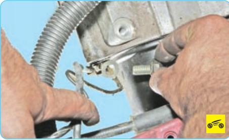
11. ...и отсоедините провод от картера коробки передач.
