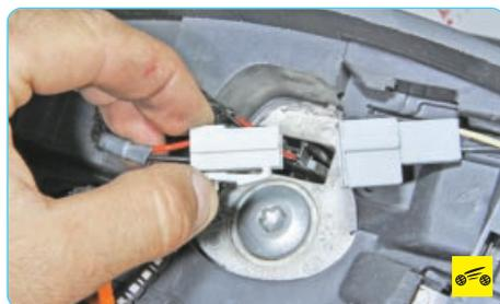
5. ...и отсоедините колодку жгута проводов от рулевого колеса.
