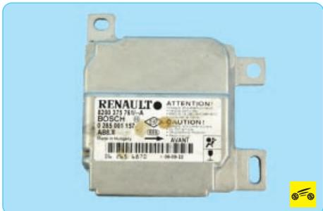
– электронный блок управления, установленный под облицовкой тоннеля пола и управляющий системой;
