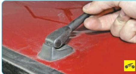
При необходимости (например, при выезде из гаража с очень низкими воротами), чтобы не повредить антенну, ее можно откинуть назад до горизонтального положения.
