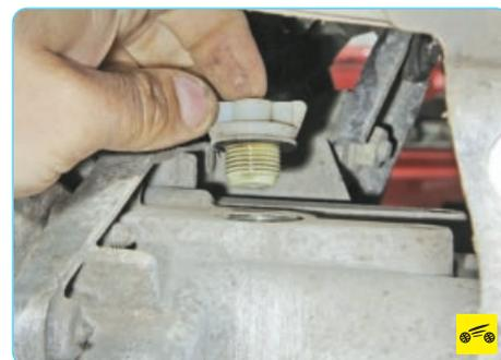
1. Выверните пробку наливного отверстия, подставив емкость на случай вытекания масла.
