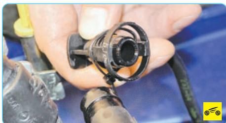
28. Отсоедините от топливной рамы топливопровод (см. «Снятие и установка топливной рамы», с. 120).
