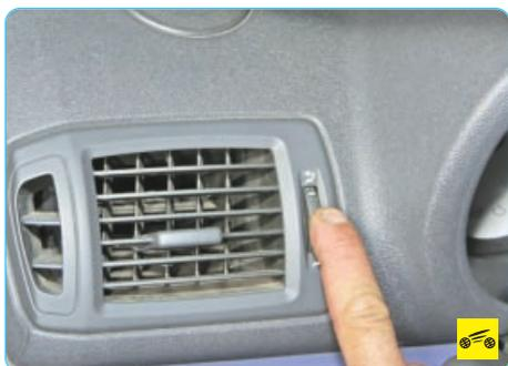
Количество воздуха, подаваемого через сопла, регулируют рукоятками, расположенными рядом с каждым соплом. При повороте рукоятки до упора вверх заслонка полностью открывается (максимальный поток воздуха). При повороте до упора вниз заслонка полностью закрывается, перекрывая поток воздуха.
