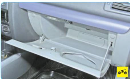
**16** – вещевой ящик. Служит для хранения мелких вещей и открывается при нажатии на ручку замка (см. «Вещевые ящики салона, электрическая розетка и пепельницы», с. 28).
