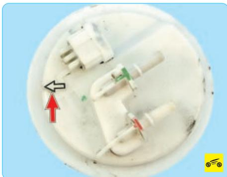
Следите за тем, чтобы при установке модуля стрелка на крышке модуля была направлена вперед по ходу движения автомобиля.
