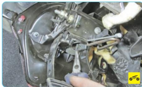
5. Захватив пассатижами край пружинного фиксатора пальца вилки толкателя вакуумного усилителя тормозов...
