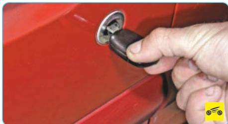
Передние двери можно заблокировать снаружи ключом, повернув по часовой стрелке цилиндр выключателя замка двери водителя или против часовой стрелки цилиндр двери переднего пассажира...
