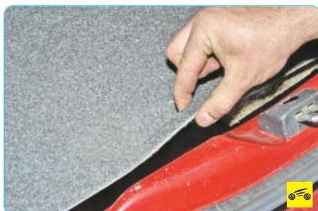
4. Потяните за край покрытия ниши для запасного колеса в багажнике...
