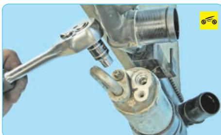
18. Выверните болт крепления фланца трубопровода от ресивера-осушителя к конденсору...
