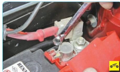
5. Ослабьте стяжной болт наконечника провода...
