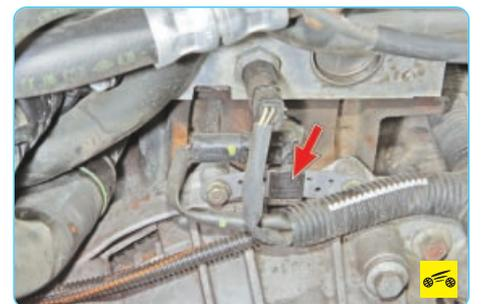
– датчик верхней мертвой точки (ВМТ) и частоты вращения коленчатого вала (установлен на картере сцепления) – полный отказ системы впрыска, двигатель не пускается;
