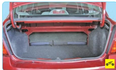
Стенки багажника облицованы формованными обивками, а на пол уложено мягкое,битое ворсовым материалом покрытие.
