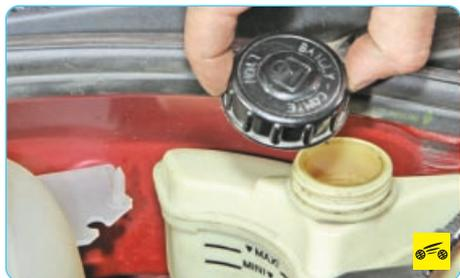
1. Отверните пробку бачка гидроусилителя рулевого управления...
