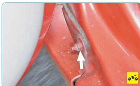
8. ...и нижнюю гайки заднего крепления крыла.
