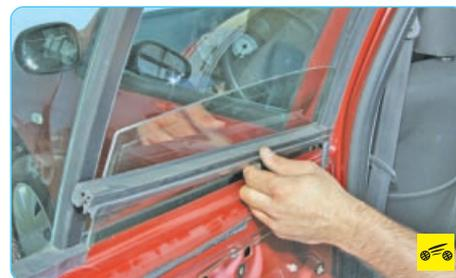
4. ...и снимите уплотнитель с отштамповки проема стекла задней двери с внутренней стороны.
