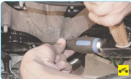
Пробейте отверткой корпус масляного фильтра и, используя ее как рычаг, строньте фильтр с места. Пробивайте корпус фильтра как можно ближе к его дну, чтобы не повредить штуцер в блоке цилиндров.
