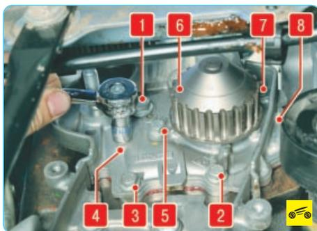
8. Затяните болты крепления водяного насоса в последовательности, указанной на фото. Болты М6 затяните моментом 10 Н·м, болт М8 – моментом 22 Н·м.
