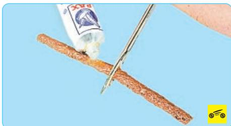
8. Нанесите на жгут слой клея из набора. Поверхность отверстия в шине также обработайте клеем.
