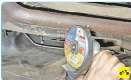
1. Между основным и дополнительным глушителями нанесены специальные метки, посередине между которыми нужно распиливать трубу.
