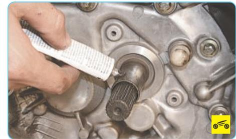
4. Смажьте тонким слоем тугоплавкой консистентной смазки наружную поверхность направляющей втулки...
