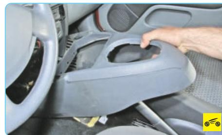
1. Снимите облицовку тоннеля поля (см. «Снятие и установка облицовки тоннеля пола», с. 266).
