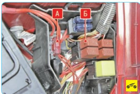
7. Замените предохранитель **А** в монтажном блоке, установленном в подкапотном пространстве. Если вентилятор после замены предохранителя так и не начал работать, замените реле **Б** в этом же монтажном блоке. Если после замены предохранителя и реле вентилятор не начал работать, проверьте электродвигатель, для чего возьмите два дополнительных провода и подайте на него питание непосредственно от аккумуляторной батареи. Провода должны быть надежно закреплены и изолированы.
