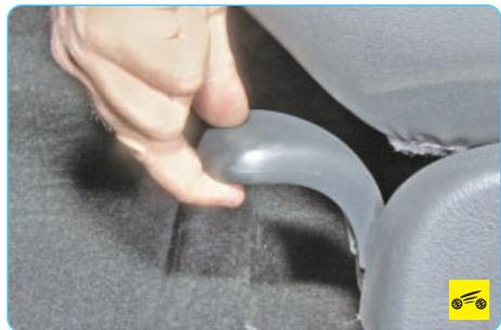
Для регулировки положения сиденья водителя в продольном направлении потяните вверх блокирующий рычаг и переместите сиденье на салазках в удобное положение. После установки сиденья опустите рычаг и небольшими перемещениями сиденья вперед-назад добейтесь его надежной фиксации.
