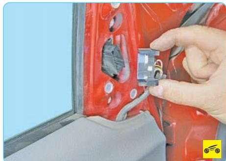
4. Нажмите на фиксатор колодки жгута проводов зеркала и отсоедините колодку.
