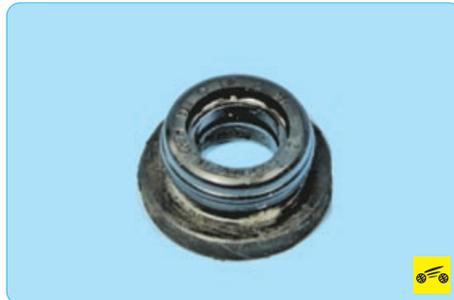
**Повторное использование соединительных втулок не допускается, замените их новыми.**
