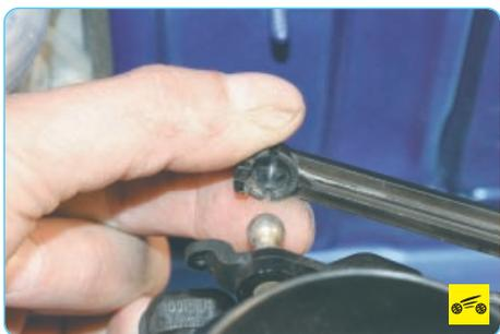
8. ...отсоедините промежуточную тягу привода дроссельной заслонки от рычага дроссельного узла.
