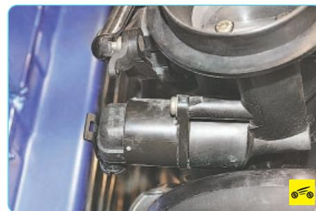
Однако необходимо отметить, что чаще всего эта неисправность бывает вызвана отказом регулятора холостого хода или подсосом постороннего воздуха через неплотные соединения шлангов, присоединенных к впускной трубе. Если заменой регулятора (см. «Замена регулятора холостого хода», с. 123) и подтяжкой хомутов шлангов восстановить холостой ход не удалось, обратитесь к специалистам.
