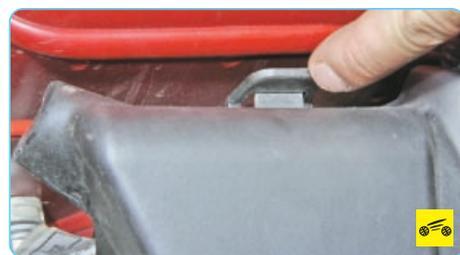
3. Для получения доступа к монтажному блоку, расположенному в моторном отсеке, отожмите фиксатор...
