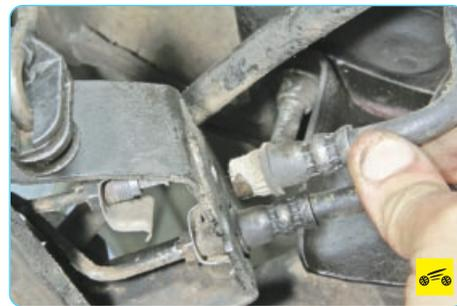
4. Извлеките наконечник тормозного шланга из отверстия в кронштейне балки задней подвески. Аналогично отсоедините от кронштейна наконечник второго шланга.
