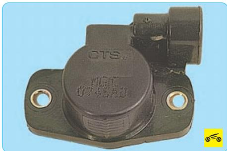
**Датчик положения дроссельной заслонки** установлен сбоку на дроссельном узле и связан с осью дроссельной заслонки.
