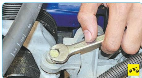
35. Выверните болт крепления кронштейна насоса гидроусилителя рулевого управления к головке блока.
