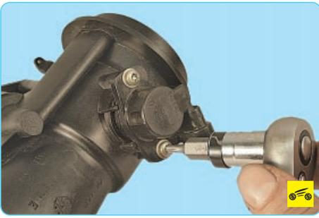
7. Для замены датчика выверните два болта его крепления (для наглядности показано на снятом дроссельном узле)...
