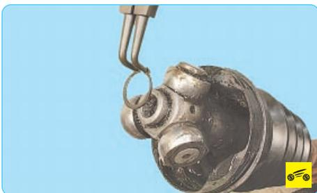
8. Снимите стопорное кольцо ступицы шарнира, разжав его съемником стопорных колец или круглогубцами и выведя кольцо из проточки вала.
