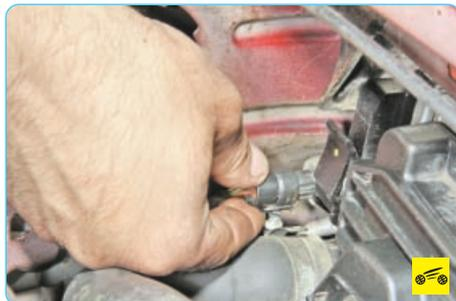
2. Отожмите фиксатор колодки жгута проводов датчика давления...
