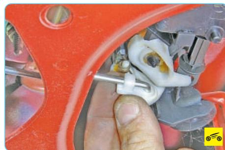
3. Подденьте фиксатор тяги привода замка крышки багажника...
