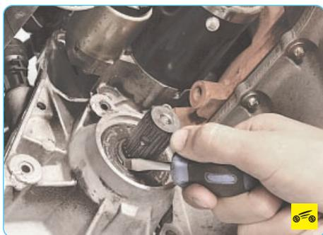
4. Поддев отверткой, извлеките сальник из гнезда в картере коробки передач.
