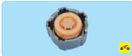
**Исправность клапанов пробки очень важна для нормальной работы системы охлажде-**
