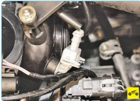
**Датчик температуры воздуха во впускной трубе** установлен на впускной трубе рядом с дроссельным узлом. Датчик представляет собой термистор с отрицательным температурным коэффициентом: электрическое сопротивление датчика уменьшается с повышением температуры. По информации о температуре воздуха от датчика электронный блок управления регулирует количество впрыскиваемого топлива.
