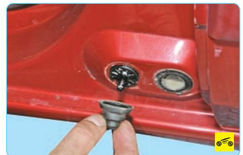
2. Снимите с выключателя защитный колпачок.
