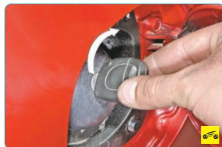
10. После заправки вставьте пробку в отверстие наливной горловины топливного бака, поверните ключ по часовой стрелке и извлеките его из замка пробки.
