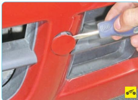
6. Для того чтобы установить буксирную проушину, подденьте отверткой заглушку...
