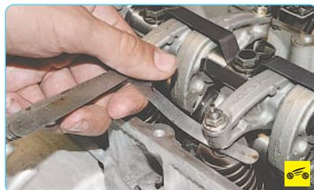
Зазор измеряют на холодном двигателе (при + 20 °С) между торцами стержня клапана и регулировочного болта при полно-
