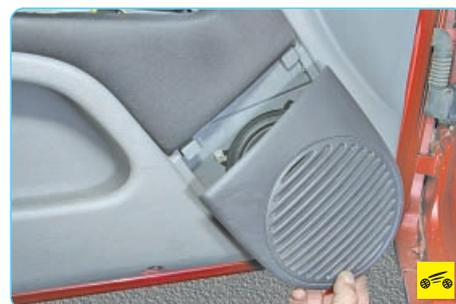
11. Подденьте отверткой накладку динамика передней двери и снимите накладку.
