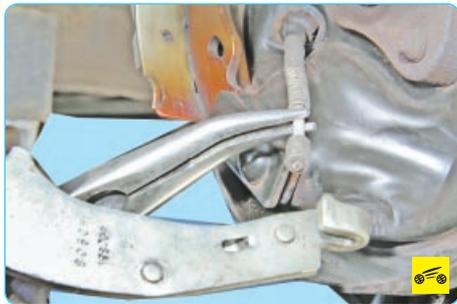
24. ...и, отсоединив трос от разжимного рычага, снимите заднюю колодку.
