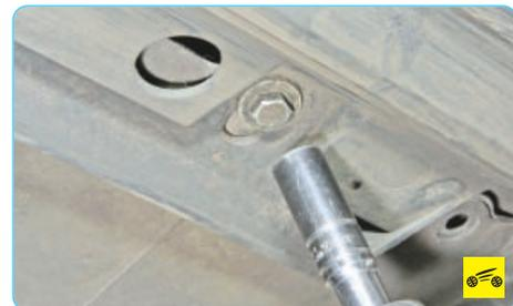
4. Выверните болт крепления переднего бампера к подрамнику...
