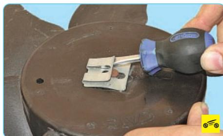
5. Поддев отверткой, сдвиньте в сторону фиксатор крыльчатки...
