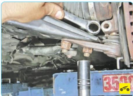
7. Удерживая головку болта крепления от проворачивания, ослабьте затяжку и снимите гайку крепления шаровой опоры к рычагу.
