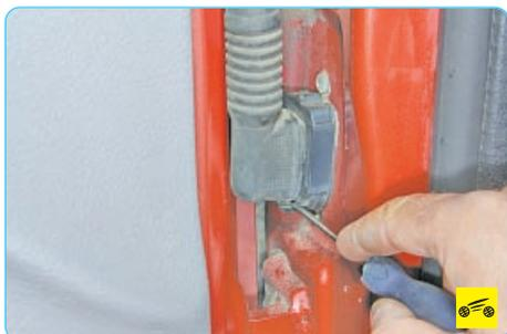
3. Подденьте отверткой фиксатор колодки жгута проводов...
