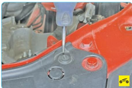
17. С обеих сторон автомобиля выверните фиксаторы двух пистонов верхнего крепления облицовки радиатора к рамке радиатора и извлеките пистоны.
