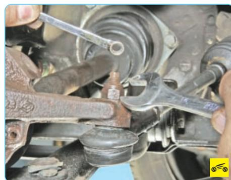
9. Отверните гайку крепления пальца шарнира рулевой тяги к рычагу поворотного кулака, удерживая палец от проворачивания.
