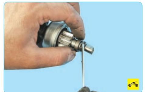
17. Поддев отверткой, снимите стопорное кольцо.
