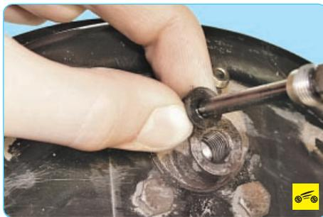
7. ...и заглушите отверстие трубки, например, колпачком клапана выпуска воздуха.
