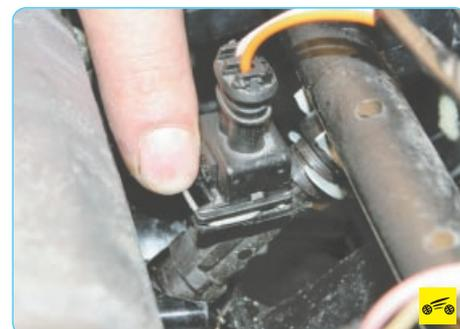
3. Сожмите фиксатор и отсоедините от форсунки колодку жгута проводов.
