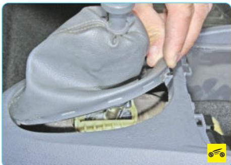
2. ...извлеките рамку из отверстия в облицовке тоннеля пола, преодолевая упругое сопротивление ее фиксаторов...
