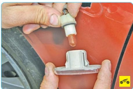
3. Снимите боковой фонарь указателя поворота (см. «Замена бокового фонаря указателя поворота», с. 226).
