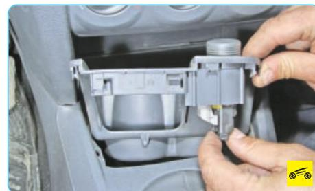
3. Сожмите фиксатор колодки жгута проводов прикуривателя...
