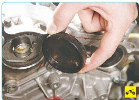
4. ...подденьте и снимите заглушки распределительных валов из задней части головки блока цилиндров.
