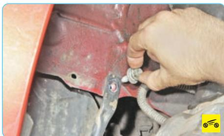
25. ...и извлеките болт из отверстия. Аналогично выверните и извлеките болт крепления соединительной тяги с другой стороны.
