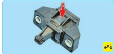
...нажмите на рычаг замка через отверстие в его корпусе (для наглядности показано на снятом замке).
