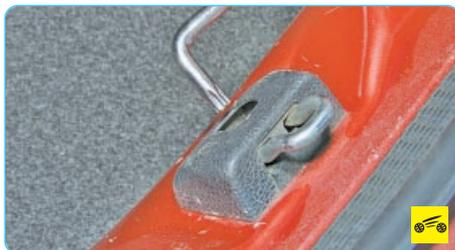
2. Выверните болт крепления защелки замка...
