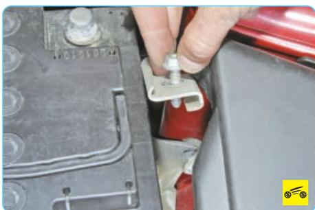
9. ...и снимите пластину.
