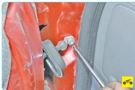
6. Выверните болт крепления петли ограничителя открывания передней двери и отведите петлю от передней стойки кузова.
