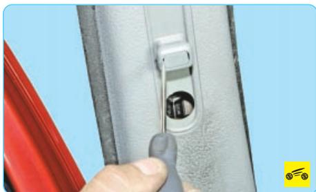
12. Подденьте отверткой фиксатор ручки механизма регулирования ремня безопасности по высоте...
