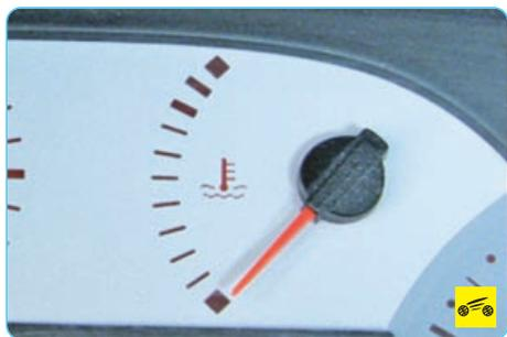
**6 – указатель температуры охлаждающей жидкости** в системе охлаждения двигателя. Красная зона предупреждает о перегреве двигателя. Если стрелка перешла в красную зону, следует остановиться, дать двигателю остыть и устранить причину перегрева.
