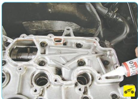
5. Нанесите на привалочные поверхности крышки головки блока цилиндров и маслоотделителя высокотемпературный прокладочный герметик.
