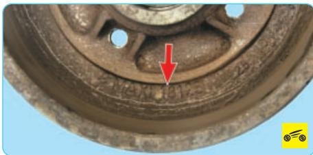
Внутренний диаметр барабана должен быть не более 181,25 мм, рабочая поверхность барабана – ровной и гладкой, без кольцевых рисок и явно видимой овальности (овальность можно определить по неравномерно изношенной рабочей поверхности барабана). Если внутренний диаметр барабана больше допустимого, кольцевые риски очень глубокие или хорошо виден неравномерный износ рабочей поверхности, барабан придется заменить новым.
