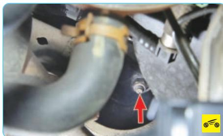
6. Под капотом отверните гайку болта клеммового соединения рулевого вала с валом рулевого механизма...
