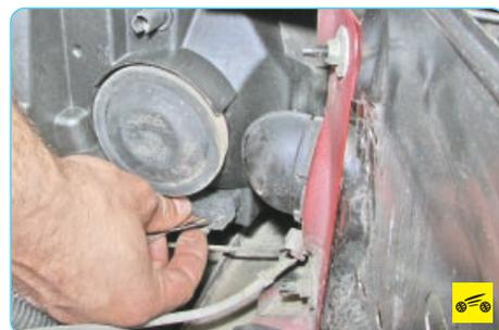
3. Сожмите фиксатор колодки жгута проводов...
