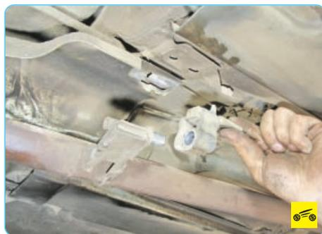
6. ...и снимите подушку подвески дополнительного глушителя.
