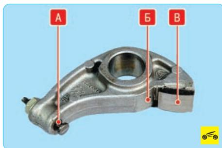
9. Осмотрите коромысла клапанов. Замените коромысло при сильном, отчетливо видимом износе поверхности **В**, контактирующей с кулачком распределительного вала. Проверьте чистоту отверстия **Б** для подвода смазки к кулачку распределительного вала. Проверьте состояние головки регулировочного болта **А** и, если на ней есть явные следы износа...
