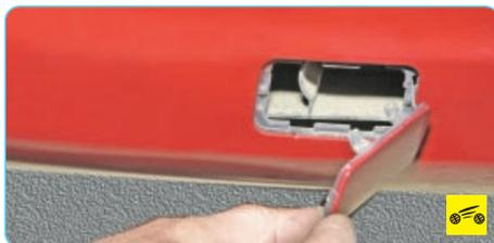
3. ...и, преодолевая усилие фиксаторов, извлеките ее из проема в заднем бампере.
