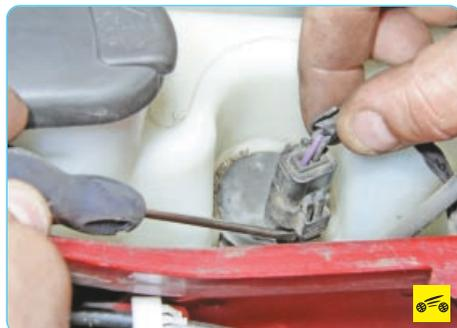
3. Отожмите фиксатор колодки жгута проводов...
