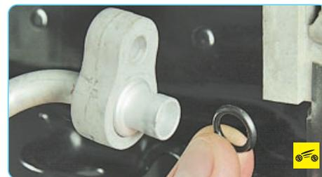
При установке новых уплотнительных колец фланцев трубопроводов обязательно смажьте их маслом для компрессора кондиционера.
