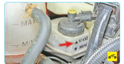
Регулярно проверяйте уровень тормозной жидкости в бачке главного тормозного цилиндра. Уровень тормозной жидкости должен быть около метки «MAX» на корпусе бачка.
