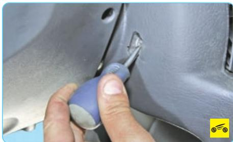
5. ...и, опуская вниз, отожмите фиксатор модуля подушки безопасности водителя.
