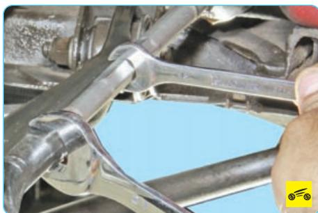
6. Отвинтите наконечник от рулевой тяги, подсчитывая количество оборотов, чтобы при установке нового наконечника по возможности не изменить схождение колес. При необходимости удерживайте от проворачивания ключом тягу за шестигранник.
