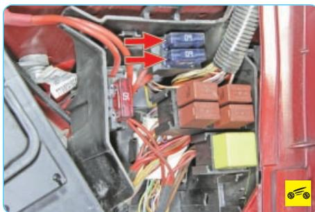
7. Если ремень натянут нормально и соединительные провода в порядке, проверьте, не перегорели ли силовые предохранители в дополнительном блоке, расположенном в моторном отсеке. Если предохранители перегорели, замените их, пустите двигатель и проверьте, погасла ли лампа разряда аккумуляторной батареи. Если лампа погасла, можно продолжать движение.
