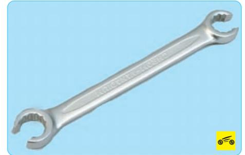
**...и специальный ключ «на 11» для тормозных трубопроводов.**
