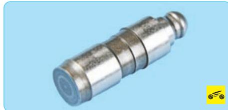
В двигателе К4J применяются гидрокомпенсаторы, которые автоматически обеспечивают беззазорный контакт кулачка распределительного вала с клапаном.
