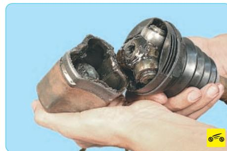
5. Снимите корпус шарнира.
