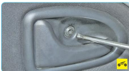
8. Выверните болт крепления внутренней ручки передней двери.
