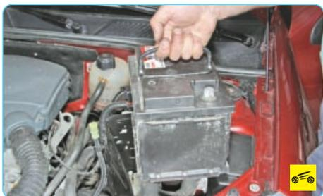
10. Извлеките аккумуляторную батарею из моторного отсека.
