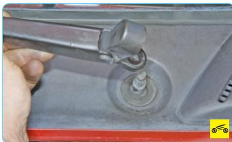
5. Снимите рычаги с валов поводков трапеции стеклоочистителя (см. «Снятие и установка рычагов стеклоочистителя ветрового окна», с. 250).
