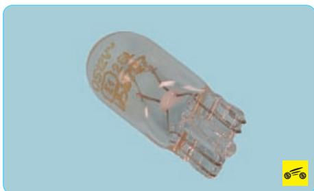
6. Установите новую лампу фонаря освещения номерного знака.
