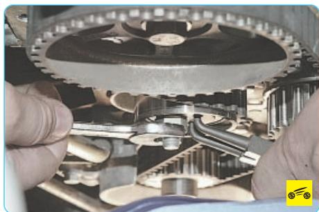
3. ...и поверните ролик по часовой стрелке, ослабив тем самым натяжение ремня привода газораспределительного механизма.
