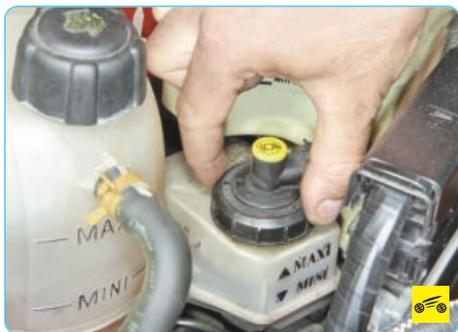
4. Заверните пробку бачка, пролитую жидкость вытрите чистой обтирочной тканью.
