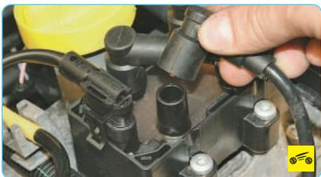
– внимательно осмотрите подкапотное пространство. Выключите зажигание и проверьте надежность крепления и посадки всех проводов и разъемов у модуля зажигания и высоковольтных проводов. Пустите двигатель и прислушайтесь к его работе: треск при пробое тока высокого напряжения на «массу» слабый, но отчетливый. В полной темноте хорошо видно искру при пробое;
