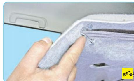
8. Сожмите фиксаторы облицовки проема ремня безопасности...
