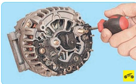
13. ...выверните два винта крепления и снимите выпрямительный блок.
