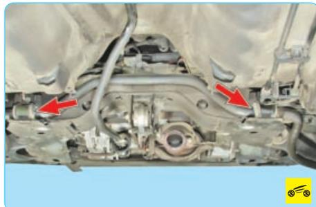
5. Качая рукой штангу стабилизатора поперечной устойчивости, проверьте состояние подушек ее крепления к поперечине. При наличии стуков замените подушки.
