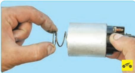
5. Извлеките из тягового реле пружину.
