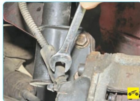
8. Выверните нижний наконечник шланга из рабочего цилиндра тормозного механизма переднего колеса...
