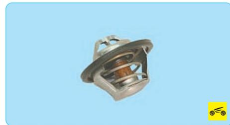
**Термостат** с твердым термочувствительным наполнителем поддерживает нормальную рабочую температуру охлаждающей жидкости и сокращает время прогрева двигателя. Он установлен на заднем торце головки блока цилиндров. При температуре охлаждающей жидкости до  $88^{\circ}\text{C}$  термостат полностью закрыт и жидкость циркули-
