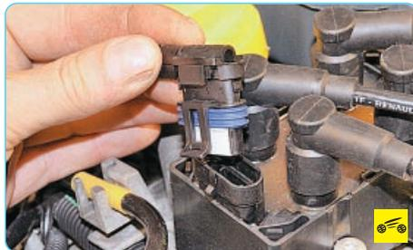
2. Остановите двигатель, отсоедините колодку жгута низковольтных проводов от модуля зажигания.
