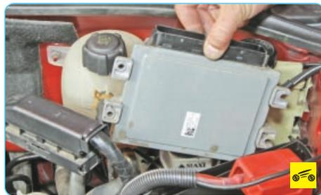
4. Снимите электронный блок управления двигателем (см. «Снятие и установка электронного блока управления двигателем», с. 215).
