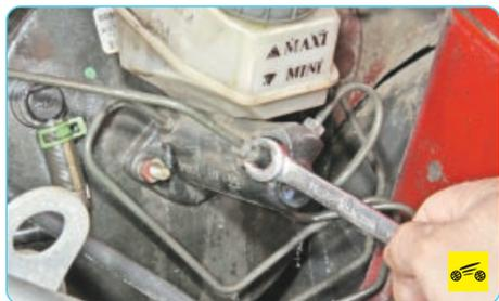
5. Отверните гайки крепления четырех трубопроводов к главному тормозному цилиндру...
