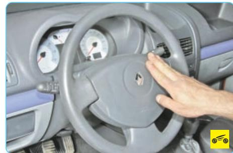
При нажатии на центральную накладку ступицы рулевого колеса включается звуковой сигнал. В ступице рулевого колеса смонтирована подушка безопасности водителя.
