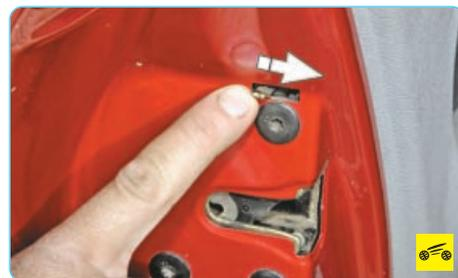
Для отключения «детской» блокировки сдвиньте рычаг в сторону внутренней панели двери.
