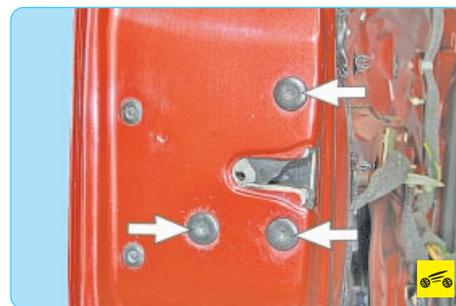
4. Выверните болты крепления замка к панели передней двери.
