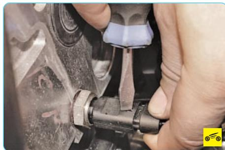
3. Отожмите отверткой фиксатор...
