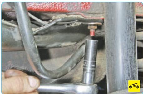
10. Отверните гайку крепления наливной трубы в колесной арке. Этой же гайкой прикреплен заземляющий провод топливного бака.
