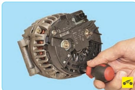
2. Выверните винт крепления задней крышки.
