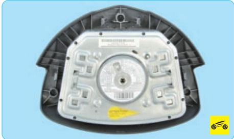
– модуль подушки безопасности водителя, расположенный в ступице рулевого колеса и состоящий из сложной оболочки подушки и газогенератора;
