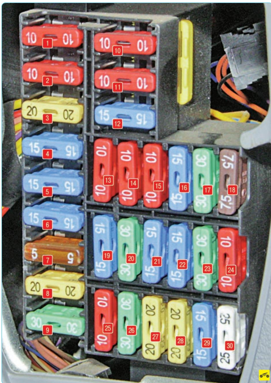
Рис. 10.2. Монтажный блок, расположенный в салоне автомобиля
