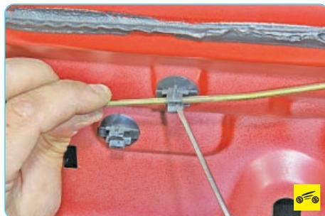
5. Отверткой разожмите держатель тяги рычага привода блокировки замка задней двери...
