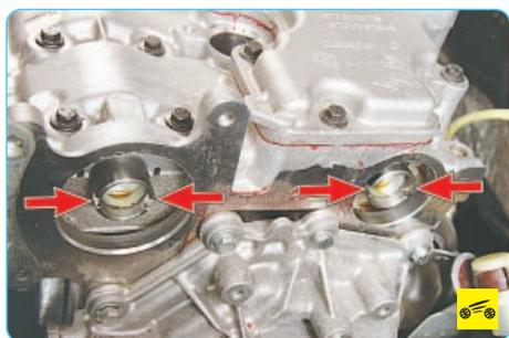
5. При правильной установке поршня 1-го цилиндра в положение ВМТ такта сжатия газы на концах распределительных валов должны занимать горизонтальное положение и быть смещены вниз относительно оси распределительных валов.
