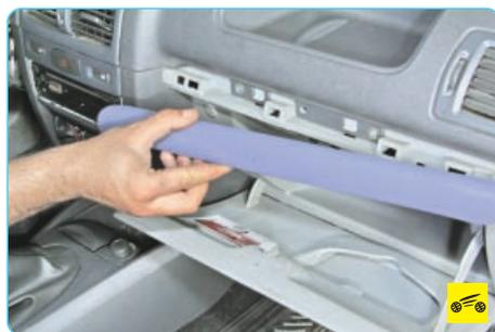
5. Преодолевая сопротивление пластмассовых фиксаторов, снимите правую декоративную накладку...
