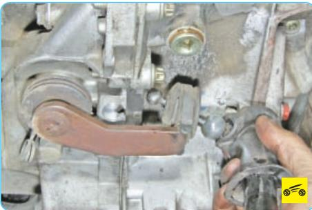
12. Извлеките шаровую головку пальца наконечника из опоры в рычаге переключения передач...
