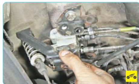
3. Отведите регулятор от кронштейна на кузове, сдвиньте его назад и вверх, чтобы отсоединить нагрузочный стержень от фиксатора на балке задней подвески...
