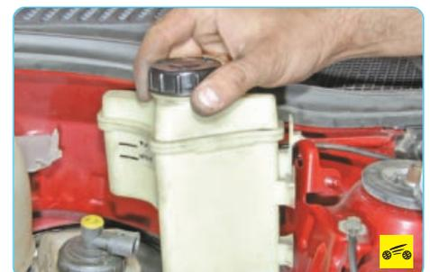
4. Для удобства работы снимите с держателей на брызговики двигателя бачок гидроусилителя рулевого управления и отведите его в сторону, не отсоединяя шланги.
