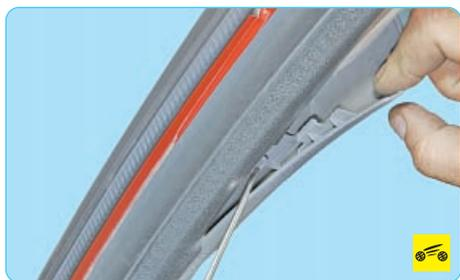
2. Через образовавшийся зазор поочередно отожмите отверткой три фиксатора облицовки...
