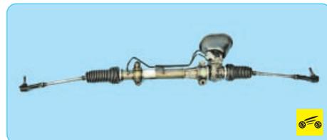
15. Установите детали в порядке, обратном снятию. При установке рулевого механизма и подсоединении к его валу-шестерне промежуточного вала рулевой колонки обратите внимание на то, чтобы рейка находилась в среднем (нейтральном) положении.
