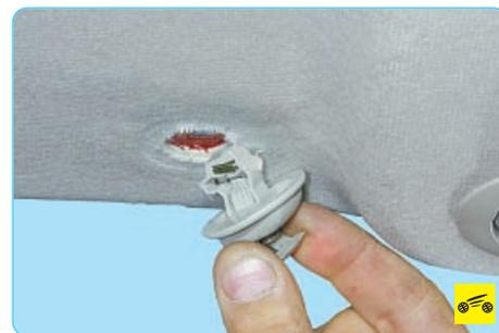
6. ...извлеките его из гнезда в усилителе крыши и снимите.
