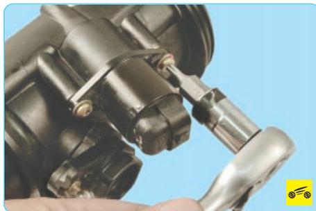
3. Выверните два винта крепления РХХ к дроссельному узлу (для наглядности показано на снятом дроссельном узле).
