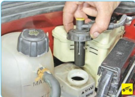
2. Отверните пробку бачка и откачайте из него тормозную жидкость, например, резиновой грушей или медицинским шприцем.
