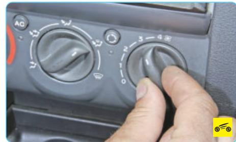
Для увеличения интенсивности подачи воздуха в салон во время движения и обеспечения подачи воздуха в неподвижный автомобиль включите рукояткой переключателя 5 один из четырех режимов работы вентилятора воздухонагнетателя.
