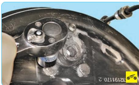
8. Выверните два болта крепления рабочего цилиндра, придерживая цилиндр с другой стороны...
