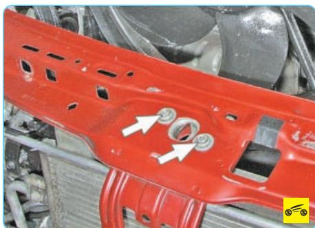
3. Выверните два болта крепления замка капота к верхней поперечине рамки радиатора...
