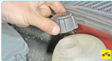
2. Для доливки жидкости отверните пробку расширительного бачка, вращая ее против часовой стрелки...
