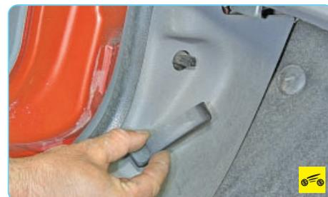
3. ...снимите рукоятку с оси привода, преодолевая упругое сопротивление ее фиксатора.
