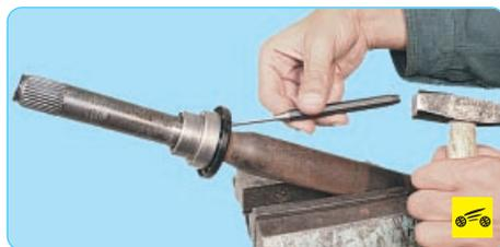
6. При необходимости замены сальника (в случае утечки масла из коробки передач) сбейте с вала узел подшипника чехла вместе с сальником и грязеотражателем.
