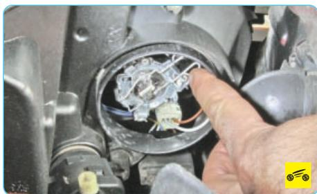
5. Разожмите пружинный фиксатор лампы...
