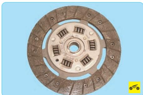
Ведомый диск 1 установлен на шлицах первичного вала коробки передач и зажат
