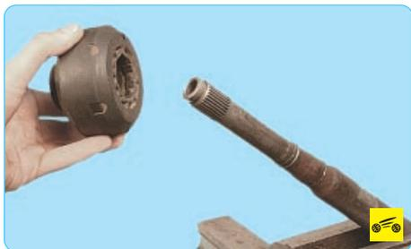
2. При замене чехла наружного шарнира привода правого переднего колеса дополнительно снимите с вала привода динамический демпфер, преодолевая упругое сопротивление резинового массива демпфера.
