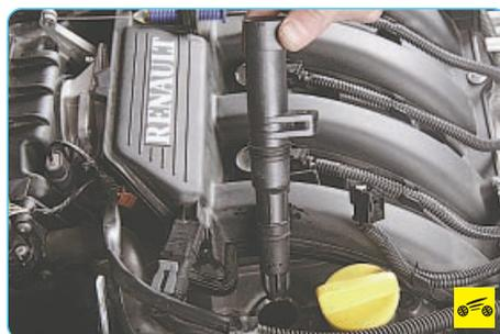
3. ...и снимите катушку со свечи зажигания.
