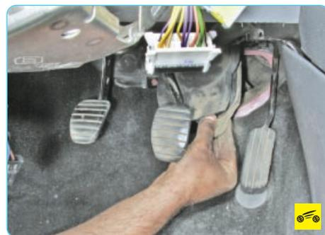
10. Извлеките резиновый уплотнитель рулевой колонки из отверстия в щите передка.
