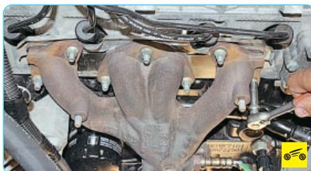
Отработавшие газы отводятся из двигателя через выпускной коллектор.
