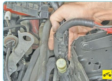
4. Снимите с края щитка держатель жгута проводов и отведите жгут в сторону.
