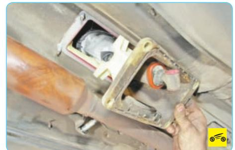
9. ...и снимите кулису, вынимая ее из отверстия в основании кузова вниз под автомобиль.
