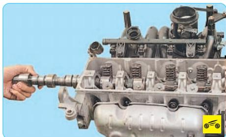
11. Аккуратно, стараясь не повредить острыми кромками кулачков рабочие поверхности подшипников, извлеките распределительный вал из постелей головки блока.
