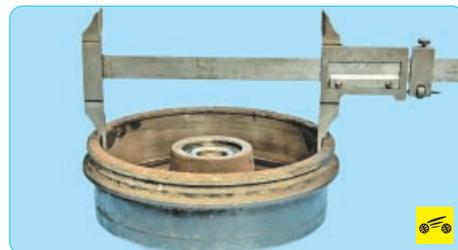
6. Установив автомобиль на домкрат, поочередно снимите задние колеса, снимите тормозные барабаны (см. «Снятие и установка тормозного барабана», с. 193) и измерьте диаметры их рабочих поверхностей.
