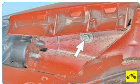
5. ...и по одному болту его бокового крепления с обеих сторон автомобиля.
