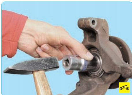
2. Зажмите поворотный кулак в тиски и выбейте ступицу молотком, используя оправку подходящего диаметра (например, торцовую головку).
