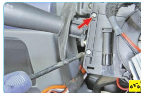
9. Выверните два винта крепления подрулевого переключателя наружного освещения и указателей поворота к контактному кольцу подушки безопасности...
