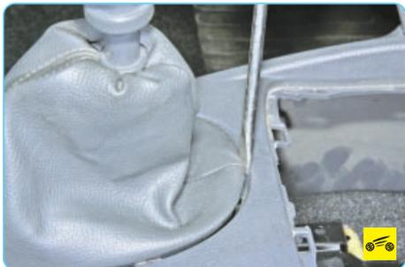
1. В салоне автомобиля подденьте тонкой отверткой край рамки чехла рычага управления коробкой передач...
