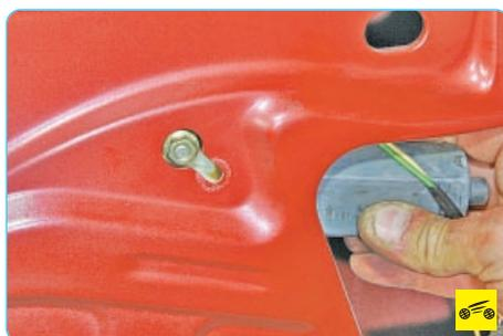
6. Сдвиньте верхнюю шпильку крепления моторедуктора вверх и выведите гайку шпильки из проема панели двери.
