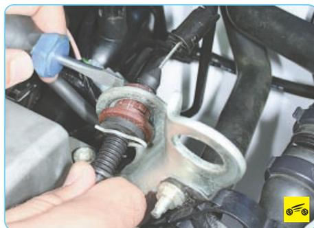
4. Сожмите фиксаторы наконечника оболочки и извлеките наконечник из отверстия в кронштейне.
