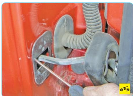
4. Подденьте отверткой заглушку ниши гаек шпилек крепления ограничителя открывания задней двери...
