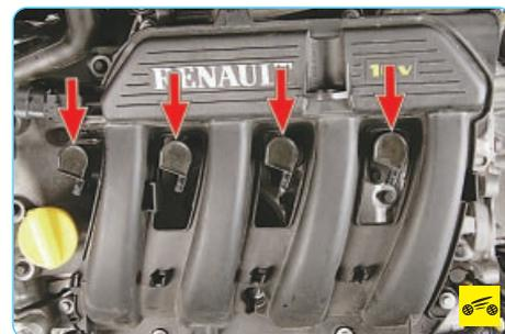
На двигателе K4J установлены четыре отдельные катушки зажигания (по одной для каждого цилиндра), которыми непосредственно управляет ЭБУ. Высоковольтные провода при этом отсутствуют, а катушки зажигания крепятся непосредственно на свечах зажигания. Порядок их снятия показан в подразделе «Снятие и установка катушек зажигания», с. 211.
