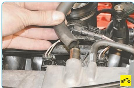
5. Отсоедините от штуцеров крышки головки блока цилиндров шланги большой...
