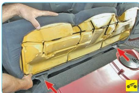
2. Поднимите подушку вверх до выхода двух ее направляющих из кронштейнов на кузове и извлеките подушку из салона автомобиля.
