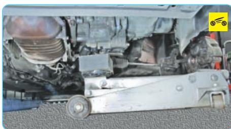
4. Установите через деревянную или резиновую проставку опору под картер коробки передач.
