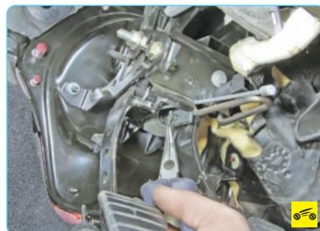
15. Захватив пассатижами край пружинного фиксатора пальца вилки толкателя вакуумного усилителя тормозов...
