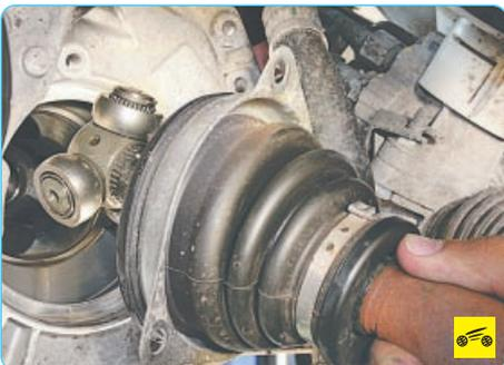
12. ...извлеките внутренний шарнир из пазов полуосевой шестерни и снимите привод.
