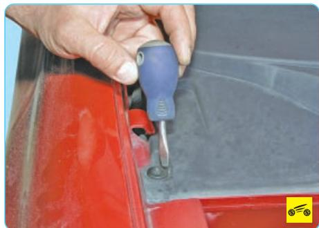
2. Выверните фиксатор пистона крепления правой части облицовки короба воздухопритока и извлеките пистон.
