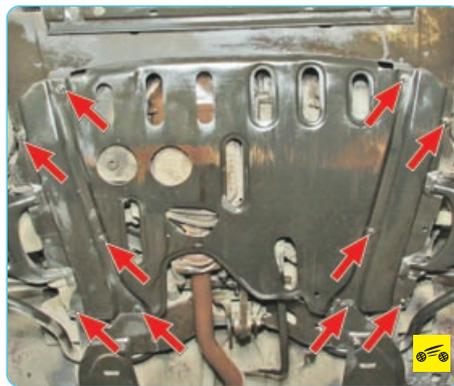
Так расположены болты крепления защиты картера двигателя.
