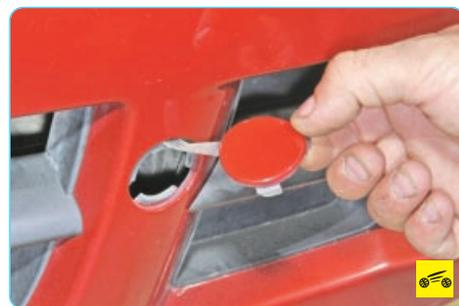
7. ...и, преодолевая усилие фиксаторов, извлеките ее из отверстия в переднем бампере.
