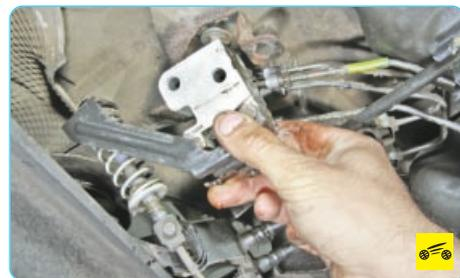
4. ...и снимите регулятор, выведя отогнутый конец нагрузочного стержня из отверстий в фиксаторе и кронштейне балки задней подвески.
