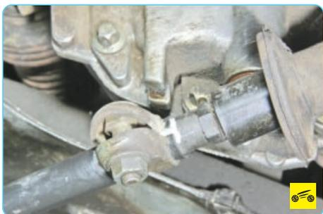
9. Пометьте, например фломастером, положение хомута крепления тяги привода управления коробкой передач и рычага коробки передач.
