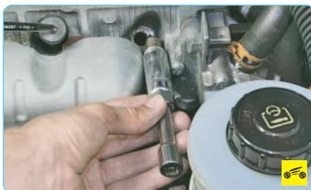
4. Выверните свечи свечным ключом (см. «Замена и обслуживание свечей зажигания», с. 212).
