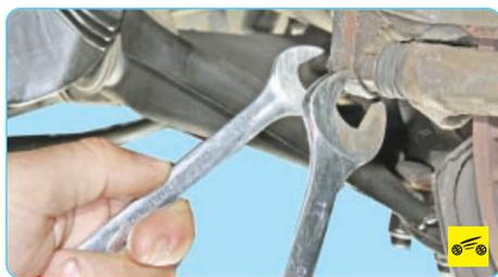
2. Ослабьте затяжку болта крепления нижнего направляющего пальца суппорта, удерживая палец от проворачивания вторым ключом...
