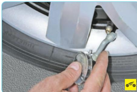
5. Если давление больше требуемого, надавите специальным выступом манометра на наконечник золотника и выпустите воздух из шины. Измерьте манометром давление. Повторяя эти операции, доведите давление до нормы.
