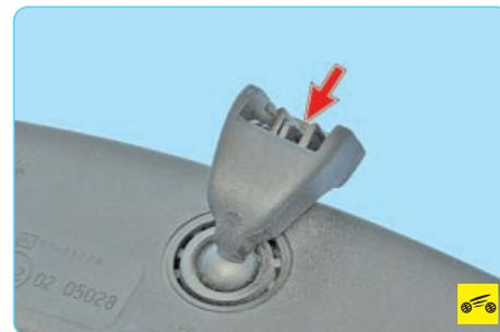
Так выглядит пружинный фиксатор снятого с автомобиля зеркала.
