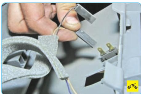
2. Отсоедините колодку жгута проводов от выключателя.
