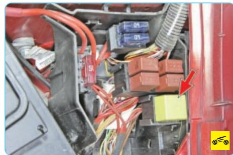
1. Стартер не включается. Причина – перегорание реле в монтажном блоке моторного отсека.
