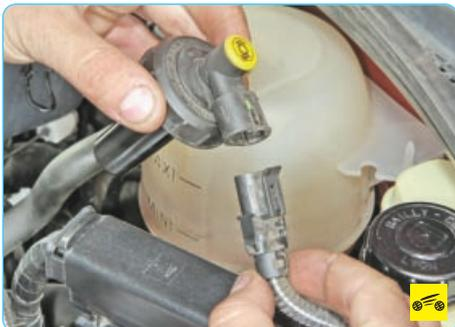
3. Отсоедините колодку жгута проводов от датчика уровня тормозной жидкости, нажав на ее фиксатор, и установите пробку на место, чтобы в бачок не попала грязь.
