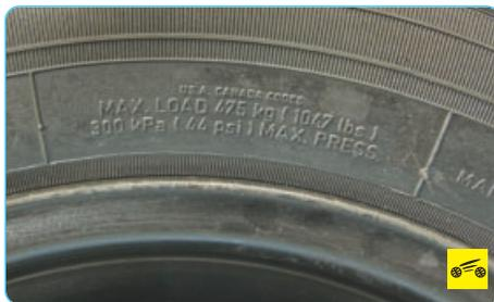
На шину также нанесена дублирующая маркировка с расшифровкой грузоподъем-
