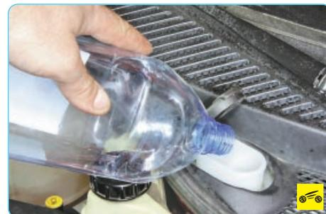
2. ...и долейте жидкость в бачок омывателя до нижней кромки горловины.
