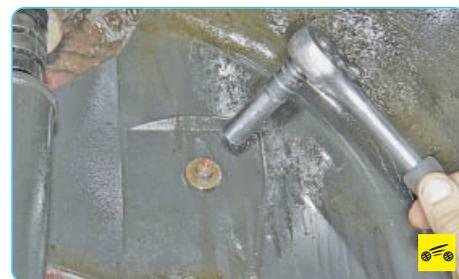
2. Отверните гайку бокового крепления подкрылка.
