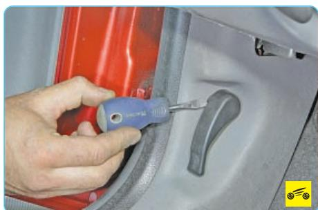
4. Подденьте отверткой ручку привода замка капота...
