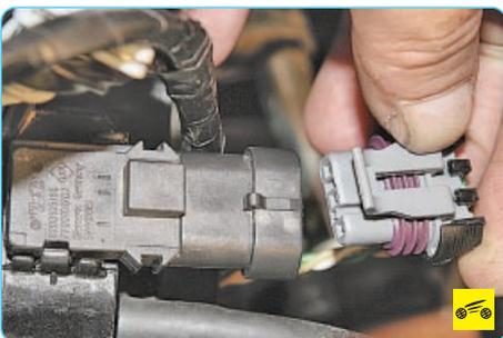
3. ...и отсоедините колодку жгута проводов от датчика.
