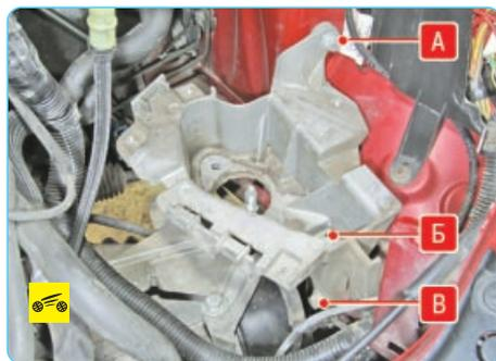
19. При необходимости снимите с кузова кронштейн левой опоры подвески силового агрегата, для чего выверните болты **А** верхнего, **Б** переднего, **В** нижнего...
