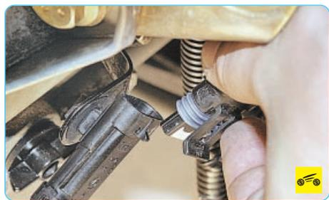
13. ...датчика концентрации кислорода в отработавших газах...
