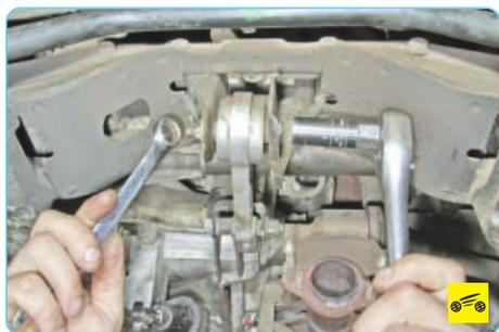
2. Удерживая от проворачивания головку болта крепления задней опоры подвески силового агрегата к кронштейну подрамника передней подвески, отверните гайку крепления...
