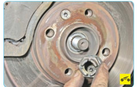
6. Окончательно отверните гайку ступицы.
