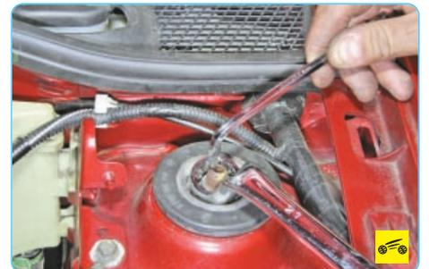
8. Ослабьте затяжку гайки крепления амортизаторной стойки (см. «Снятие и установка амортизаторной стойки», с. 154) и отверните гайку до конца резьбы, но не снимайте ее.
