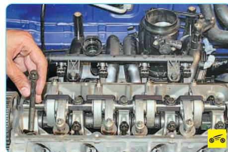
38. ...окончательно выверните болты крепления головки, выньте их...
