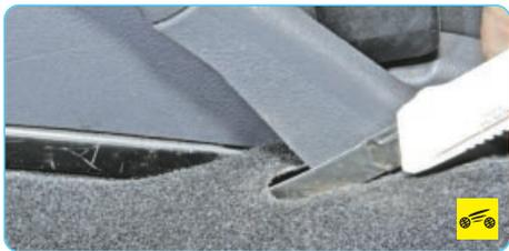
4. В салоне автомобиля аккуратно разрежьте коврик пола в передней части рычага привода стояночного тормоза...
