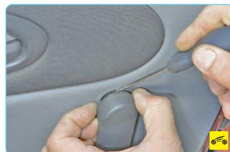
2. Отожмите фиксатор ручки стеклоподъемника...
