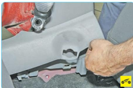
10. Захватите передний край задней облицовки порога и снимите облицовку, преодолевая упругое сопротивление ее фиксаторов.
