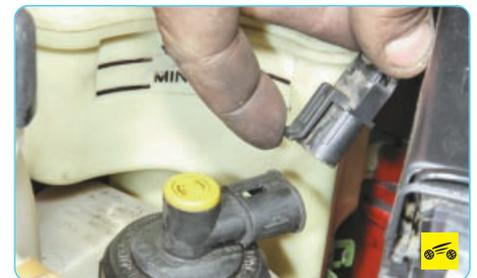
3. Нажмите на фиксатор колодки жгута проводов датчика уровня тормозной жидкости и отсоедините колодку от датчика.
