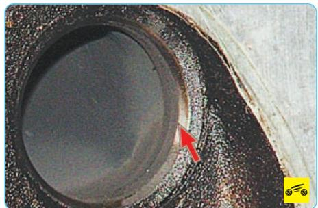
24. Проверьте состояние седел клапанов. На рабочих фасках седел не должно быть следов износа, раковин, коррозии и других дефектов. Седла клапанов можно заменить в специализированной мастерской. Незначительные повреждения (мелкие риски, царапины и пр.) можно вывести притиркой клапанов (см. «Притирка клапанов», с. 99).
