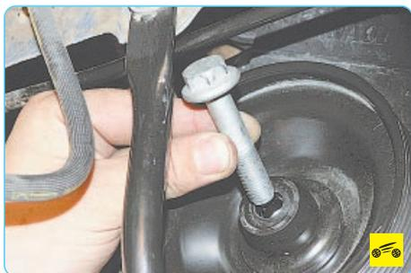
4. Выверните болт крепления шкива привода вспомогательных агрегатов...
