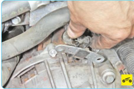
16. Снимите датчик верхней мертвой точки (см. «Замена датчиков системы управления двигателем», с. 215).
