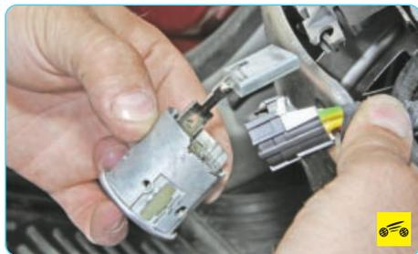
9. Извлеките контактную группу из корпуса замка зажигания и снимите замок зажигания.
