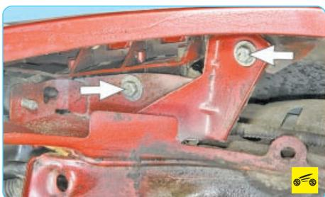
5. В арке переднего колеса выверните болты переднего крепления крыла и переднего бампера к кузову.
