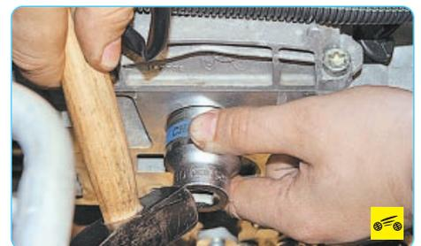
8. Установите сальник рабочей кромкой внутрь гнезда головки блока, аккуратно
