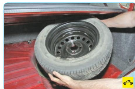
5. Выньте запасное колесо из багажника и положите его рядом с заменяемым колесом.
