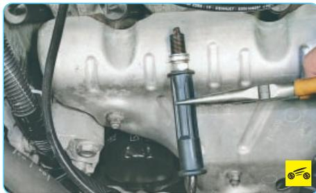
3. Если низковольтная цепь модуля зажигания исправна, проверьте наличие искры на свечах зажигания. Снимите высоковольтный провод с любой свечи зажигания. Вставьте в наконечник провода запасную свечу зажигания и прижмите ее металлической частью к «массе» автомобиля (например, к термозрану выпускного коллектора). Попросите помощника провернуть стартером коленчатый вал двигателя.
