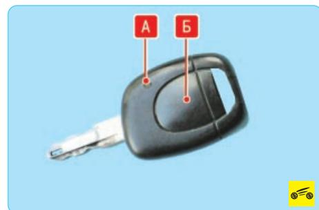
Основной ключ с пультом дистанционного управления замками снабжен кнопкой **B**, последовательным нажатием на которую
