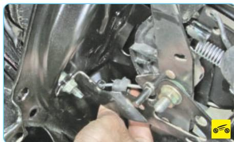
6. Снимите резиновый уплотнитель с наконечника оболочки троса, вставленного в монтажную плиту педального узла.
