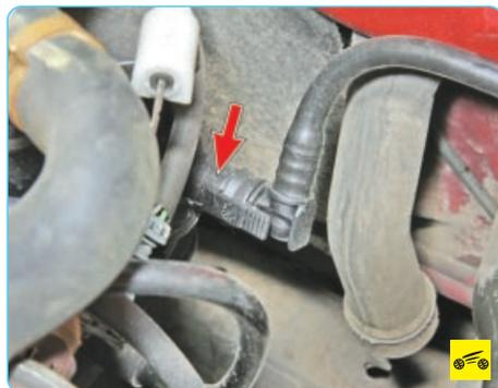
2. Если педаль осталась неподвижной, проверьте целостность и надежность соединения шланга вакуумного усилителя со штуцером на впускной трубе двигателя...
