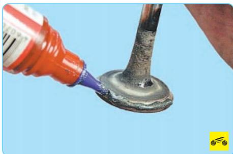
2. Нанесите на фаску клапана сплошной тонкий слой притирочной пасты.
