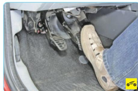
14. Перед поездкой обязательно проверьте на неподвижном автомобиле работу тормозной системы, нажав на педаль тормоза. Если педаль без сопротивления «провалилась» до пола, значит, тормозная система неисправна. Эксплуатация такого автомобиля запрещена.
