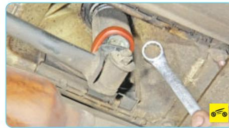
5. Отверните гайку пальца тяги управления коробкой передач...
