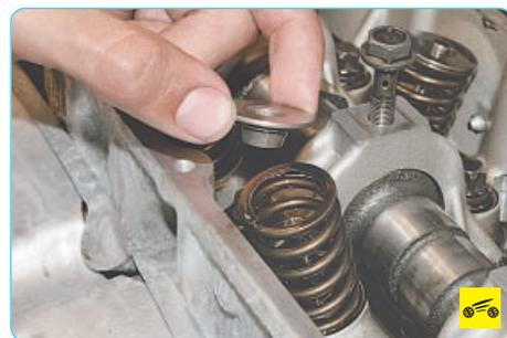
10. Снимите тарелку пружины...
