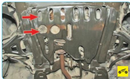
2. Загляните под переднюю часть автомобиля – не пробит ли масляный картер двигателя, нет ли там течи.
