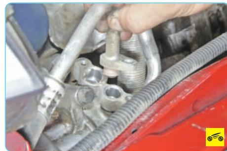
6. ...и отсоедините фланец трубопровода от компрессора.
