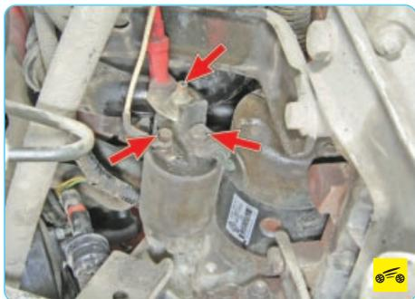
Указанные неисправности требуют квалифицированного вмешательства в автосервисе или по приезде в гараж (см. разд. 10 «Электрооборудование», с. 200). Предварительно можно проверить лишь степень разряженности аккумуляторной батареи с помощью вольтметра (например, в составе автотестера) и затяжку контактных соединений в цепи стартера.
