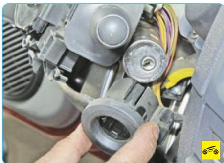
4. Снимите антенный блок иммобилизатора с замка зажигания.
