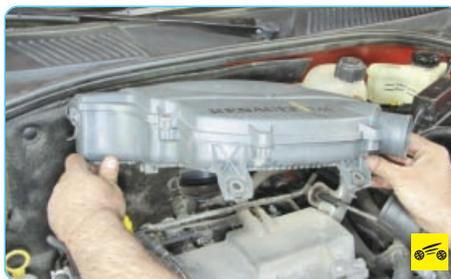
1. Снимите воздушный фильтр (см. «Снятие и установка воздушного фильтра», с. 116).
