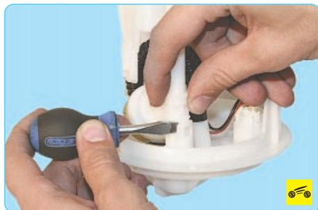
7. Отожмите фиксатор и извлеките штуцер регулятора давления топлива из посадочного гнезда в крышке модуля.
