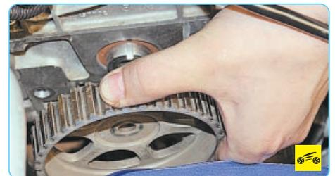
5. ...и снимите шкив с хвостовика распределительного вала.
