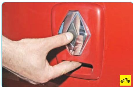
2. Нажмите на клавишу привода замка крышки багажника...
