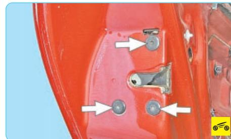
7. Выверните болты крепления замка к панели задней двери и извлеките болты из отверстий.
