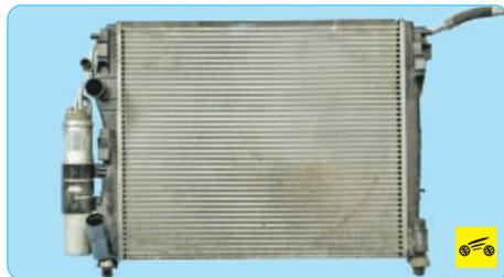
**Радиатор** с горизонтальным потоком жидкости, с трубчато-ленточной алюминиевой сердцевинкой и пластмассовыми бачками. В левом бачке выполнены подводный и отводящий патрубки шлангов к водяной рубашке двигателя. Радиатор системы охлаждения представляет собой неразборный узел с конденсором системы кондиционирования.
