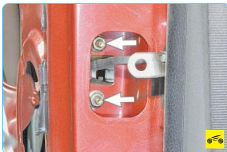
8. Отверните две гайки шпилек крепления ограничителя открывания задней двери к панели двери.
