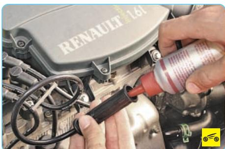
8. Перед установкой смажьте наконечники высоковольтных проводов консистентной смазкой. Завод-изготовитель рекомендует смазку FLUORINE GREASE (№8200168855 по каталогу Renault), но можно использовать и технический вазелин.
