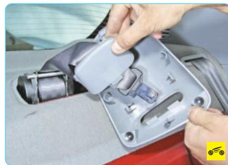
6. ...и, отсоединив направляющую, снимите облицовку катушки ремня безопасности центрального заднего пассажира.
