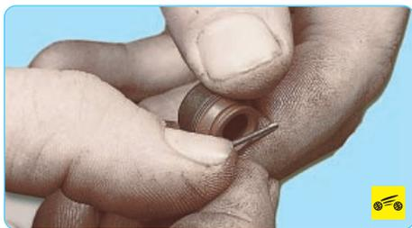
14. Перед установкой новых маслосъемных колпачков рекомендуем снять с них пружины, иначе колпачки можно повредить, когда они будут проходить через проточки под сухари на клапанах. Если в комплект новых колпачков входит пластмассовая установочная втулка, пружины можно не снимать. В этом случае наденьте втулку на стержень клапана.
