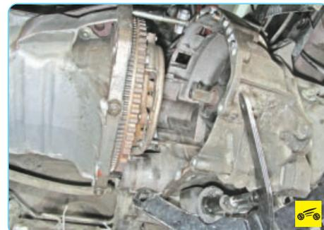
37. Сдвиньте коробку передач назад до момента выхода первичного вала коробки из ступицы ведомого диска сцепления и аккуратно снимите коробку передач с автомобиля.
