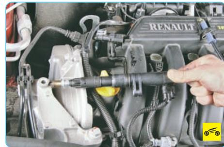
Проверьте наличие искры на свечах зажигания. Если искры нет, проверьте катушки зажигания, установив в катушку проверенную свечу с «рабочей» машины. В случае неисправности замените катушку зажигания (см. «Снятие и установка катушек зажигания», с. 211).
