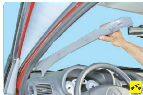
10. Преодолевая сопротивление пластмассовых фиксаторов, снимите правую и левую облицовки передних стоек.
