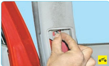
14. Сожмите фиксаторы облицовки центральной стойки кузова...
