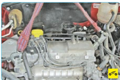
28. Вывесите силовой агрегат грузоподъемным механизмом, зацепив его стropy за монтажные петли на двигателе, или установите под масляный картер двигателя надежную опору.
