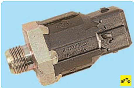
**Датчик детонации**, прикрепленный к блоку цилиндров между 2-м и 3-м цилиндрами, улавливает аномальные вибрации (детонационные удары) в двигателе.
