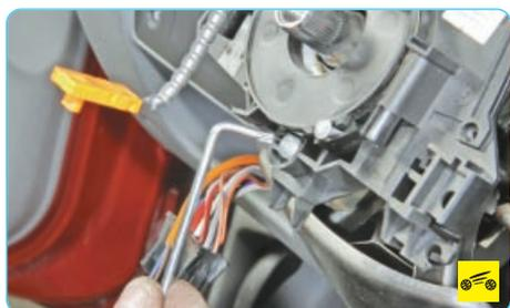
14. Ослабьте затяжку болта клинового зажима крепления контактного кольца подушки безопасности к рулевой колонке...
