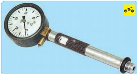
Так выглядит компрессометр, использованный для иллюстрирования данной книги. Существуют варианты компрессометров, у которых взамен резьбового штуцера для вворачивания вместо свечи зажигания установлен резиновый наконечник. Такие компрессометры при проверке компрессии просто сильно прижимают к свечному отверстию.
