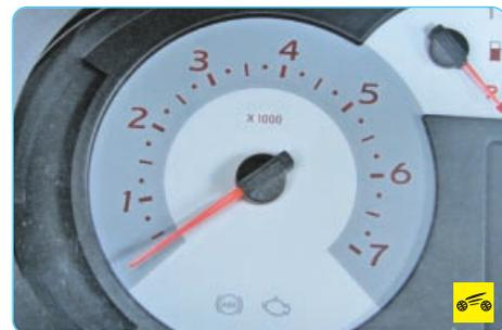
4 – **тахометр** электронного типа показывает частоту вращения коленчатого вала двигателя. Шкала имеет деления от 0 до 7, цена деления 0,25. чтобы узнать частоту вращения коленчатого вала в мин<sup>-1</sup>, нужно показания тахометра умножить на 1000.
