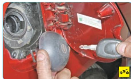
7. Поверните ключ по часовой стрелке и извлеките его из замка пробки.
