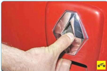
Чтобы открыть крышку багажника, разблокируйте замок вышеописанным способом, отоприте его, нажав на кнопку привода замка, расположенную внутри заводской эмблемы...
