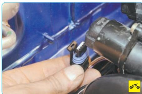
2. Отсоедините (при выключенном зажигании) колодку жгута проводов от РХХ.
