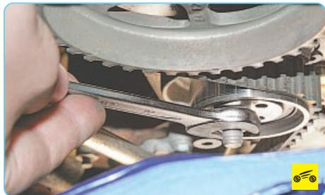
2. Запомните или пометьте любым способом положение натяжного ролика относительно оси, ослабьте затяжку гайки крепления ролика...
