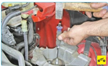
17. Немного опустите силовой агрегат и ударами мототка через выколотку спрес-
