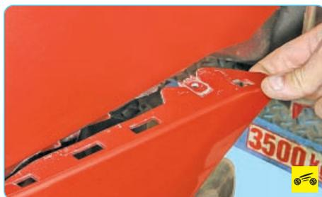
6. Отсоедините угол переднего бампера от крыла (см. «Снятие и установка переднего бампера», с. 243).
