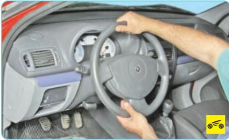
– отрегулируйте положение рулевого колеса так, чтобы были видны все приборы в комбинации приборов, а руки на рулевом колесе находились в наиболее удобном положении;
