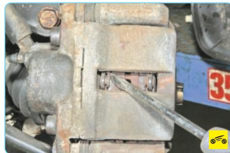
5. Проверьте подвижность поршня тормозного механизма. Для этого отверткой попробуйте сдвинуть с места внутреннюю тормозную колодку. Если колодку не удастся сдвинуть, значит, заклинило поршень в тормозном цилиндре.
