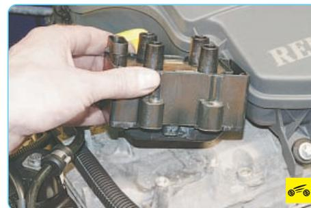
3. Снимите модуль зажигания (см. «Снятие и установка катушек зажигания», с. 211).
