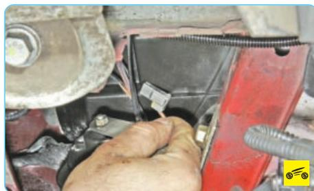
5. Снимите колодку жгута проводов с контакта звукового сигнала.
