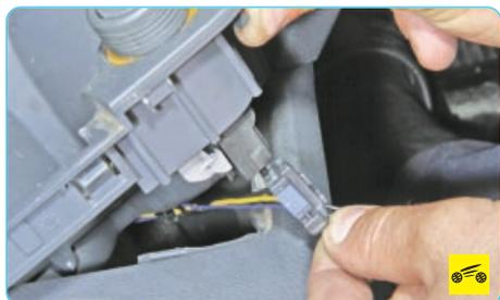
3. ...отсоедините колодку жгута проводов от прикуривателя и лампы подсветки блока...
