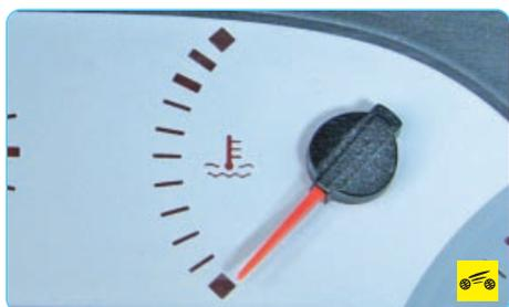
В комбинации приборов вашего автомобиля находится указатель температуры охлаждающей жидкости.
