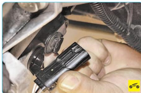
2. Снимите с кронштейна колодку, сдвинув ее вперед.
