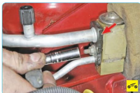
2. Отверните гайку шпильки крепления прижимной пластины трубопроводов системы отопления, кондиционирования и вентиляции салона...
