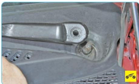
4. ...и, покачивая рычаг стеклоочистителя из стороны в сторону, снимите его с оси поводка трапеции.
