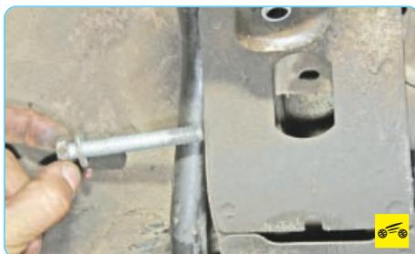
15. ...затем извлеките болт из отверстия.
