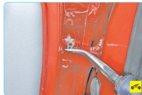
9. ...извлеките фиксатор из паза оси петель верхнего крепления задней двери и легкими ударами выбейте ось вниз. Аналогично выбейте ось нижнего крепления и снимите заднюю дверь.
