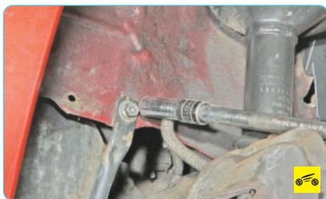
24. Выверните болт верхнего крепления соединительной тяги к кузову...
