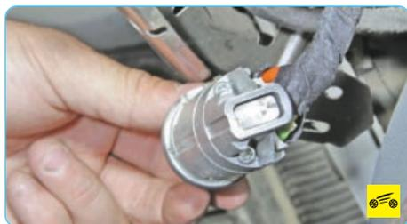
7. Выверните два винта крепления задней крышки замка зажигания...
