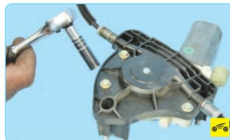
4. Выверните три винта крепления моторедуктора к кронштейну механизма стеклоподъемника...
