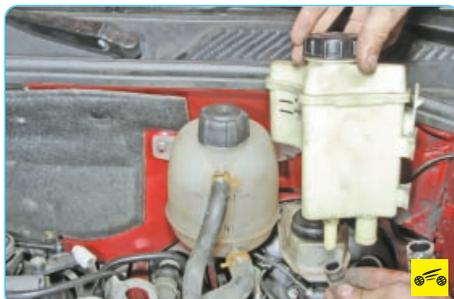
7. ...снимите шланги со штуцеров бачка гидроусилителя и снимите бачок.
