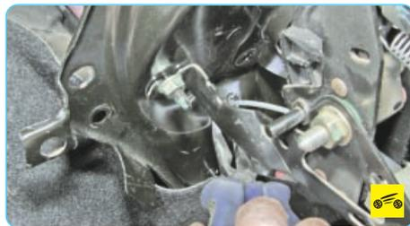
7. Сожмите пассатижами усики наконечника оболочки троса и протолкните наконечник в отверстие монтажной плиты.
