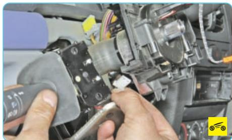
11. ...и, отсоединив колодку, снимите рычаг подрулевого переключателя.
