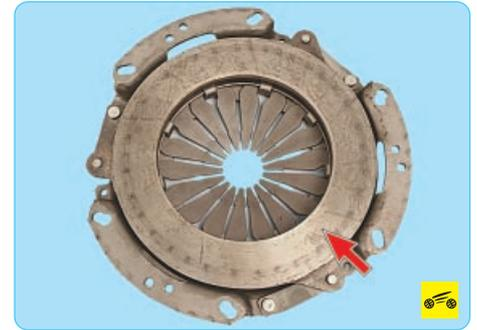
7. Осмотрите рабочие поверхности трения маховика и нажимного диска, обратив внимание на отсутствие глубоких рисок, задиров, забоин, явных следов износа и перегрева. Замените дефектные узлы.
