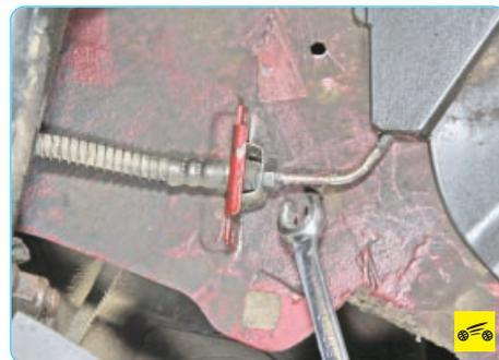
7. Для замены шланга тормозного механизма переднего колеса отсоедините от верхнего наконечника шланга тормозную трубку, как это делали при замене шланга тормозного механизма заднего колеса (см. выше п. 1).
