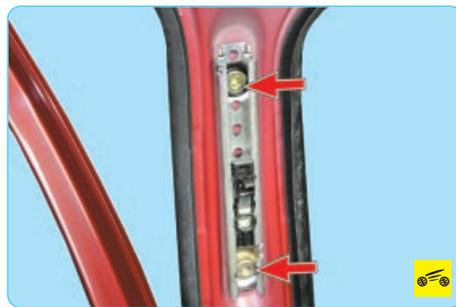
Так расположены болты крепления механизма регулирования ремня безопасности по высоте.
