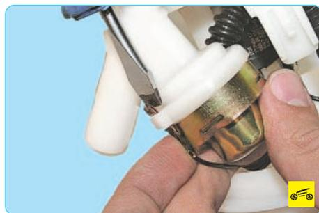
8. Отожмите фиксатор и отсоедините «массовый» провод.
