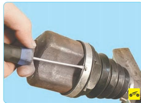
2. Снимите большой хомут крепления чехла, отогнув его усик отверткой...
