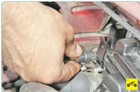
3. Отожмите фиксатор колодки жгута проводов датчика давления...
