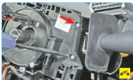
12. Выверните два винта крепления подрулевого переключателя очистителя и омывателя ветрового стекла...
