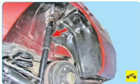
2. Проверьте состояние амортизаторов – потеки жидкости и запотевания не допускаются.
