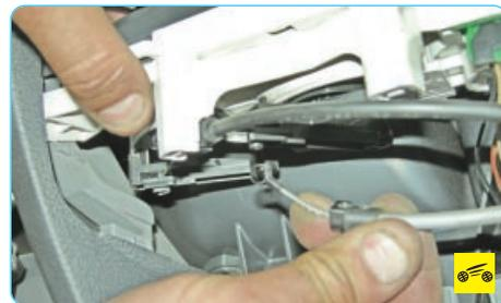
11. Отсоедините наконечник троса управления распределением воздушных потоков от рычага блока управления.
