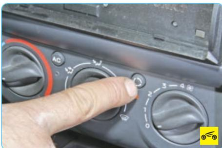
Для включения режима рециркуляции нажмите на кнопку выключателя 4 (см. рис. 1.10) режима рециркуляции – в кнопке загорится контрольная лампа. При повторном нажатии на кнопку возобновится подача наружного воздуха и контрольная лампа в кнопке погаснет. При включенном режиме рециркуляции наружный воздух не поступает в салон, а вентилятор воздухоподогревателя обеспечивает циркуляцию воздуха внутри салона. Этот режим используют для быстрого прогрева салона в холодное время
