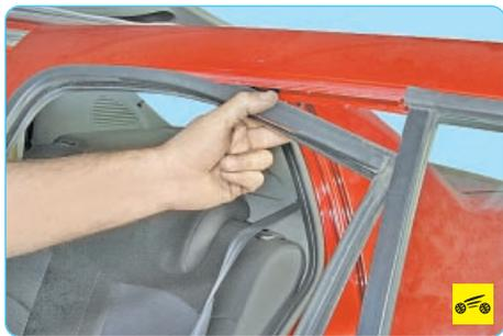
8. Снимите уплотнитель с отштамповки верхней части проема стекла задней двери...
