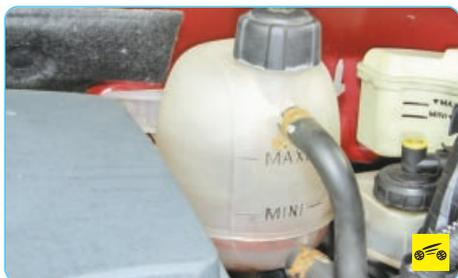
5. Проверьте уровень охлаждающей жидкости в расширительном бачке. При необходимости доведите его до нормы.
