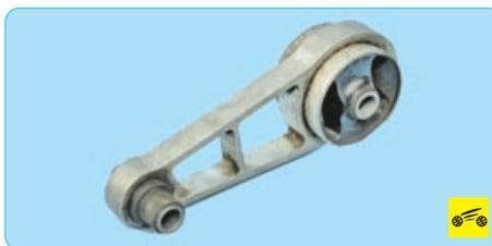
6. Установите заднюю опору подвески силового агрегата в порядке, обратном снятию.
