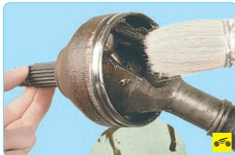
6. Удалите из шарнира старую смазку, промыв его полость бензином или керосином, и просушите шарнир сжатым воздухом.
