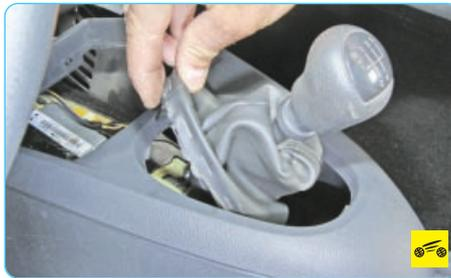
3. ...и, развернув рамку боком, протолкните ее вместе с чехлом в отверстие облицовки тоннеля пола.
