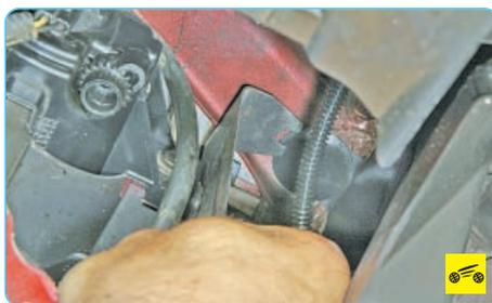
6. С левой стороны автомобиля извлеките пистон крепления брызговика двигателя к нижней поперечине рамки радиатора.
