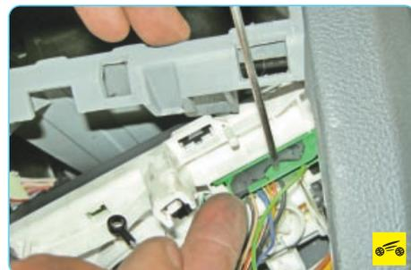
13. Отожмите держатель фиксирующей скобы колодки жгута проводов блока управления климатической системой...
