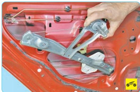
5. Извлеките механизм стеклоподъемника из проема во внутренней панели задней двери.
