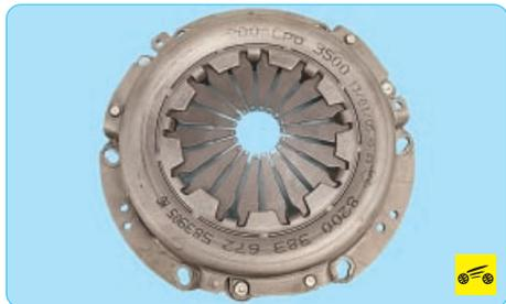
Нажимной диск смонтирован в стальном штампованном кожухе 2 (рис. 6.1), прикрепленном болтами к маховику двигателя.
