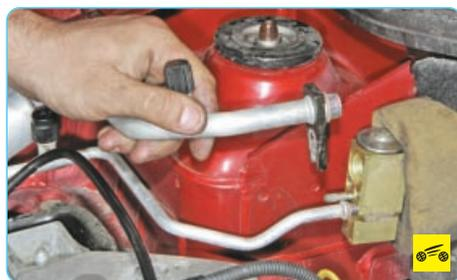
3. ...и отсоедините от клапана трубопроводы линий низкого...
