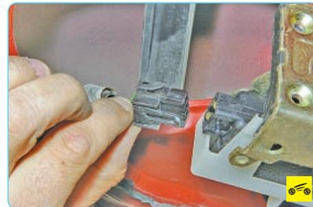
9. Отожмите отверткой держатель колодки жгута проводов замка задней двери, отсоедините колодку от замка и снимите замок.
