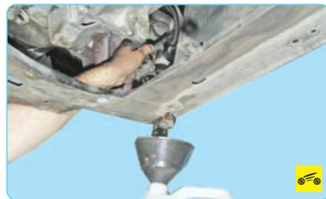
7. ...снимите шланг с патрубка и слейте охлаждающую жидкость из радиатора (см. «Замена охлаждающей жидкости», с. 108).
