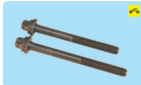
Болты крепления головки блока обязательно замените новыми. Повторное их использование не допускается. Обратите внимание на то, что болты разной длины. При их снятии запомните расположение болтов и затем установите их на прежние места.
