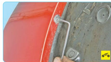
12. ...по одному винту переднего крепления подкрылков к бамперу и отведите подкрылки назад, отсоединив их от бампера.
