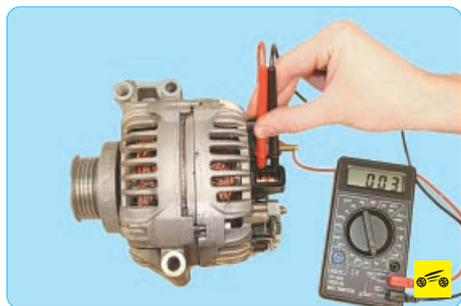
8. Проверьте омметром (тестером) сопротивление обмотки ротора, подсоединив его к контактным кольцам. Если омметр покажет бесконечность, значит, в обмотках обрыв и ротор нужно заменить.
