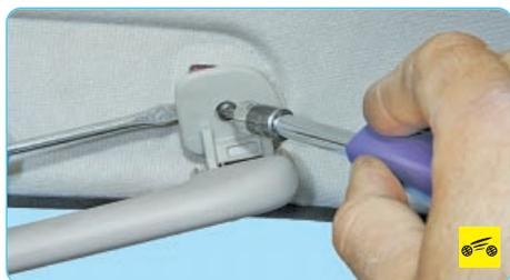
При затрудненном извлечении фиксаторов из гнезд в усилителе крыши аккуратно подденьте их отверткой.
