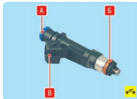
**Форсунки** прикреплены к рампе, из которой к ним подается топливо, а своими распылителями входят в отверстия впускной трубы. В отверстиях рампы и впускной трубы форсунки уплотнены резиновыми уплотнительными кольцами **А** и **Б**. Форсунка предназначена для дозированного впрыска топлива в цилиндр двигателя и представляет собой высокоточный электромеханический клапан. Топливо под давлением поступает из рампы по каналам внутри корпуса форсунки к запорному клапану. Пружина
