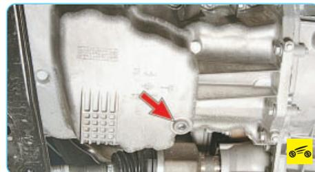
На двигателе К4М для доступа к пробке сливного отверстия на масляном картере необходимо предварительно снять защиту картера двигателя (см. «Снятие и установка защиты картера двигателя», с. 68).
