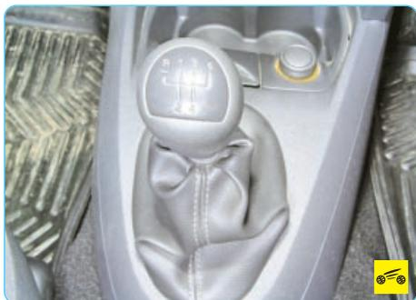
Механической коробкой передач управляйте согласно схеме переключений, нанесенной на рукоятку ее рычага. В нейтральном положении рычаг автоматически устанавливается в положение для включения III или IV передачи, из которого его можно переместить соответственно вперед или назад. Для включения I или II передачи переместите рычаг влево до упора, а затем вперед или назад соответственно.
