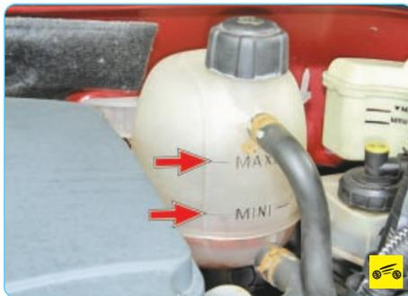
4. Проверьте уровень охлаждающей жидкости. Он должен быть между метками «MIN» и «MAX» на стенке расширительного бачка системы охлаждения двигателя.
