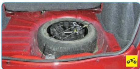
...находятся запасное колесо, а также уложенные в специальную кассету баллонный ключ, вороток домкрата, съемная буксирная проушина и домкрат.
