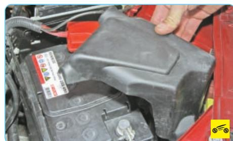
4. ...и снимите крышку монтажного блока.
