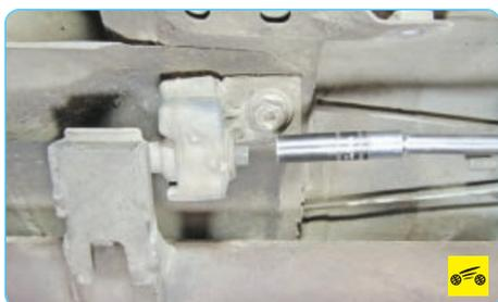
4. Выверните болт крепления кронштейна дополнительного глушителя к подушке.
