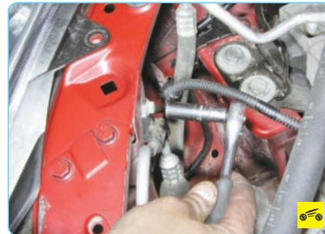
12. Выверните болт крепления держателя трубопровода линии высокого давления к кронштейну верхней рамки радиатора...
