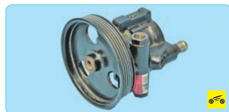
Давление рабочей жидкости в гидроусилителе создается насосом лопастного типа, который установлен на двигателе и при-
