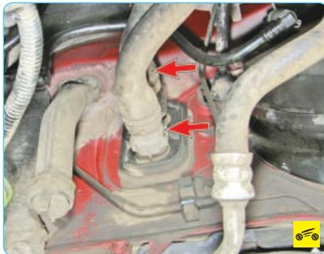
Радиатор отопителя соединен с системой охлаждения двигателя двумя шлангами.
