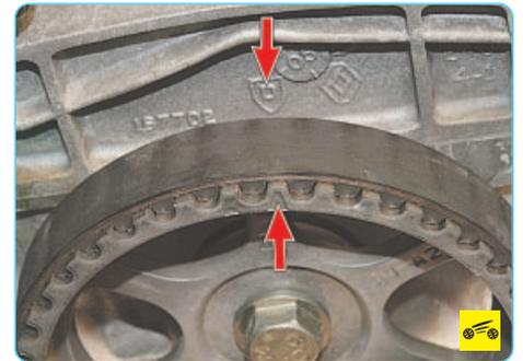
12. Проверьте совпадение меток на зубчатом шкиве распределительного вала и на крышке головки блока цилиндров.
