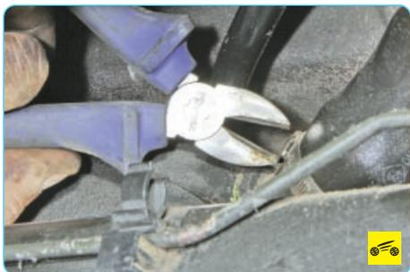
7. Бокорезами разрежьте хомут крепления наливной трубы и снимите трубу с фланца топливного бака.
