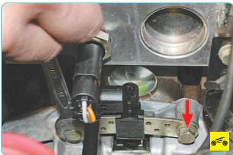
3. Выверните два болта крепления датчика...
