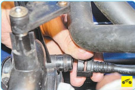
16. Отсоедините от впускной трубы шланг к вакуумному усилителю тормозов, сжав фиксаторы его крепления.
