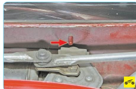
6. ...чтобы снять подушку ее крепления со штифта на кузове.
