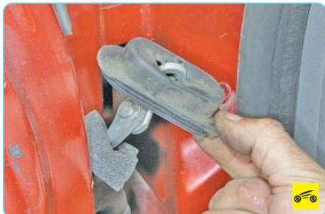
5. Придерживая ограничитель открывания передней двери через проем во внутренней панели кузова, снимите резиновый уплотнитель.
