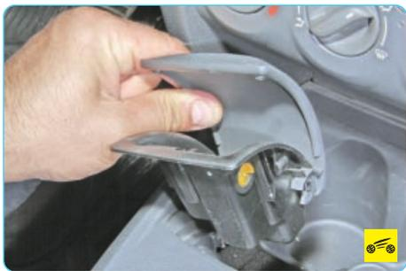
Для очистки извлеките пепельницу из гнезда в облицовке, преодолевая упругое сопротивление ее фиксаторов.
