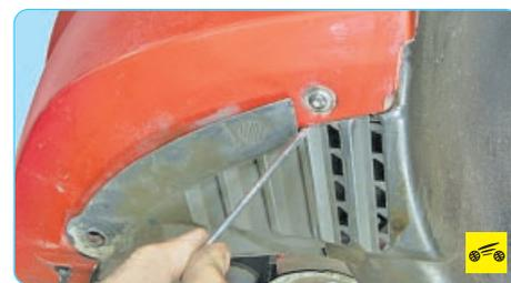
11. ...выверните по одному винту заднего крепления передних частей подкрылков...
