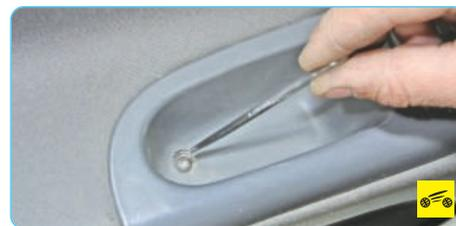
2. Выверните винт крепления блока переключателей электростеклоподъемников передних дверей и наружных зеркал.
