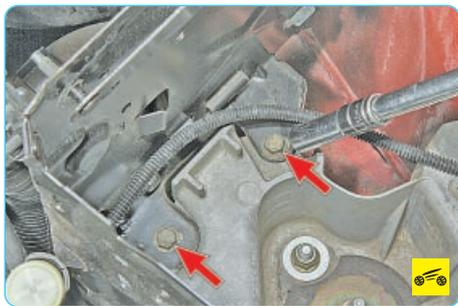
7. Выверните два болта крепления щитка к кронштейну левой опоры подвески силового агрегата.
