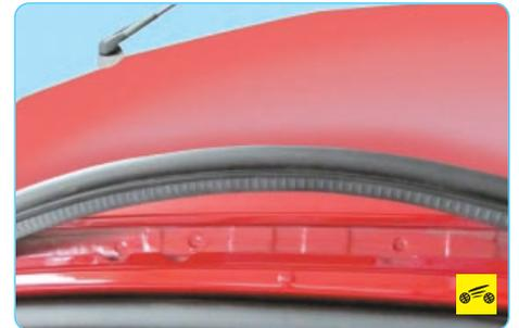
Так выглядят выштамповки для лап поперечных перекладин багажника (для наглядности частично снят уплотнитель проемов дверей).
