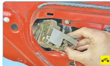
8. Извлеките замок из проема панели задней двери на длину подсоединенного жгута проводов.
