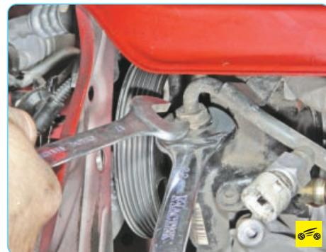
4. Выверните наконечник напорного трубопровода из корпуса насоса...
