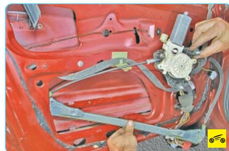
9. Выведите механизм стеклоподъемника в сборе с моторедуктором из нижнего проема внутренней панели передней двери.
