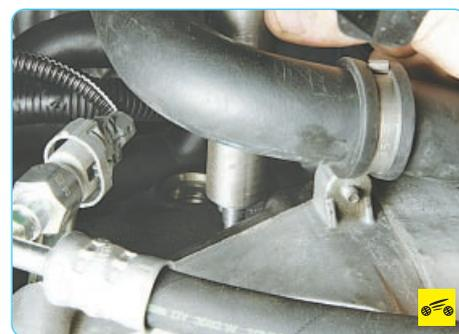
9. Вверните в отверстие фиксатор положения ВМТ.
