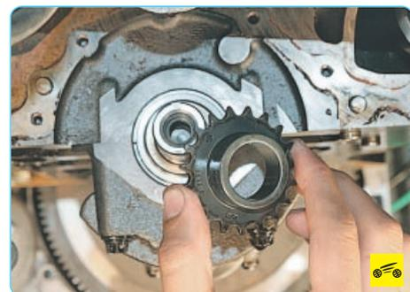
11. ...и шестерню привода масляного насоса.
