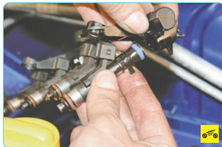
10. Извлеките форсунку из топливной рамы.
