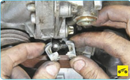
11. ...и снимите с пальца два пластиковых сухаря.
