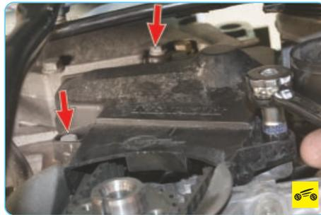
6. Выверните три болта крепления нижней крышки ремня привода газораспределительного механизма...
