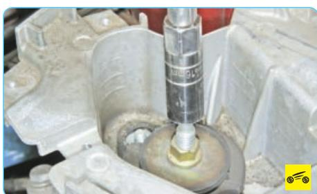
16. Отверните гайку шпильки крепления подушки левой опоры подвески силового агрегата к кронштейну опоры.
