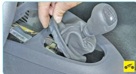
11. ...пропустите чехол рычага управления коробкой передач в отверстие облицовки, развернув его рамку боком...
