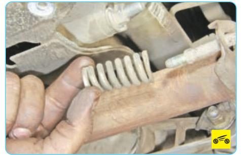
3. ...снимите пружины...
