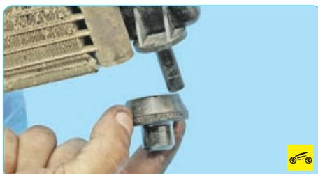
17. Снимите подушки с нижних опор блока радиатора системы охлаждения двигателя и конденсора, при необходимости замените их.
