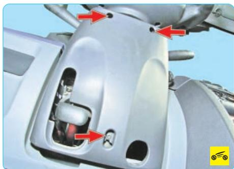
1. Выверните три винта крепления кожу- ху рулевой колонки.
