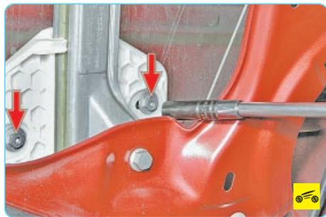
13. Выверните два болта крепления ползуна к обойме подвижного стекла задней двери.
