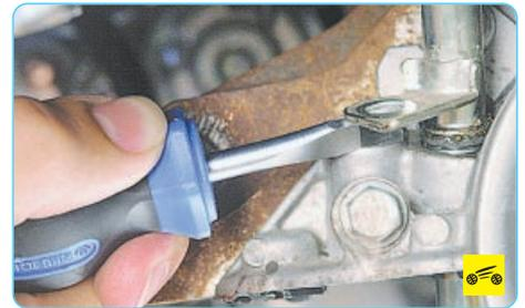
3. Поддев отверткой направляющую, извлеките ее из отверстия в блоке цилиндров и снимите с автомобиля.
