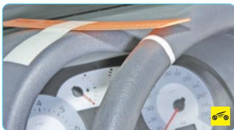
3. Не меняя положения линейки, поверните рулевое колесо вправо до момента начала поворота передних колес. В этом положении нанесите на обод рулевого колеса метку (закрепите проволоку).
