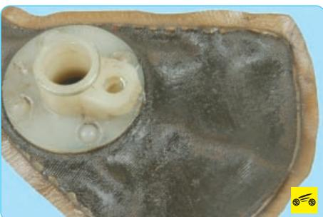
– загрязнение сетчатого фильтра топливного модуля (в обоих случаях модуль топливного насоса надо снять с автомобиля для ремонта);
