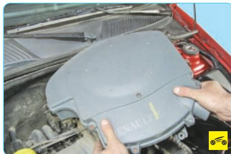
3. Снимите воздушный фильтр (см. «Снятие и установка воздушного фильтра», с. 116).
