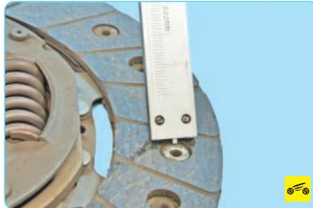
4. Осмотрите ведомый диск сцепления. Трещины на деталях ведомого диска не допускаются. Проверьте степень износа фрикционных накладок. Если головки заклепок утоплены менее чем на 0,2 мм, поверхность фрикционных накладок замаслена или ослаблены заклепочные соединения, то ведомый диск надо заменить.
