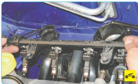
7. Снимите рампу, вынув форсунки из отверстий во впускной трубе (см. «Снятие и установка топливной рамы», с. 120).
