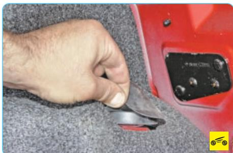
3. Подденьте край защитного чехла верхней опоры амортизатора...
