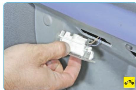
4. ...и извлеките плафон освещения вещевого ящика из панели приборов.
