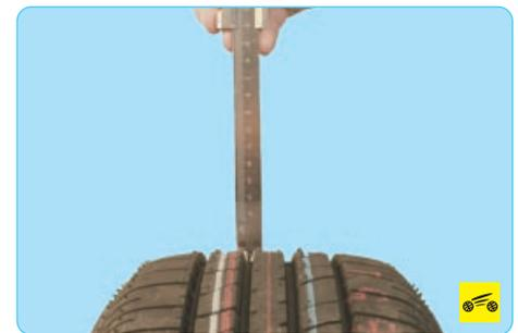
8. Измерьте штангенциркулем остаточную глубину протектора. Если глубина протектора 1,6 мм или меньше, замените шину.
