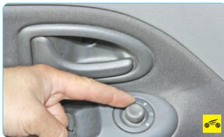
Для регулировки положения зеркал наклоните в соответствующую сторону рукоятку джойстика. При отпускании рукоятка автоматически возвращается в среднее положение. По окончании регулировки поверните рукоятку в среднее положение.
