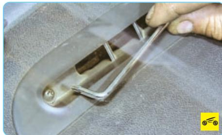
8. Выверните три винта крепления сопла обдува ветрового стекла.
