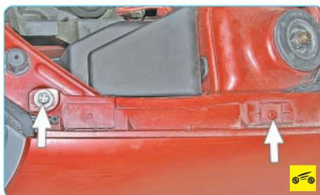
9. Выверните два болта верхнего крепления и снимите крыло.
