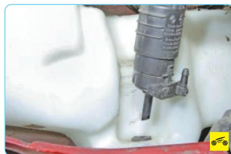
9. ...и снимите насос, вынимая его штуцер из отверстия в бачке.
