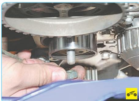
8. Для замены натяжного ролика окончательно отверните гайку от его оси...
