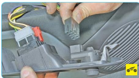
5. Отожмите фиксатор колодки жгута проводов джойстика управления наружными зеркалами заднего вида и отсоедините колодку от джойстика.
