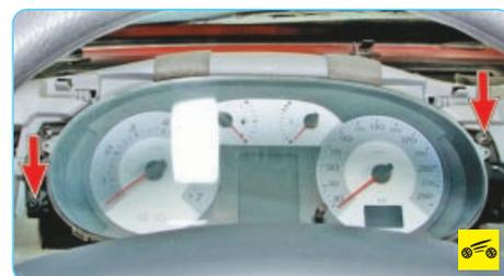
12. Выверните два винта крепления комбинации приборов.
