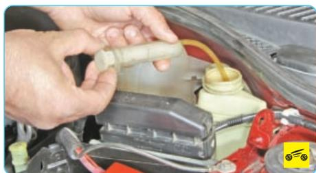
3. ...откачайте рабочую жидкость из бачка (например, большим шприцем) и установите пробку на место, чтобы в бачок не попала грязь.
