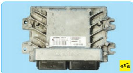
Электронный блок управления (ЭБУ, контроллер) связан электрическими проводами со всеми датчиками системы. Получая от них информацию, блок выполняет расчеты в соответствии с параметрами и алгоритмом управления, хранящимися в памяти программируемого постоянного запоминающего устройства (ПЗУ), и управляет исполнительными устройствами системы. Вариант программы, записанный в память ПЗУ, обозначен номером, присвоенным данной модификации ЭБУ.
