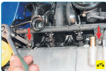
4. Выверните два болта крепления топливной рампы.
