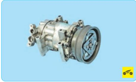
**Компрессор** установлен на блоке цилиндров двигателя и приводится во вращение поликлиновым ремнем.
