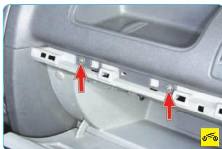
6. ...и выверните расположенные под ней винты крепления верхней накладки панели приборов.
