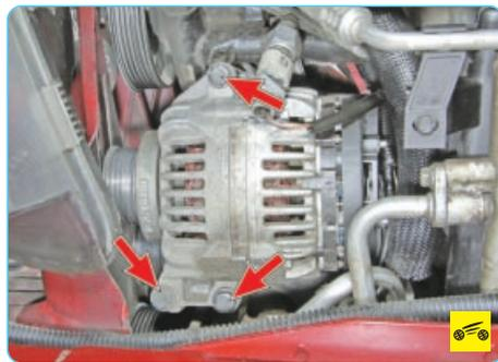
8. Выверните три болта крепления генератора...
