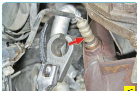
– **датчик концентрации кислорода в отработавших газах (лямбда-зонд)** (для наглядности термозщитный экран выпускного коллектора снят) – увеличение расхода топлива, снижение мощности двигателя, неустойчивая работа на холостом ходу, возможно повреждение каталитического нейтрализатора отработавших газов;
