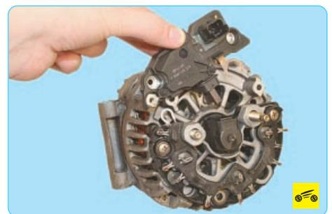
6. ...и снимите регулятор напряжения.
