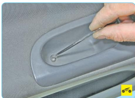
2. Выверните винт крепления блока переключателей управления электростеклоподъемниками дверей к кронштейну двери...
