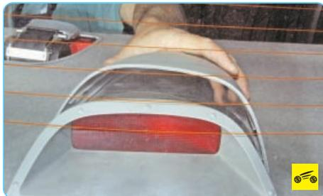
2. Снимите верхнюю облицовку дополнительного стоп-сигнала.
