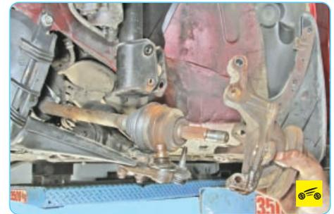
12. Придерживая вал привода от резкого опускания, снимите поворотный кулак в сборе со ступицей.
