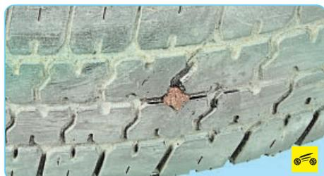
13. Подождите указанное в прилагаемой к ремонтному набору инструкции время, необходимое для полимеризации клея, и накачайте колесо до рекомендуемого давления.
