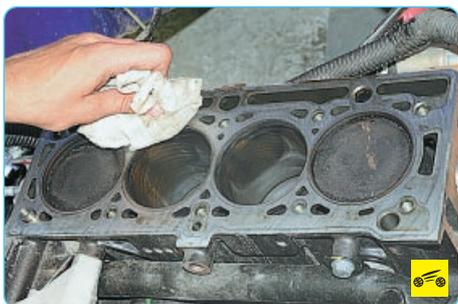
42. Очистите привалочные поверхности головки и блока.
