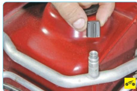
2. Отверните и снимите резьбовой колпачок любого из двух сервисных клапанов.
