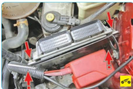
2. Отверните четыре гайки шпилек крепления электронного блока управления двигателем и снимите со шпилек кронштейн электронного блока.
