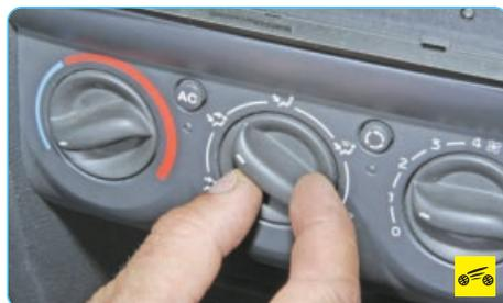
Для изменения направления подачи воздуха выберите рукояткой регулятора 3 (рис. 1.10) распределения потоков воздуха один из пяти вариантов (по часовой стрелке):
