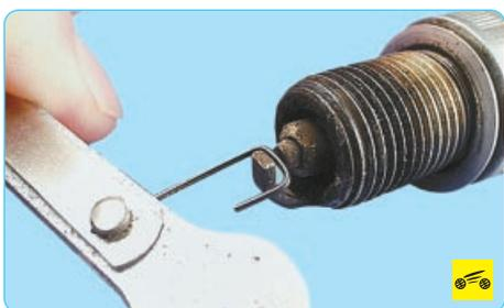
5. Проверьте зазор между электродами свечи щупом. Зазор должен составлять (0,95±0,05) мм.
