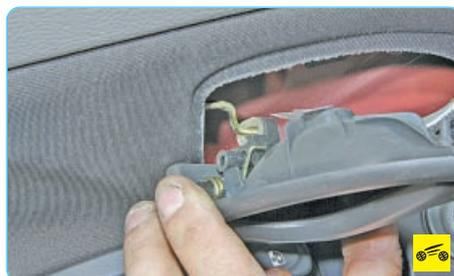
4. ...выведите наконечник тяги привода замка из втулки рычага внутренней ручки.
