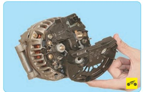
4. ...и снимите заднюю крышку генератора.
