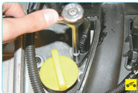
2. Выверните болт крепления катушки зажигания...
