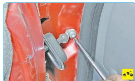
4. Выверните болт петли крепления ограничителя к стойке кузова. Обратите внимание, что на болт нанесен анаэробный фиксатор резьбы. При установке нанесите на болт новый фиксатор резьбы.
