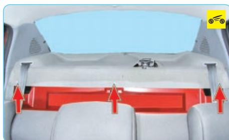
Так расположены пистоны крепления обивки задней полки.
