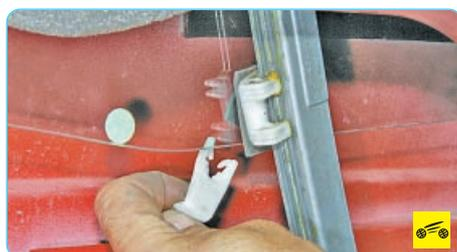
6. ...и, преодолевая сопротивление фиксаторов, снимите держатель с оси ползуна.
