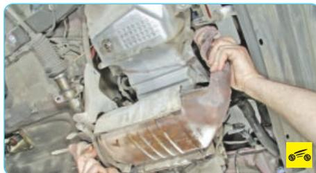
3. Снимите каталитический нейтрализатор (для наглядности показано со снятым подрамником передней подвески) (см. «Замена элементов системы выпуска отработавших газов», с. 126).
