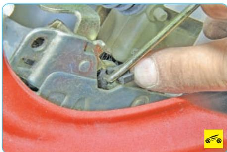
10. ...отожмите фиксатор тяги внутренней ручки...
