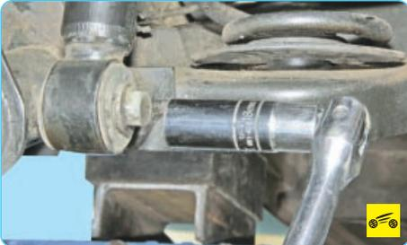
11. Выверните и извлеките болты нижних креплений амортизаторов.
