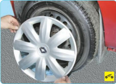
7. ...и, преодолевая сопротивление фиксаторов, снимите колпак.
