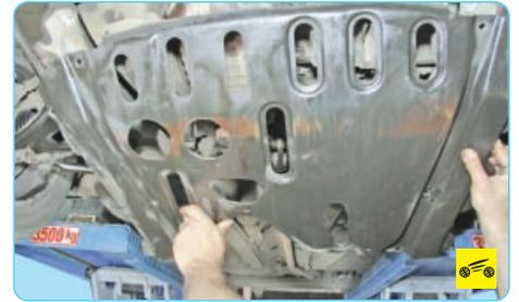
21. Снимите защиту картера двигателя (см. «Снятие и установка защиты картера двигателя», с. 68).
