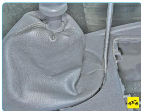
7. Подденьте отверткой край рамки чехла рычага управления коробкой передач...
