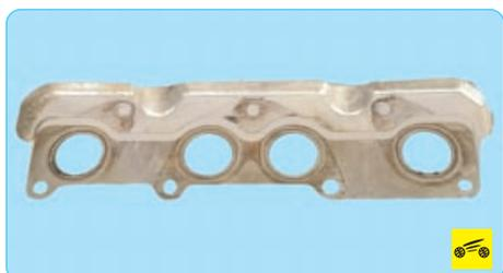
Между фланцами головки блока цилиндров и выпускного коллектора установлена уплотнительная прокладка, изготовленная из тонкой отформованной металлической полосы.
