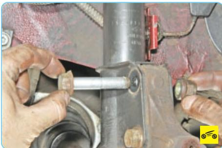
10. ...снимите гайку и извлеките из отверстия болт крепления. Аналогично снимите гайку и извлеките из отверстия болт нижнего крепления амортизаторной стойки к поворотному кулаку (для наглядности показано со снятым тормозным диском).
