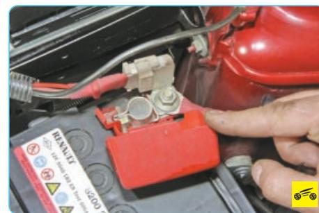
4. Откройте защитный колпачок клеммы «плюс» разряженной батареи.
