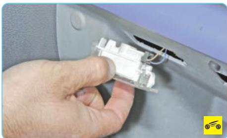
2. ...и извлеките плафон освещения вещевого ящика из панели приборов.
