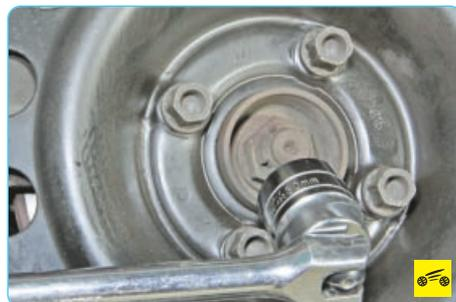
4. Ослабьте затяжку гайки ступицы и болтов крепления колеса.
