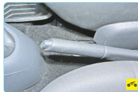
**Стояночный тормоз**, приводимый в действие механически, состоит из рычага, установленного на основании кузова между передними сиденьями, тяги с регулировочным устройством и уравнивателем, к которому присоединены два задних троса. Наконечники задних тросов соединены с разжимными рычагами тормозных механизмов задних колес. Разжимные рычаги воздействуют на задние тормозные колодки 8 после упора передних колодок 1 в тормозной барабан через распорную планку 7.
