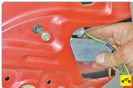
5. Ослабьте затяжку гайки шпильки верхнего крепления моторедуктора к внутренней панели передней двери и выведите шпильку нижнего крепления из отверстий панели двери.
