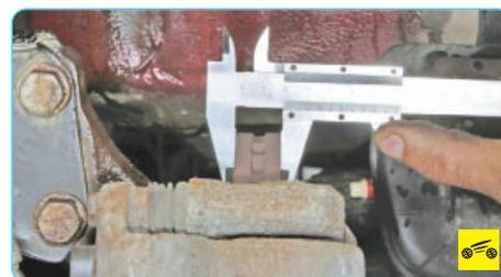
4. Измерьте толщину тормозного диска. Если его толщина меньше предельно допустимого значения (см. табл. 9.1), замените тормозной диск (см. «Замена тормозного диска», с. 193).
