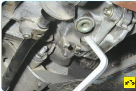
6. Для замены масла в коробке передач ослабьте затяжку пробки сливного отверстия...
