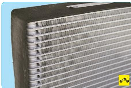
Испаритель расположен в блоке системы отопления и кондиционирования салона. Испаритель изготовлен из алюминиевых трубок с наружным оребрением для улучшения теплообмена. Проходя по трубкам испарителя, кипящий хладагент активно поглощает тепло из воздуха, обдувающего наружную оребренную поверхность трубок. Воздух охлаждается и вентилятором подается в салон автомобиля.
