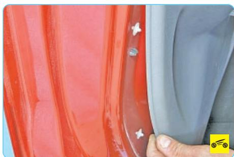
7. Подденьте край обивки задней двери и, преодолевая сопротивление фиксаторов и монтажной мастики, отведите обивку от панели двери.
