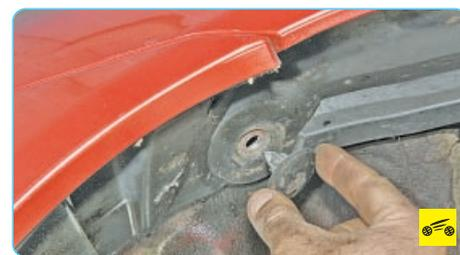
10. С обеих сторон автомобиля извлеките пистоны верхнего переднего крепления подкрылков...
