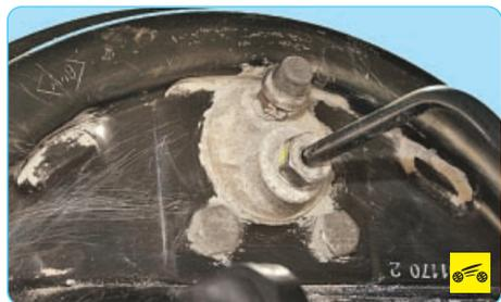
3. Очистите от грязи место крепления тормозной трубки и болты крепления рабочего цилиндра с обратной стороны тормозного щита.
