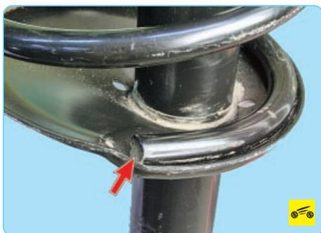
При установке пружины следите за тем, чтобы конец нижнего витка упирался в специальный выступ нижней чашки пружины.
