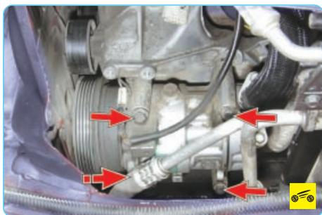
29. Выверните болты крепления компрессора кондиционера к кронштейну (для наглядности показано со снятым генератором), затем, не отсоединяя от него трубопроводы, отведите в сторону и закрепите любым доступным способом (например, привязав проволокой).
