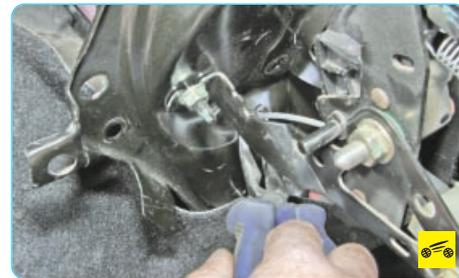
11. Сожмите пассатижами усики наколенника оболочки троса привода выключения сцепления и отсоедините оболочку от монтажной плиты педального узла.
