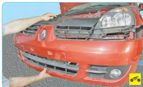
19. Снимите передний бампер.
