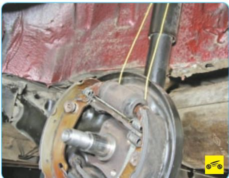
4. Зафиксируйте, например, проволокой щит тормозного механизма заднего колеса.
