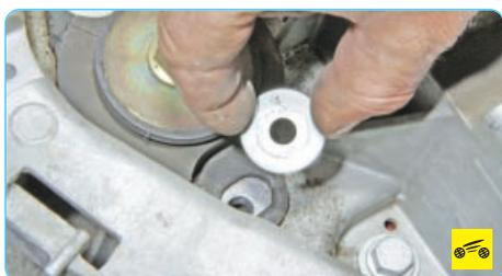
15. ...и шайбу. Аналогично отверните вторую гайку шпильки крепления подушки левой опоры подвески силового агрегата к кронштейну кузова. При установке обязательно замените гайки шпилек крепления опоры подвески силового агрегата.
