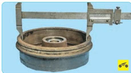
9. Измерьте штангенциркулем диаметр рабочей поверхности. Если диаметр превышает максимально допустимый, барабан подлежит замене.
