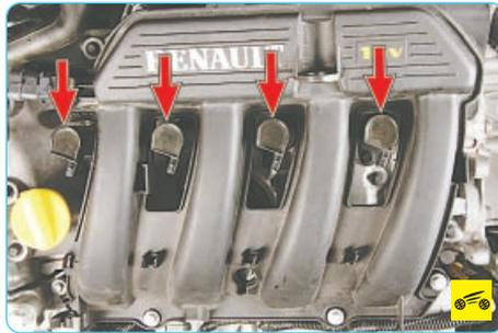
Различие заключается в том, что со свечей двигателя K4J необходимо предварительно снять четыре катушки зажигания.
