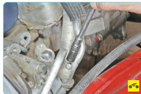
5. Выверните болт крепления фланца трубопровода линии высокого давления к фланцу компрессора кондиционера...
