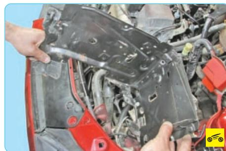
6. Снимите защитный щиток аккумуляторной батареи (см. «Снятие и установка защитного щитка аккумуляторной батареи», с. 271).
