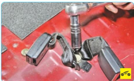
14. При необходимости выверните болт крепления замков ремней безопасности к основанию кузова...
