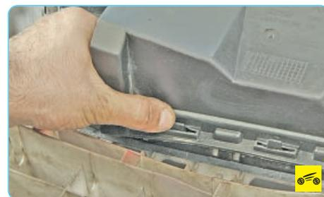
2. Отожмите нижние фиксаторы воздуховода...
