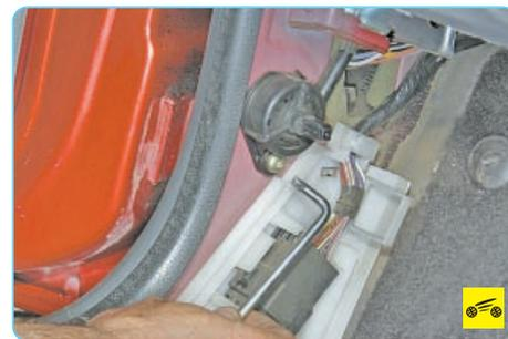
6. Выверните болт крепления привода замка капота к боковине кузова...
