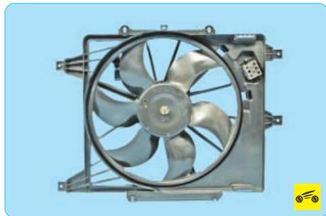
**Электровентилятор** с пластмассовой шестилопастной асимметричной крыльчаткой обеспечивает продувку радиатора воздухом на небольшой скорости движения автомобиля в основном в городских условиях или на горных дорогах, когда встречного потока воздуха недостаточно для охлаждения радиатора.
