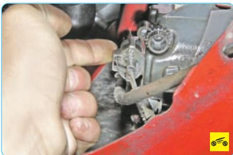
3. Сожмите фиксатор колодки жгута проводов...
