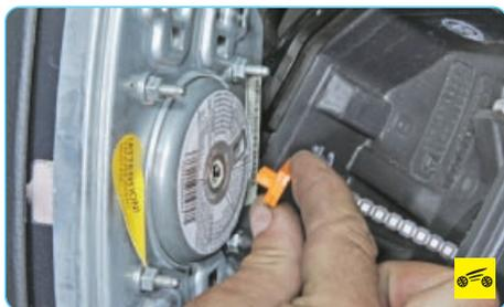
8. ...и, отсоединив колодку, снимите модуль с рулевого колеса.
