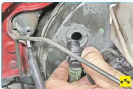
2. Отсоедините от вакуумного усилителя шланг к впускной трубе, вынув из его корпуса обратный клапан.
