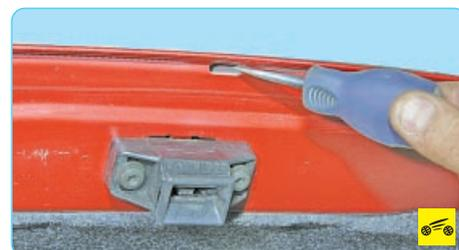
3. Три дренажных отверстия выполнены и в нижней кромке крышки багажника. Их также следует периодически прочищать, как и отверстия в боковых дверях.
