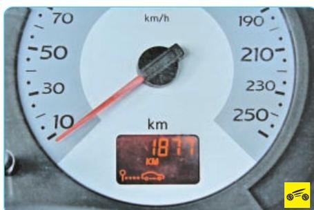
– в режиме **счетчика пробега после последнего обнуления показаний маршрутного компьютера** отображается суммарный пробег автомобиля с момента последнего обнуления всех показаний компьютера. Рабочий диапазон счетчика от 0,0 до 9999,9 км;
