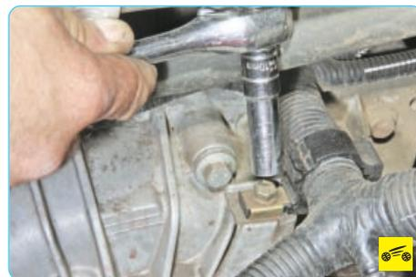
8. Выверните болт крепления держателя моторного жгута...
