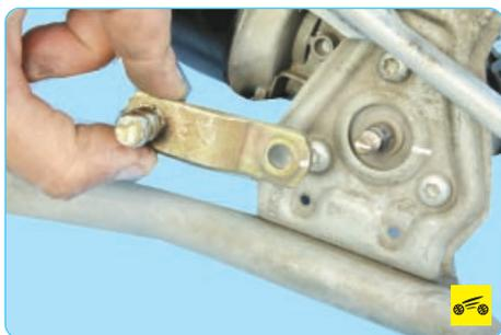
7. ...снимите кривошип моторедуктора.
