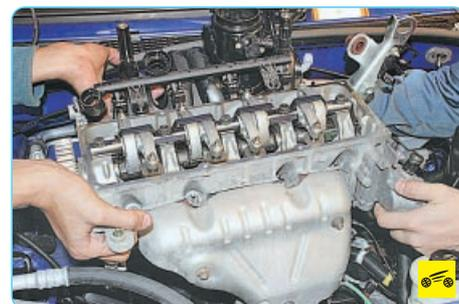
40. Снимите головку блока цилиндров в сборе с впускной трубой, дроссельным узлом и выпускным коллектором...
