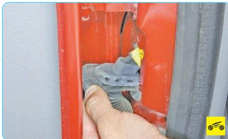
4. ...и извлеките уплотнитель со жгутом проводов из проема.
