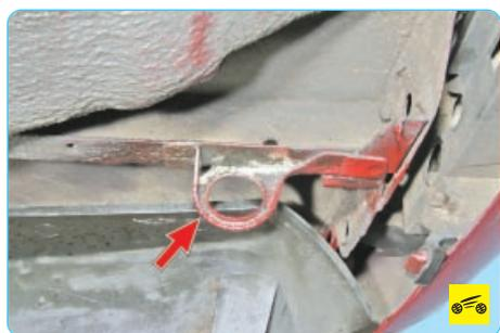
...и задней частях автомобиля расположены проушины, предназначенные для крепления автомобиля на платформе эвакуатора. Для буксировки или использования автомобиля в качестве буксировщика не закрепляйте трос за эти проушины – так можно повредить бамперы.
