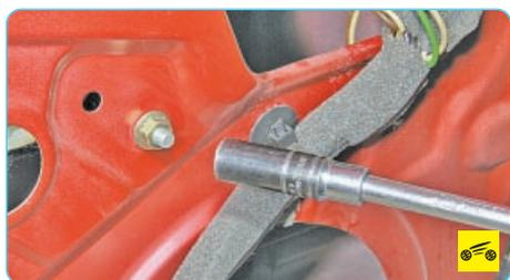
4. Отверните гайки 2 шпильки нижнего крепления моторедуктора к внутренней па-
