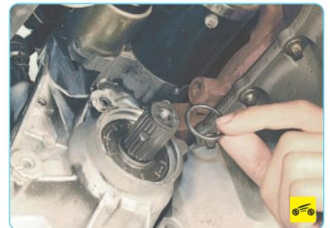
3. Снимите с хвостовика полуосевой шестерни резиновое уплотнительное кольцо.
