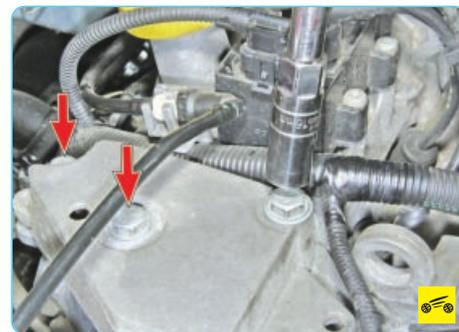
4. Выверните три болта крепления кронштейна правой опоры подвески силового агрегата к кронштейну двигателя...
