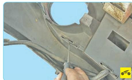
26. При необходимости замены облицовки противотуманной фары отожмите отверткой пять ее фиксаторов крепления к бамперу...
