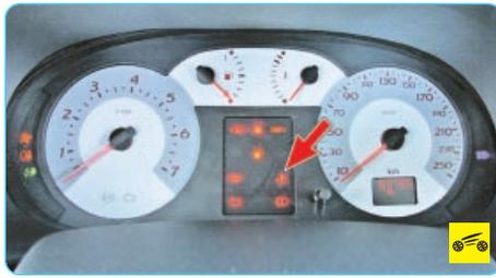
Помимо этого в блоке ламп комбинации приборов автомобиля установлена сигнальная лампа перегрева двигателя. Если двигатель перегревается, стрелка указателя переходит в красную зону шкалы и загорается сигнальная лампа.
