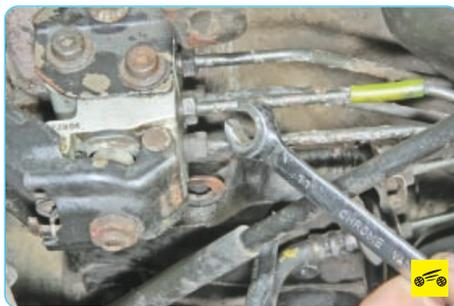
1. Отверните гайки крепления к регулятору четырех трубопроводов и отведите трубопроводы в сторону.
