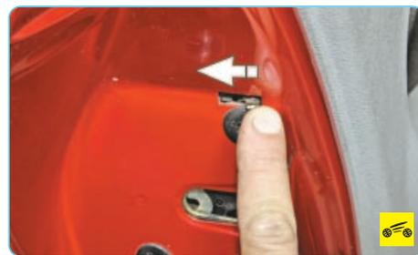
Если на заднем сиденье находятся дети, при открытой двери переместите выступающий за плоскость торца двери конец рычага блокировки замка в сторону наружной панели двери и закройте дверь. В этом случае при ненажатой кнопке блокировки можно открыть дверь только снаружи, внутренней ручкой замок отпереть невозможно.
