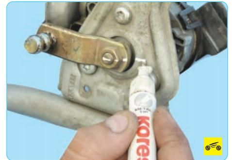
5. Пометьте любым способом взаимное расположение кривошипа, оси моторредуктора и кронштейна трапеции.
