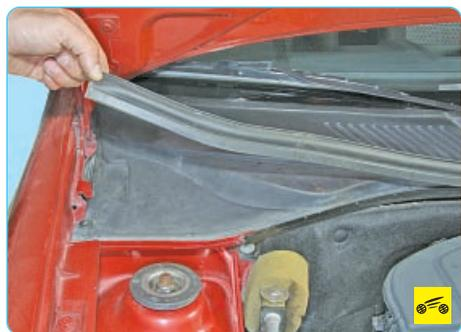
1. Возьмитесь за край уплотнителя капота и снимите уплотнитель.
