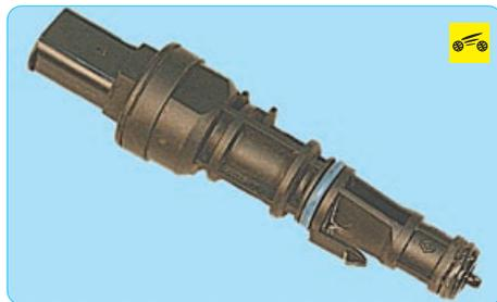
**Датчик скорости автомобиля** установлен на коробке передач. Принцип действия датчика основан на эффекте Холла. Датчик выдает на электронный блок управления прямоугольные импульсы напряжения с частотой, пропорциональной скорости вращения ведущих колес.
