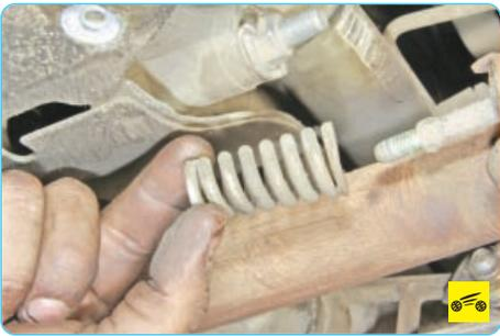
4. Снимите пружины...
