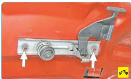
2. Отверните две гайки крепления блока защелки замка капота и предохранительного крючка к внутренней панели капота...
