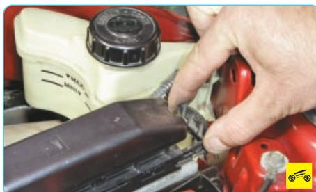
2. Выдвиньте фиксатор...
