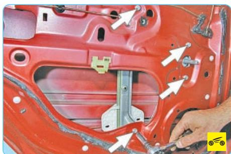
4. Выверните четыре болта крепления механизма стеклоподъемника к панели задней двери.
