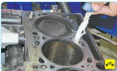
– удалите из резьбовых отверстий болтов крепления головки блока цилиндров масло или охлаждающую жидкость, попавшие туда при снятии головки;
