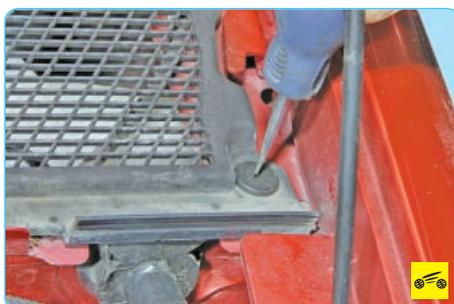
6. Выверните фиксатор пистона крепления левой части облицовки короба воздухопритока и извлеките пистон.
