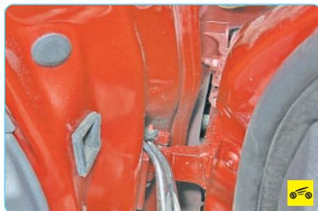
8. Поддев пассатижами, извлеките фиксатор из паза оси петель верхнего крепления передней двери и легкими ударами выбейте ось вниз. Аналогично выбейте ось нижнего крепления и снимите переднюю дверь.
