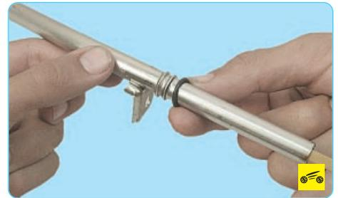
4. Снимите с направляющей уплотнительное кольцо. Новое кольцо перед установкой смажьте моторным маслом.
