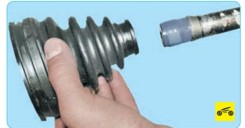
Для того чтобы при сборке не повредить чехол шарнира, оберните шлицевую часть вала изоляционной лентой.
