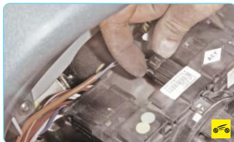
5. Отожмите фиксатор центральной колодки проводов контактного кольца подушки безопасности...
