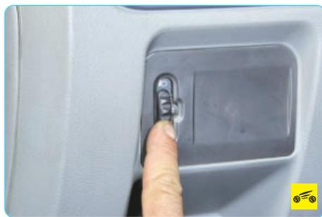
Поворотом рукоятки регулятора в зависимости от загрузки автомобиля изменяют угол наклона пучка света фар таким образом, чтобы исключить ослепление водителей встречного транспорта. Совмещение цифры на рукоятке регулятора и прорези на корпусе регулятора обеспечивает соответствующую регулировку положения фар при следующих вариантах загрузки автомобиля:
