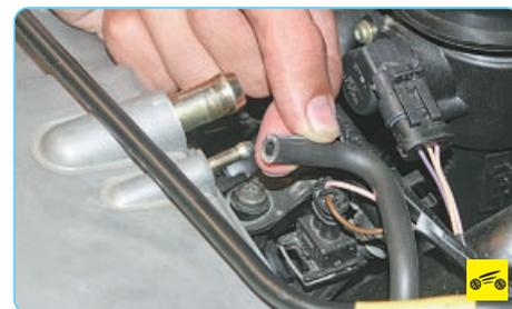
3. Снимите со второго патрубка крышки головки блока цилиндров шланг малой ветви системы вентиляции картера.
