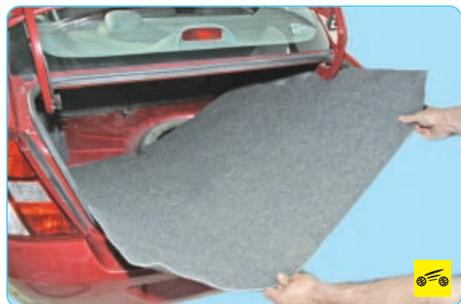
2. Потяните за край покрытия ниши для запасного колеса в багажнике и снимите покрытие.
