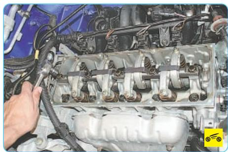
5. Равномерно ослабив затяжку пяти болтов крепления оси коромысел привода клапанов...
