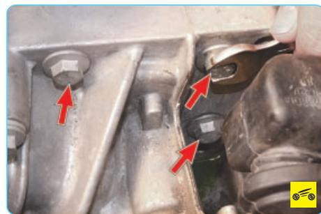
4. Стартер включается, его якорь вращается, но маховик остается неподвижным. Причины – ослабление крепления стартера к картеру сцепления, повреждение зубьев маховика или шестерни привода,
