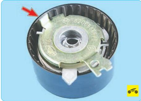
Выступ на натяжителе ролика должен совпасть с пазом на двигателе.
