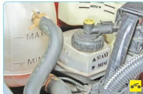
1. Бачок установлен на главном тормозном цилиндре с левой стороны моторного отсека у щита передка. Проверьте уровень тормозной жидкости в бачке. Он должен находиться между метками «MIN» и «MAX», нанесенными на корпус бачка.
