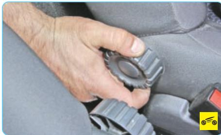
Для регулировки наклона, вращая вперед или назад рукоятку, расположенную с внутренней стороны сиденья, бесступенчато установите спинку в желаемое положение.
