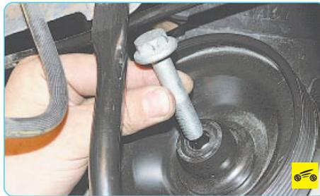
8. ...выверните окончательно болт крепления шкива...
