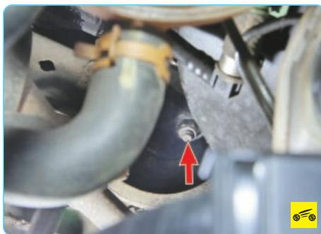
12. Под капотом отверните гайку болта клеммового соединения рулевого вала с валом рулевого механизма...
