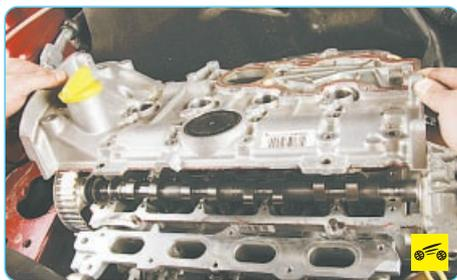
8. Снимите крышку головки блока цилиндров (см. «Замена прокладки крышки головки блока цилиндров», с. 80).
