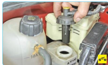
2. Если уровень жидкости ниже метки «MIN», отверните пробку бачка...
