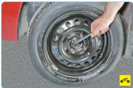
10. Проверьте затяжку болтов крепления колес и при необходимости затяните их моментом 90 Н·м.
