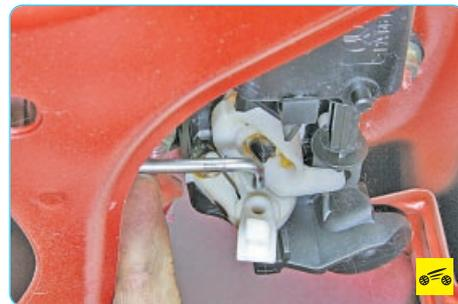
5. ...и отсоедините тягу от рычага привода замка.
