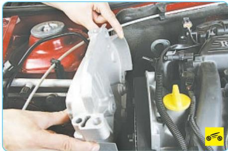
3. Снимите верхнюю крышку ремня привода газораспределительного механизма.
