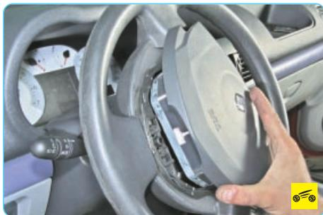
6. Через отверстие в коже рулевого колеса отожмите фиксатор модуля подушки безопасности водителя с другой стороны и отсоедините подушку от колеса.
