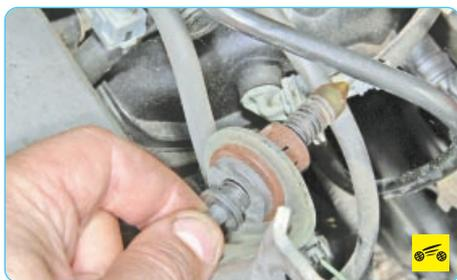
4. ...и перемещением вперед наконечника в отверстии резинового демпфера добейтесь, чтобы заслонка полностью закрывалась. При не полностью открывающейся дроссельной заслонке перемещением наконечника троса назад добейтесь, чтобы заслонка полностью открывалась. Зафиксируйте наконечник троса в новом положении, вставив скобу в его соответствующую прорезь.
