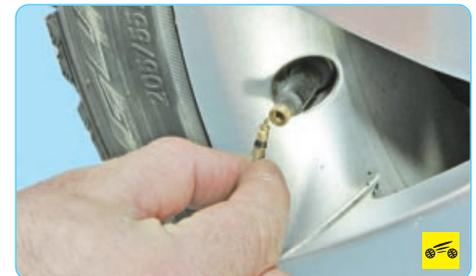
7. Нанесите на вентиль жидкость так, чтобы она заполнила собой полость вентиля. При дальнейшем образовании пузырьков и невозможности повернуть золотник, замените его. Если замена не помогла, замените вентиль.
