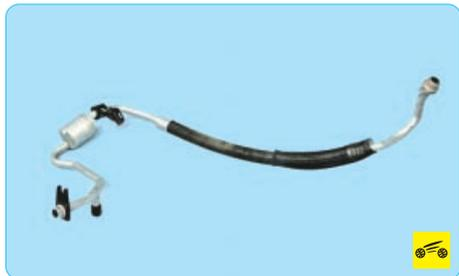
**Трубопроводы** соединяют все элементы системы кондиционирования в единый герметичный контур. Трубопроводы и фланцы их крепления изготовлены из алюминиевых сплавов.
