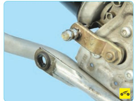
4. ...и снимите тягу трапеции с кривошипа моторредуктора.
