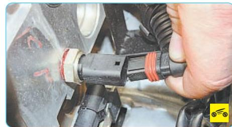
10. ...датчика температуры охлаждающей жидкости...
