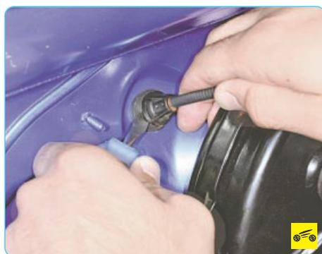
5. Поддев отверткой, извлеките из щита моторного отсека упор оболочки троса...
