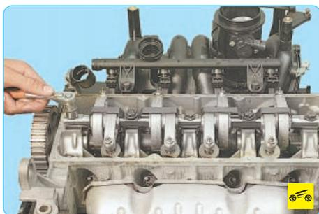
2. Равномерно ослабив затяжку, выверните пять болтов крепления оси коромысел клапанов...
