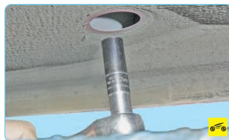
3. Через отверстия в основании кузова выверните две гайки крепления левых салазок сиденья...
