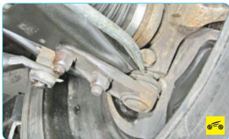
2. Проверьте шаровые опоры на наличие люфтов. Для этого вставьте монтажную лопатку между поворотным кулаком и рычагом подвески и, опираясь на рычаг, попытайтесь покачать поворотный кулак. Если есть люфт шарового пальца, замените шаровую опору.
