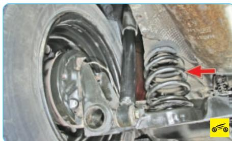
6. Осмотрите пружины задней подвески. При деформации или поломке витков замените пружины.
