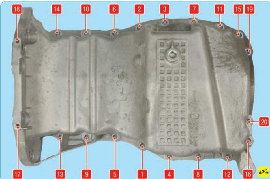
Рис. 5.11. Порядок затяжки болтов крепления масляного картера двигателя
