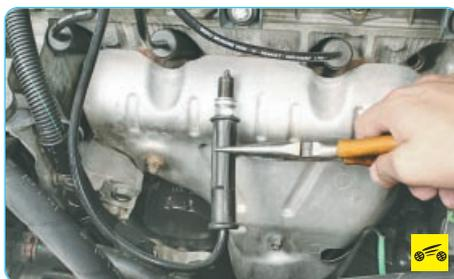
7. Возьмите запасную свечу. На двигателе K7J подсоедините к запасной свече высоковольтный провод 1-го цилиндра; на двигателе K4J – катушку 1-го цилиндра (см. «Проверка системы зажигания», с. 40). Любым способом зафиксируйте ее на двигателе. Пустите двигатель. Если перебои двигателя не усилились, замените свечу в 1-м цилиндре заведомо исправной. Если перебои усилились, последовательно повторяйте эту процедуру со всеми цилиндрами, чтобы обнаружить неисправную свечу.
