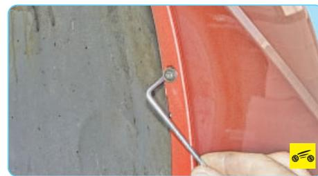
3. Выверните один винт переднего крепления...
