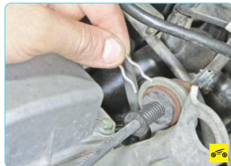
3. Извлеките из прорези наконечника троса пружинный фиксатор...
