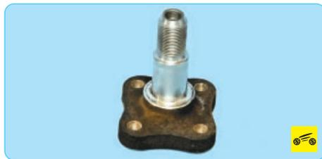
7. Установите новую цапфу, гайку ступицы заднего колеса затяните моментом 175 Н·м.
