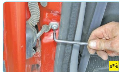
2. Выверните болт петли крепления ограничителя к центральной стойке кузова. Обратите внимание, что на болт нанесен анаэробный фиксатор резьбы. При установке нанесите на болт новый фиксатор резьбы.
