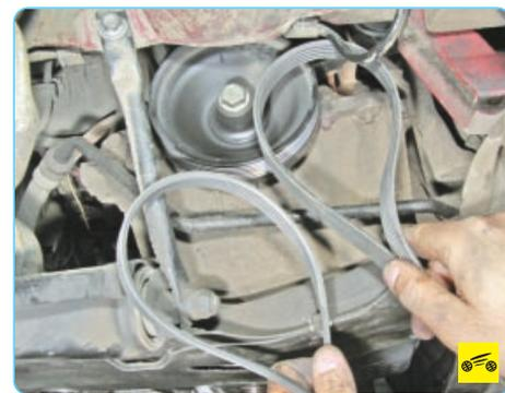
4. Снимите ремень привода вспомогательных агрегатов.
