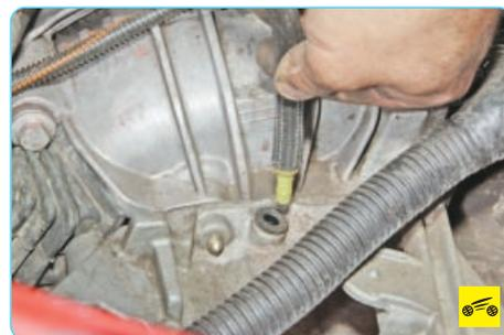
7. Отсоедините от коробки передач шланг сапуна, вынув его штуцер из уплотнительной втулки в картере коробки передач.
