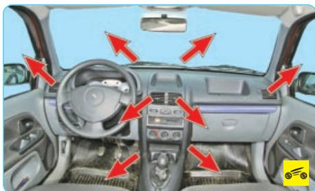
Воздух из воздухозаборника подается по воздуховодам в салон автомобиля через сопла обдува ветрового стекла, боковые и центральные сопла, а также через нижние сопла корпуса отопителя.
