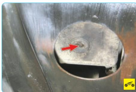
1. Очистите металлической щеткой, а затем тряпкой пробку сливного отверстия на масляном картере.
