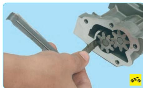
9. Измерьте радиальный зазор между шестернями и корпусом насоса. Он должен составлять 0,110–0,249 мм.
