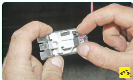
5. Сожмите фиксатор колодки жгута проводов...
