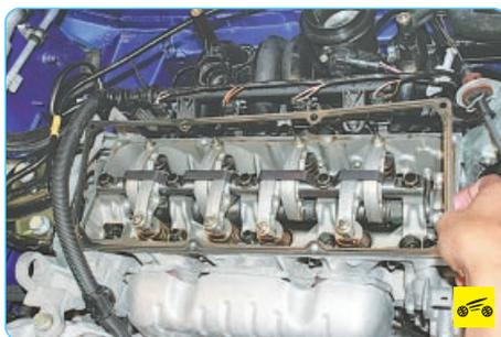
9. ...и установленную под ней прокладку. 10. Очистите пазы крышки и поверхность головки блока от остатков старой прокладки.
