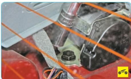
12. Выверните болт крепления инерционной катушки ремня безопасности бокового заднего пассажира...
