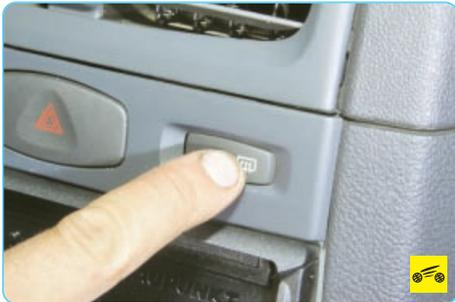
Для быстрого устранения запотевания заднего стекла нажмите на кнопку выключателя 17 (см. рис. 1.7) электрообогрева заднего стекла. При нажатии на кнопку выключателя (двигатель должен работать) включается электрообогрев стекла, одновременно в кнопке загорается контрольная лампа. При повторном нажатии на кнопку обогрев выключается, контрольная лампа гаснет.
