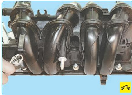
25. ...отверните три гайки нижнего крепления...
