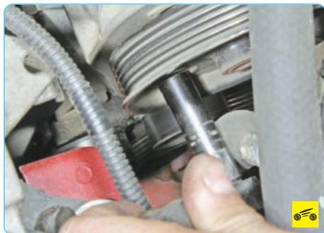
6. Выверните верхний и нижний болты крепления насоса через отверстия в шкиве.
