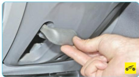
Для регулировки разблокируйте рулевую колонку, подняв рычаг вверх...
