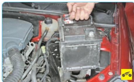
5. Снимите аккумуляторную батарею (см. «Снятие и установка аккумуляторной батареи», с. 204).
