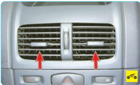
**9, 11** – центральные сопла системы вентиляции и отопления салона. Предназначены для подачи воздуха в центральную часть салона. Соплами регулируют направление и интенсивность потоков воздуха, см. «Отопление (кондиционирование) и вентиляция салона», с. 19.
