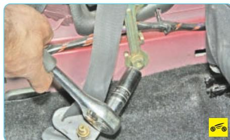
18. Выверните болт крепления инерционной катушки...
