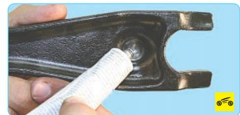
7. ...поверхности вилки, контактирующие с шаровой опорой...
