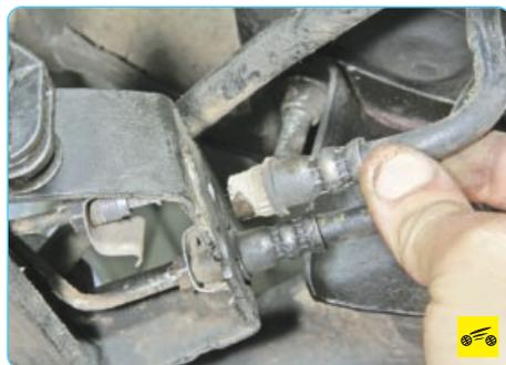
2. ...выньте наконечник из кронштейна на балке задней подвески и слейте тормозную жидкость из шланга в емкость.
