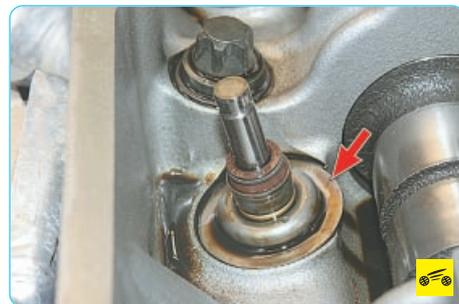
Опорную шайбу пружины клапана можно не снимать, так как она не мешает замене маслосъемного колпачка.
