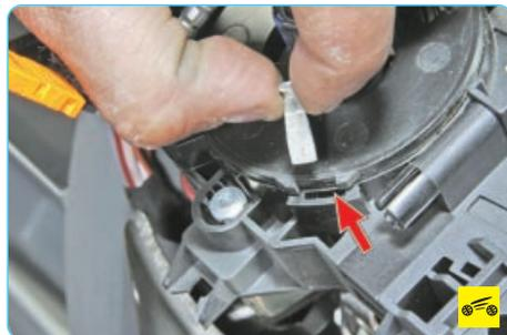
Снимайте рулевое колесо в положении, соответствующем прямолинейному движению, затем зафиксируйте контактное кольцо любым подходящим способом (штифтом).
