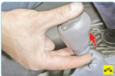
Для включения передачи заднего хода поднимите вверх до упора блокирующее кольцо под рукояткой рычага, переместите рычаг влево до упора, а затем вперед.
