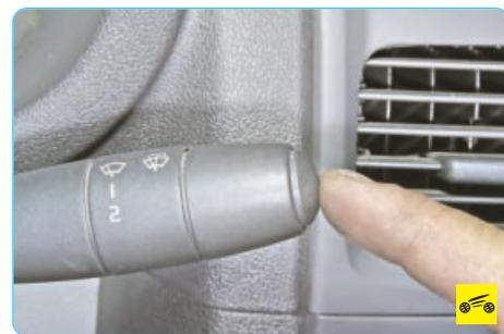
Информация маршрутного компьютера выводится на информационный дисплей 14 (см. рис. 1.8) в комбинации приборов нажатием на кнопку, установленную в торце рычага 8 (см. рис. 1.7) переключателя очистителя и омывателя ветрового стекла. Повторным нажатием на эту же кнопку на дисплее отображаются различные режимы работы маршрутного компьютера.
