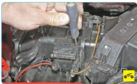
11. Отожмите фиксатор колодки жгута проводов...
