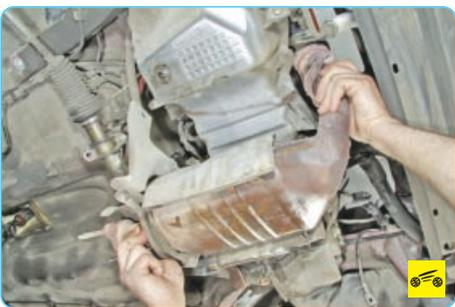
7. ...и снимите каталитический нейтрализатор.
