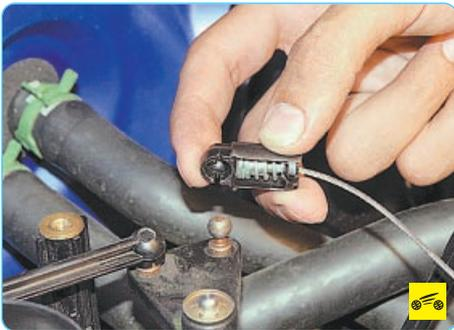
19. Снимите с шарового пальца промежуточного рычага наконечник троса привода дроссельной заслонки.
