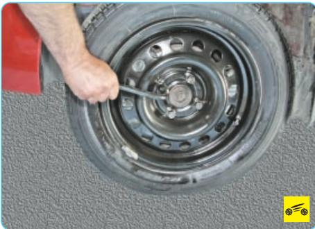
8. Включите первую передачу и стояночный тормоз. Штатным баллонным ключом ослабьте затяжку четырех болтов крепления колеса.
