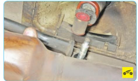
7. ...и отсоедините тягу от рычага управления коробкой передач.
