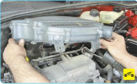
3. Снимите воздушный фильтр (см. «Снятие и установка воздушного фильтра», с. 116).
