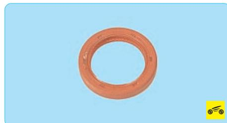
Сальник распределительного вала при каждом снятии заменяйте новым.
