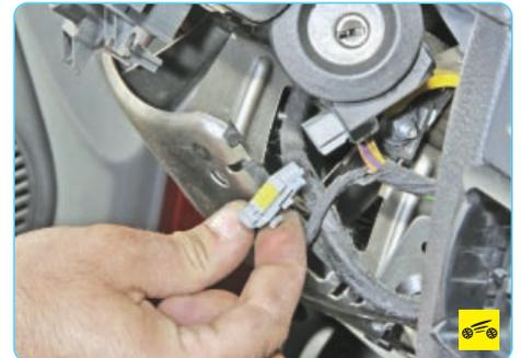
3. Сожмите фиксатор и отсоедините колодку жгута проводов от антенного блока иммобилизатора.
