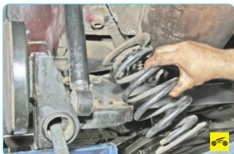
5. Снимите пружину в сборе с прокладками.
