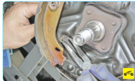
8. Сожмите пассатижами ушки фиксатора наконечника оболочки заднего троса привода стояночного тормоза...
