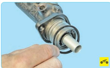
11. ...снимите с корпуса главного тормозного цилиндра резиновое уплотнительное кольцо.
