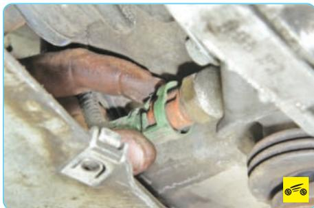
26. Сожмите фиксаторы колодки жгута проводов выключателя света заднего хода...
