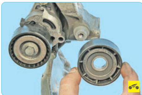
7. ...и снимите ролик.
