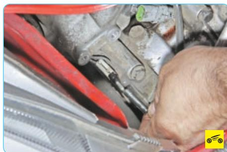
8. Отсоедините колодку провода электромагнитной муфты включения компрессора кондиционера.
