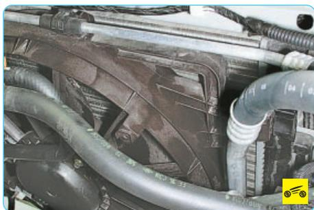
5. Очень часто причиной перегрева двигателя, система охлаждения которого оснащена электрическим вентилятором, является выход из строя вентилятора.
