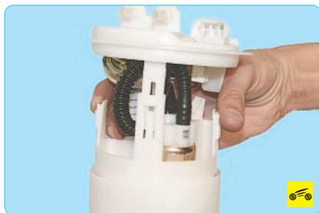
3. Сожмите фиксаторы и извлеките узел топливного насоса из стакана-накопителя.
