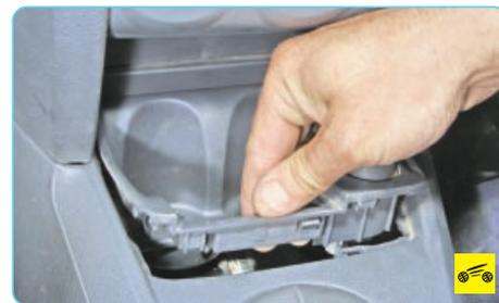
2. Возьмитесь за край и, преодолевая сопротивление пластмассовых фиксаторов, извлеките подстаканники из гнезда в облицовке тоннеля пола.
