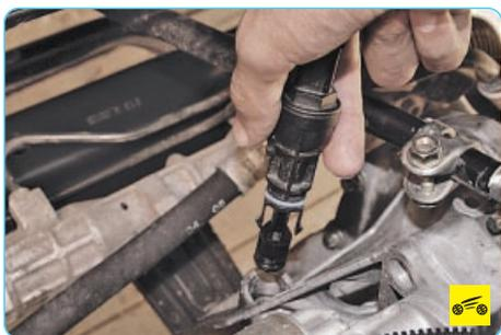
5. ...и извлеките его из картера коробки передач.
