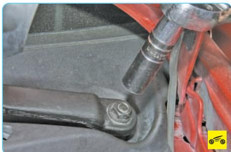
3. Отверните гайку крепления рычага стеклоочистителя...
