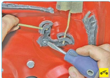
3. Сожмите фиксатор рычага привода блокировки замка задней двери...
