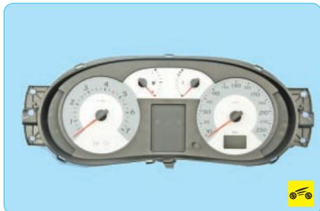
Все контрольно-измерительные приборы автомобиля объединены в комбинацию приборов. Она включает в себя спидометр, тахометр, счетчик общего и суточного пробега (одометр), указатель уровня топлива и температуры охлаждающей жидкости, сигнальные и контрольные лампы. В комбинации приборов также установлен дисплей бортового компьютера.
