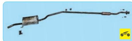
...и затем в блок основного и дополнительного глушителей.
