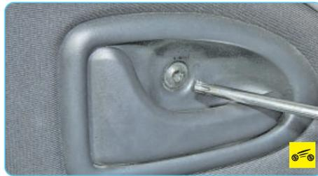
1. Выверните болт крепления внутренней ручки передней двери.
