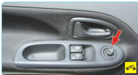
Джойстик управления зеркалами расположен на подлокотнике двери водителя в общей блоке с переключателями управления электростеклоподъемниками. Для регулировки положения зеркал необходимо, чтобы ключ в выключателе зажигания находился в положении «А» или «М».
