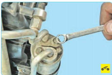
12. Выверните болт крепления фланца трубопровода к ресиверу-осушителю...
