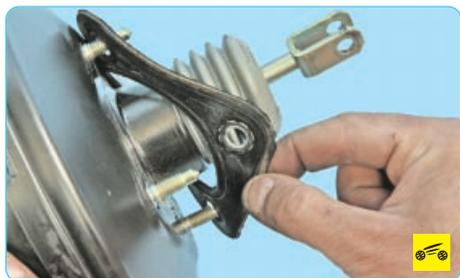
20. В случае замены вакуумного усилителя снимите уплотнительную прокладку и установите ее на новый усилитель.
