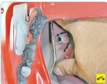
2. Отсоедините тягу замка передней двери от рычага наружной ручки.
