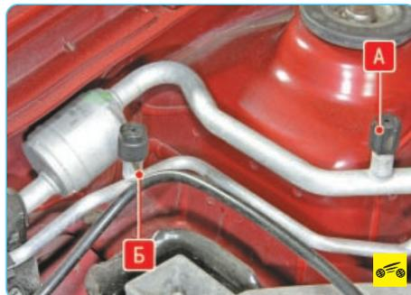
Так расположены на трубопроводах сервисные клапаны линий низкого А и высокого В давления.
