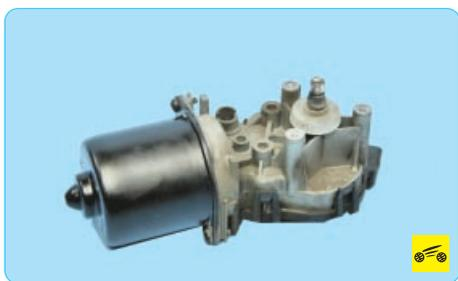
9. ...и снимите моторедуктор.
