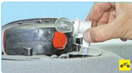
3. Поверните патрон лампы против часовой стрелки и извлеките его из фонаря.
