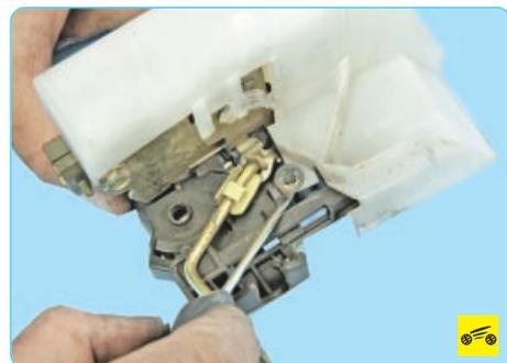
2. Снимите стопорное кольцо крепления кожуха электропривода замка...
