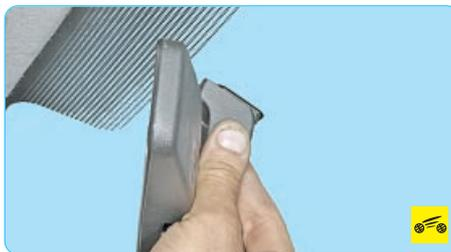
1. Преодолевая сопротивление пружинного фиксатора, сдвиньте зеркало вверх вдоль стекла...
