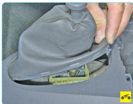
8. ...извлеките рамку из гнезда в облицовке тоннеля пола, преодолевая упругое сопротивление ее фиксаторов, и поднимите чехол по рычагу.
