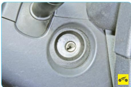
Для коммутации основных цепей автомобиля служит комбинированный выключатель (замок) зажигания, состоящий из контактной части и механического противогонного устройства с замком.
