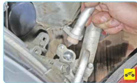
10. ...извлеките болт из отверстия и отсоедините трубопровод от компрессора.
