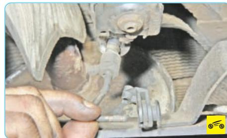
5. Отсоедините от балки задней подвески нагрузочный стержень регулятора тормозных сил в гидроприводе задних тормозов (см. «Замена регулятора тормозных сил в гидроприводе задних тормозов», с. 187).
