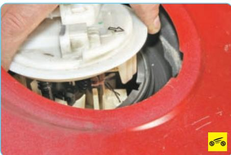
– неисправность топливного насоса;
