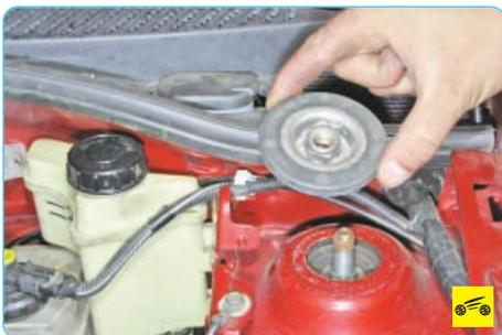
11. Отверните гайку упорной шайбы верхнего крепления амортизаторной стойки и снимите упорную шайбу.
