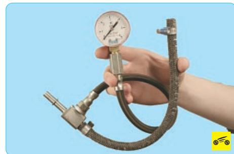
Проверка давления топлива в топливной рампе двигателя возможна только при наличии манометра с набором переходников для подключения к топливному трубопроводу.
