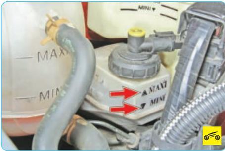
13. Долейте тормозную жидкость до уровня между метками «MAX» и «MIN» на стенке бачка и заверните пробку.
