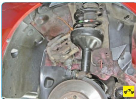
3. ...и закрепите суппорт проволокой к виткам пружины передней подвески, не допуская скручивания или натяжения шланга.
