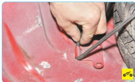
6. Подденьте жгут-фиксатор кассеты с инструментами и запасного колеса...
