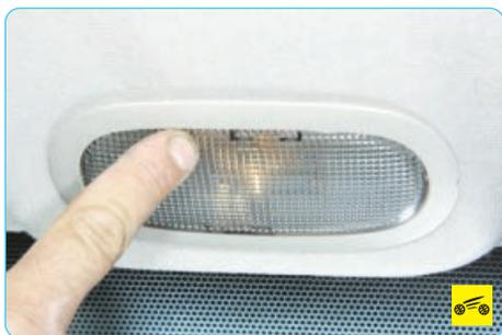
– среднее положение – плафон загорается при открывании любой боковой двери и гаснет при ее закрывании;
