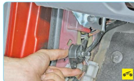
7. ...и снимите привод, вытягивая его трос в салон через уплотнитель в щите передка.
