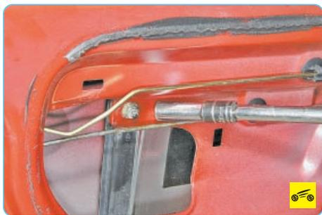
11. ...и отверните гайку нижнего крепления направляющей опускного стекла.
