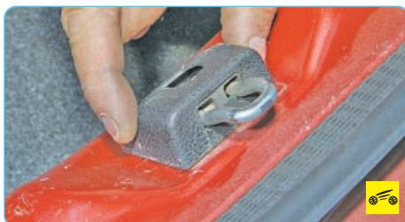
Если замок крышки багажника нечетко запирается или отпирается, если закрывание сопровождается ударом, отрегулируйте положение защелки замка, для чего при ослабленном болте крепления перемещайте защелку вправо-влево.
