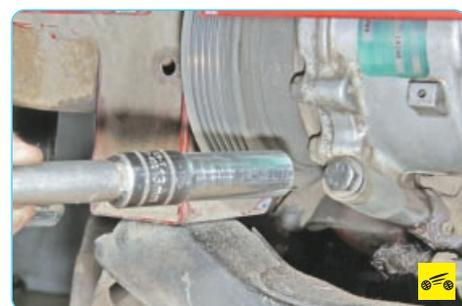
13. Выверните болты крепления компрессора к кронштейну на блоке цилиндров...
