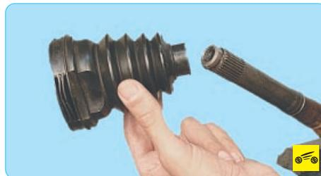
11. Снимите чехол с вала привода.
