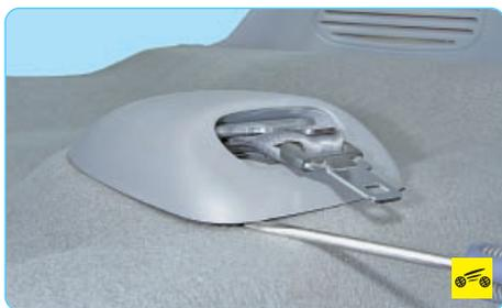
22. Подденьте отверткой край облицовки инерционной катушки безопасности среднего пассажира на заднем сиденье...
