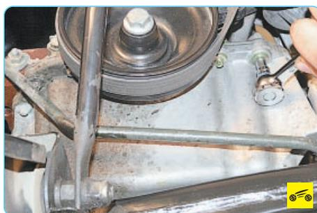
5. ...пять болтов крепления к блоку цилиндров спереди...
