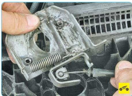
5. Переверните замок нижней стороной вверх. Выведите наконечник оболочки троса привода замка капота из держателя на корпусе замка.
