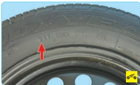
**DOT** – символ соответствия действующим стандартам безопасности, установленным транспортным департаментом США. Далее указан идентификационный или серийный номер шины (до 11 цифр и букв).
