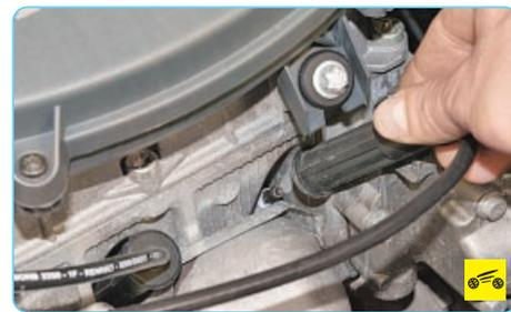
1. Снимите наконечник высоковольтного провода с заменяемой свечи.
