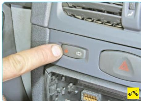
...или все двери (и крышку багажника) – клавишей блокировки, расположенной на панели приборов, нажав на ее левый край, а также кнопкой пульта управления в ключе зажигания (см. «Ключи автомобиля», с. 12).
