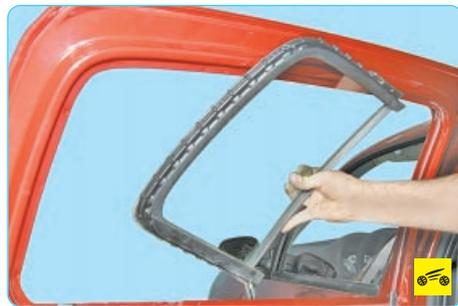
3. ...и снимите неподвижное стекло с уплотнителем в сборе.
