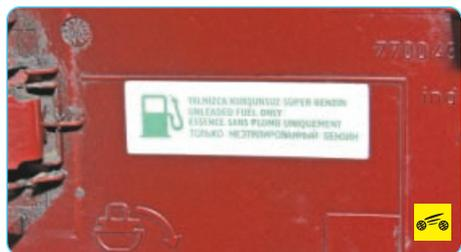
Используйте только неэтилированный бензин. Наконечники заправочных пистолетов колонок для этилированного бензина (колонки старого образца со стрелочными указателями) отличались увеличенным диаметром, поэтому для исключения случайной заправки таким бензином диаметр горловины наливной трубы сделан меньшим, чем у наконечников пистолетов этих колонок, следовательно, и у воронки должен быть наконечник малого диаметра.
