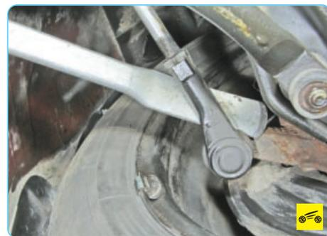
3. Проверьте наличие люфтов в шаровых шарнирах наконечников рулевых тяг. Наконечники, шарниры которых имеют ощутимый люфт, замените. Проверьте также надежность затяжки гаек пальцев шаровых шарниров наконечников рулевых тяг.
