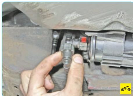
2. Осмотрите топливопроводы, их крепления к днищу кузова и топливному фильтру. При обнаружении трещин, потертостей или потеков топлива замените поврежденные топливопроводы. Замените поврежденные крепления.
