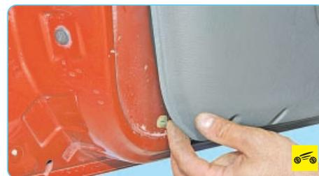
14. Подденьте отверткой край обивки передней двери и, преодолевая сопротивление фиксаторов и монтажной мастики...
