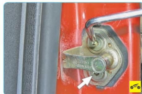
...для чего ослабьте болты крепления защелки к центральной стойке...
