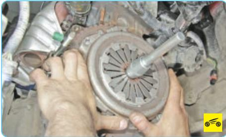
12. При монтаже сцепления сначала с помощью оправки установите ведомый диск, а затем на три центрирующих штифта – кожух нажимного диска и вверните болты крепления кожуха к маховику. Болты вворачивайте равномерно, по одному обороту ключа каждый, поочередно переходя от болта к болту по диаметру. Момент затяжки болтов 12 Н·м.
