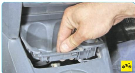
2. Подденьте край блока пепельницы, прикуривателя и подстаканника, извлеките блок из проема облицовки тоннеля пола...
