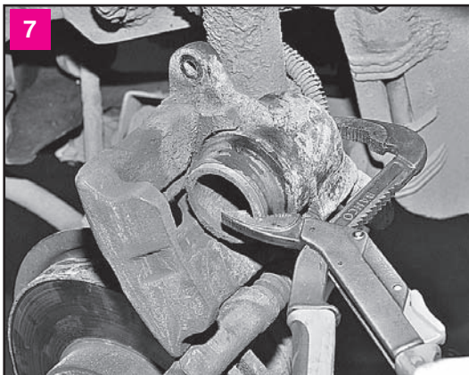
Перед установкой новых тормозных колодок губками раздвижных пассатижей утапливаем поршень в тормозной цилиндр (не повредите при этом резиновый пыльник поршня)
