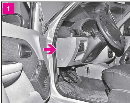
1 Монтажный блок предохранителей расположен на левом торце панели приборов под крышкой (показано стрелкой)
