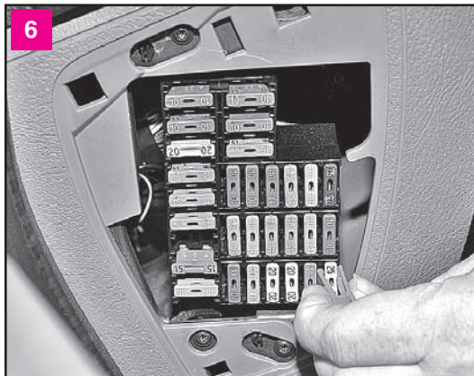
Захватываем пинцетом предохранитель
