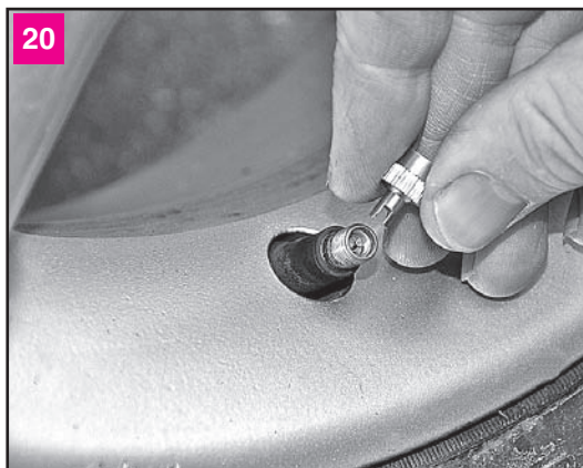
Если воздух из шины выходит через неисправный вентиль, специальным колпачком с выступами выворачиваем из вентиля золотник
