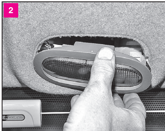
2 Отжав пальцами или шлицевой отверткой, вынимаем плафон из отверстия в обивке потолка
