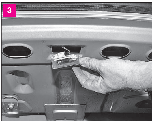
Выводим плафон из отверстия в полке
