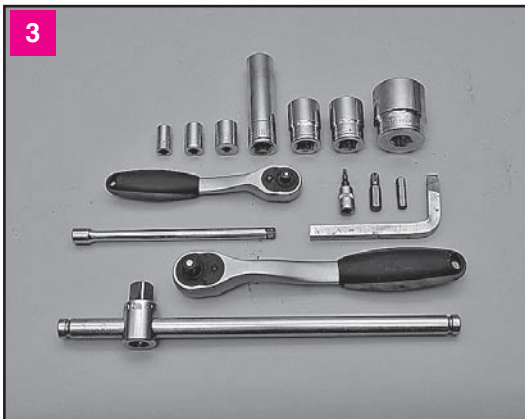
Торцевая головка: 8, 10, 13, 16 (высокая), 18, 19, 30; ключ Torx: T-20, T-40; шестигранник: 6; квадрат: 8; трещотки, удлинители
