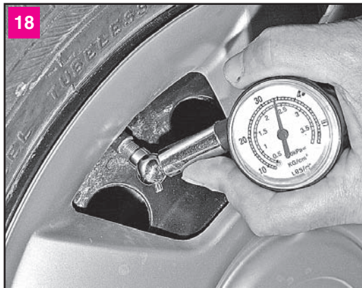
Проверяем давление шинным манометром. Оно должно составлять 2,1 бар для передних шин и 1,9 бар — для задних
