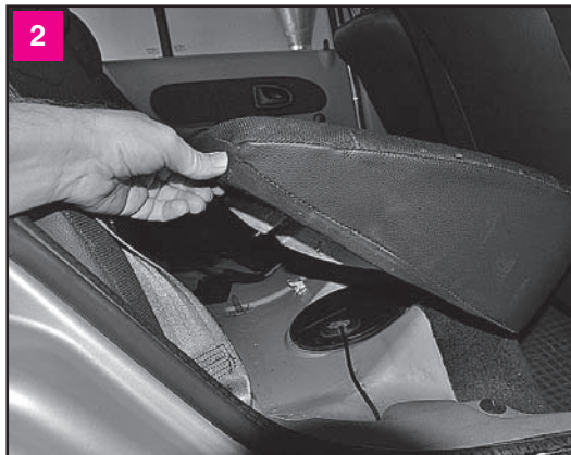
Чтобы сбросить давление топлива, необходимо выключить зажигание и отсоединить разъем питания топливного насоса. Для этого поднимаем подушку заднего сиденья
