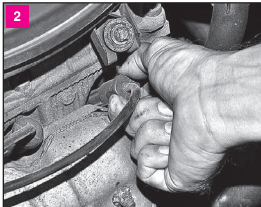
Отсоединяем наконечник высоковольтного провода от свечи (при этом тянуть следует только за наконечник, а не за провод)
