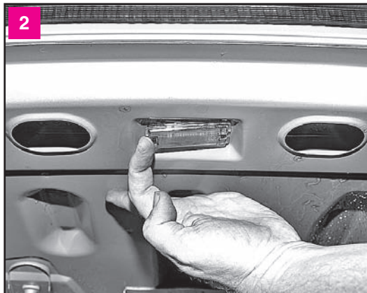
Для замены лампы плафон лучше снять. Нажимаем пальцем на фиксатор с правой стороны плафона
