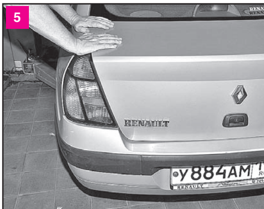
Нажимая поочередно на задние крылья автомобиля, аналогично проверяем состояние задних амортизаторов
