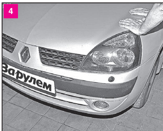
Нажимая на переднее крыло автомобиля, проверяем состояние амортизатора: после отпускания рук автомобиль не должен раскачиваться. Будьте осторожны: передние крылья выполнены из пластмассы
