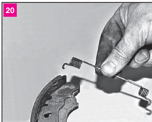
Отсоединяем от колодки верхнюю стяжную пружину. Устанавливаем новые колодки в обратной последовательности
