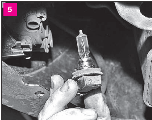
Извлекаем лампу из корпуса фары
