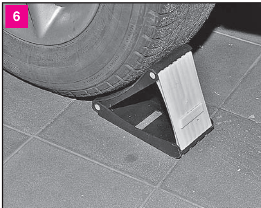
Под колесо, расположенное по диагонали от снимаемого, устанавливаем противооткатный упор (лучше установить два упора — под одно из передних и одно из задних колес)
