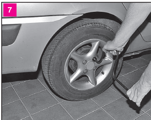
Штатным колесным ключом или головкой «на 19» ослабляем затяжку болтов крепления колеса
