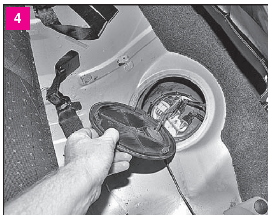
Поднимаем крышку, преодолевая усилие трех ее фиксаторов
