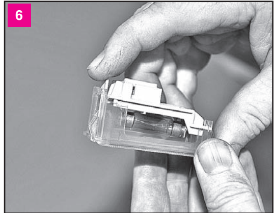
6 Нажимаем на фиксатор крепления рассеивателя
