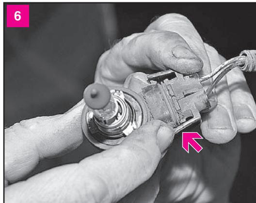
Освобождаем два фиксатора колодки проводов в месте ее соединения с разъемом патрона лампы
