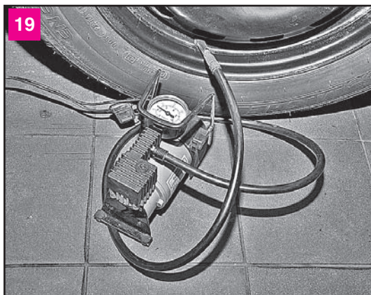
Если давление ниже нормы, подкачиваем шину компрессором или насосом
