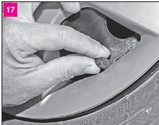
Для проверки давления в шине отворачиваем колпачок вентиля
