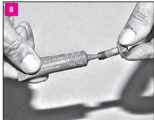
Ставим суппорт на место и заворачиваем нижний болт крепления суппорта, предварительно нанеся на его резьбовую часть фиксирующий герметик
