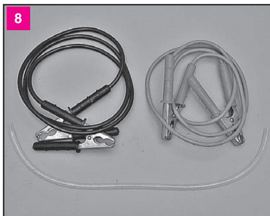
8 Провода для «прикуривания», шланг для прокачивания тормозов
