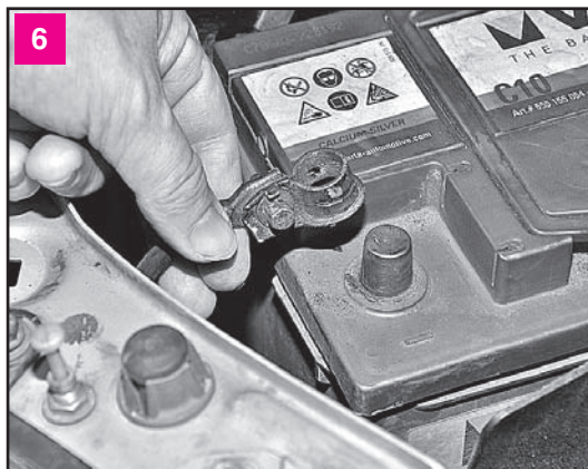
Снимаем клемму и отводим ее в сторону
