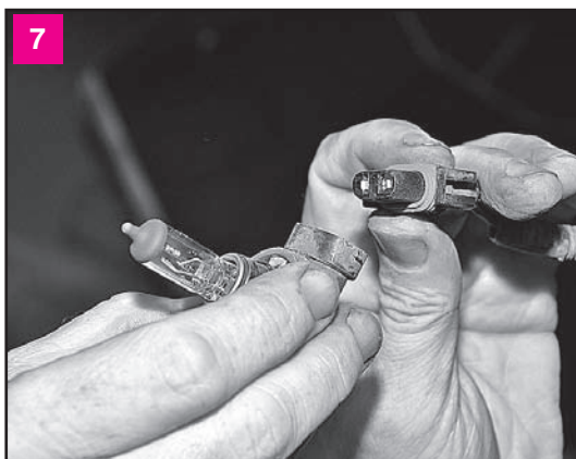
Отсоединяем колодку проводов
