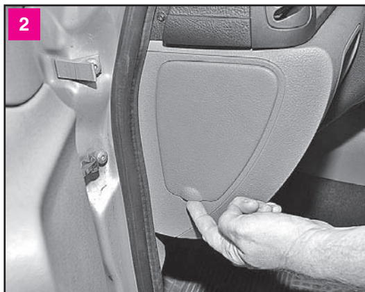
2 Поддеваем крышку за выступ и тянем ее на себя
