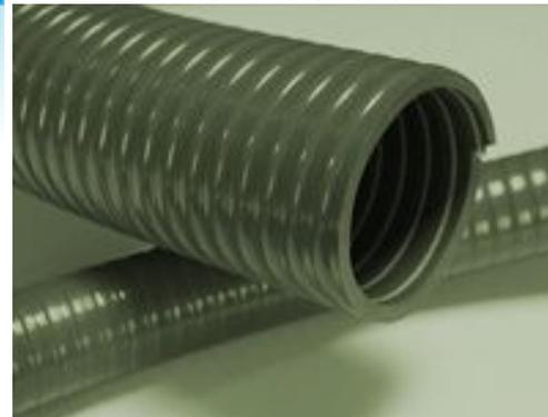
**Описание:** Очень эластичный шланг из ПВХ, армированный усиливающей спиралью из устойчивого к ударам и давлению ПВХ. Внутренняя поверхность гладкая, внешняя слегка ребристая. Это исполнение является чрезвычайно износостойким и гибким.
