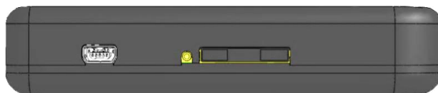
Рис. 2. Системный блок изделий (вид сбоку). Разъем MiniUSB и гнездо держателя SIM-карты с выталкивателем
