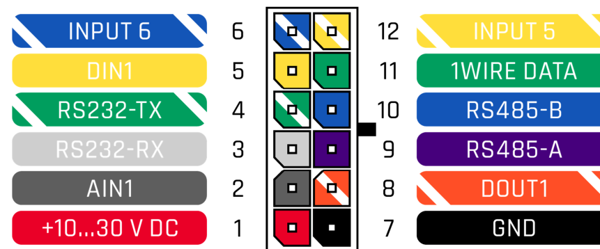
Рисунок 2 FMC125 2x6 распиновка розетки
