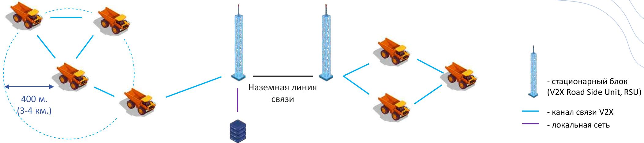
1. Обеспечивается возможность передачи данных через цепочку ТС, которые используются в качестве ретрансляторов сигнала. В цепочке может находиться до 4-5 ТС.
