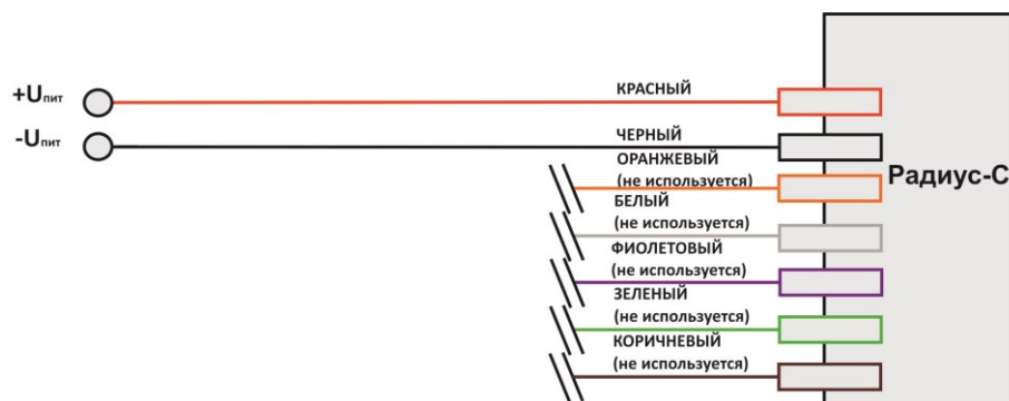
Рис.15. Схема подключения в режиме «Метка с питанием»
