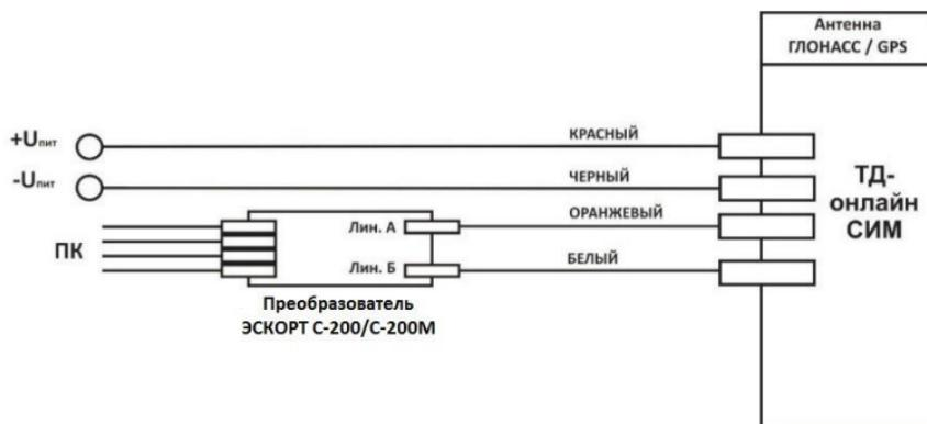
**ПРИЛОЖЕНИЕ 2.** Схема подключения измерителя в штатном режиме
