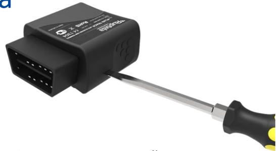
Рисунок 4. Используйте отвертку для вскрытия корпуса устройства.
