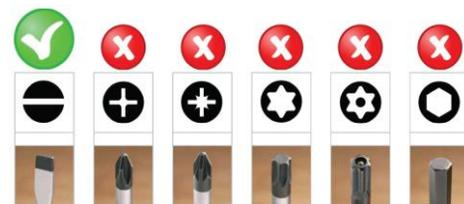
Рисунок 5. Используйте отвертку с прямым шлицом
