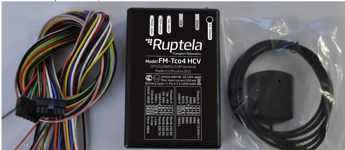
Рис 2. Содержимое коробки: устройство FM-Tco4 HCV, кабели IO, GPS/GLONASS антенна
