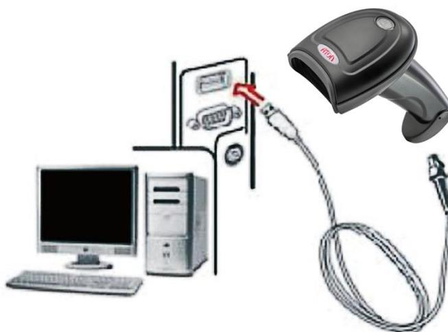
Рисунок 1. Подключение сканера к ПК
