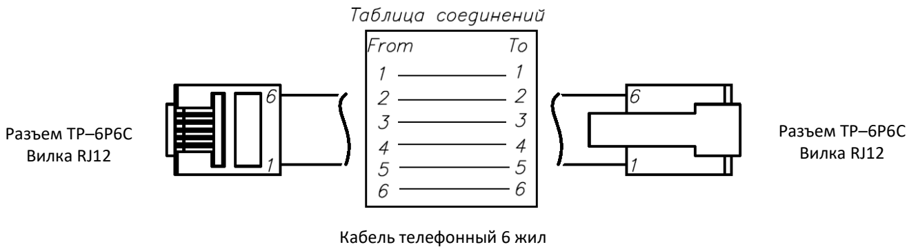
Рисунок 45. Схема кабеля денежного ящика
