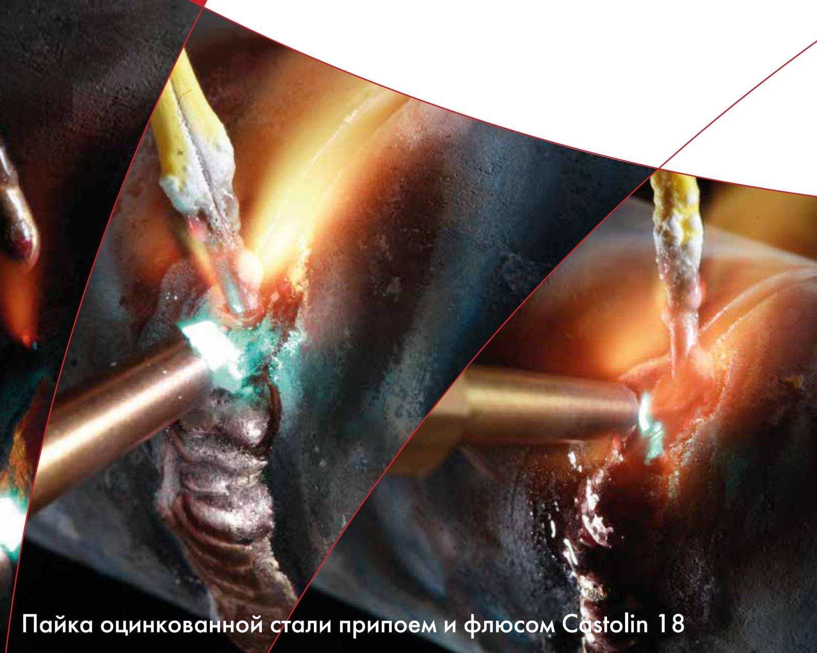
Пайка оцинкованной стали припоем и флюсом Castolin 18
