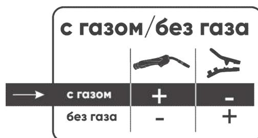
**Подключение к аппарату рукава для подачи защитного газа:**
