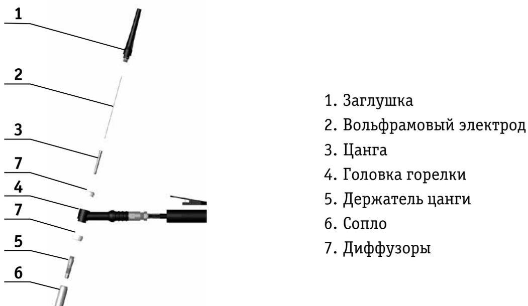
Рисунок 7.2.1 Основные компоненты горелки TIG
