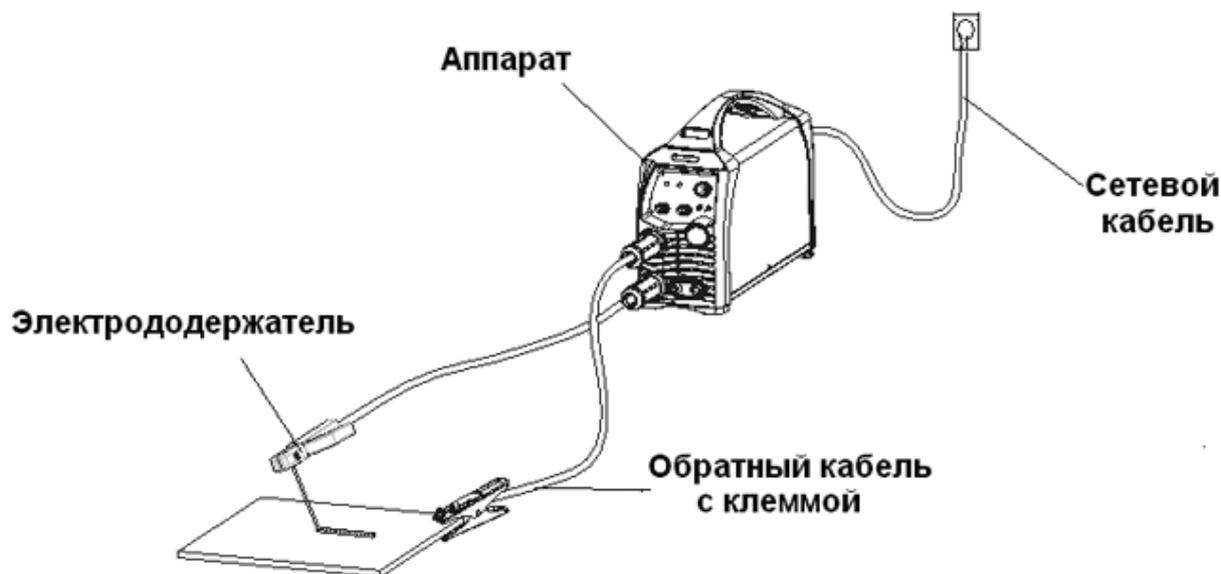
Рисунок 6.3 Схема подключения оборудования для ММА сварки.
