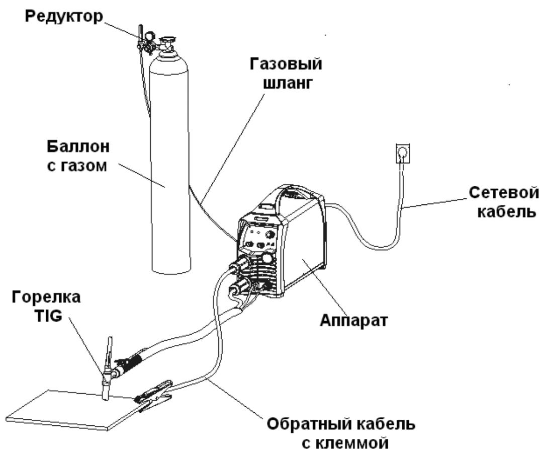
Рисунок 7.2.2 Схема подключения оборудования для TIG сварки
