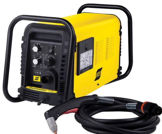
ESAB Cutmaster 120 весит всего 28 кг и обеспечивает мощность резки 120 ампер при рекомендуемой толщине разрезаемого металла 40 мм и максимальной толщине 55 мм. Эта компактная модель, как и все модели Cutmaster, имеет в стандартной комплектации плазматрон 1Torch, предоставляя комфорт и надежность, известные во всей отрасли.
