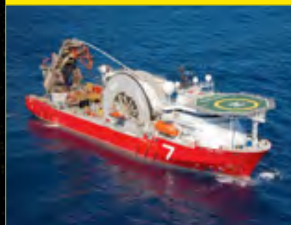
УКЛАДКА С БАРАБАНА (МОРСКАЯ)
