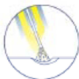
Рис.16б. Если расход защитного газа слишком велик, возникает турбулентность потока
