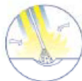
Рис.16а. Если расход защитного газа слишком мал, воздух попадает в зону сварки
