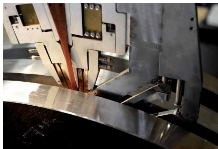
Двухстороннее слежение по стыку
