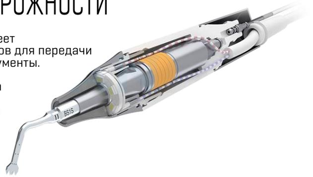
Несущий центральный стержень наконечника изготовлен из медицинской стали. Открытая торцевая часть стержня оснащена наружной резьбой упорного типа, предназначенной для фиксации сменных насадок. Внутренний (осевой) канал центрального стержня служит для подачи ирригационной жидкости, которая также охлаждает пьезоэлектрические кольца.
