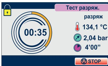
Этот цикл выполняется при пустой стерилизационной камере с установленными только держателем поддонов и поддонами.
