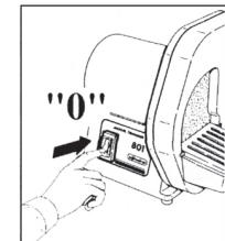
Сетевой выключатель имеет защитную панель, которая препятствует случайному включению оборудования и тем самым защищает оператора и окружающих людей. Чтобы выключить устройство по завершении работы, следует вынуть вилку из розетки. Если используется модель с системой водяного охлаждения, рекомендуется также закрыть кран подачи воды.
