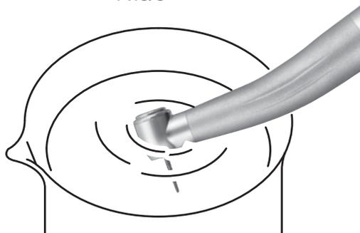
Наполните стакан наполовину чистой водой. Приведите наконечник в действие, погрузите половину головки работающего наконечника в воду (Рис.5).
