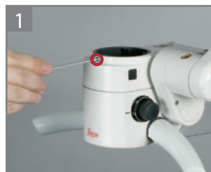
1 Выкрутите зажимной винт.
