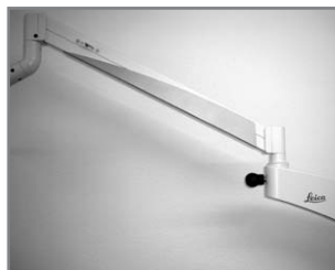
Отведите поворотный рычаг вверх. Свет автоматически выключится.
