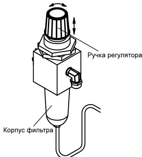
Рис.18 Фильтр-клапан воздушный в сборе
