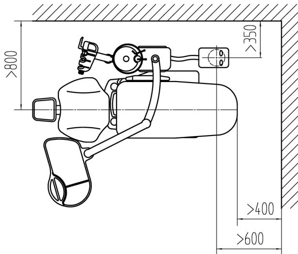
Рис. 12. Расположение установки
