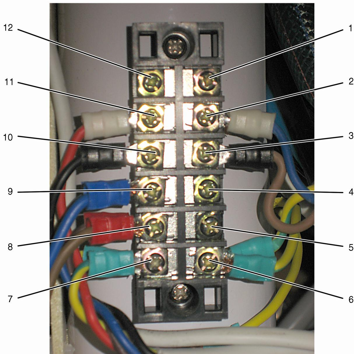
Для правильного подключения стоматологического кресла к распределительной колодке гидроблока нужно строго соблюдать следующую разводку:
