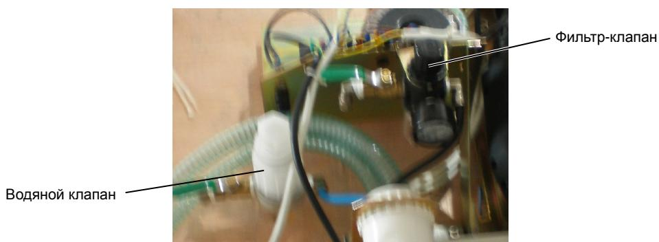
Рис. 17. Водяной клапан
