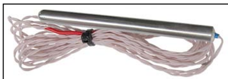
Рисунок 2. Датчик в герметичном корпусе.
