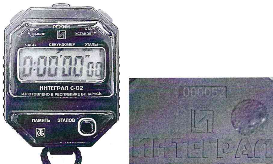
Рисунок 1.1 – Фотографии общего вида и маркировки секундомера электронного «Интеграл С-02» (изображение носит иллюстративный характер)
