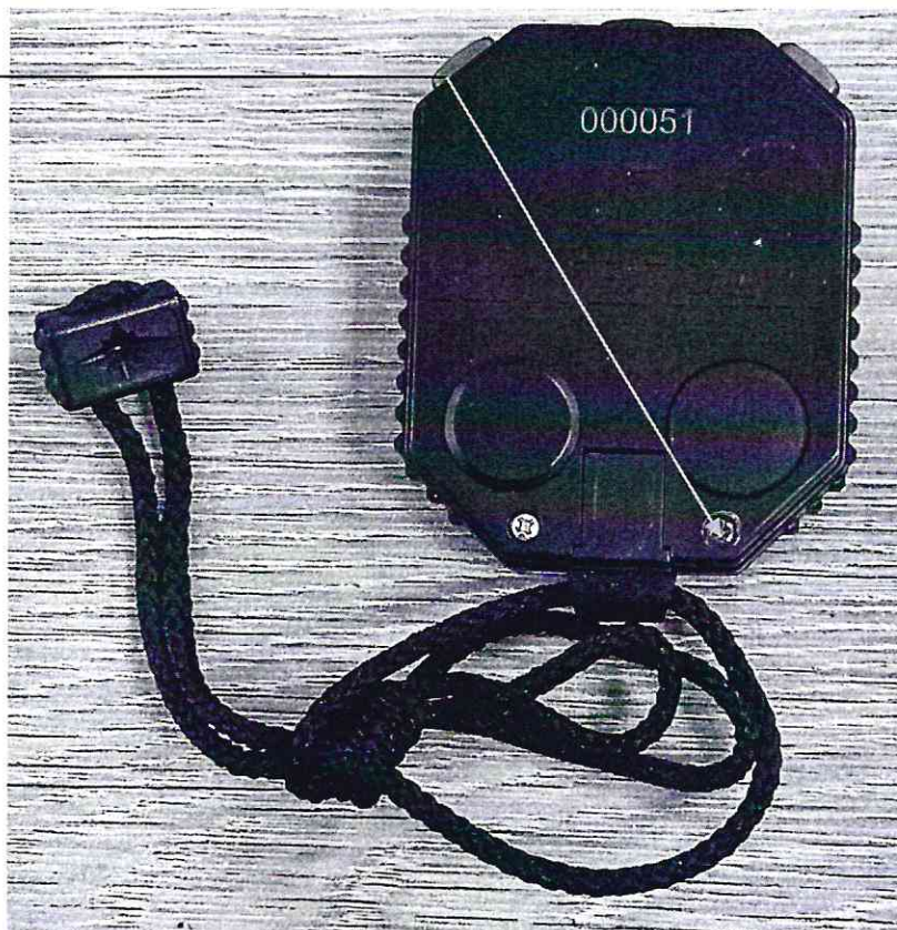
Рисунок 3.1 – Схема пломбировки от несанкционированного доступа
