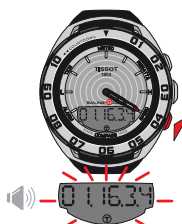
а) Мигание прекращается с индикацией промежуточного времени, хронограф работает в фоновом режиме
