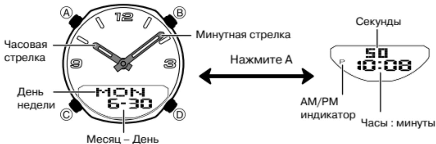
На рисунке изображен общий вид часов в Режиме Текущего Времени. Нажмите кнопку “**С**” для перехода из разряда в разряд в следующей последовательности: Режим Текущего Времени → Режим Записной Книжки → Режим Мирового Времени → Режим Звукового Сигнала
