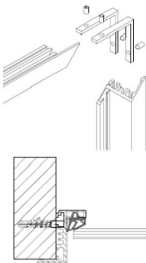
Перед установкой профиля в проем нужно по линии сверления, просверлить отверстия с шагом 300 мм, выполнить зенковку отверстий. Далее соедините дверной профиль уголками крепления (каждый уголок вставляется в отдельный паз). Закрепите их в профиле специальными винтами, которые поставляются в комплекте с угловым соединителем.
