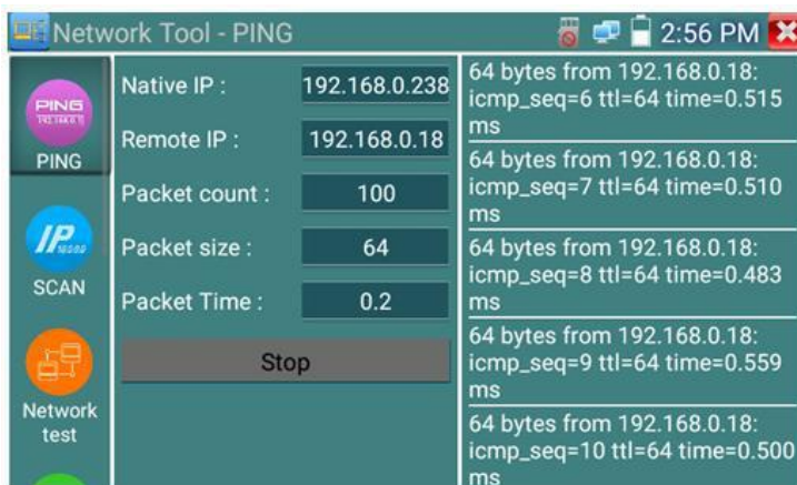
Рис. 86 Интерфейс инструмента «PING тест»
