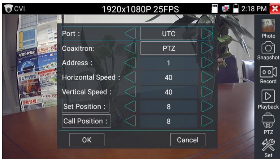
Рис. 74 Настройки для управления PTZ CVI видеокамерой по коаксиальному кабелю
