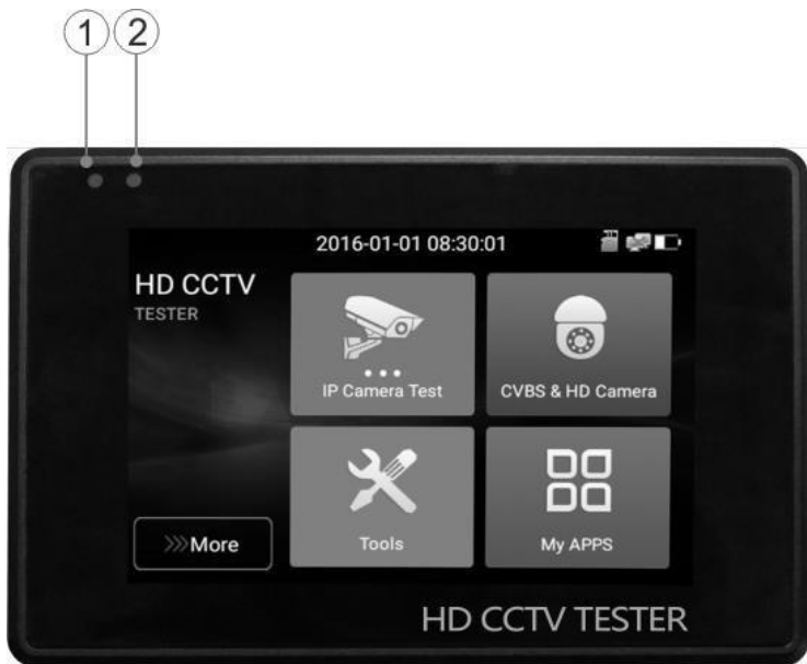
Рис. 3 Fiesta T-2, индикаторы на передней панели
