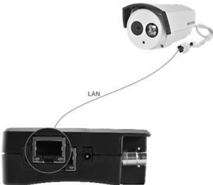
Рис. 8 Подключение IP-видеокамеры к тестеру
