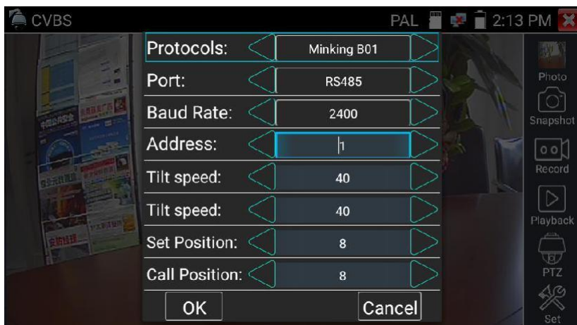
Рис.60 Настройки PTZ для управления через RS-485
