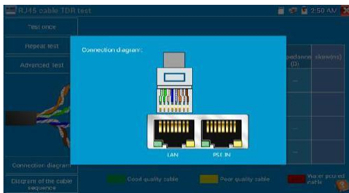
Рис. 102 Справочная схема подключения кабеля к тестеру для TDR теста
