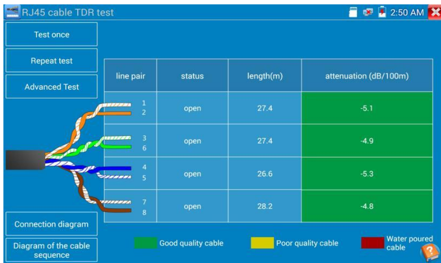
Рис. 100 Интерфейс рефлектометра (TDR) для кабеля «витой пары»
