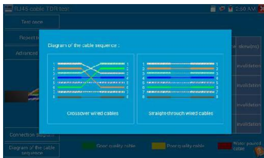
Рис. 103 Типы обжимки кабеля «витой пары»
