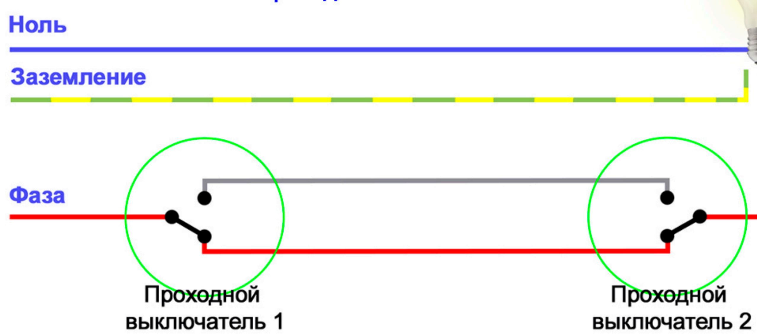
**Проходные выключатели** — дают возможность управлять одним источником света как минимум из двух разных мест. Это значит, что для управления освещением с двух мест в электрической цепи должно быть два проходных выключателя. Проходных переключателей в схеме может быть только два. Если требуется управлять освещением из трех и более мест, то применяется схема с перекрестным (промежуточным) переключателем.
